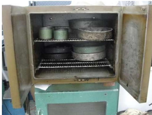
Fig. 5.3. Agregado pétreo, moldes y utensilios en horno
