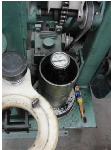
Fig. 4.13. Mezcla lista para compactar
