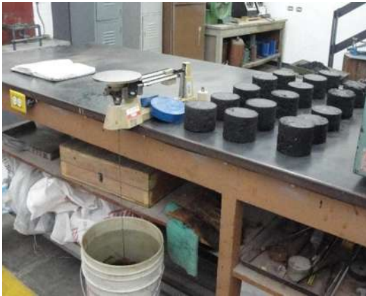
Fig. 4.18. Peso pastilla con parafina en agua
