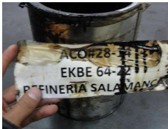
Fig. 4.7. Cemento asfaltico a utilizar
