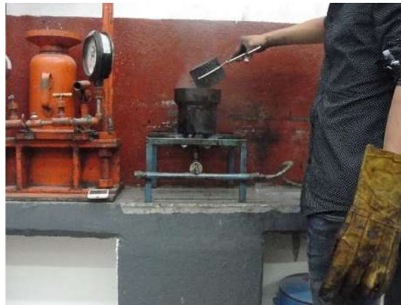
Fig. 4.15. Impermeabilizando cada pastilla
