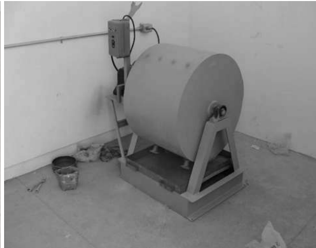
Fig.2.19. Maquina de abrasion de los Angeles
