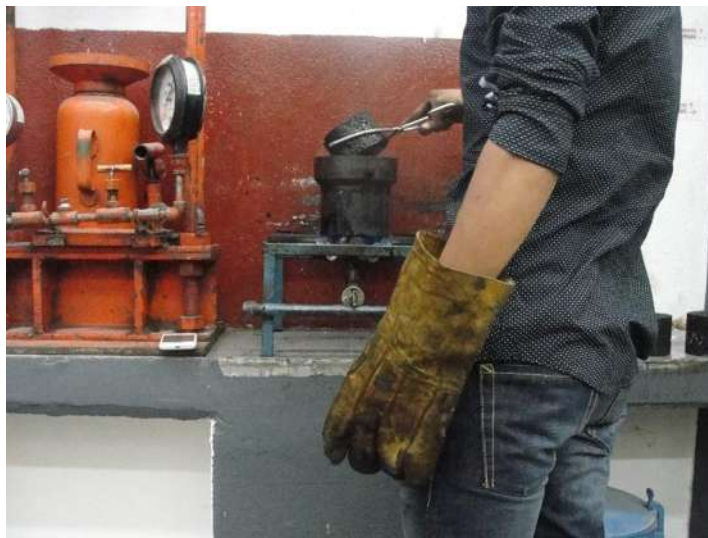
Fig. 5.7. Impermeabilizando cada pastilla
