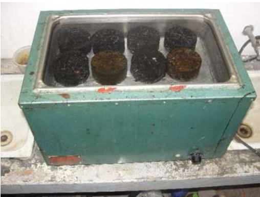
Fig. 5.10. Acondicionamiento de probetas a 60°C
