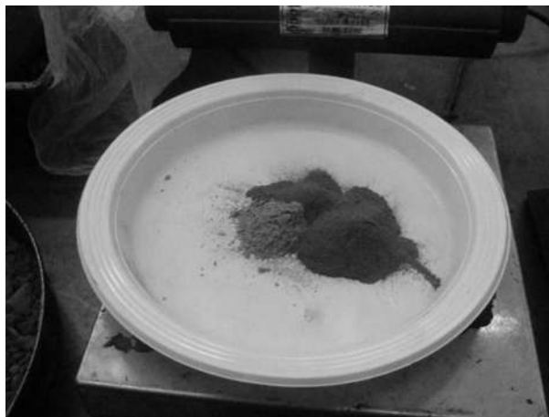
Fig. 5.2. Empleo de cemento portland en el ensaye Marshall.
