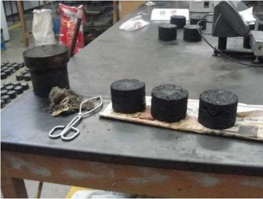
Fig. 5.8. Probetas del diseño Marshall impermeabilizadas
