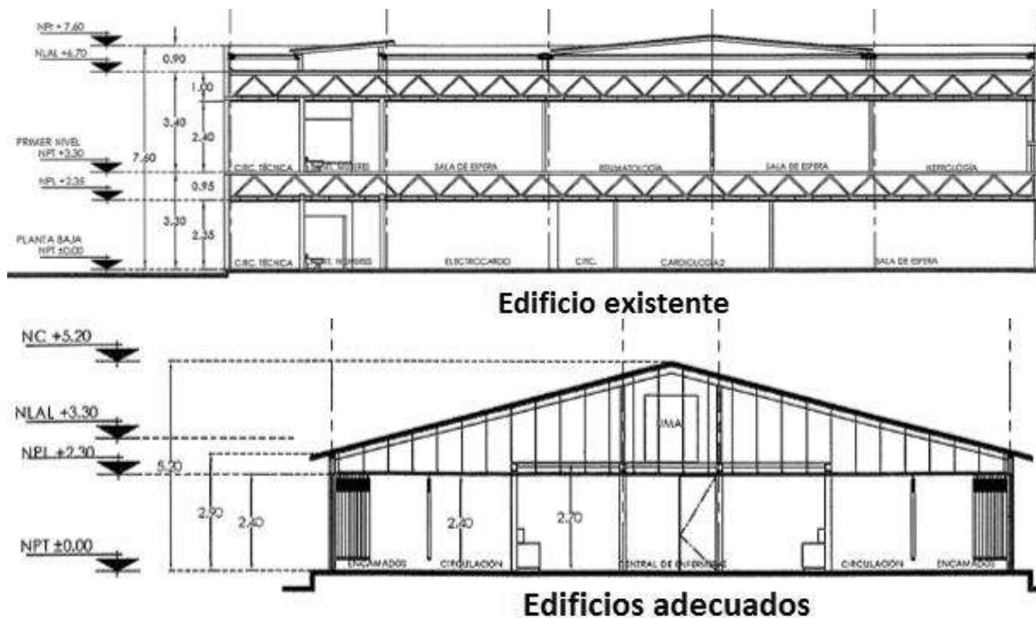
Figura 3.52 Irregularidades en elevación en el HGZ N° 83
