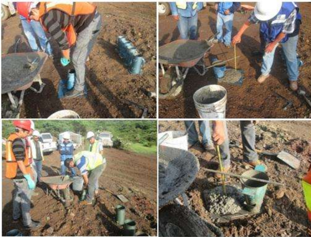
Figura 4.2.7.- Pruebas de revenimiento.
