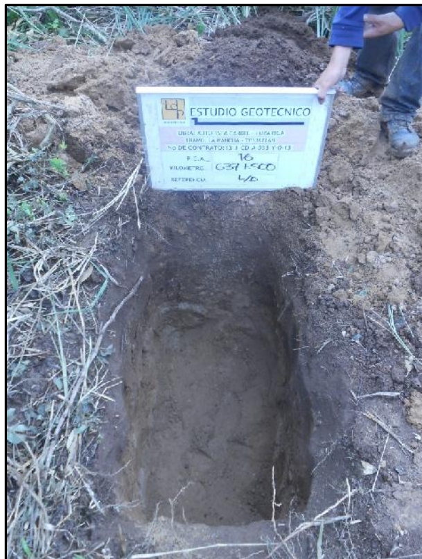
Fotografía No. 48.- PCA no.16 ubicado en el km 637+500 de 1.60 m de profundidad. En donde se encontró arena arcillosa poco húmeda, medianamente compacta. De color café. SC
