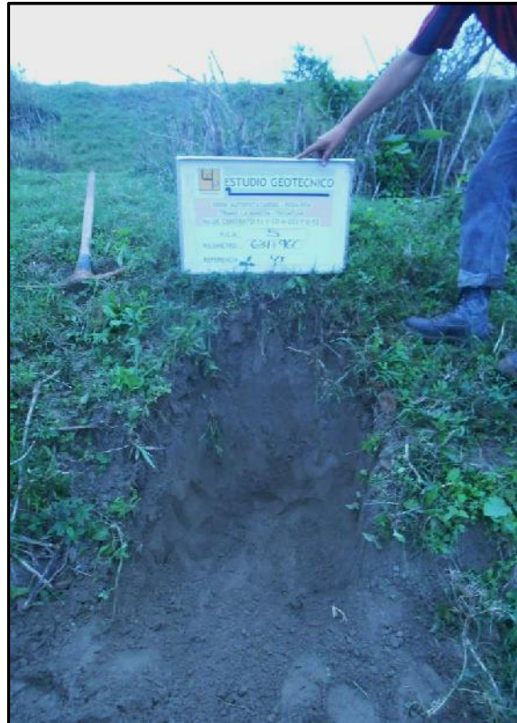
Fotografía No. 15.- PCA no.5 ubicado en el km 631+960 de 1.20 m de profundidad. En donde se encontró arcilla inorgánica de alta plasticidad, de consistencia firme. De color café. CH1 (Zona de inundación), Se recomienda colocar un pedraplen.
