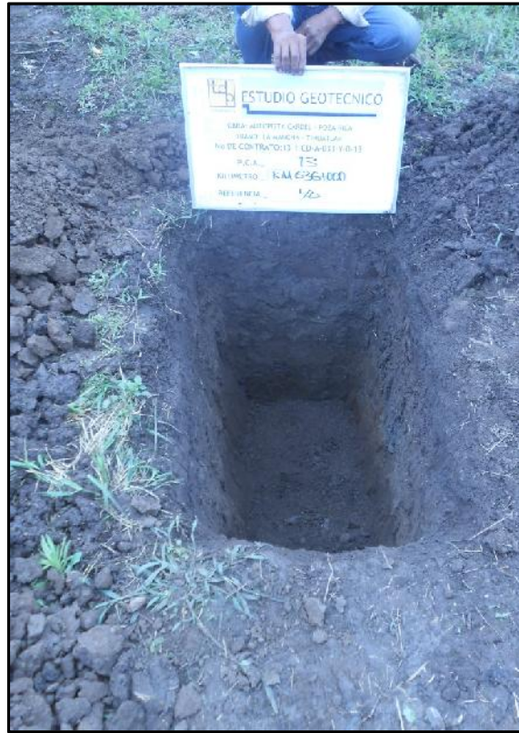
Fotografía No. 39.- PCA no.13 ubicado en el km 636+000 de 1.50m de profundidad. En donde se encontró arena arcillosa poco húmeda, medianamente compacta. De color café. SC
