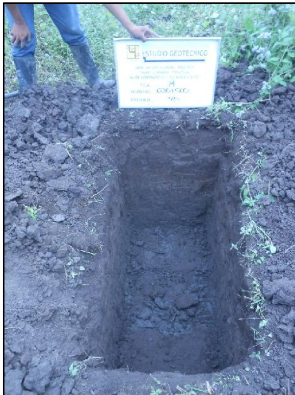
Fotografía No. 42.- PCA no.14 ubicado en el km 636+500de 1.50 m de profundidad. En donde se encontró limo orgánico de alta plasticidad, de consistencia media. De color café. OH
