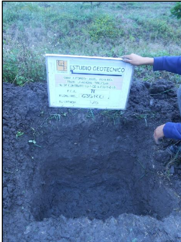
Fotografía No. 33.- PCA no.11 ubicado en el km 635+000 de 1.20 m de profundidad. En donde se encontró arcilla inorgánica de alta plasticidad, de consistencia firme. De color café. CH1
