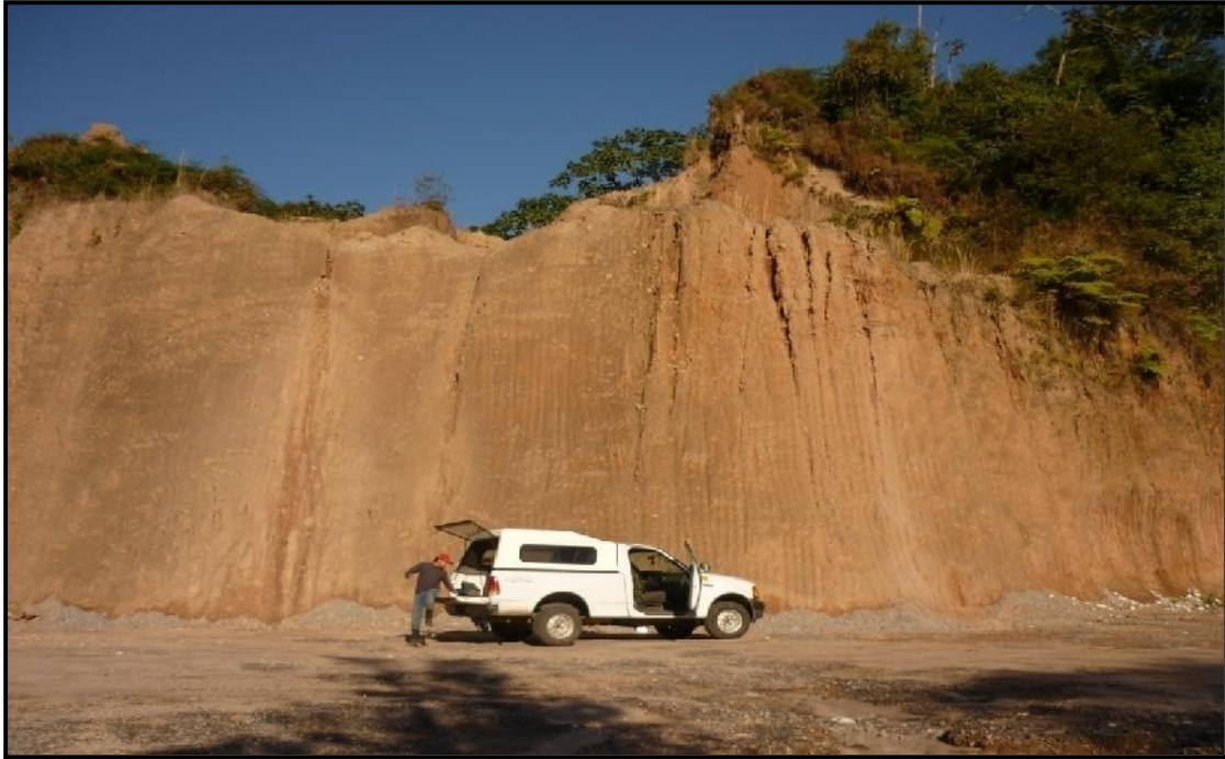
Fotografía 8.- Banco de materiales denominado como Camacho Ubicado en la carretera martinez de la torre-cochota en el km 3+000 con desviación izquierda a 100m en camino de terracería y referenciado al eje de trazo a 25,459 m del km 634+280 propuesto para ser empleado como: subrasante, subyacente y cuerpo de terraplén
