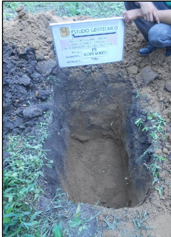
Fotografía No. 57.- PCA no.19 ubicado en el km 639+000 de 1.60 m de profundidad. En donde se encontró arena arcillosa poco húmeda, medianamente compacta. De color café. SC
