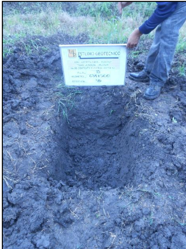
Fotografía No. 30.- PCA no.10 ubicado en el km 634+500 de 1.20 m de profundidad. En donde se encontró arcilla inorgánica de alta plasticidad, de consistencia firme. De color café. CH1
