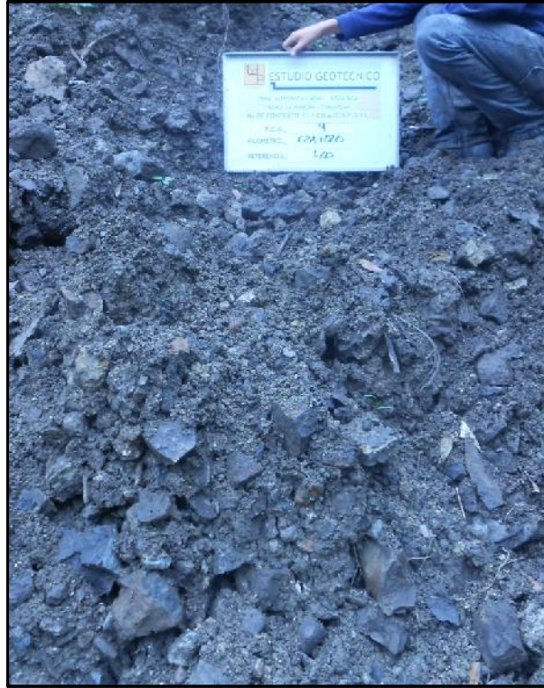
Fotografía No. 27.- PCA no.9 ubicado en el km 634+020 de 1.50 m de profundidad. En donde se encontró en el primer estrato arcilla inorgánica de alta plasticidad, de consistencia Firme de color café, empacando fragmentos de roca grandes, medianos y chicos CH1_Fgmc . En el segundo estrato se encontró roca ígnea extrusiva medianamente intemperizada y cementada al atacarse se obtendrán fragmentos grandes, medianos y chicos. Rie-Fgmc
