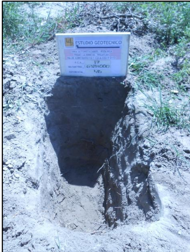
Fotografía No. 51.- PCA no.17 ubicado en el km 638+000 de 1.60 m de profundidad. En donde se encontró arena arcillosa poco húmeda, medianamente compacta. De color café. SC
