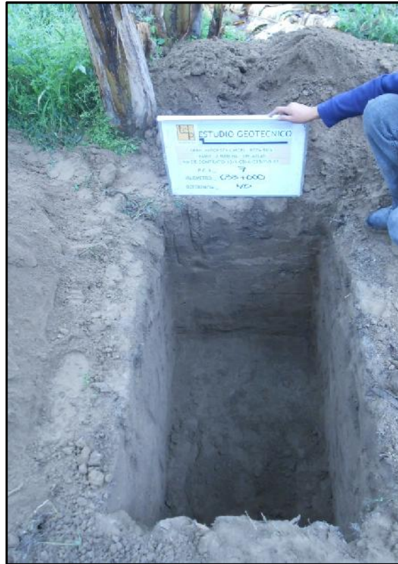
Fotografía No. 21.- PCA no.7 ubicado en el km 633+000 de 1.60 m de profundidad. En donde se encontró arena arcillosa poco húmeda, medianamente compacta. De color café. SC (Zona de inundación), Se recomienda colocar un pedraplen.
