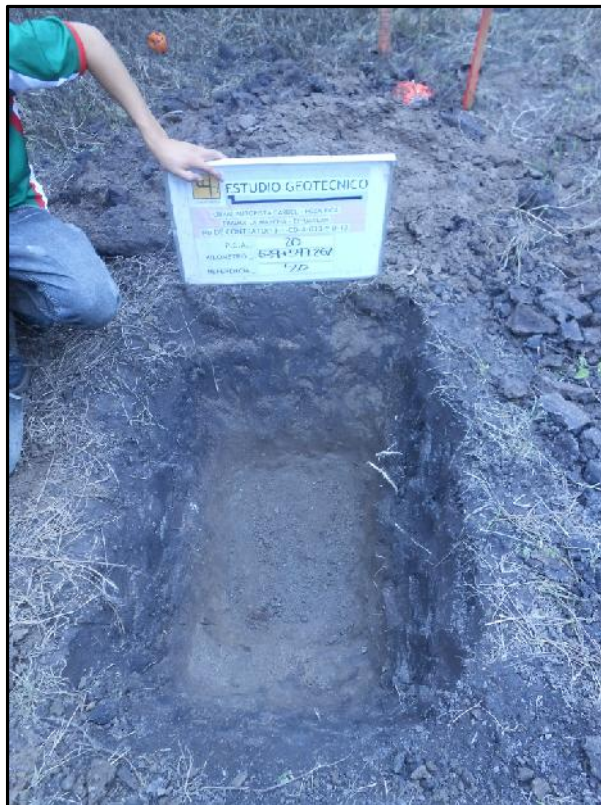
Fotografía No. 60.- PCA no.20 ubicado en el km 639+547.267 de 1.60 m de profundidad. En donde se encontró arena arcillosa poco húmeda, medianamente compacta. De color café. SC .
