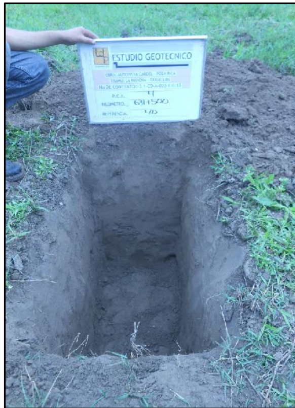
Fotografía No. 12.- P.C.A. No.4 ubicado en el km 631+500 de 1.50 m de profundidad. En donde se encontró arcilla inorgánica de alta plasticidad, de consistencia firme. De color café. CH1 (Zona de inundación), Se recomienda colocar un pedraplen.
