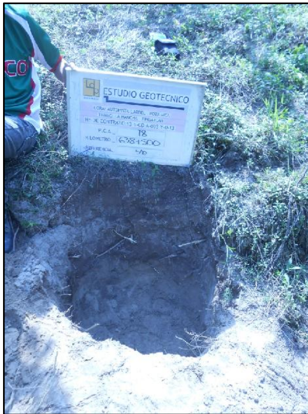
Fotografía No. 54.- PCA no.18 ubicado en el km 638+500 de 1.40 m de profundidad. En donde se encontró arena arcillosa poco húmeda, medianamente compacta. De color café. SC
