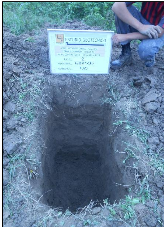
Fotografía No. 6.- P.C.A. No. 2 ubicado en el km 630+500 de 1.50 m de profundidad. En donde se encontró arcilla inorgánica de alta plasticidad, de consistencia firme. De color café. CH1 (Zona de inundación), Se recomienda colocar un pedraplen.
