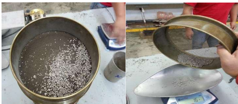
FIGURA 43. Peso del material retenido en las mallas.
