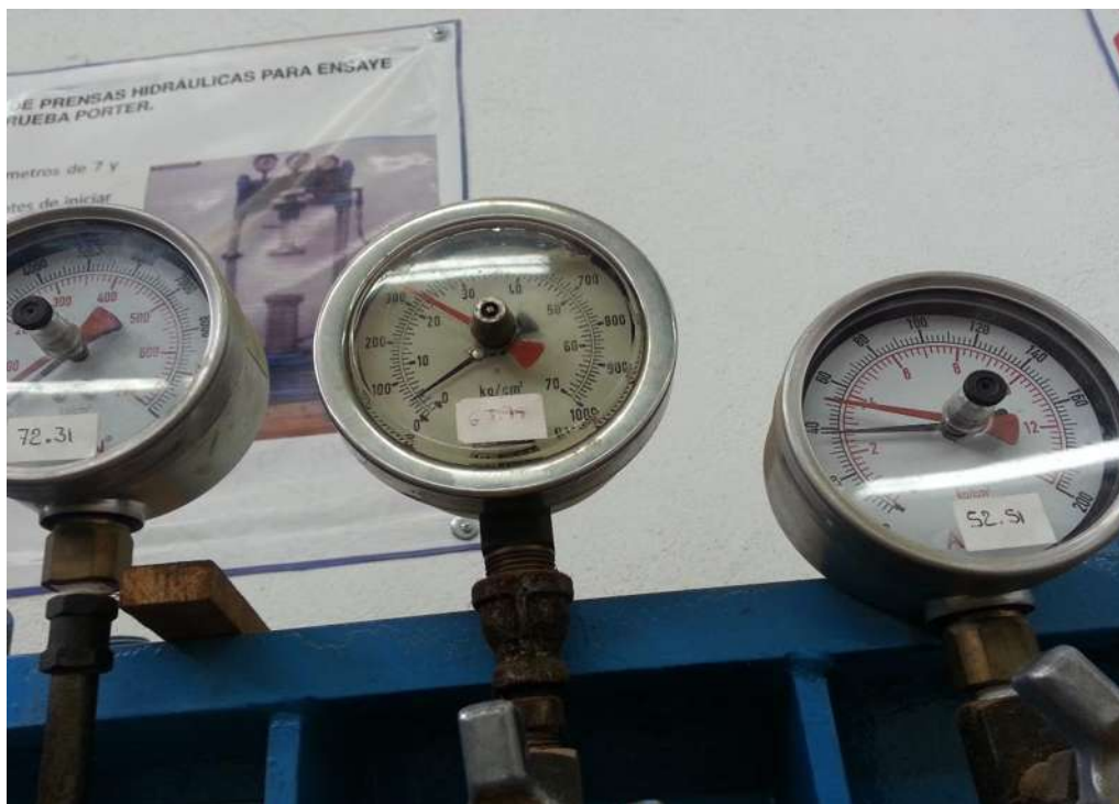
FIGURA 153. Lectura de la carga aplicada.
