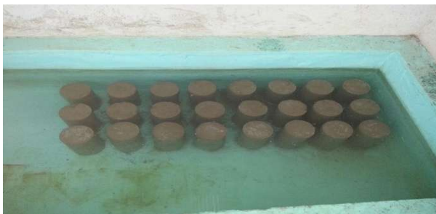
FIGURA 146. Especímenes colocados dentro de la pila llena de agua.
