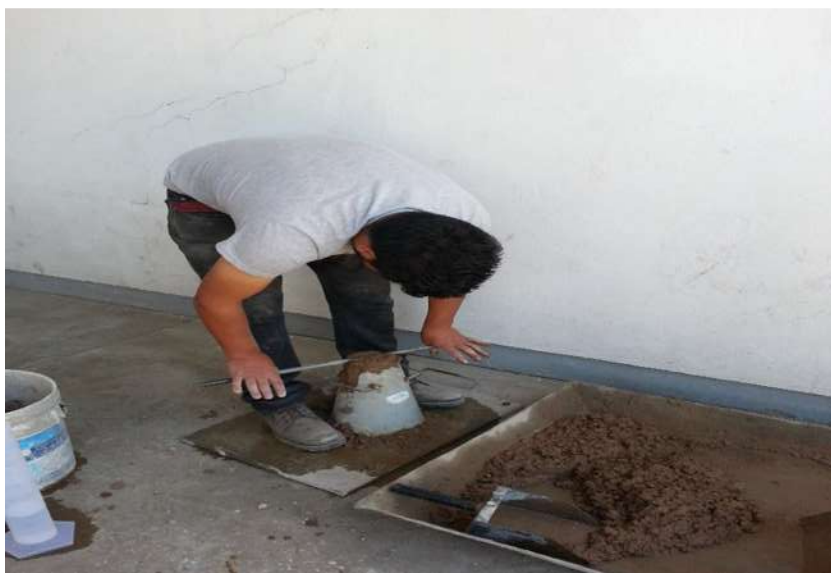
FIGURA 102. Enrase con barrilla.
