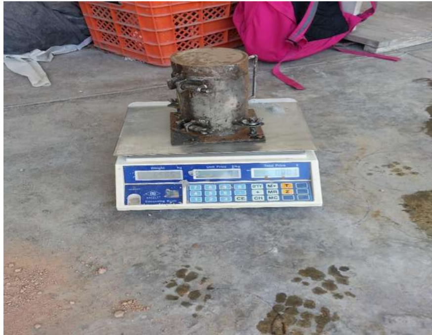
FIGURA 112. Peso del espécimen.
