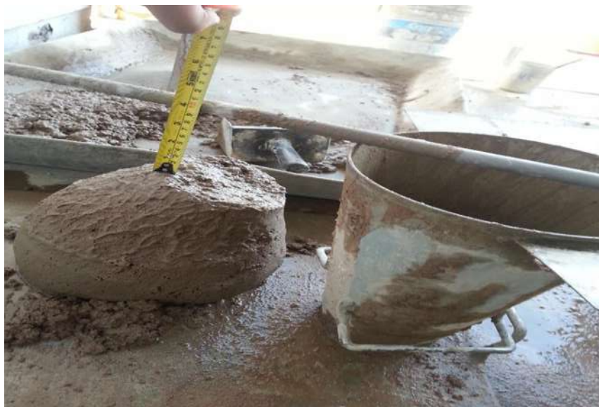
FIGURA 105. Medición del revenimiento (8 a 14 cm).
