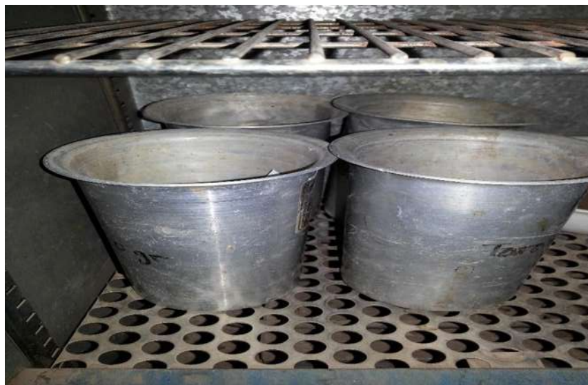
FIGURA 71. Se colocan las porciones en el horno por 24 horas.
