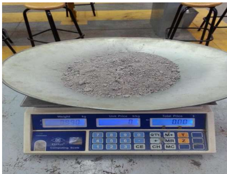
FIGURA 86. Pesado de las cantidades de cemento para cada porcentaje.
