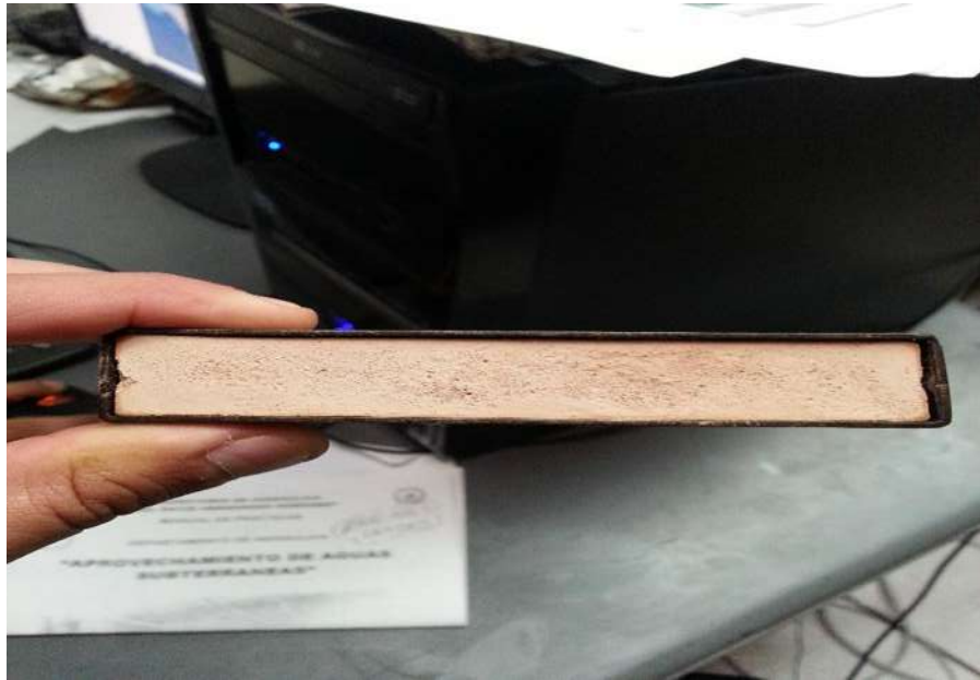
FIGURA 52. Muestra seca y contraída.
