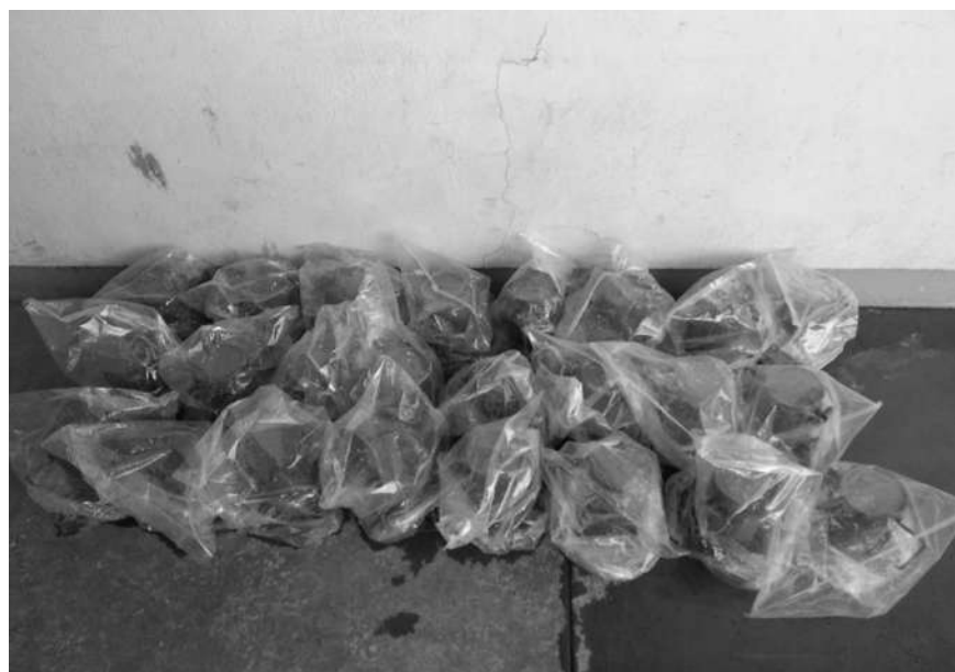
FIGURA 115. Especímenes cubiertos con bolsas de plástico.
