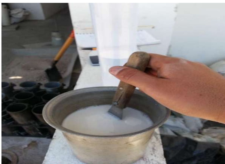
FIGURA 88. El aditivo MAXE-H es diluido en agua y mantenido en reposo por 10 minutos mínimo.
