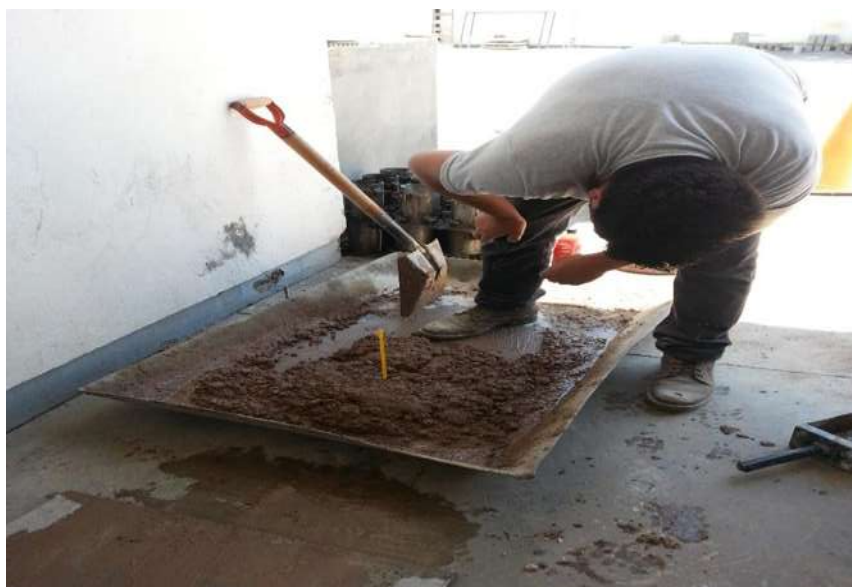
FIGURA 96. Observación de temperatura.
