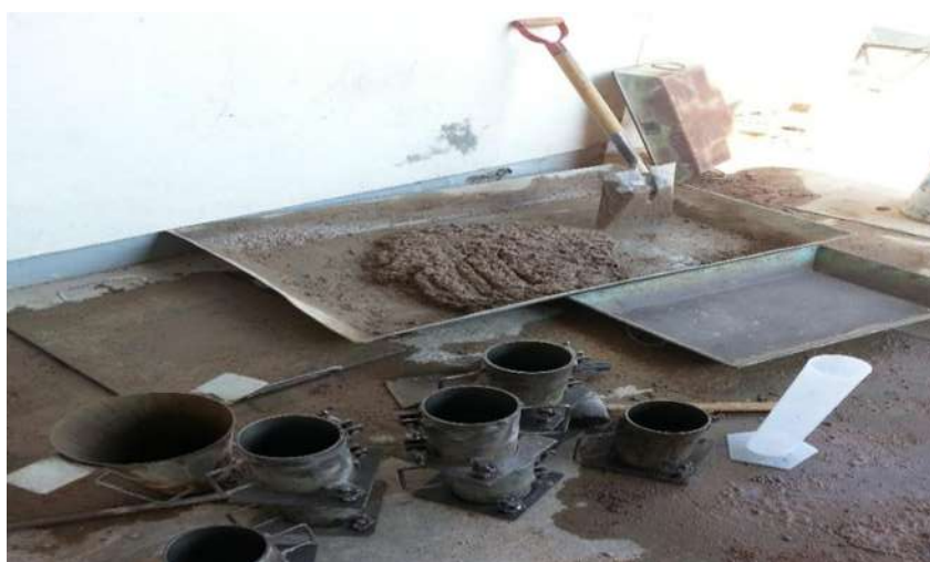
FIGURA 106. Llenado de los especímenes.
