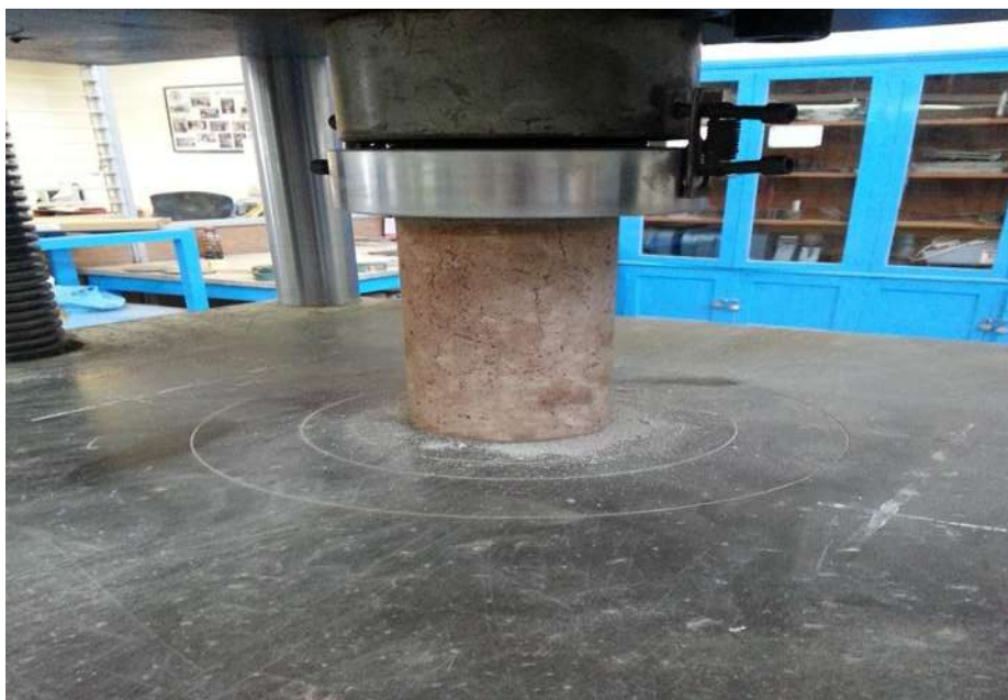
FIGURA 137. Ruptura del espécimen.
