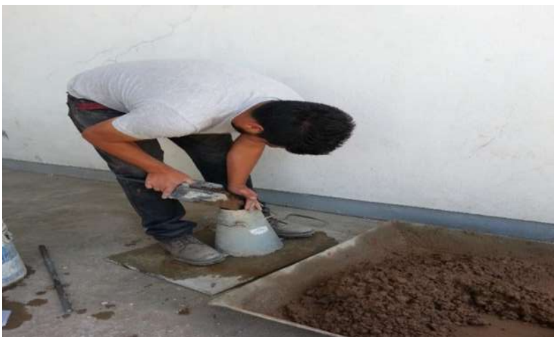
FIGURA 97. Llenado del cono para el revenimiento.
