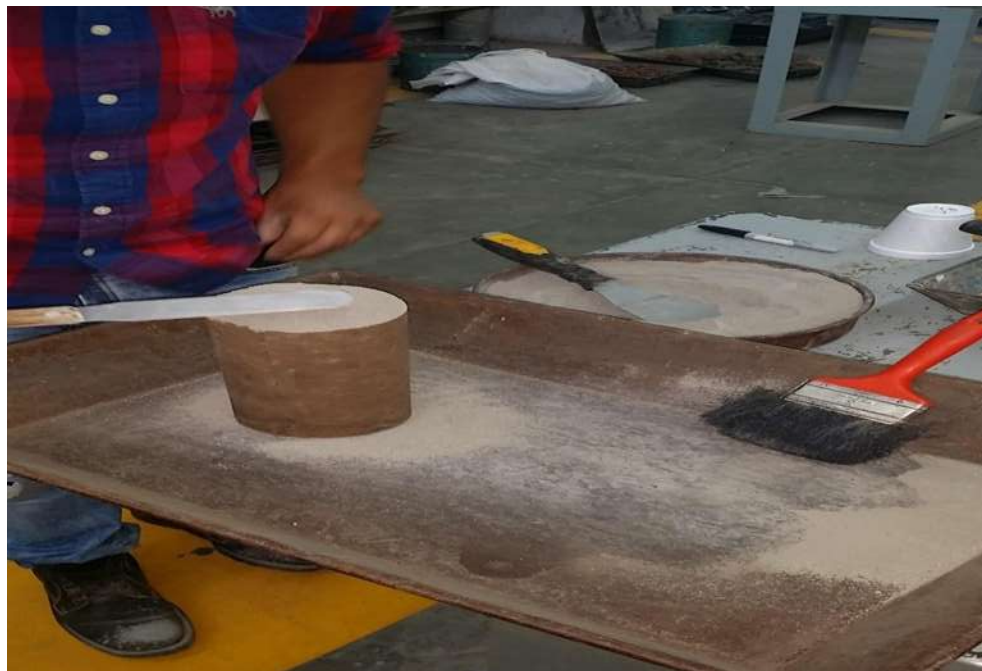
FIGURA 125. Espátula de laboratorio rígida de bordes rectos para esparcir el material de forma uniforme.
