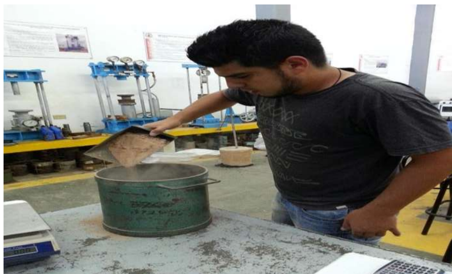
FIGURA 54. Llenado uniforme del recipiente.
