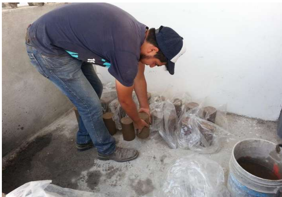
FIGURA 120. Colocación de bolsas húmedas.
