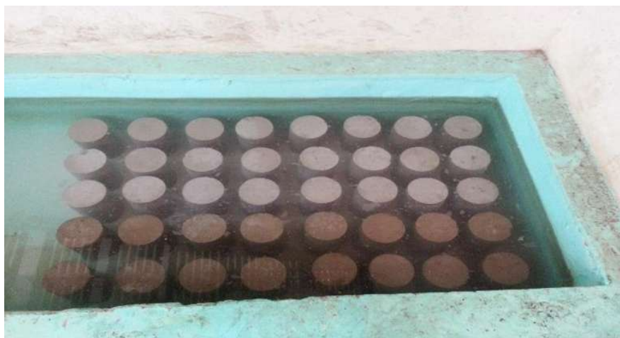
FIGURA 147. Especímenes saturados en agua.
