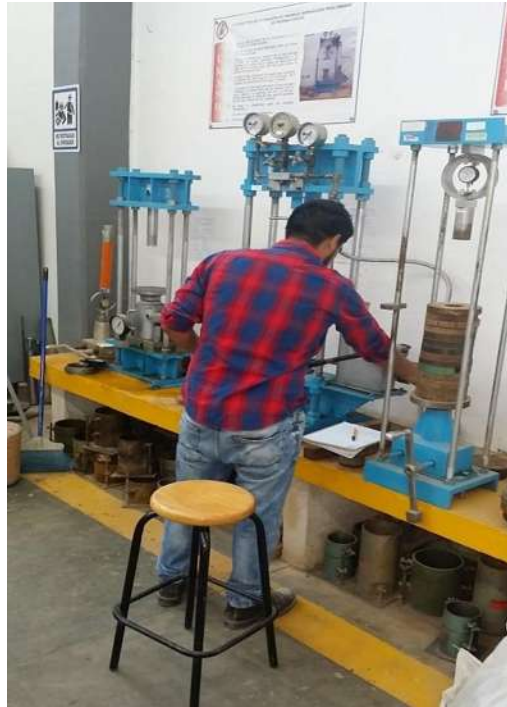
FIGURA 129. Preparación para realizar la prueba de compresión simple en prensa hidráulica.
