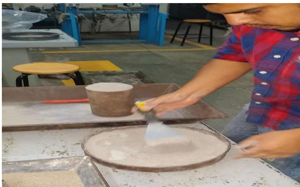
FIGURA 124. Cabeceo de los cilindros con la mezcla de arena fina de mar y cemento portland, para lograr un paralelismo entre caras al ser comprimido el espécimen.
