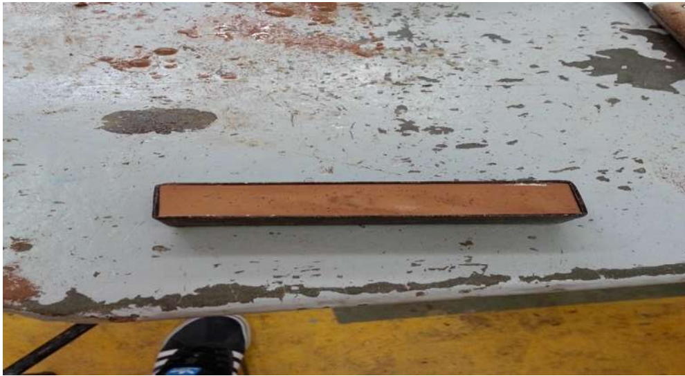
FIGURA 51. Muestra en el molde enrazado.
