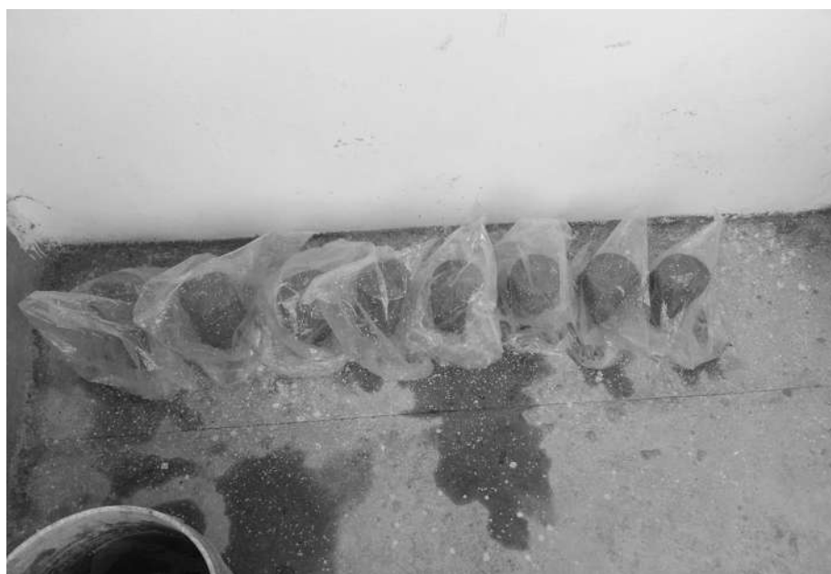
FIGURA 119. Curado de especímenes con bolsa húmeda.
