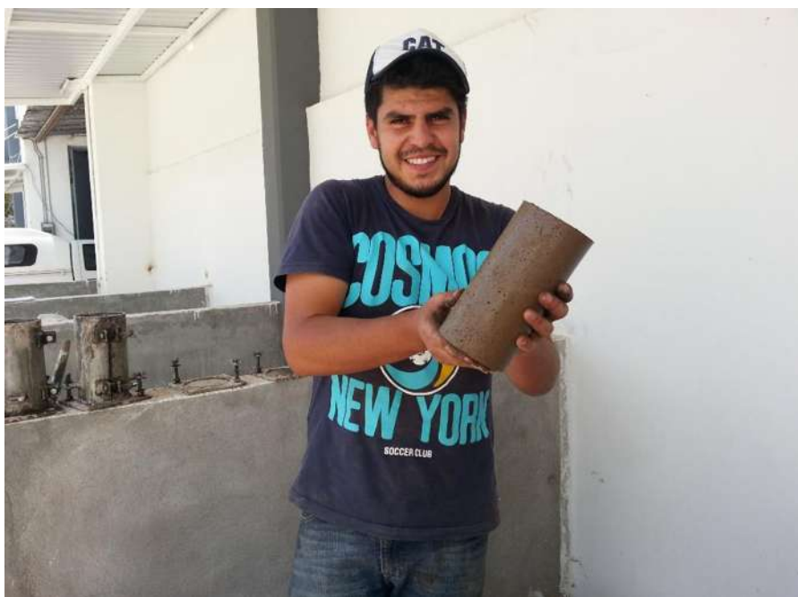
FIGURA 117. Especimen fuera del molde.
