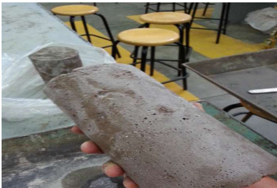
FIGURA 154. Especimen que muestra expulsión de cemento.
