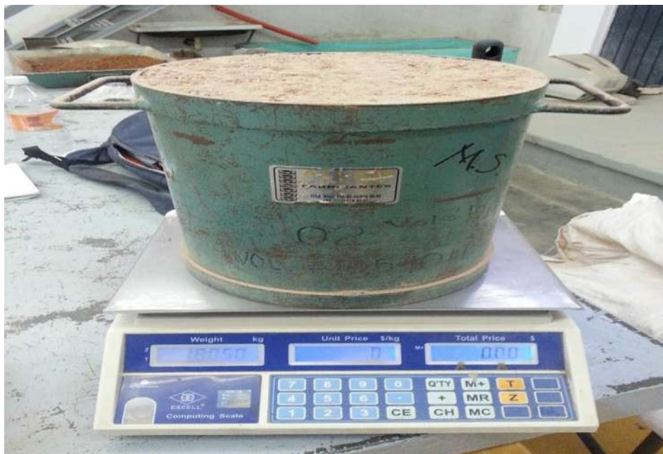
FIGURA 56. Peso del material para la obtención del P.V.S.S.
