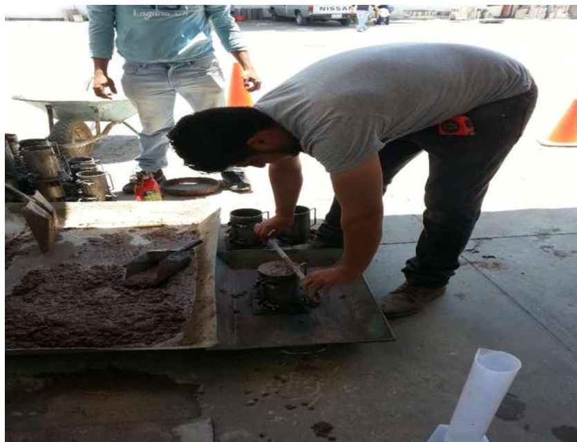
FIGURA 109. Enrase de los especímenes.
