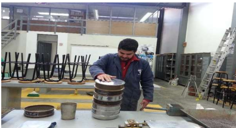
FIGURA 42. Cribado del material manualmente.
