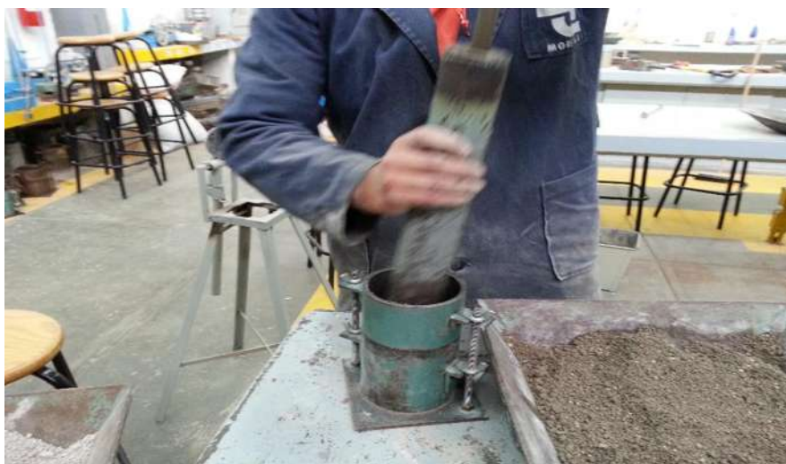
FIGURA 66. Muestra la compactación de una de la capas.
