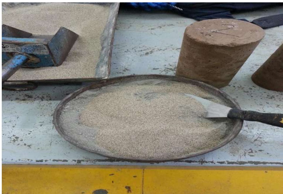
FIGURA 122. Mezcla de arena fina de mar y cemento portland para realizar el cabeceo de los especímenes para realizar pruebas a compresión simple.
