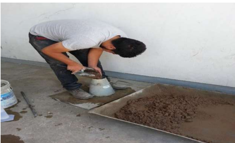
FIGURA 98. Llenado del cono para el revenimiento.
