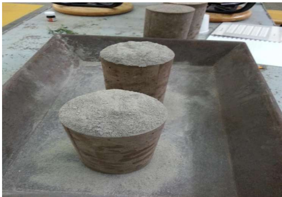
FIGURA 126. Mezcla de arena fina de mar y cemento portland para cabeceo colocada en especímenes.
