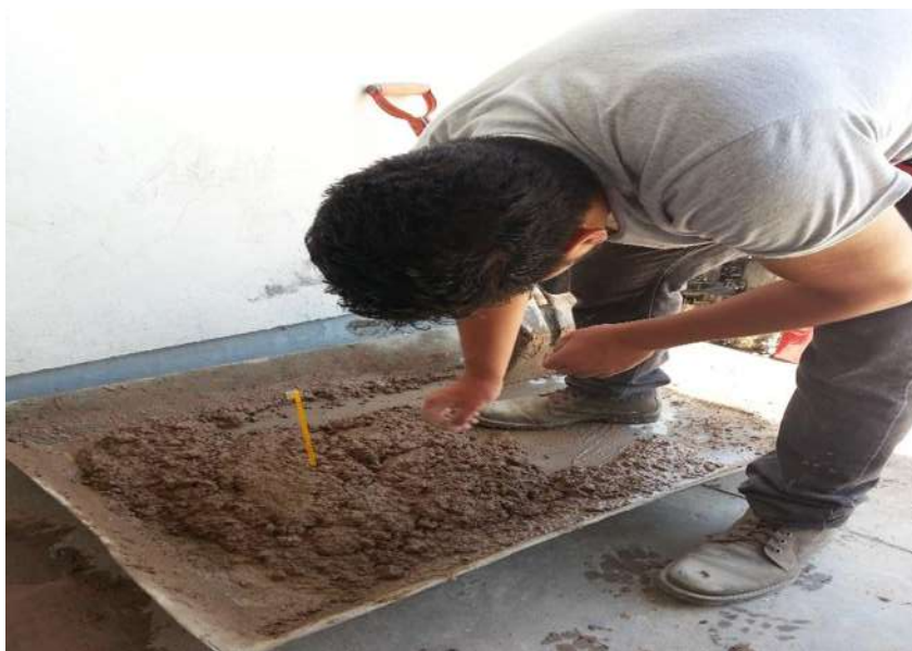
FIGURA. 95. Colocación del termómetro.
