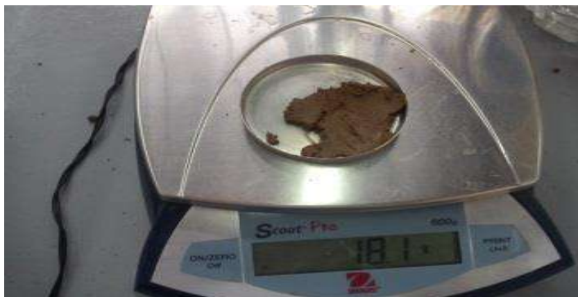
FIGURA 49.10 gr. del material es pesada para obtener el contenido de agua.
