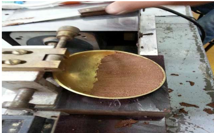
FIGURA 47. Material colocado en la copa de Casagrande.
