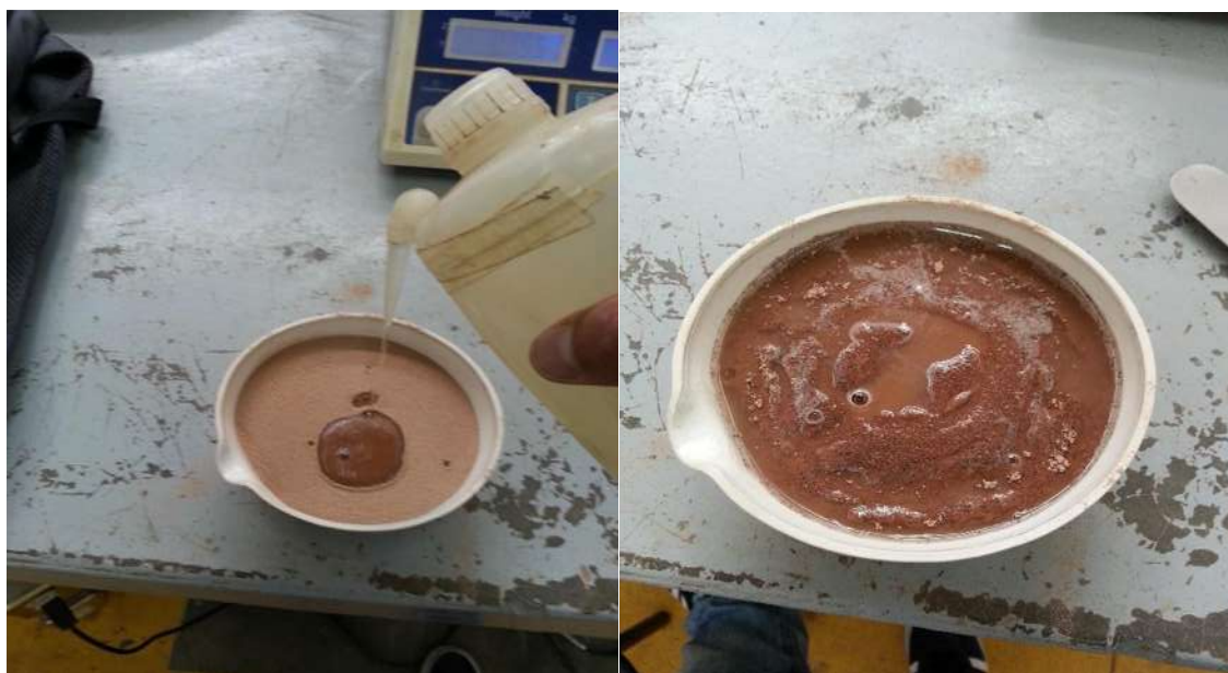
FIGURA 45. Saturación de la muestra con agua destilada y puesta en reposo por 24 horas.
