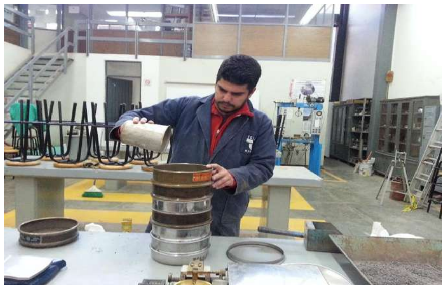
FIGURA 41. Colocación del material en las mallas.
