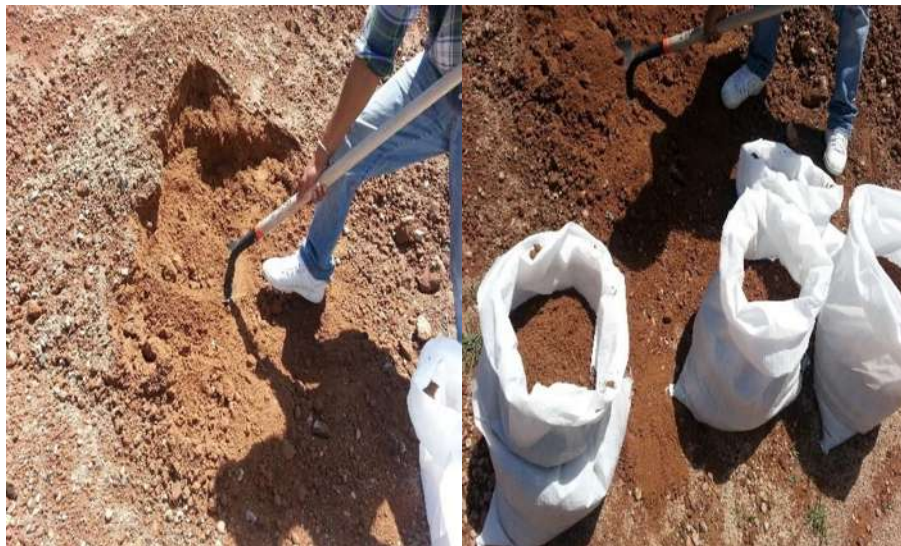
FIGURA 37. Muestreo del material proveniente del banco de materiales de San Miguel de Allende.
