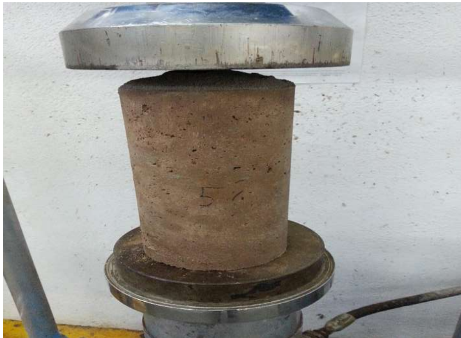
FIGURA 128. Especimen listo para probar.
