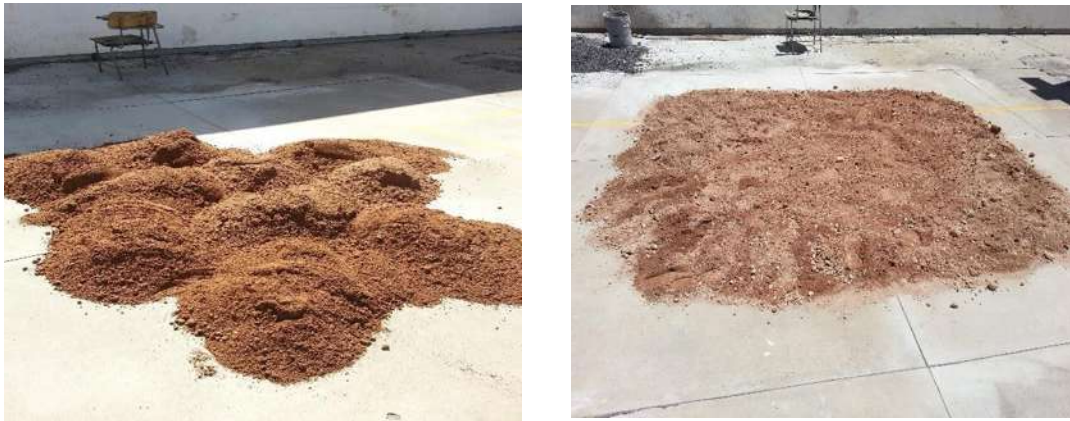
FIGURA 32. Suelo de tepetate. (Arena limosa) sin materia vegetal.
