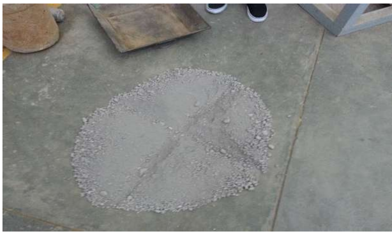
FIGURA 62. Cuarteo del material.
