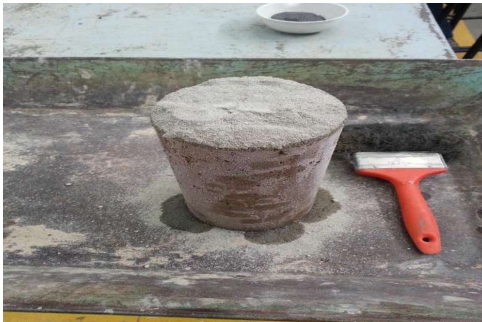
FIGURA 150. Especimen cabeceado listo para probar.
