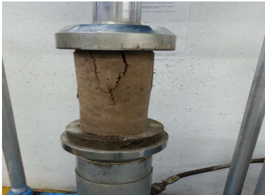
FIGURA 131. Ruptura del espécimen.
