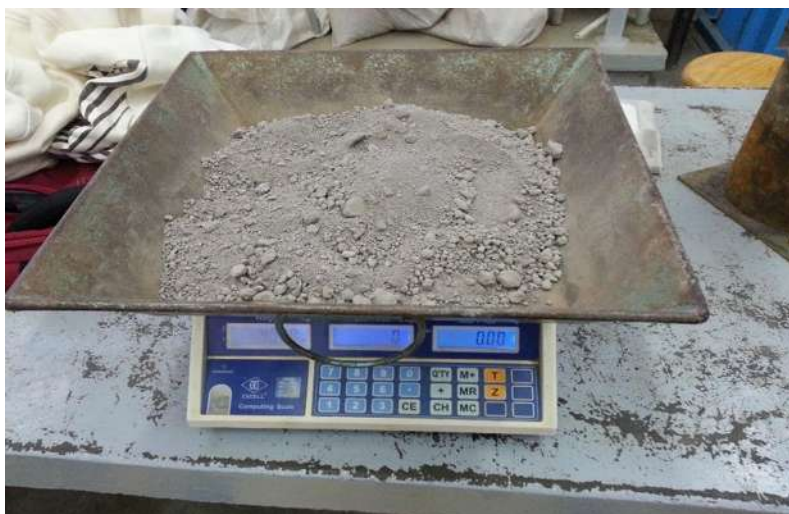
FIGURA 63. Peso de la muestra de 4kg.
