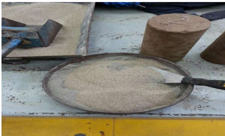
FIGURA 133. Mezcla de arena fina de mar y cemento portland para realizar el cabeceo de los especímenes para realizar pruebas a compresión simple.
