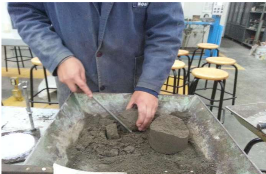
FIGURA 69. Obteniendo la porción de material para obtener su contenido de agua.
