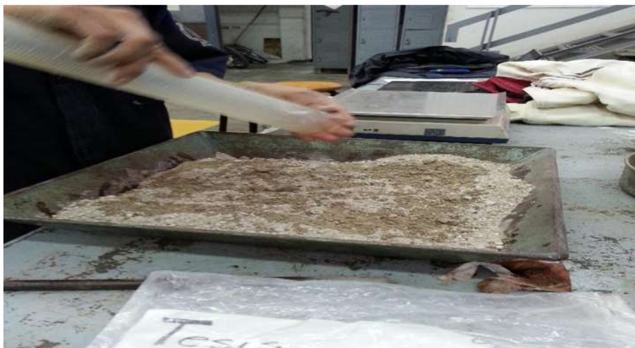
FIGURA 64. Muestra incorporación de agua al material.
