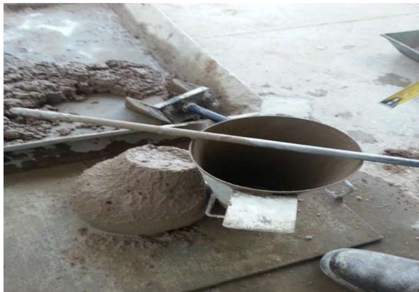
FIGURA 104. Preparación para la medición del revenimiento.
