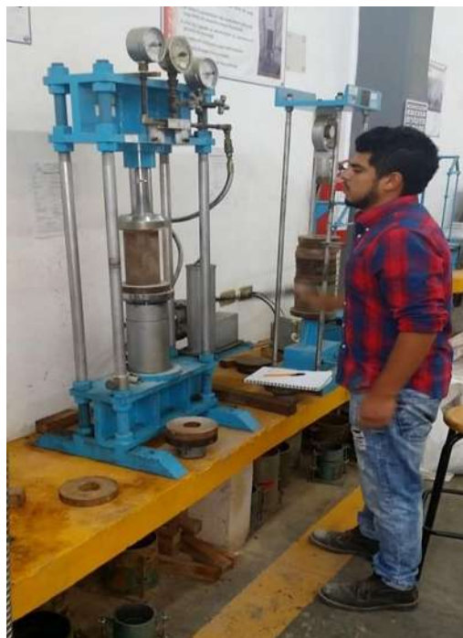
FIGURA 130. Prueba de compresión simple en prensa hidráulica.
