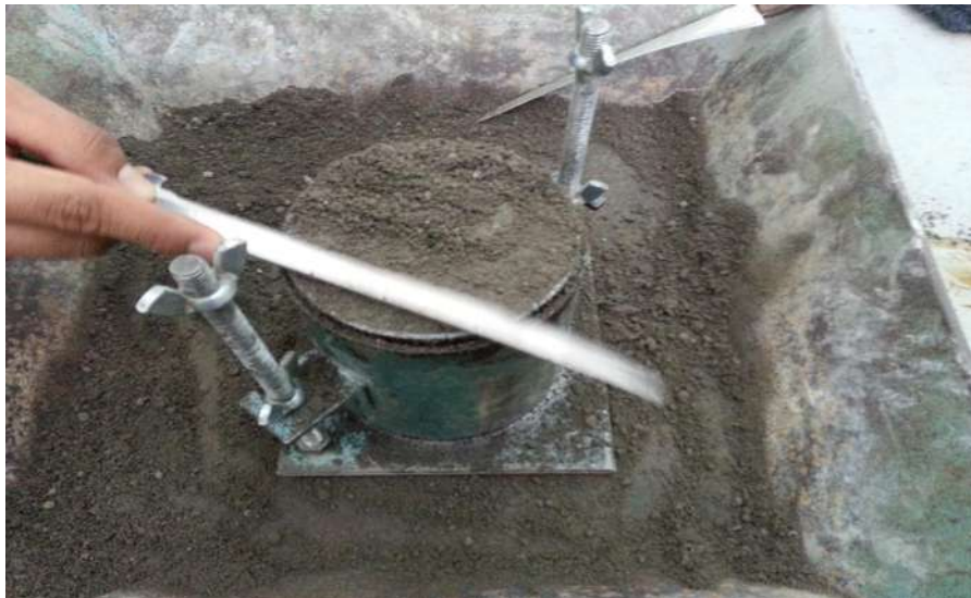
FIGURA 67. Muestra el enrazado del molde.
