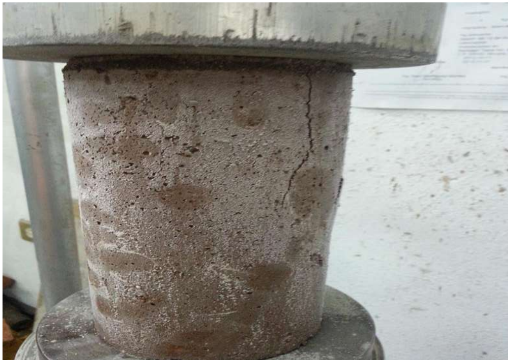
FIGURA 152. Fractura del espécimen al llegar a su máxima resistencia.
