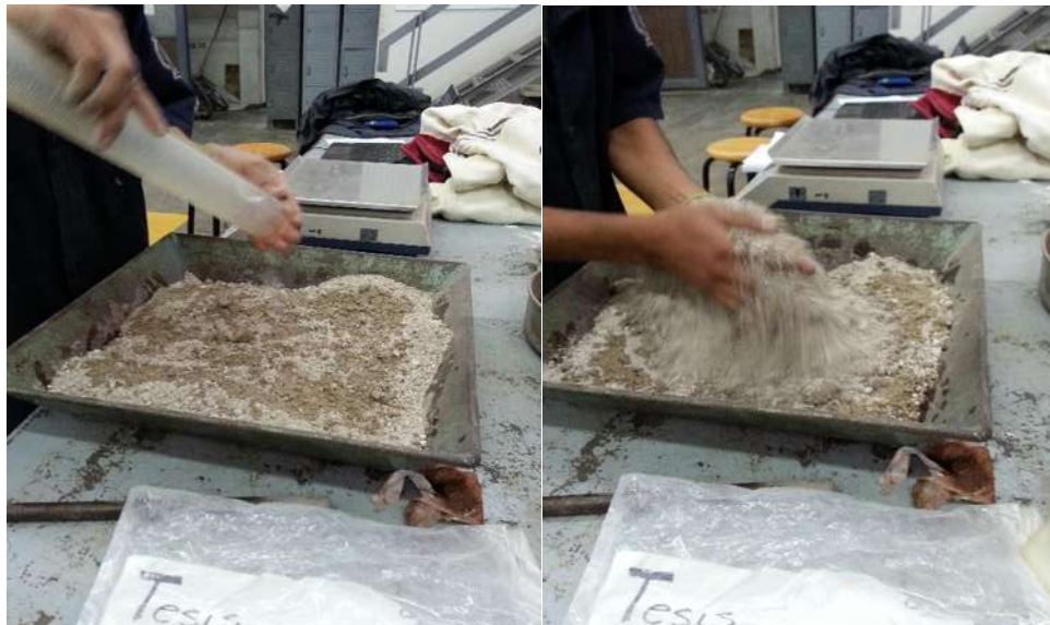
FIGURA 73. Muestra homogenización de la muestra.
