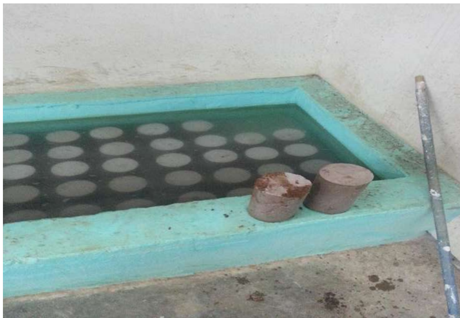
FIGURA 148. Escurriendo los especímenes antes de ser probados.
