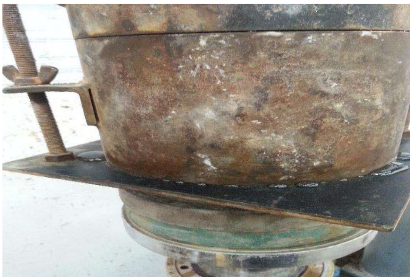
FIGURA 76. Humedecimiento en la base del molde.
