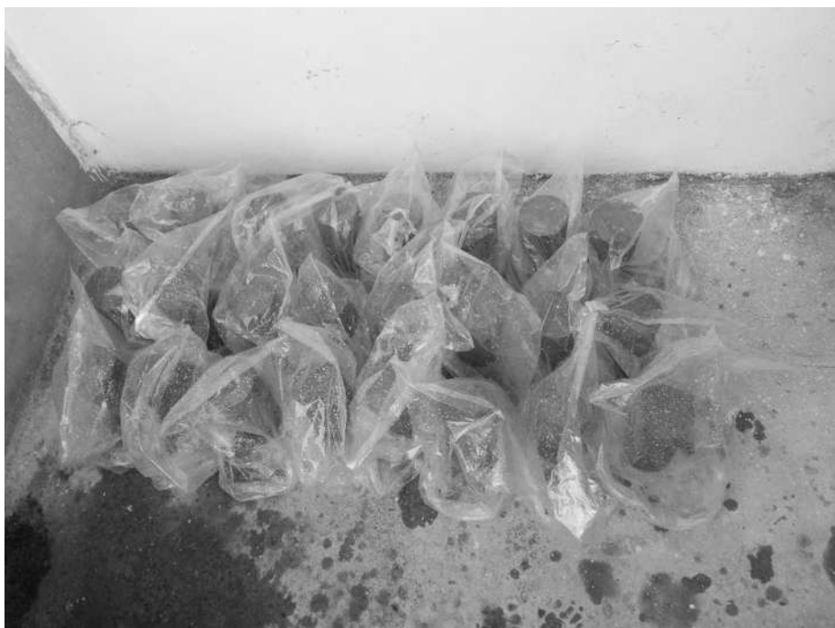
FIGURA 121. Especímenes con curado de bolsas húmedas y colocados en un lugar seguro.
