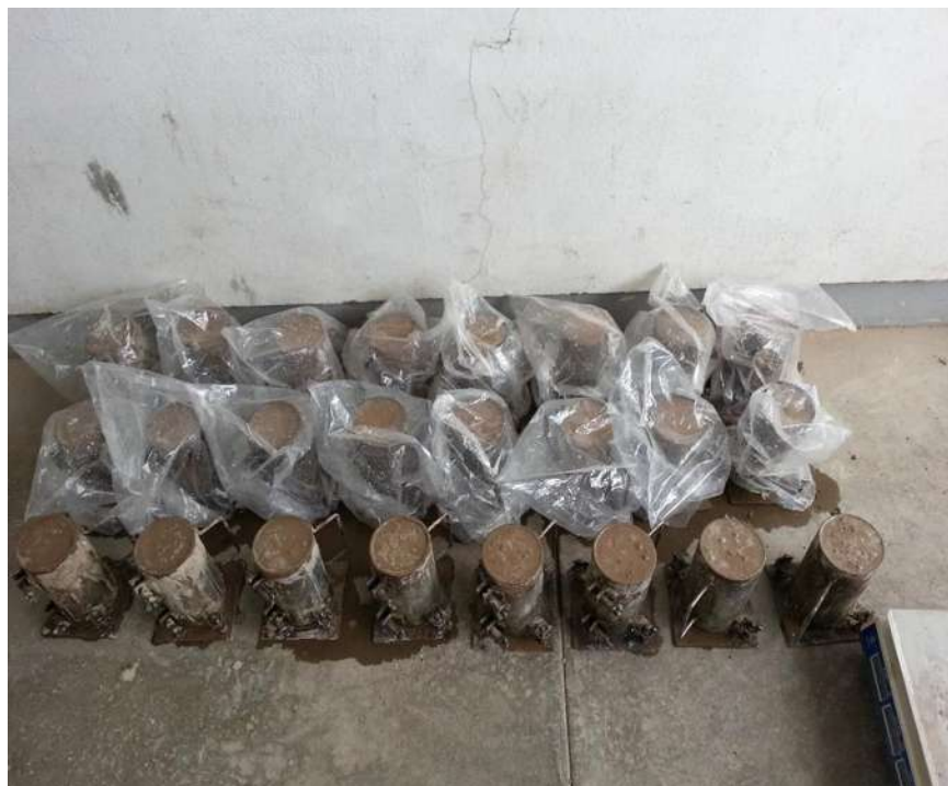
FIGURA 114. Cubriendo los especímenes con bolsas de plástico.
