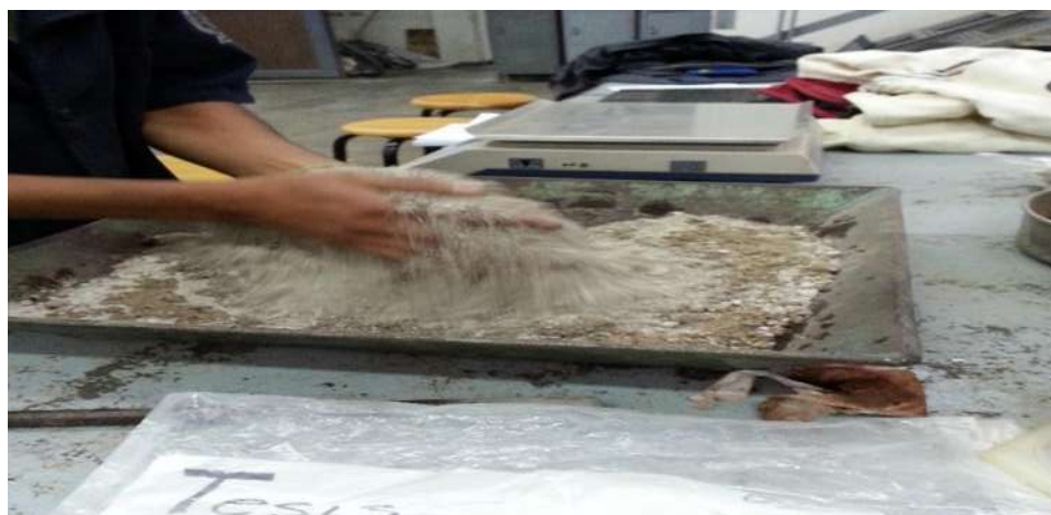
FIGURA 65. Muestra la homogenización del material.
