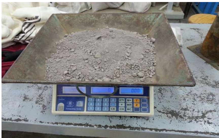
FIGURA 72. Muestra el cribado y pesado de la muestra a utilizar.
