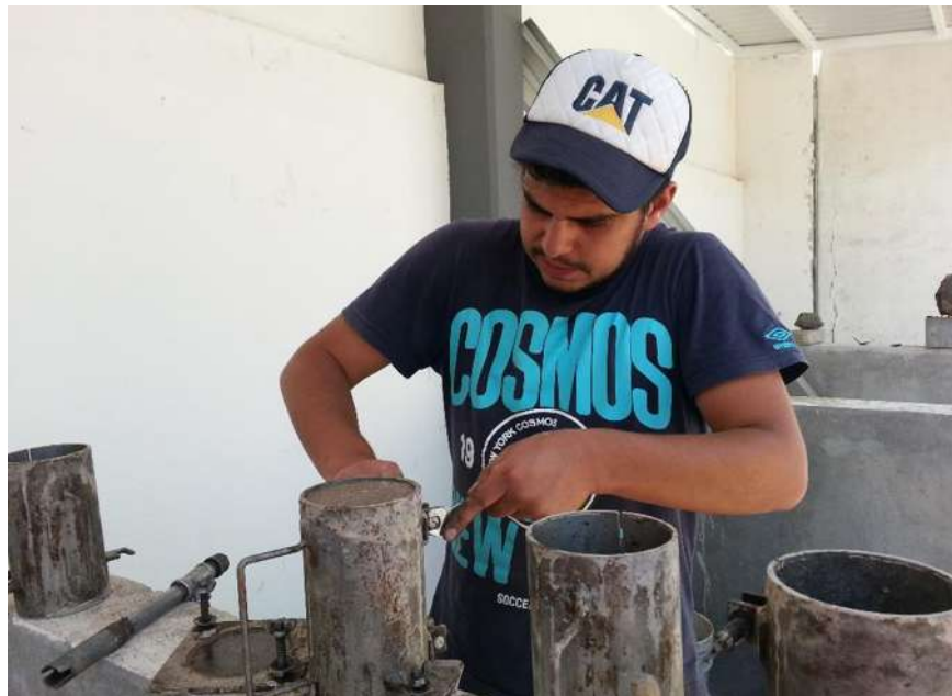
FIGURA 116. Descimbrado los especímenes.
