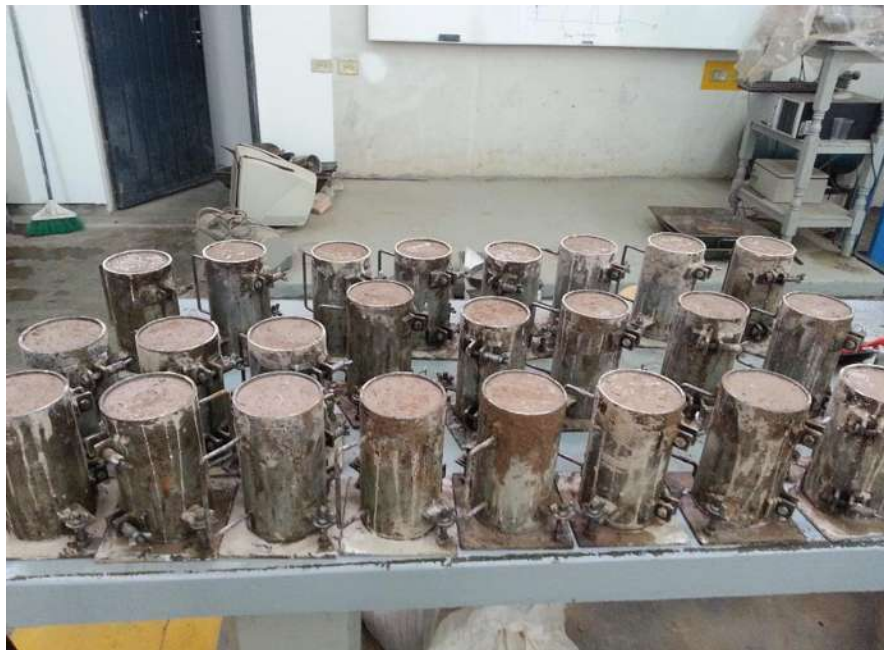
FIGURA 142. Especímenes listos para descimbrar.
