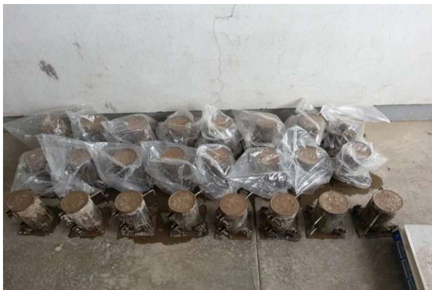
FIGURA 139. Especímenes terminados colocados en un lugar seguro y curado con bolsa húmeda.
