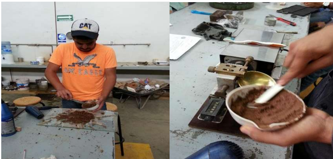
FIGURA 46. Homogenización del material en la capsula.
