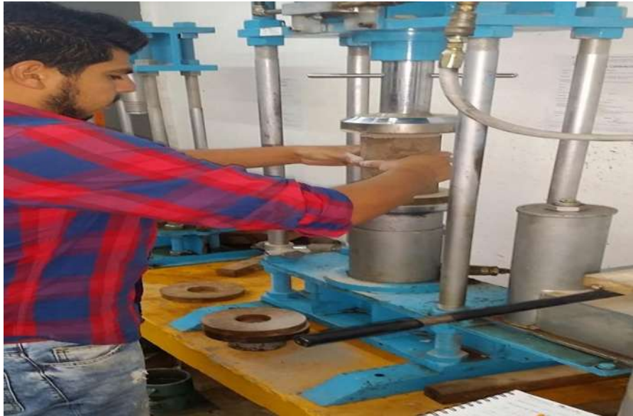
FIGURA 127. Colocación de los especímenes con la edad de 3 y 7 días en la máquina para realizar la prueba de compresión simple.
