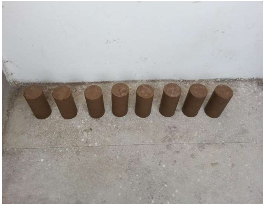
FIGURA 118. Especímenes descimbrados y colocados en un lugar seguro.
