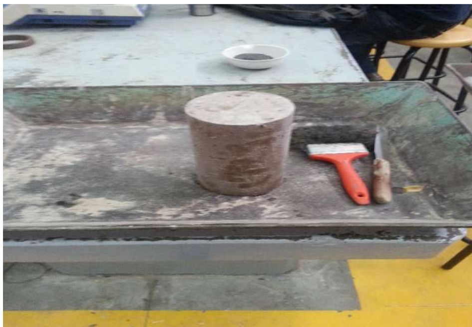
FIGURA 149. Especimen antes de ser cabeceado.
