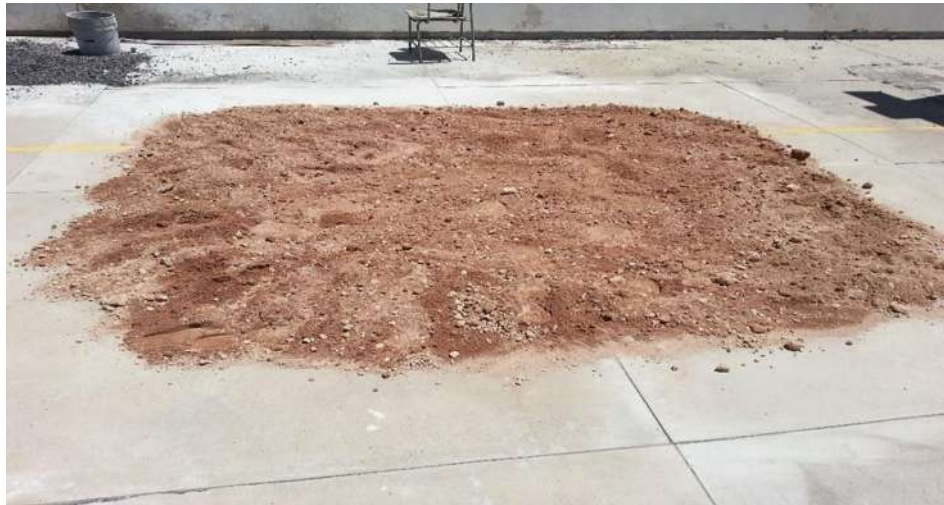
FIGURA 38. Proceso de secado al sol del material en estudio.
