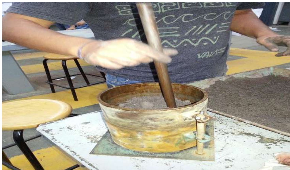
FIGURA 74. Colocación y varillado de la muestra en el molde.
