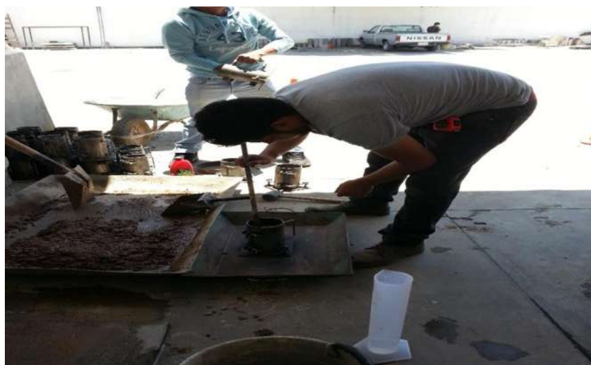
FIGURA 107. Varillado de los especímenes, 25 golpes alrededor.
