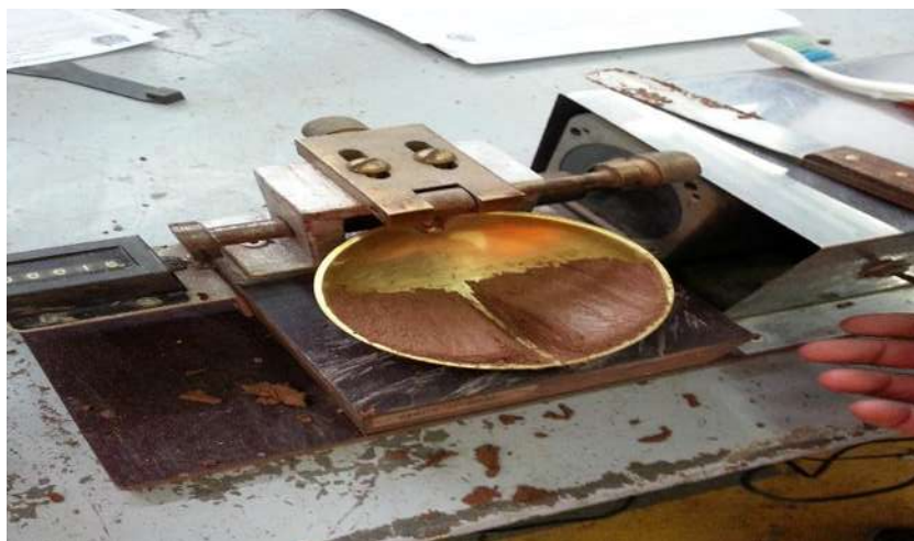
FIGURA 48. Ranura en el centro de la copa da Casagrande.
