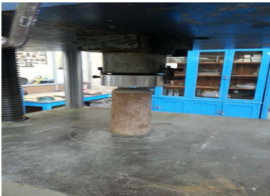
FIGURA 136. Especimen colocado en la maquina listo para probarse.
