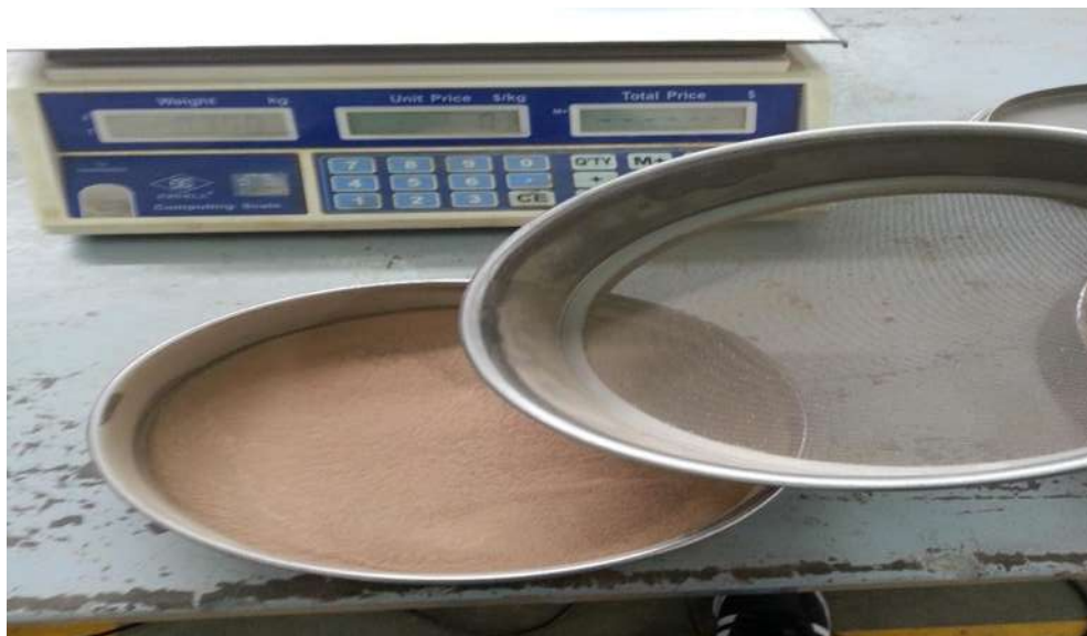
FIGURA 44. 250 gr. De material cribado por la malla N° 40.
