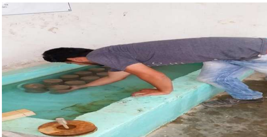
FIGURA 145. Colocando los especímenes dentro de la pila llena de agua.
