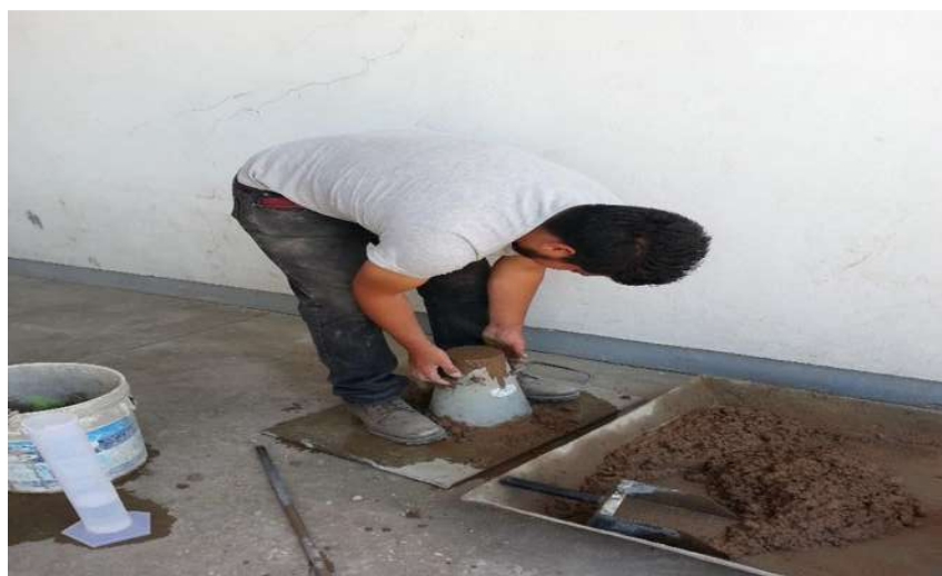
FIGURA 103. Cono enrazado listo para retirar.
