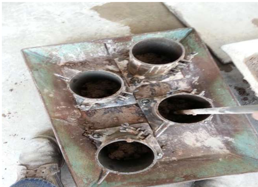
FIGURA 108. Acomodo del material con el varillado.
