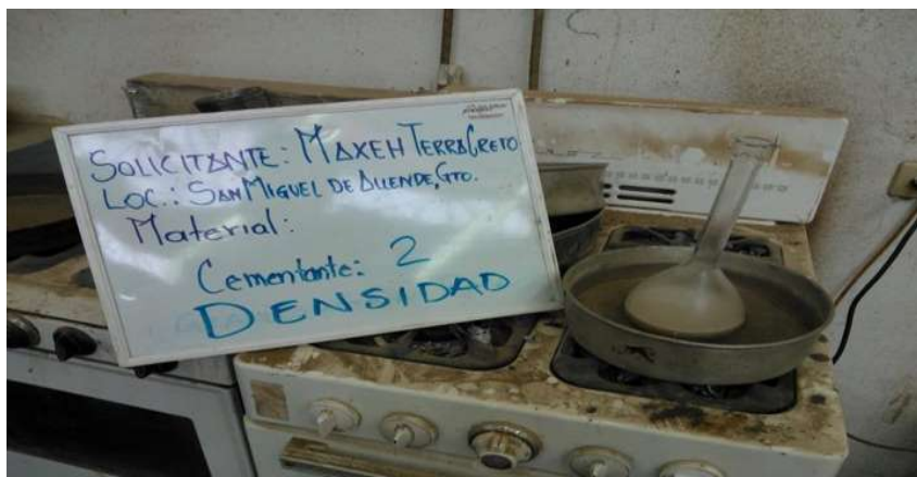
FIGURA 59. Puesta del agua de los matraces en ebullición para facilitar la expulsión del aire atrapado.
