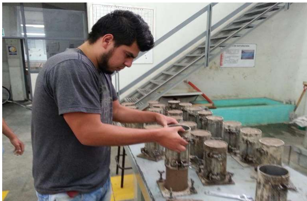
FIGURA 143. Desimbrando los especímenes.
