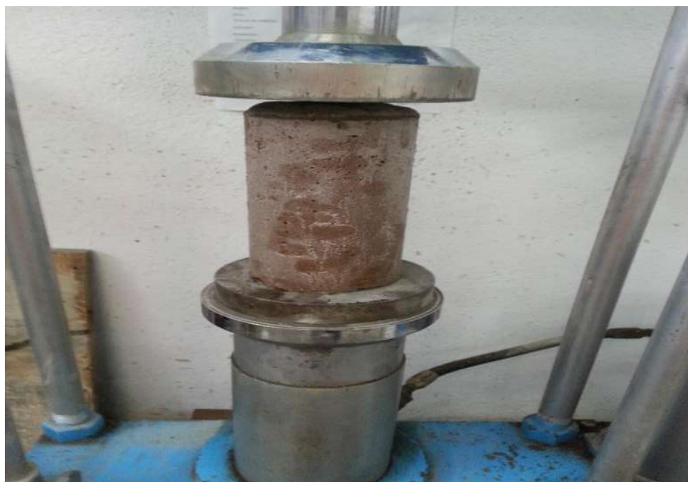
FIGURA 151. Especimen colocado en la maquina antes de aplicar la carga.
