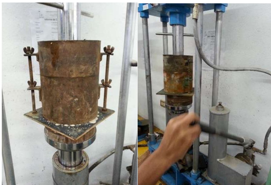
FIGURA 75. Muestra colocada en la maquina y el incremento de la carga.
