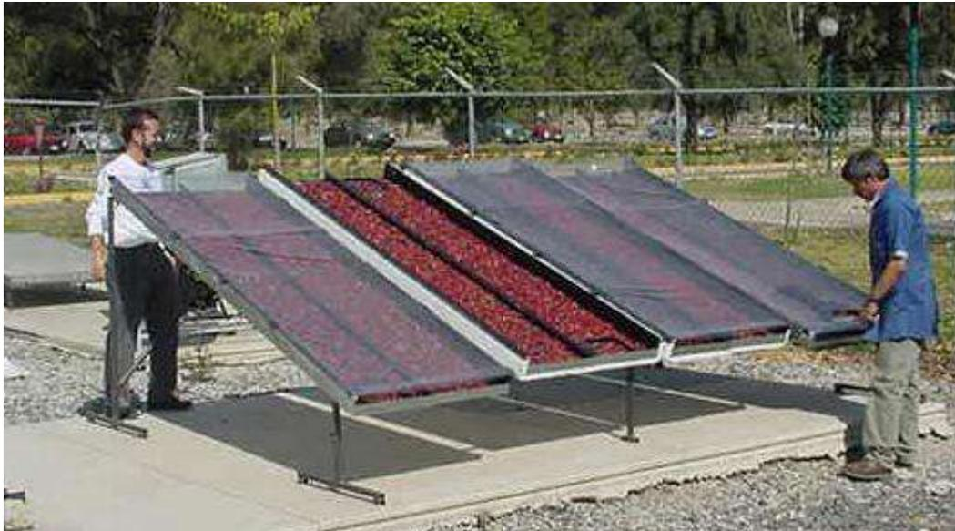
Los secadores indirectos se construyen de modo que la radiación solar es recogida por un dispositivo. Este colector solar consiste en una caja poco profunda con interiores pintados de negro y un panel de vidrio en la parte
