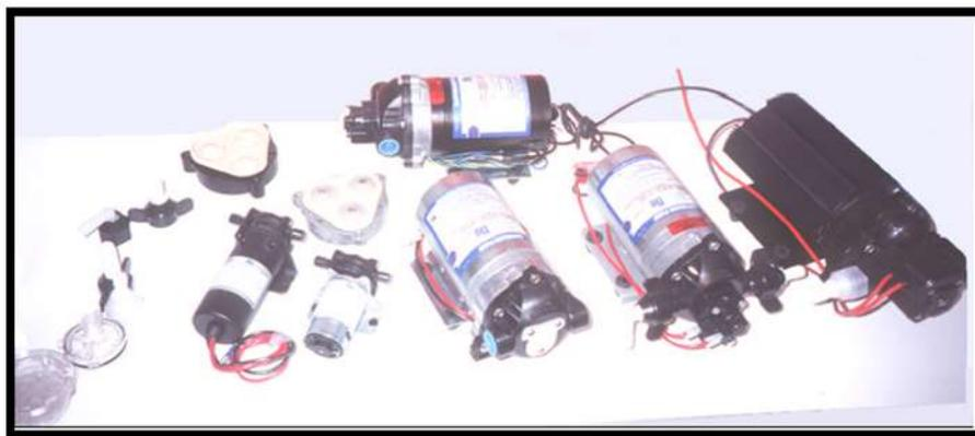
Figura. 3.20. Bomba de diafragma no sumergible. Fuente; Tecnologías y Sistemas Fotovoltaicos. Departamento de Materiales Solares, Centro de Investigación en Energía, UNAM.
