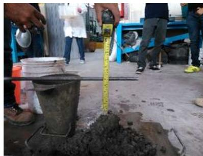
Fig 23.-Medición del revenimiento
