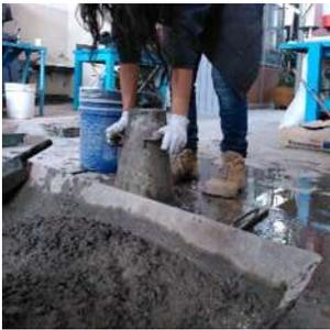
Fig 22.-levantamiento del cono
