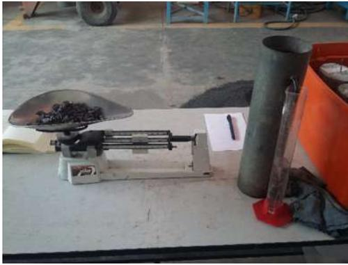
Fig 9.- equipo de medición de densidad
