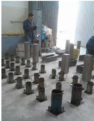
Fig 24.-Preparación de los moldes para cilindros de 15x30
