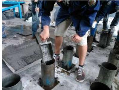
Fig 25.-Llenado en capas de los moldes
