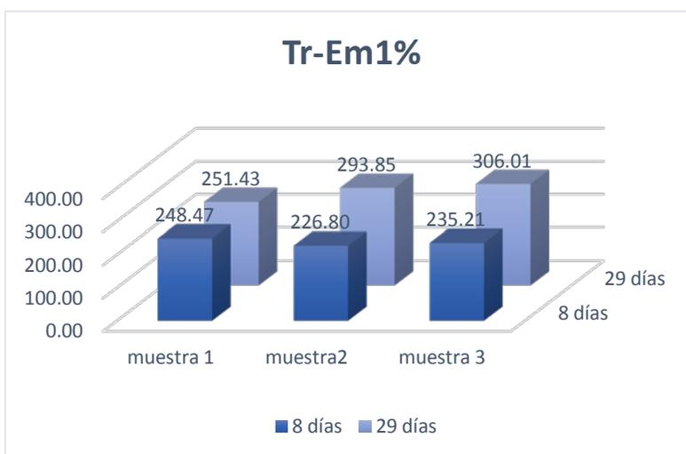
Fig 38.- Compresión de los especímenes Tr-Em 1%
