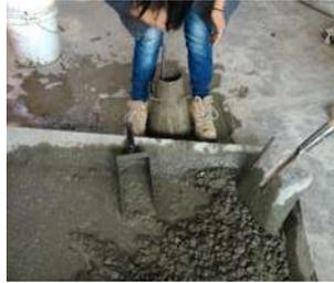
Fig 20.-Golpes con la varilla punta de bala
