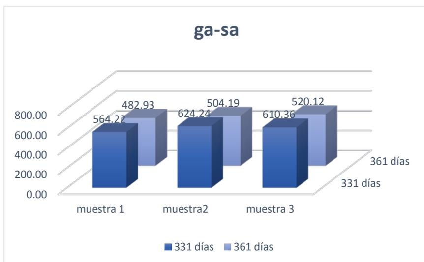
Fig 41.-Compresión de los especímenes Ga-Sa
