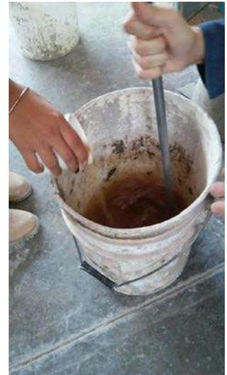
*Fig 16.-Adición del Fluidificante en agua*
