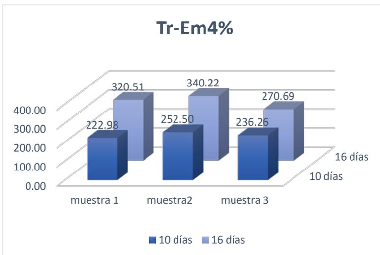
Fig 39.- Compresión de los especímenes Tr-Em 4%
