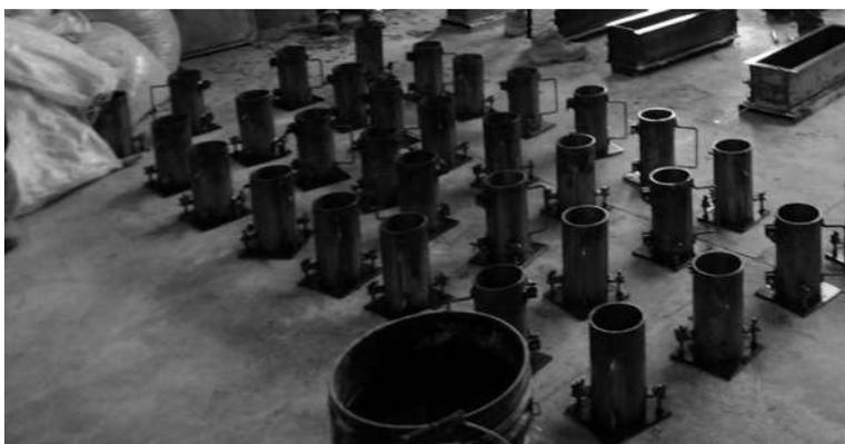
*Fig 10.-Moldes cilindricos de 10x20*
