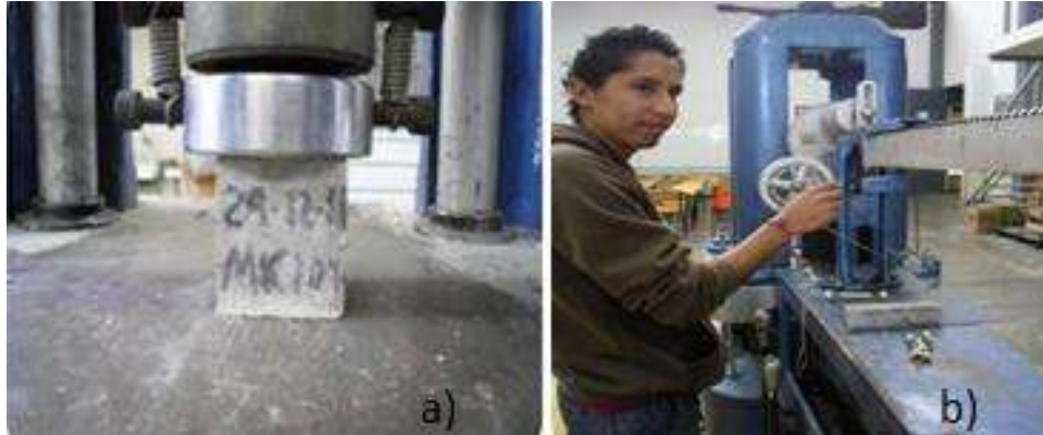
Figura 31.- Determinación del esfuerzo a la compresión en cubos: a) cubo sujeto a compresión y b) aplicación de carga de compresión (Arguello Hernández, S.del C., 2012).
