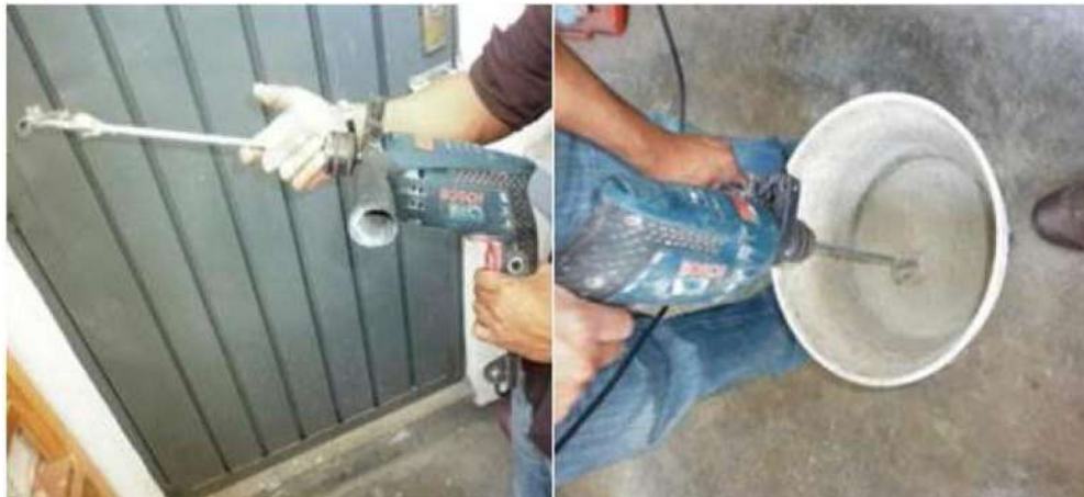
Figura 24.- Equipo y modo de mezclado (Arreola Sánchez, M., 2013).
