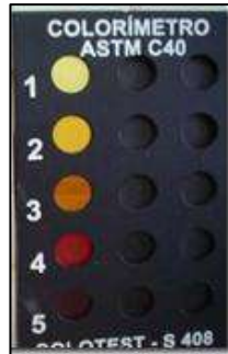
Figura 3.1. Criterio de color basado en el Hellige Tester (ASTM c-40)
