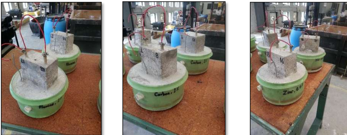
Figura 3.6. Prismas con camisa de reparación con mortero adicionado con alúmina al 1%, grafito al 1% y zinc al 0.5%
