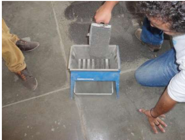
Figura 3.1. Agregado de la muestra a través del divisor. (F. Lopez, 2016)
