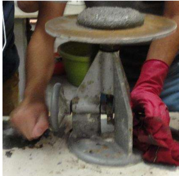
Figura 3.15. Expansión de la mezcla de forma manual, haciendo girar la leva. (F. Lopez, 2016)
