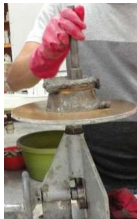
Figura 3.14. Compactación de la mezcla (F. Lopez, 2016).
