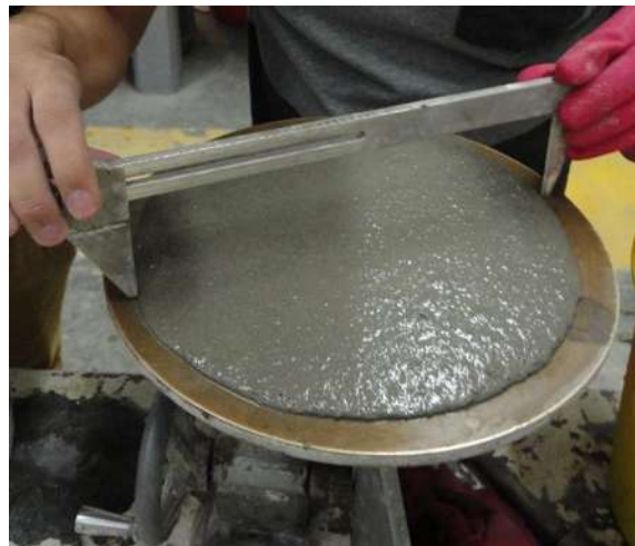
Figura 3.16. Toma de lecturas para obtener la fluidez. (F. Lopez, 2016)
