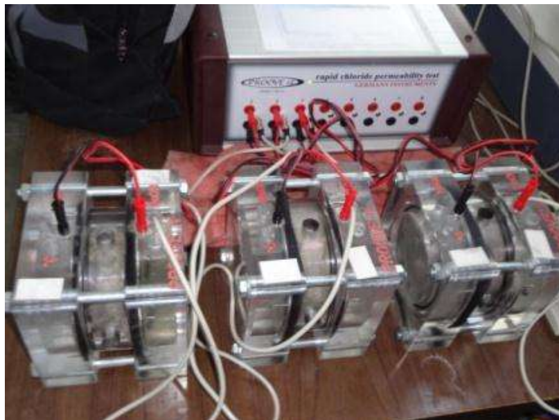
Figura 3.33. Conectado de celdas y Equipo de medición. (J. D. Alvarez, 2016)
