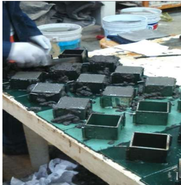
Figura 3.18. Llenado y enrazado de muestra. (J. D. Alvarez, 2016)
