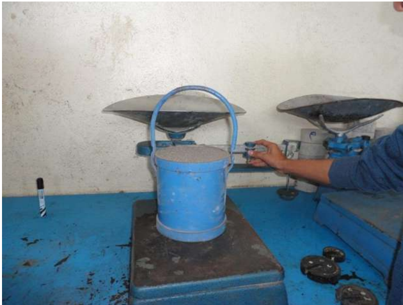
Figura 3.5. Pesado del recipiente lleno con el material. (F. Lopez, 2016).
