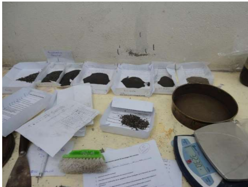
Figura 3.7. Material retenido en cada una de las mallas previamente pesado. (F. Lopez, 2016).
