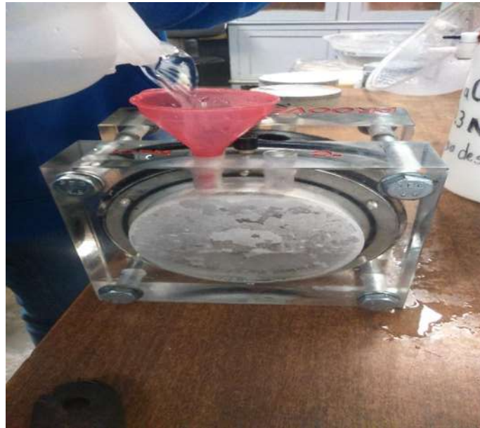
Figura 3.32. Llenado de las celdas con la solución correspondiente. (J. D. Alvarez, 2016)
