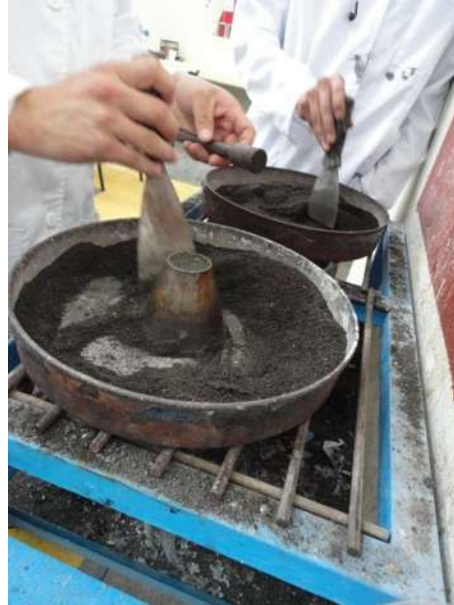
Figura 3.4. Secado superficial de la muestra mediante el molde troncocónico (F. Lopez, 2016).
