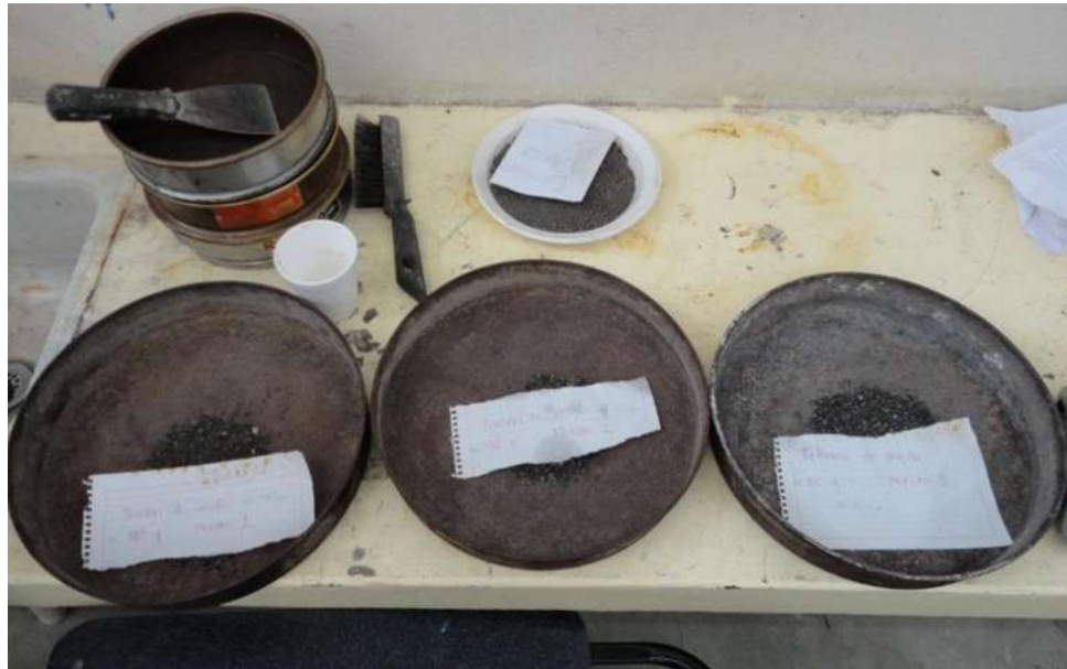
Figura 3.13. Muestras representativas para la realización de la prueba de terrones de arcilla. (F. Lopez, 2016).
