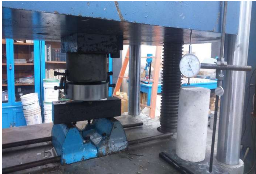
Figura 3.28. Prueba de Flexión en la muestra. (J. D. Alvarez, 2016)
