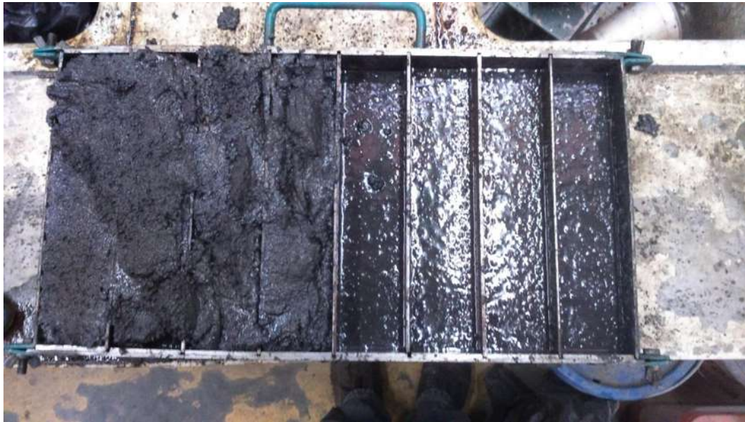
Figura 3.21. Elaboración de prismas de 6x6x26. (J. D. Alvarez, 2016)
