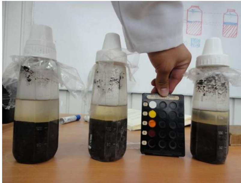
Figura 4.2. Comparación del resultado de la prueba con la tabla colorimétrica. (F. Lopez, 2016)
