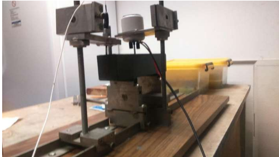
Figura 3.27. Evaluación de la frecuencia de resonancia. (J. D. Alvarez, 2016)
