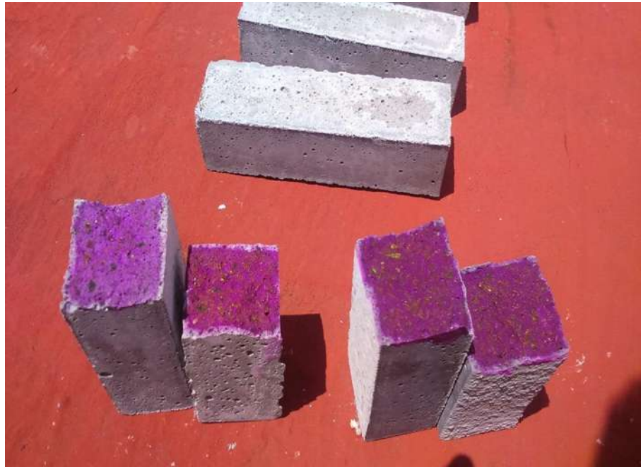
Figura 3.25. Pigmentación de la zona no carbonatada. (J. D. Alvarez, 2016)
