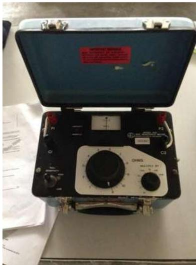
Ilustración 15 Equipo para medir la resistencia eléctrica marca Nilsson.
