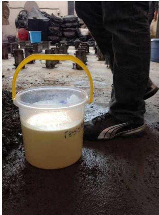
*Ilustración 8 Emulsión base poliestireno para ser adicionada.*
