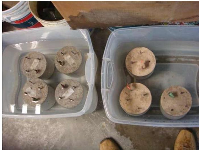
*Ilustración 9 Cilindros dentro de solución salina para el ataque de cloruros.*
