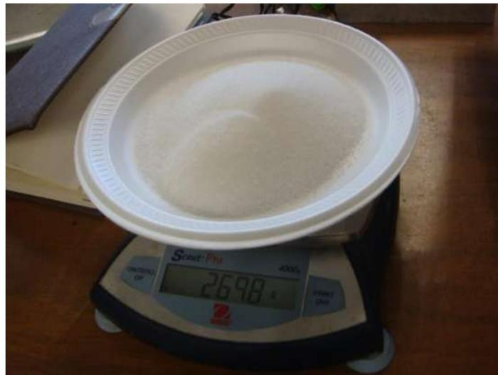
*Ilustración 13 Pesado de NaCl, para ser adicionado al agua.*
