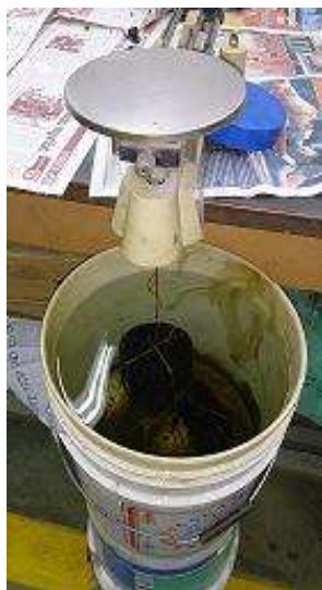
Fig.- 8.2.16 – Peso de patilla en agua
