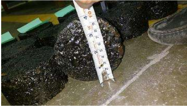
Figura 9.4.2. Dimensiones del espécimen
