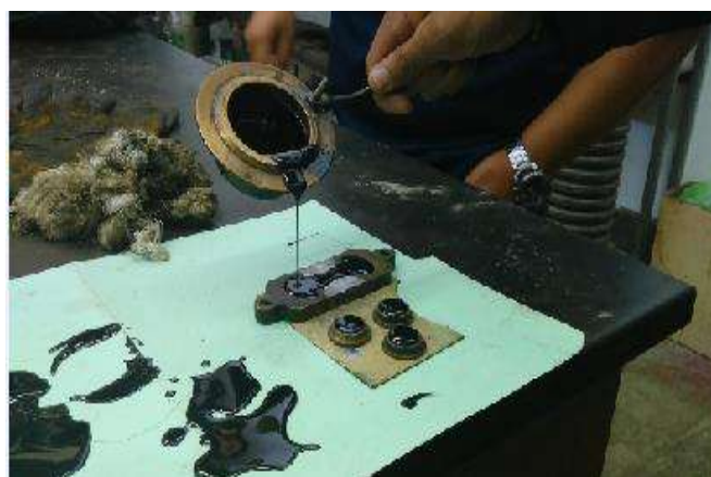
Fig.- 7.5.3-Vaciado del cemento Asfaltico
