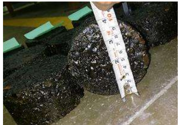
Fig.- 8.2.20 Y 8.2.21 – DEFORMACION DE PASTILLAS SOMETIDAS A PRUEBA MARSHALL
