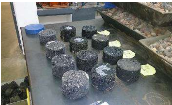
9.3.2.- Resultado de Pastillas sometidas a congelamiento
