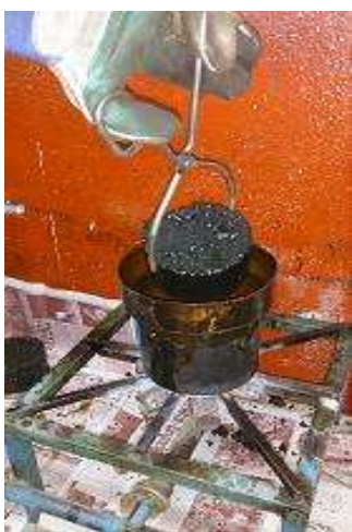
Fig.- 8.2.14 – Sellado de pastilla con parafina.
