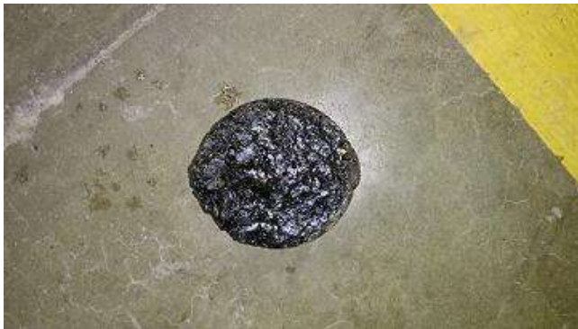
Fig.- 8.2.20 Y 8.2.21 – DEFORMACION DE PASTILLAS SOMETIDAS A PRUEBA MARSHALL
