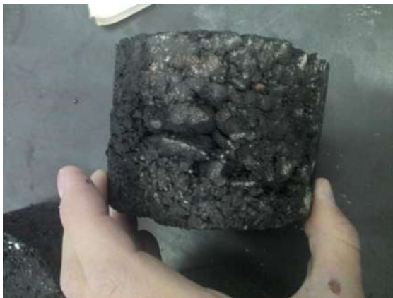
Figura 9.4.8. Pastilla con falla aparente sometida a prueba de compresión de esfuerzo.
