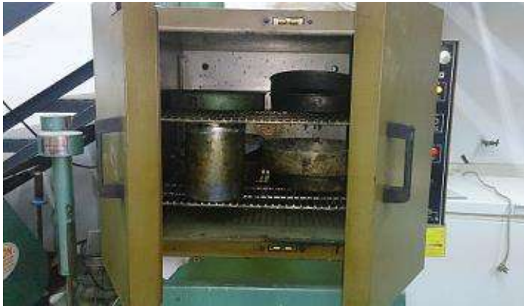
9.2.1 Calentamiento de moldes y material pétreo.
