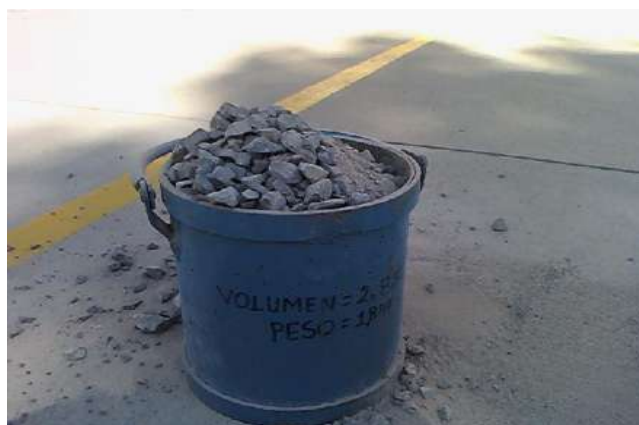
Fig.- 6.2.1.- Llenado de recipiente para prueba.
