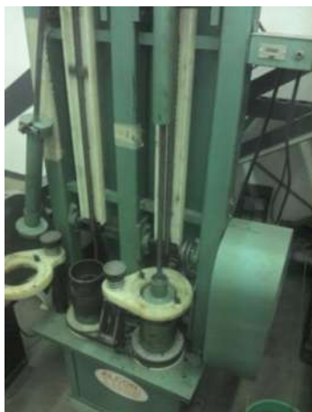
Fig.- 8.2.8 – Compactación de material mezclado
