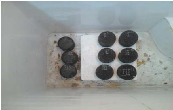
9.3.1.- Congelado de las pastillas a temperatura 0°C.
