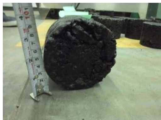
Fig.- 8.2.20 Y 8.2.21 – DEFORMACION DE PASTILLAS SOMETIDAS A PRUEBA MARSHALL
