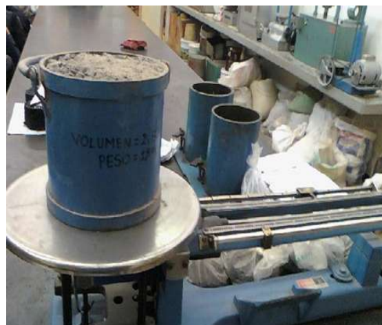
Fig. 6.2.4.- Peso de Material y Bote
