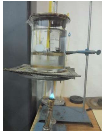
Fig.- 7.4.5 -Baño de agua con balín.
