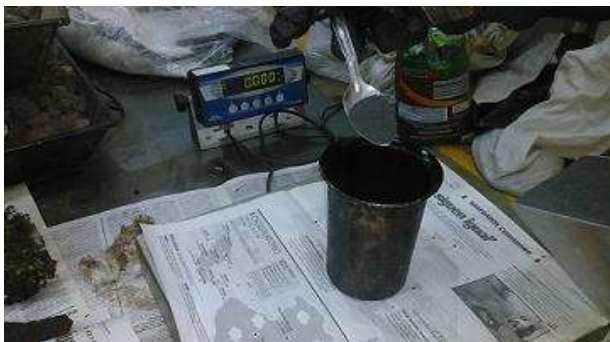
9.2.5.- Vertido de caucho en C.A. proporcional al % de material fino.
