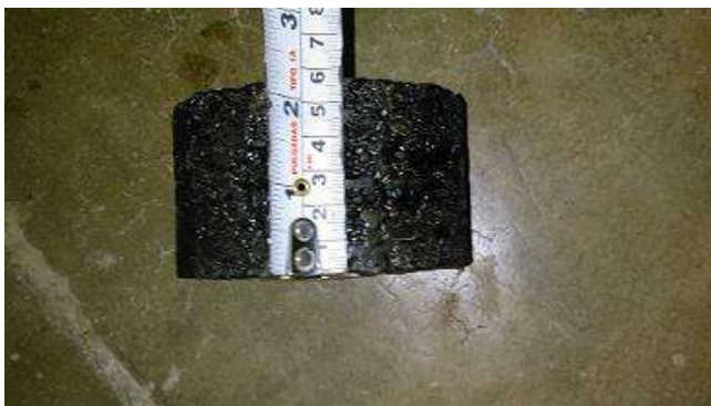
Fig.- 8.2.20 Y 8.2.21 – DEFORMACION DE PASTILLAS SOMETIDAS A PRUEBA MARSHALL
