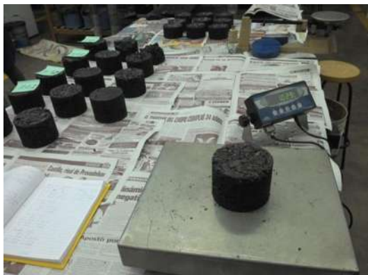
Fig.- 8.2.12 – Peso de la pastilla en aire.
