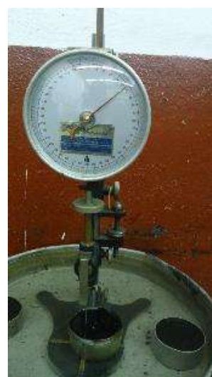
Fig.- 7.2.4- Capsula en penetrometro.
