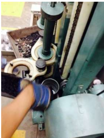
9.2.7.- Vertido de la mezcla al molde para compactación.
