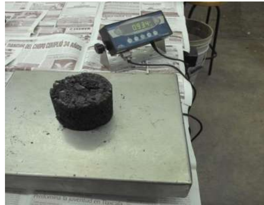
Figura 9.4.3 Peso del espécimen
