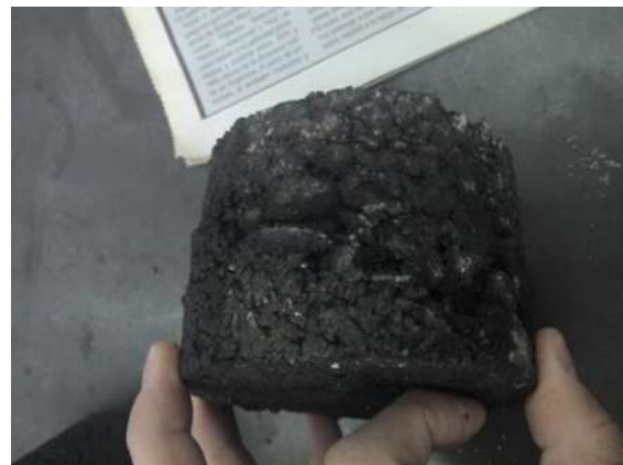
Figura 9.4.8. Pastilla con falla aparente sometida a prueba de compresión de esfuerzo.
