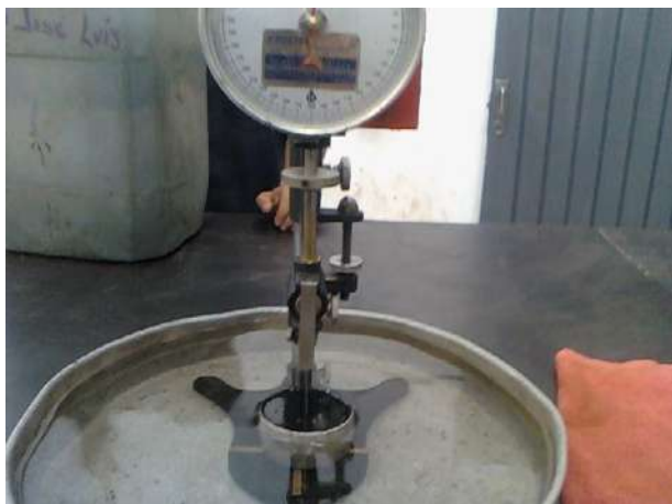
Fig.- 7.2.5- Prueba de penetración.
