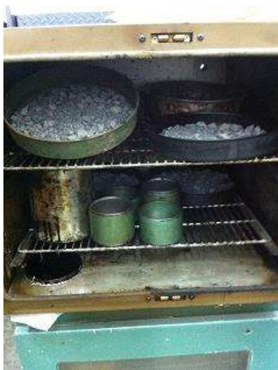
Fig.- 8.2.4 – Calentamiento de material pétreo
