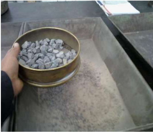
Fig. 6.3.1.- Cribado de material
