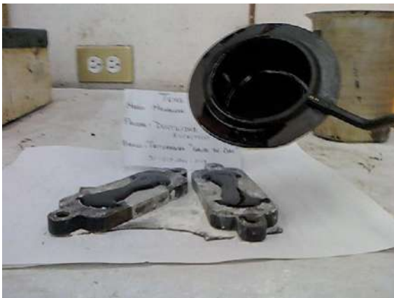
Fig. 3.14.- Vaciado del cemento.
