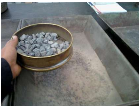
Fig. 2.11.- Cribado de material.
