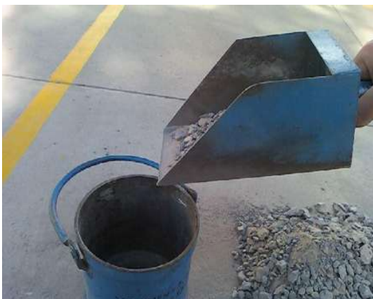
Fig. 2.9.- Llenado de Material.
