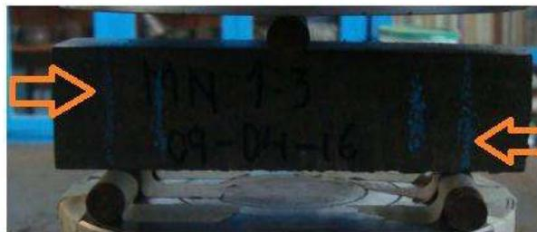
**Figura 3. 65.** Marca de crayola en los extremos del prisma para los apoyos (V. H. Blancas Herrera, 2017).
