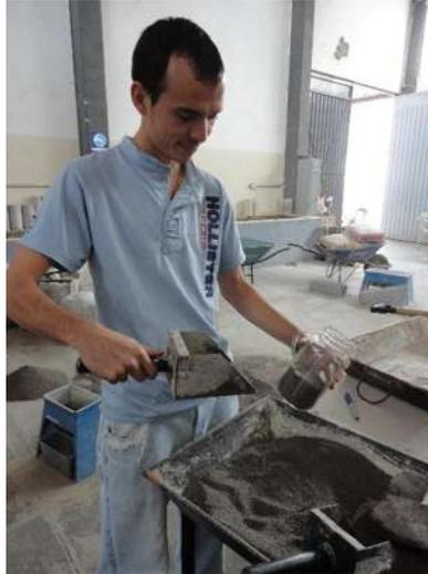
**Figura 3. 21.** Incorporación del agregado al recipiente (V. H. Blancas Herrera, 2017).
