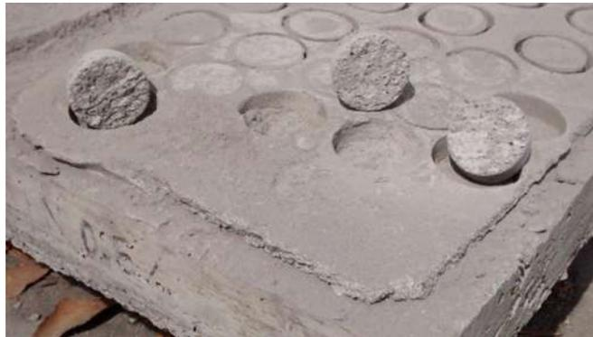
*Figura 3. 79. Resultados de la prueba Pull Off (V. H. Blancas Herrera, 2017).*
