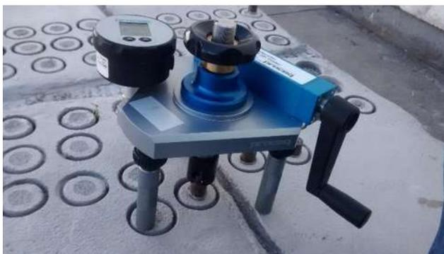
**Figura 3. 77.** Colocación del equipo Pull Off por encima del perno a tensionar (V. H. Blancas Herrera, 2017).
