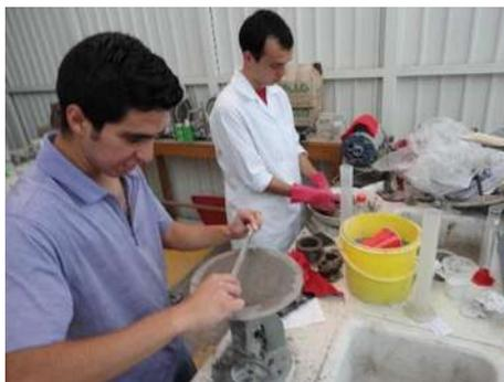
**Figura 3. 33.** Medición del diámetro de la mezcla (V. H. Blancas Herrera, 2017).
