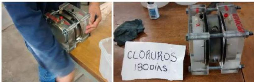
**Figura 3. 86.** Colocación del disco de mortero en las celdas de cloruros (V. H. Blancas Herrera, 2017).
