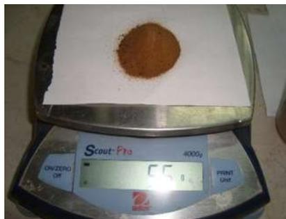
**Figura 3. 28.** Medición de la cantidad de aditivo requerida (V.H. Blancas Herrera, 2017).
