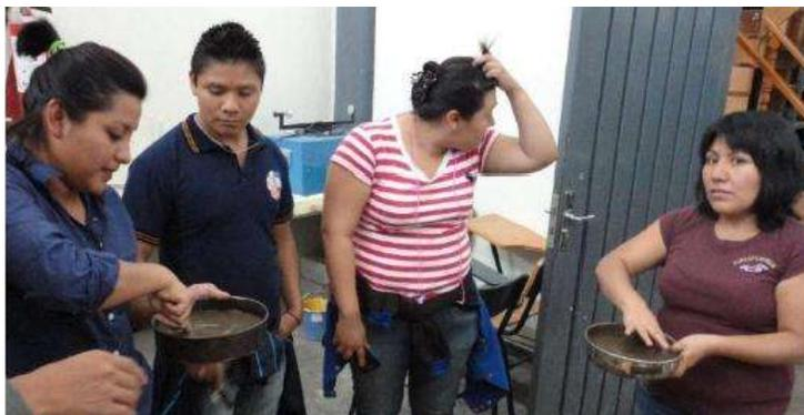
Figura 3. 24. Desintegración de los terrones de arcilla. (V. H. Blancas Herrera, 2017).
