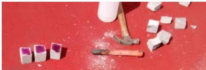
Figura 3. 93. Corte en la cara transversal de la muestra y colocación del indicador ácido-base (V. H. Blancas Herrera, 2017).
