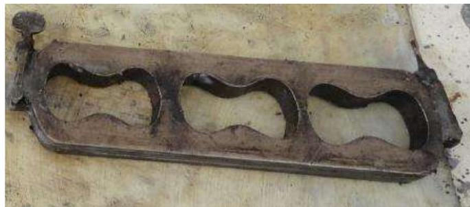
Figura 3. 44. Molde para la fabricación de briquetas (V.H. Blancas Herrera, 2017).
