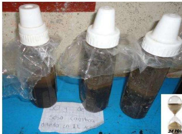
**Figura 3. 19.** Muestras de arena después de 24 horas en reposo (V.H. Blancas Herrera, 2017).
