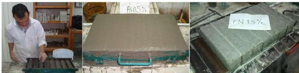
**Figura 3. 89.** Elaboración de especímenes prismáticos para la prueba de congelamiento y deshielo (V. H. Blancas Herrera, 2017).
