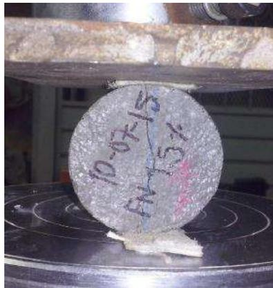
Figura 3. 75. Resultado de la prueba de tensión indirecta, donde se presenta la falla (V. H. Blancas Herrera, 2017).
