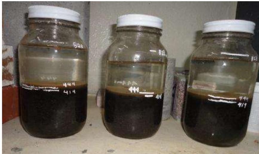
Figura 4. 3. Resultados de la prueba de sedimentación (V. H. Blancas Herrera, 2017).
