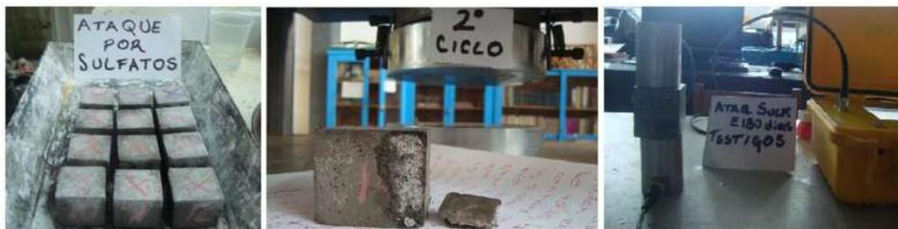
**Figura 3. 82.** Extracción y aplicación de pruebas físico-mecánicas a las muestras (V. H. Blancas Herrera, 2017).
