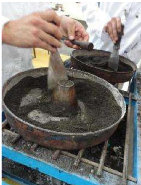
**Figura 3. 9.** Secado superficial de la muestra mediante el molde troncocónico (V. H. Blancas Herrera, 2017).
