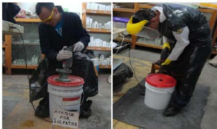
**Figura 3. 80.** Preparación de la solución de sulfato de sodio (V. H. Blancas Herrera, 2017).
