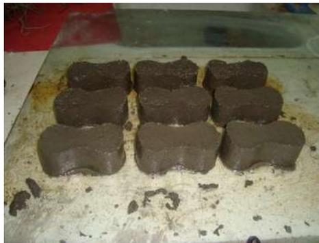
**Figura 3. 47.** Fraguado de la mezcla en forma de briquetas (V. H. Blancas Herrera, 2017).
