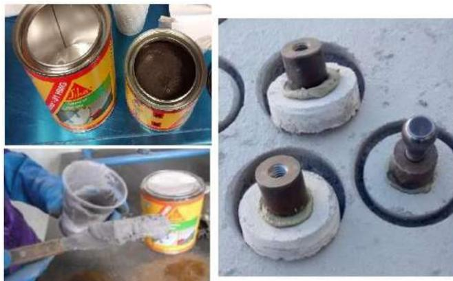
**Figura 3. 76.** Pegado de los discos de acero mediante el uso de epóxico (V. H. Blancas Herrera, 2017).
