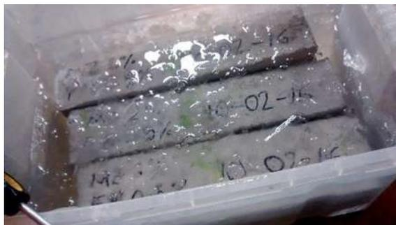
**Figura 3. 92.** Proceso de deshielo, después de sacar los especímenes del enfriador (V. H. Blancas Herrera, 2017).
