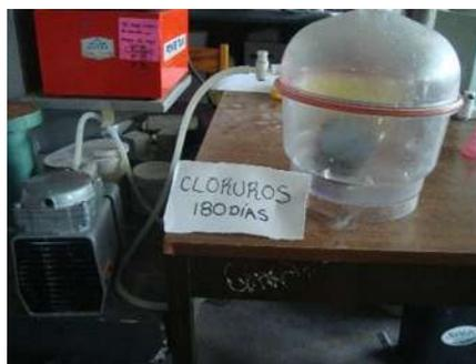
*Figura 3. 85. Obtención de vacío dentro del desecador (V. H. Blancas Herrera, 2017).*
