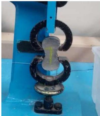
*Figura 3. 70. Briqueta sujeta por las mordazas de la máquina de prueba (V. H. Blancas Herrera, 2017).*
