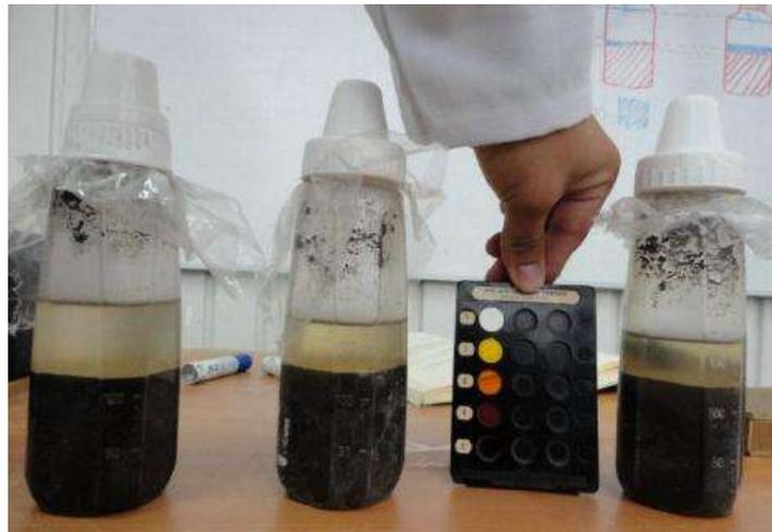
*Figura 4. 2. Comparación del color de las muestras con la tabla colorimétrica (V. H. Blancas Herrera, 2017).*
