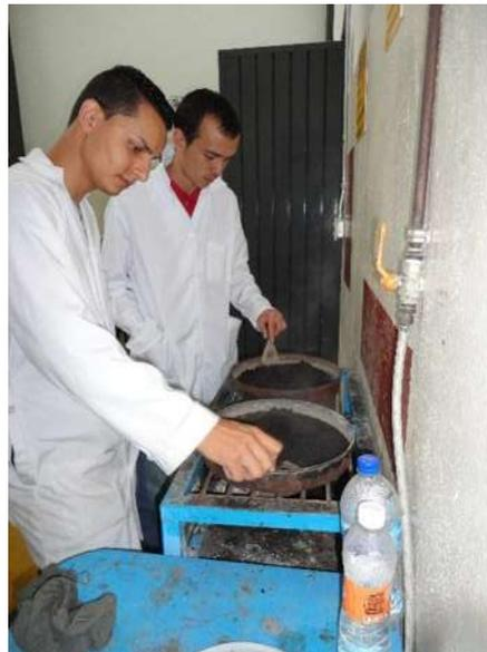
***Figura 3. 8.*** Secado del material, para la obtención de la Humedad actual (V.H. Blancas Herrera, 2017).
