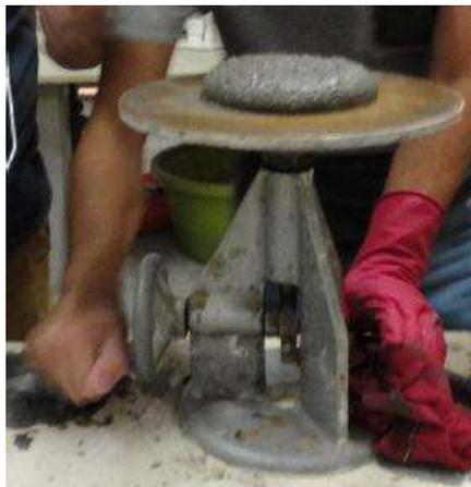
**Figura 3. 32.** Expansión de la mezcla de forma manual, haciendo girar la manivela (V. H. Blancas Herrera, 2017).
