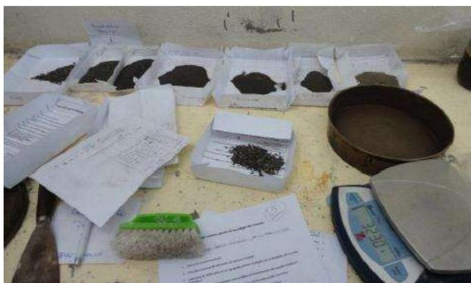
**Figura 3. 15.** Material retenido en cada una de las mallas previamente pesado (V.H. Blancas Herrera, 2017).
