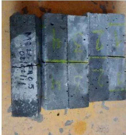
**Figura 3. 69.** Resultados de la prueba de flexión estática. Tipo de ruptura al centro (V. H. Blancas Herrera, 2017).
