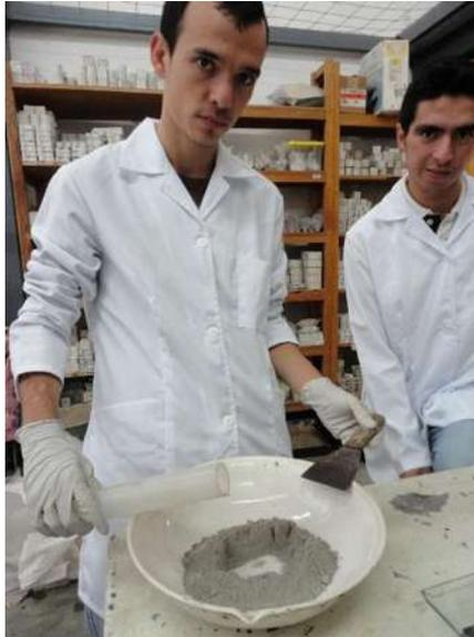
**Figura 3. 3.** Caída del agua sobre el cráter de cemento (V. H. Blancas Herrera, 2017).
