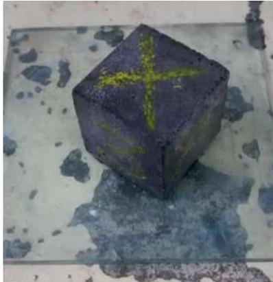
**Figura 3. 59.** Identificación de la cara más plana del espécimen cubico (V. H. Blancas Herrera, 2017).
