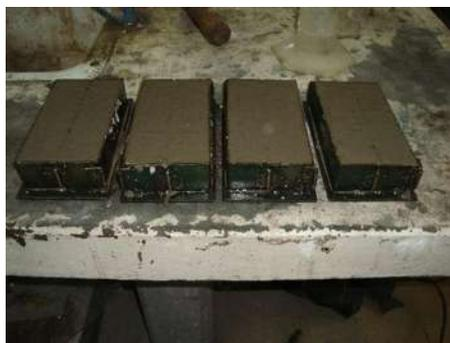
*Figura 3. 50. Enrazado de los prismas (V. H. Blancas Herrera, 2017).*
