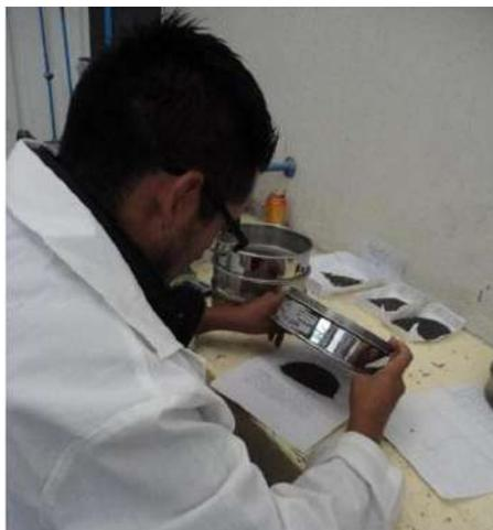
**Figura 3. 14.** Extracción del material retenido en cada una de las malla (V.H. Blancas Herrera, 2017).
