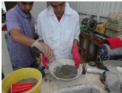
**Figura 3. 30.** Elaboración de mezcla de mortero, partiendo de una relación a/c baja (V.H. Blancas Herrera, 2017).
