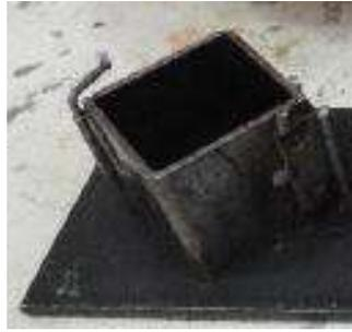
*Figura 3. 38. Molde para elaboración de cubo (V. H. Blancas Herrera, 2017).*
