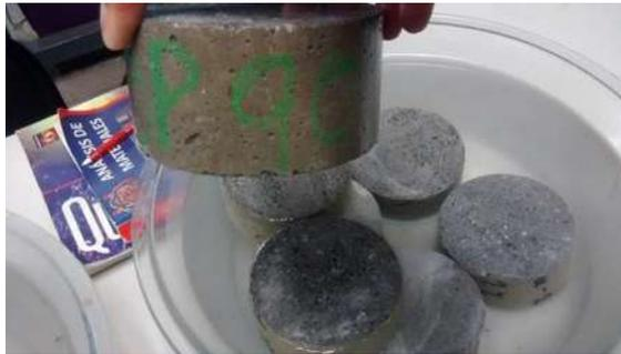
**Figura 3. 84.** *Discos de mortero para la prueba (V. H. Blancas Herrera, 2017).*
