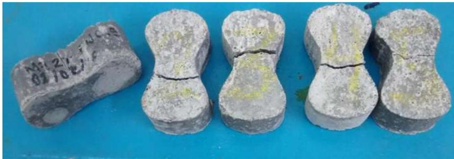
**Figura 3. 72.** Resultados de la prueba de tensión directa en morteros (V. H. Blancas Herrera, 2017).
