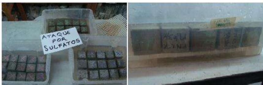
**Figura 3. 81.** Colocación de las muestras en los recipientes con solución (V. H. Blancas Herrera, 2017).
