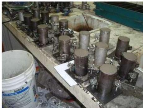
*Figura 3. 48. Enrazado de los cilindros (V. H. Blancas Herrera, 2017).*
