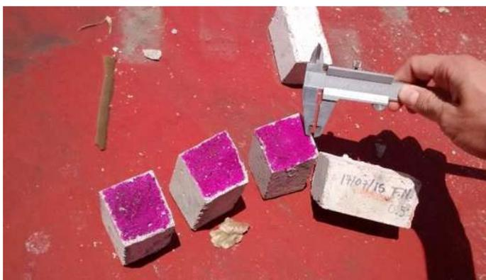
Figura 3. 94. Medición de la profundidad de carbonatación (V. H. Blancas Herrera, 2017).
