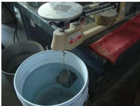
**Figura 3. 58.** *Espécimen sumergido con ayuda de la canastilla (V. H. Blancas Herrera, 2017).*
