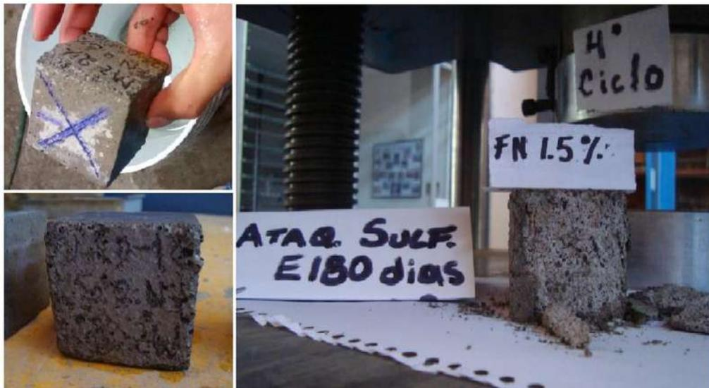
**Figura 3. 83.** Resultados de la prueba de ataque por sulfatos (V. H. Blancas Herrera, 2017).
