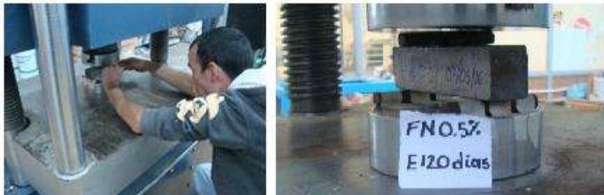
**Figura 3. 66.** Colocación del espécimen en la máquina universal de pruebas (V. H. Blancas Herrera, 2017).
