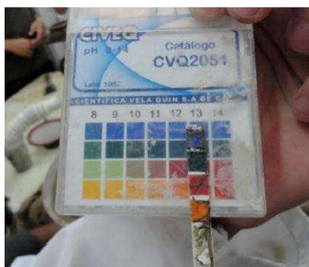
**Figura 4. 4.** Resultados del pH en el mortero fresco (V. H. Blancas Herrera, 2017).
