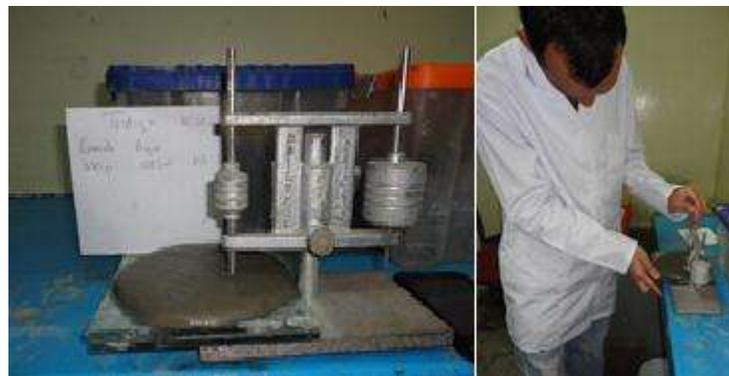
**Figura 3. 5.** Medición del tiempo de fraguado, fraguado inicial (V.H. Blancas Herrera, 2017).
