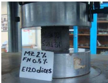
**Figura 3. 64.** Aplicación de la carga axial en el espécimen (V. H. Blancas Herrera).
