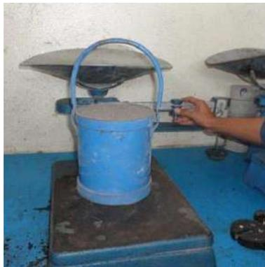
**Figura 3. 11.** Determinación de la masa del material en el recipiente (V. H. Blancas Herrera, 2017).
