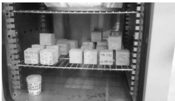
**Figura 3. 95.** Secado de los especímenes hasta masa constante (V. H. Blancas Herrera, 2017).
