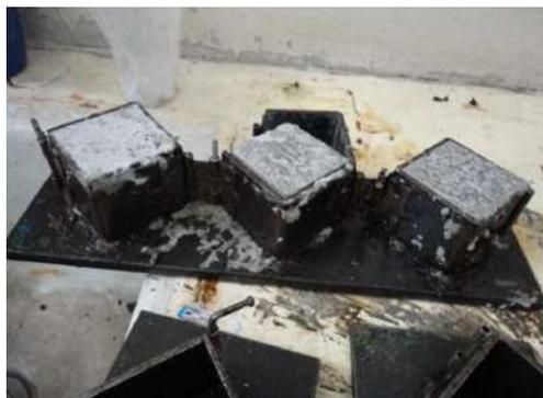
**Figura 3. 42.** Desmolde del cubo (V.H. Blancas Herrera, 2017).
