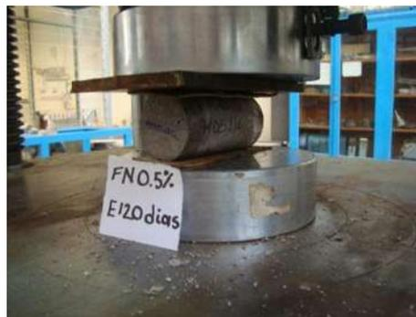
**Figura 3. 74.** *Aplicación de la carga sobre el espécimen (V. H. Blancas Herrera, 2017).*
