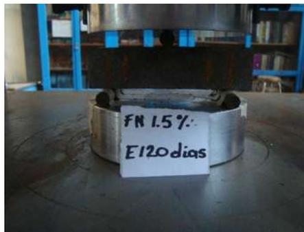
**Figura 3. 67.** Aplicación de la carga sobre el espécimen (V. H. Blancas Herrera, 2017).
