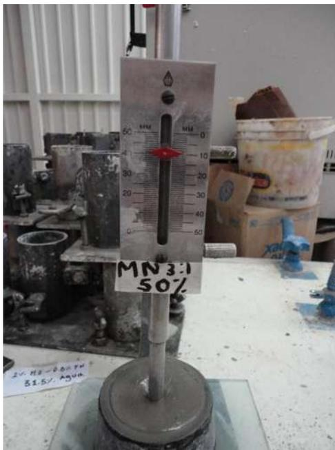
Figura 11. Ensayo de consistencia normal para pastas usando la aguja de Vicat (Bautista León, 2015)
