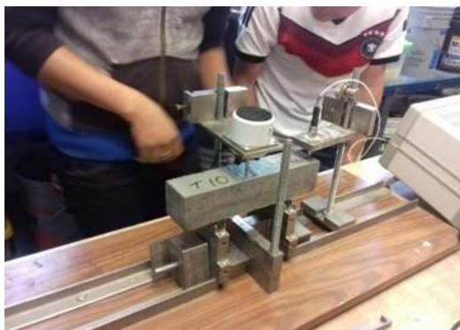
Figura 72. Prueba de frecuencia de resonancia (Bautista León, 2016)
