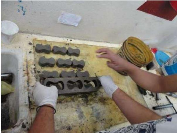
*Figura 54. Elaboración de probetas en forma de maní con molde de bronce que se puede desmoldar al instante (Villanueva Guzmán, 2015)*
