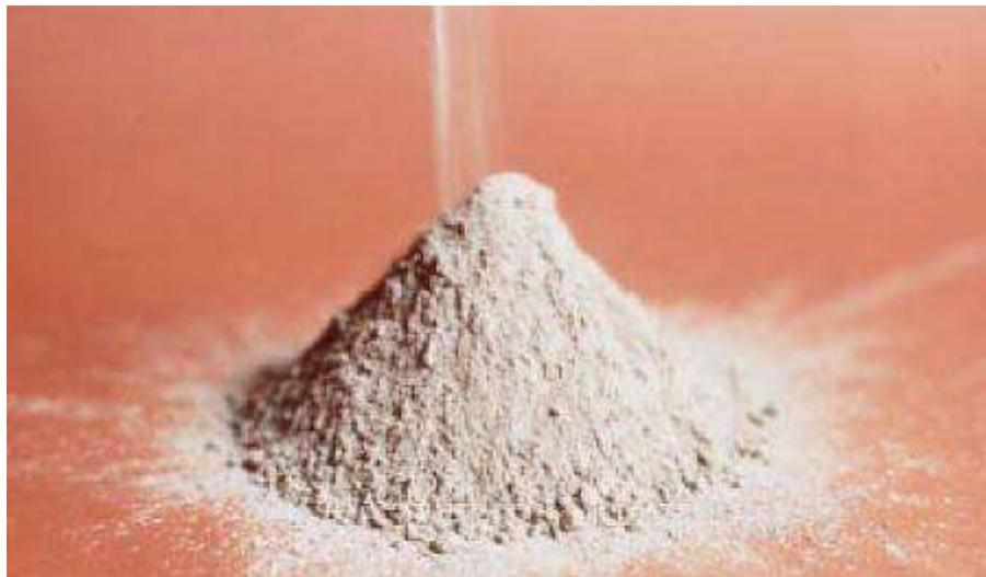
Figura 1. Cemento Portland, compuesto por silicatos hidráulicos (Kosmatka, et al, 2004, pág. 25)
