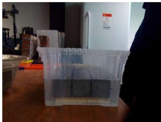
Figura 73. Probetas listas para ser introducidos al frigorífico durante 4 h (Bautista León, 2016)
