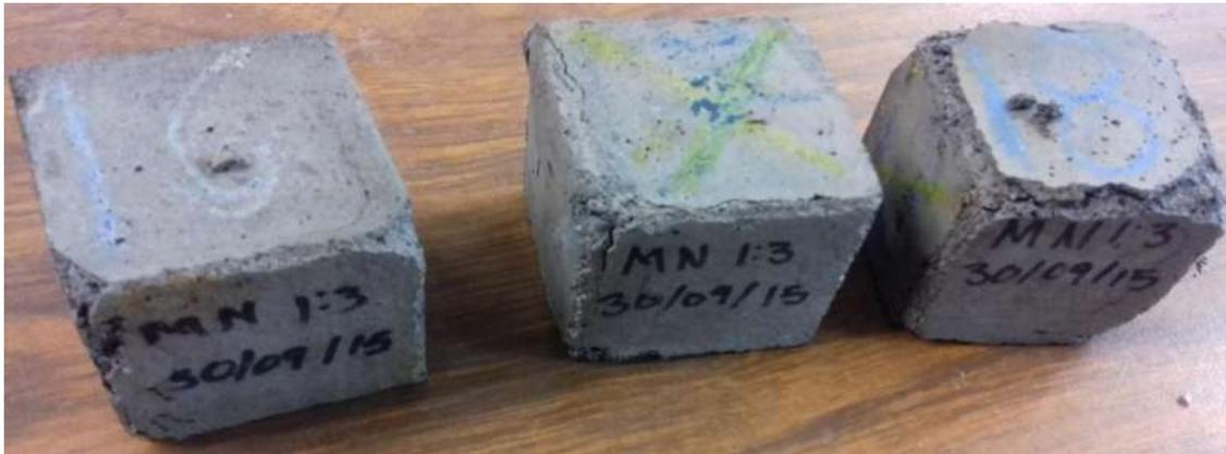
Figura 69. Probetas de la mezcla “MN 1:3” en el último ciclo, después de la prueba de compresión (Bautista León, 2015)
