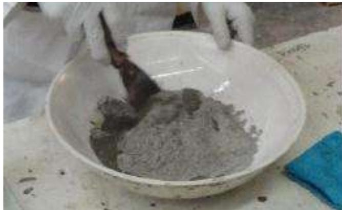
Figura 25. Mezclado de cemento con líquido de amasado, (López Regalado, 2016)
