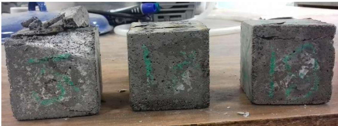
Figura 68. Probetas de la mezcla “MN 1:2” en el último ciclo, después de la prueba de compresión (Bautista León, 2015)
