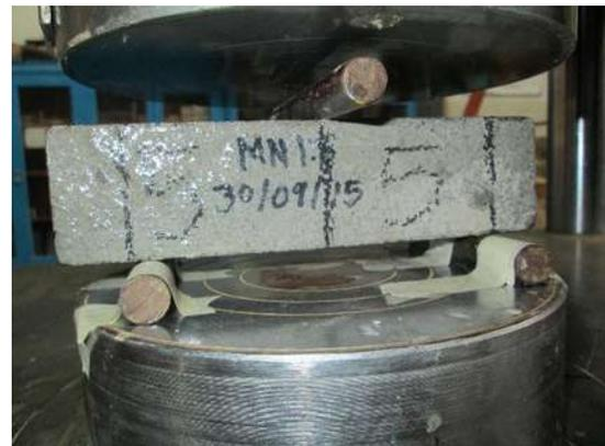
Figura 59. Aplicación de carga al centro de la viga (Bautista León, 2015)
