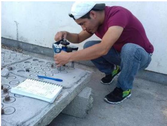
*Figura 63. Determinación de la resistencia al despegue con el equipo Pull-off (Bautista León, 2015)*
