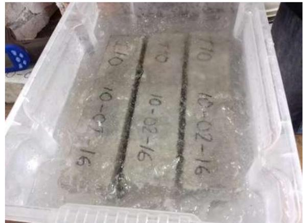
Figura 74. Probetas envueltas de hielo en el ciclo seis (Bautista León, 2016)
