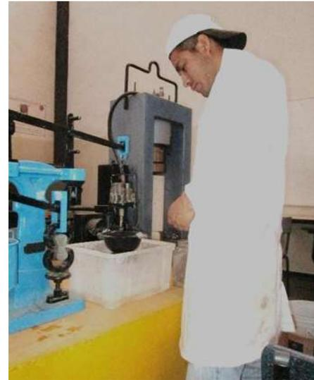
Figura 60. Ejecución de la prueba de tensión directa (Bautista León, 2015)
