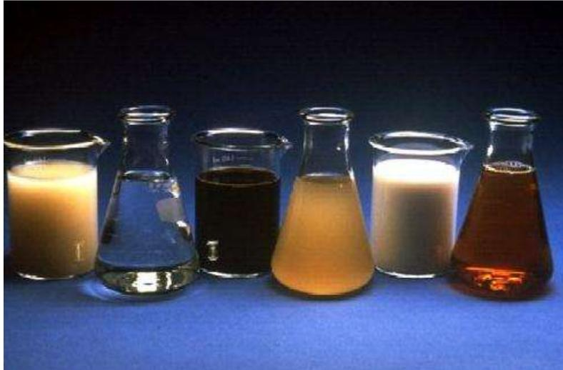
Figura 16. Aditivos líquidos, de izquierda a derecha: aditivo antideslave, reductor de retracción, reductor de agua, agente espumante, inhibidor de corrosión e incorporador de agua (WWW.ARQHYS.COM)
