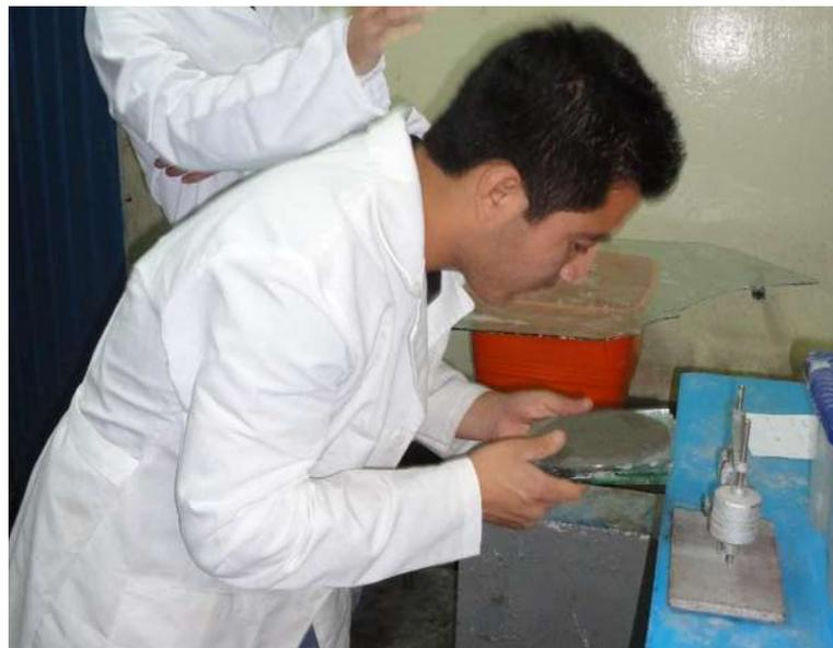
*Figura 27. Determinación de tiempos de fraguado (Bautista León, 2016)*
