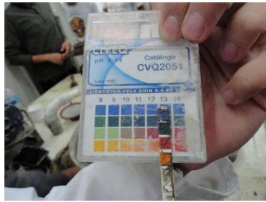
Figura 49. Determinación de pH de las mezclas (Bautista León, 2015)
