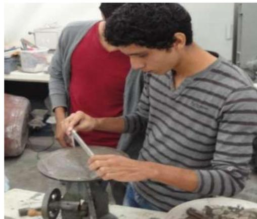
Figura 47. Toma de medidas distribuidas simétricamente para la obtención de fluidez (Bautista León, 2015)
