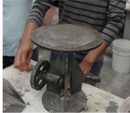
Figura 46. Expansión de la mezcla manualmente girando la leva (Bautista León, 2015)
