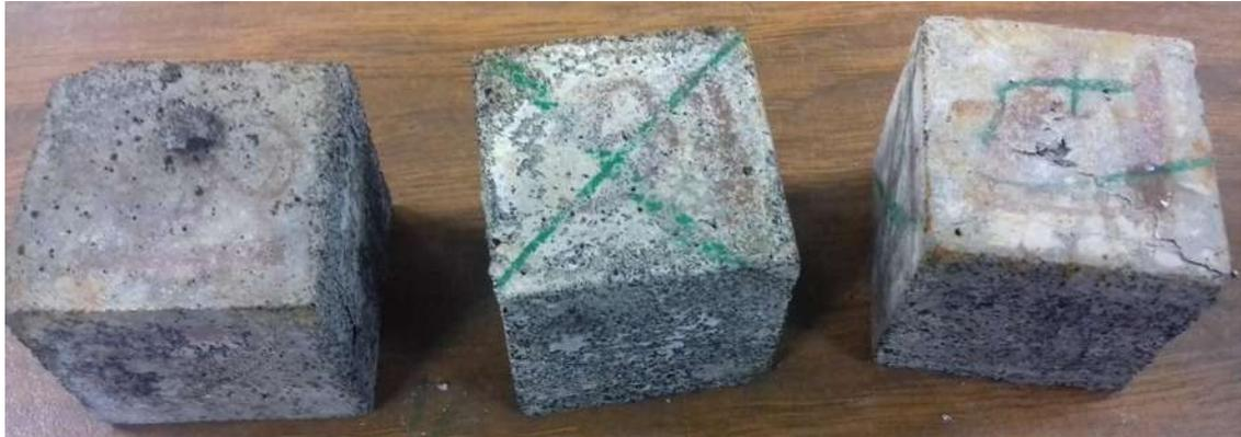
Figura 67. Probetas de la mezcla “Control” en el último ciclo, después de la prueba de compresión (Bautista León, 2015)
