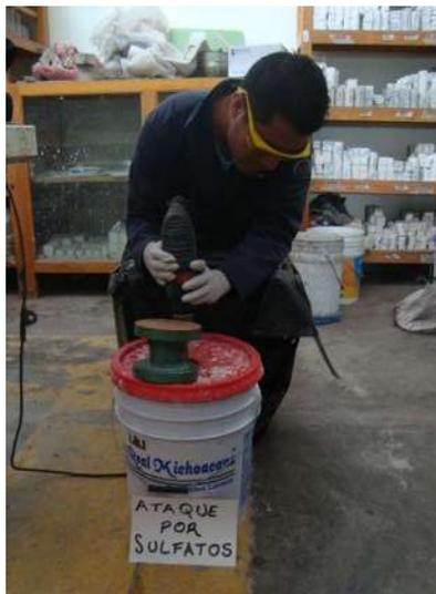
Figura 66. Preparación de solución de sulfato de sodio (Bautista León, 2015)
