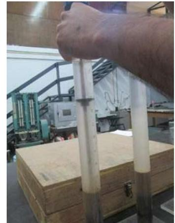
Figura 40. Introducción de tubo agitador para obtener la lectura de arena (Bautista León, 2015)
