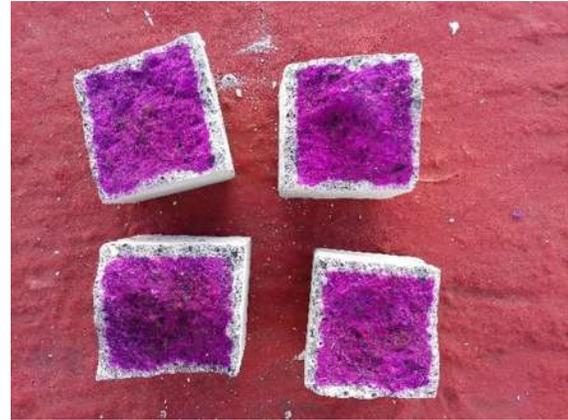
Figura 76. Aplicación de fenolftaleína para verificar la carbonatación (Bautista León, 2015)
