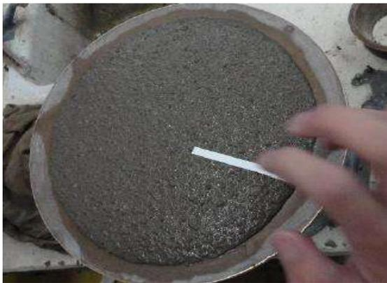
Figura 48. Determinación de pH mediante papel indicador (López Regalado, 2015)
