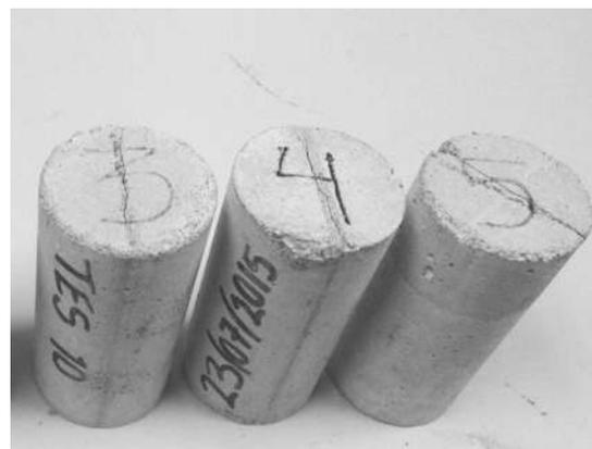
Figura 62. Fallas de las probetas evitado que sea por impacto (Bautista León, 2015)
