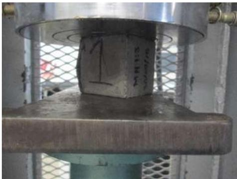
Se aplicó carga a una velocidad constante en el rango de 50000 kg, con una aproximación de 0.5 kg, esta velocidad se mantuvo durante toda la prueba hasta la falla del cubo, registrando esta carga para posteriormente calcular el esfuerzo a compresión del espécimen (ASTM C 109 M, I., 2002).
