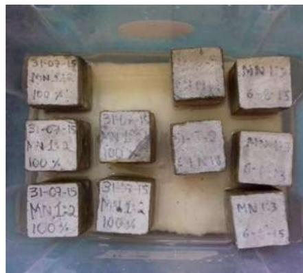
Figura 78. Probetas en prueba de absorción capilar.
