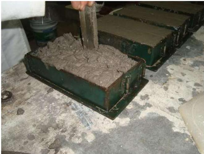
*Figura 53. Elaboración de probetas prismáticas (Bautista León, 2015)*
