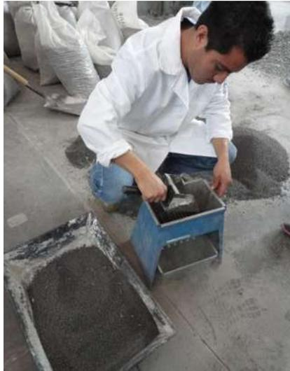
*Figura 28. Cuarteo de arena usando un divisor mecánico (Bautista León, 2015)*
