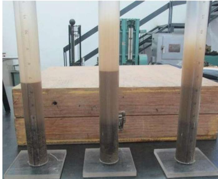
Figura 41. Pruebas de equivalente de arena donde se observa el nivel de arena (Bautista León, 2015)
