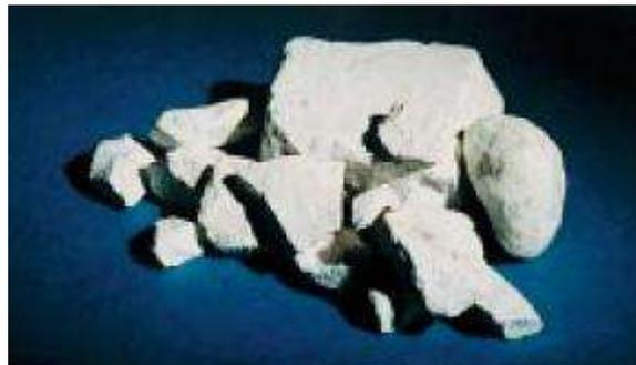
*Figura 5. Yeso, se muele con el clinker para formar el cemento portland. El yeso controla el tiempo de fraguado, las propiedades de contracción por secado y el aumento de la resistencia. (Kosmatka, et al, 2004, pág.30)*
