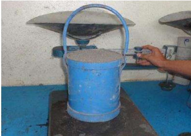
Figura 30. Determinación del peso + material (Bautista León, 2015)
