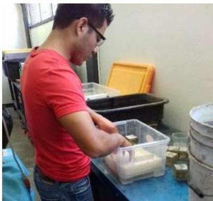
Figura 77. Sumergido de probetas para iniciar la prueba (Bautista León, 2015)
