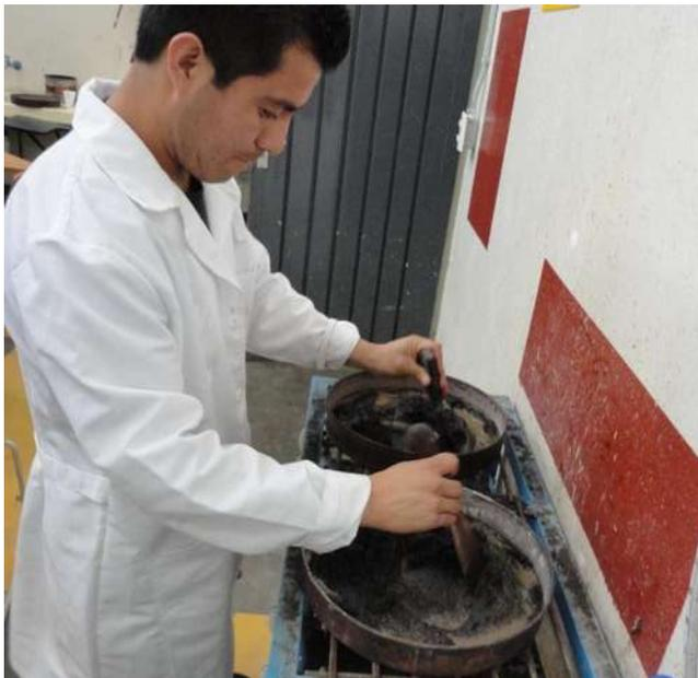
arena trata de disgregarse, significa que se ha secado superficialmente y si la arena mantiene la forma del cono significa que la arena conserva agua en exceso, por lo tanto hay que continuar secando el material hasta que se obtenga el secado superficial. Conforme vaya perdiendo la humedad la muestra hay que realizar más continuamente el procedimiento con el cono para evitar que se seque en exceso.
