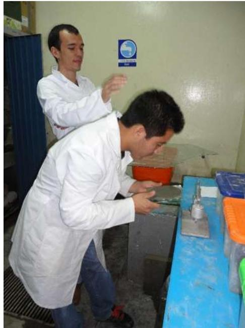
Figura 12. Determinación de fraguado inicial y final (Bautista León, 2015)
