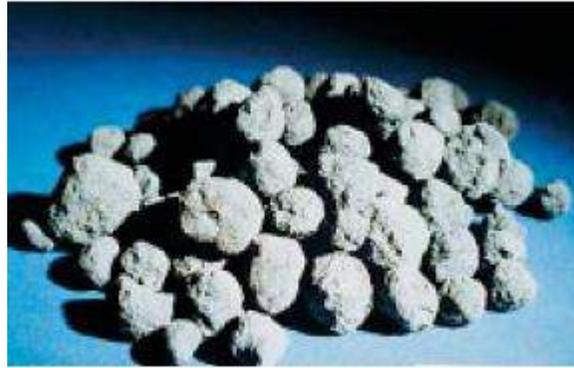
*Figura 4. El clinker, se forma por la calcinación en el horno del material crudo calcáreo y sílice. Específicamente este tiene un diámetro de 20 mm (3/4 pulg). (Kosmatka, et al, 2004, pág.30)*
