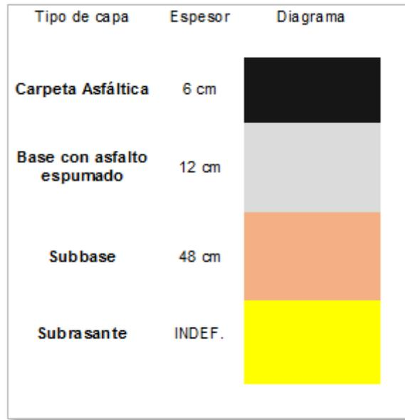
Figura 119.- Estructura base para el proyecto 10.
