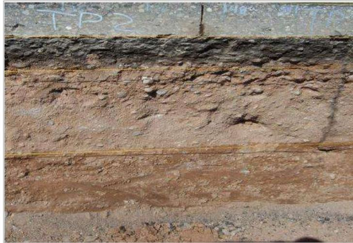
Figura 35.- Espesores de capas de pavimento obtenidos de calas o sondeos (corte transversal).
