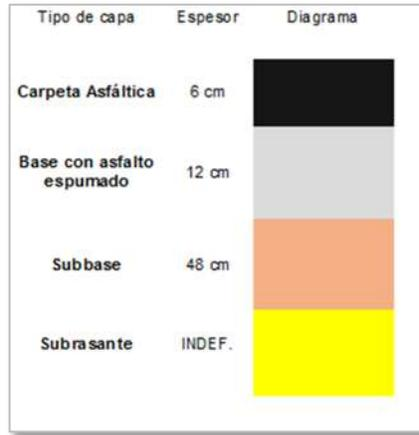
Figura 128.- Estructura base para el análisis de sensibilidad.
