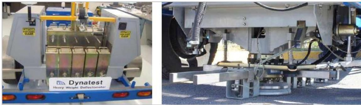
Figura 17.- Sistema de carga y placa de carga HWD.
