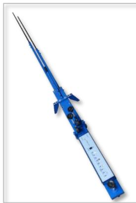
Figura 5.- Viga Benkelman.
