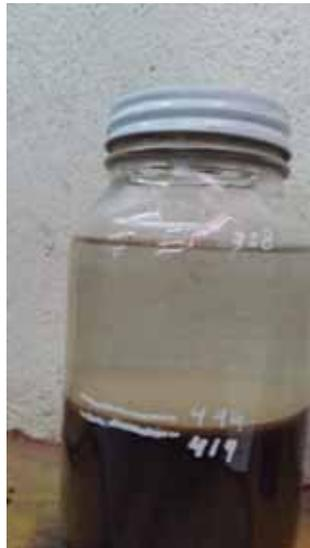
**ILUSTRACIÓN 28 CONTENIDO DE MATERIAL FINO EN LA MUESTRA DE ARENA (FOTOGRAFÍA: MAYRA A. GUIZA S.)**
