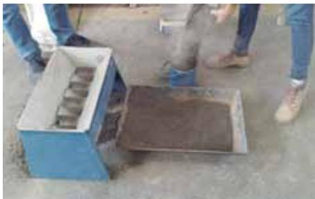
**ILUSTRACIÓN 23 REDUCCIÓN DE LA MUESTRA DE ARENA POR MEDIO DEL CUARTEADOR MECÁNICO. (FOTOGRAFÍA: MAYRA A. GUIZA S.)**
