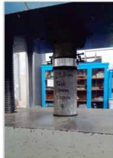
ILUSTRACIÓN 42 CILINDROS CABECEADOS PARA SER SOMETIDOS A COMPRESIÓN
