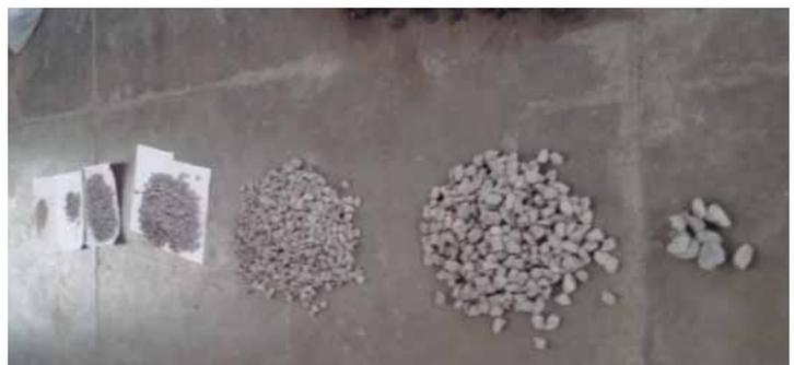
**ILUSTRACIÓN 26 CRIBADO DE LA MUESTRA DE GRAVA PARA OBTENER EL TAMAÑO MÁXIMO DE AGREGADO (FOTOGRAFÍA: MAYRA A. GUIZA S.)**
