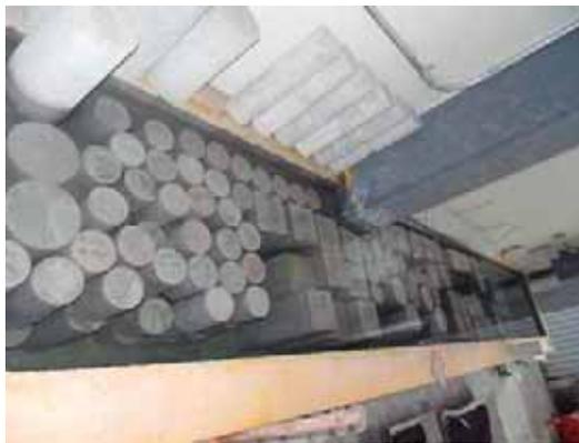
ILUSTRACIÓN 40 PILA DE CURADO (FOTOGRAFÍA: I. TRUJILLO C.)
