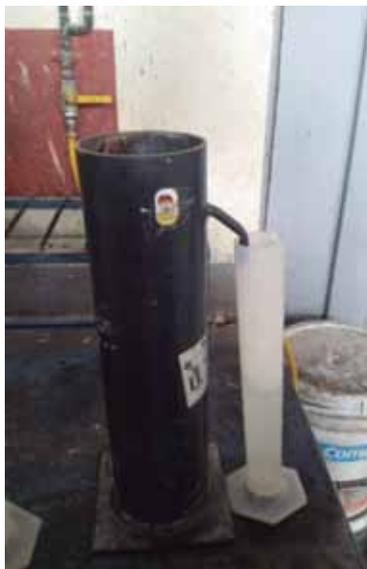
ILUSTRACIÓN 20 DETERMINACIÓN DE LA DENSIDAD DE LA GRAVA POR MEDIO DEL VOLUMEN DESPLAZADO EN EL PICNÓMETRO
