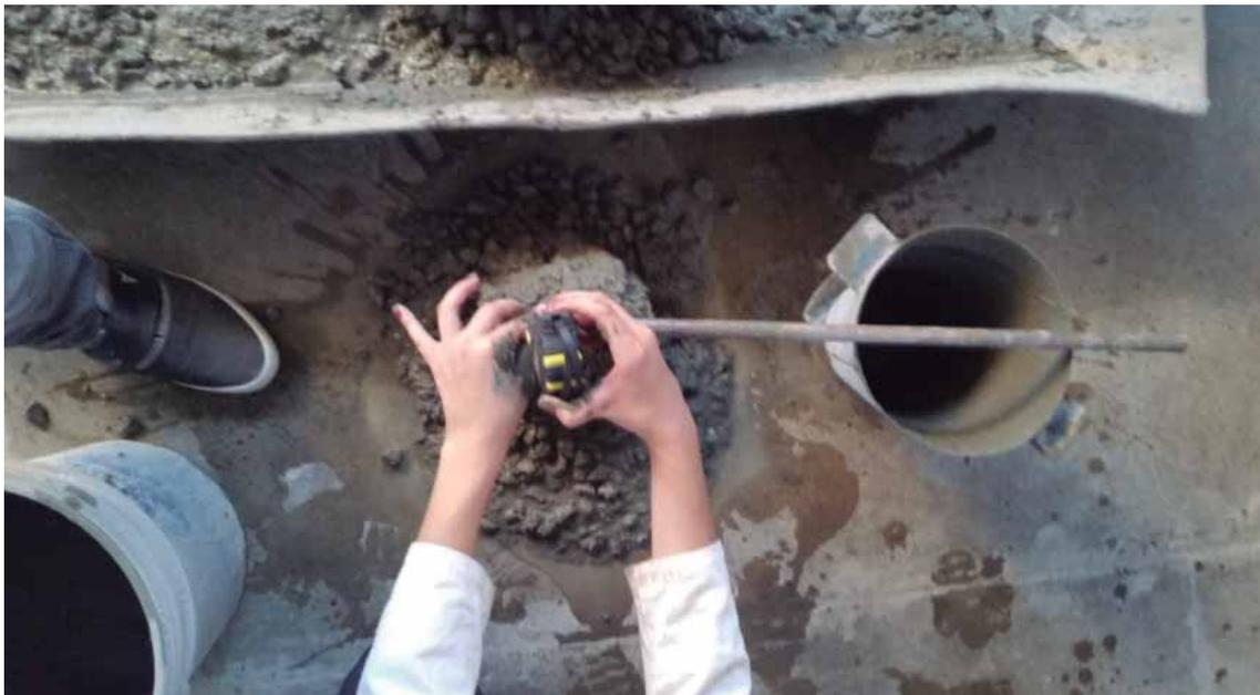
**ILUSTRACIÓN 37 DETERMINACIÓN DEL REVENIMIENTO EN LAS MEZCLAS. (FOTOGRAFÍA: MAYRA A. GUIZA S.)**
