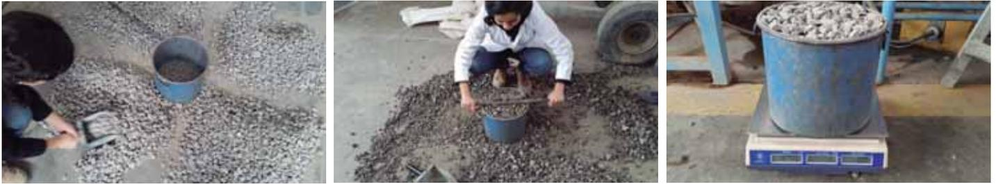
**ILUSTRACIÓN 21 PROCESO DE DETERMINACIÓN DE MASA VOLUMÉTRICAS SECAS SUELTAS. (FOTOGRAFÍA: MAYRA A. GUIZA S.)**
