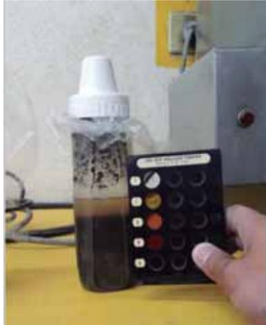
**ILUSTRACIÓN 27 DETERMINACIÓN DEL CONTENIDO DE MATERIA ORGÁNICA POR MEDIO DE LA TABLA COLORIMÉTRICA (FOTOGRAFÍA: MAYRA A. GUIZA S.)**
