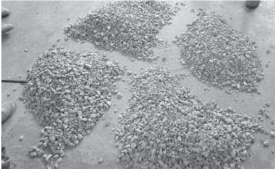
**ILUSTRACIÓN 16 DIVISIÓN DE LA MUESTRA DE GRAVA EN CUATRO PARTES. (FOTOGRAFÍA: MAYRA A. GUIZA S.)**
