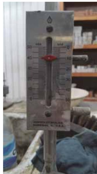
ILUSTRACIÓN 31 APARATO VICAT CON LA MASA IDÓNEA DE CEMENTO
