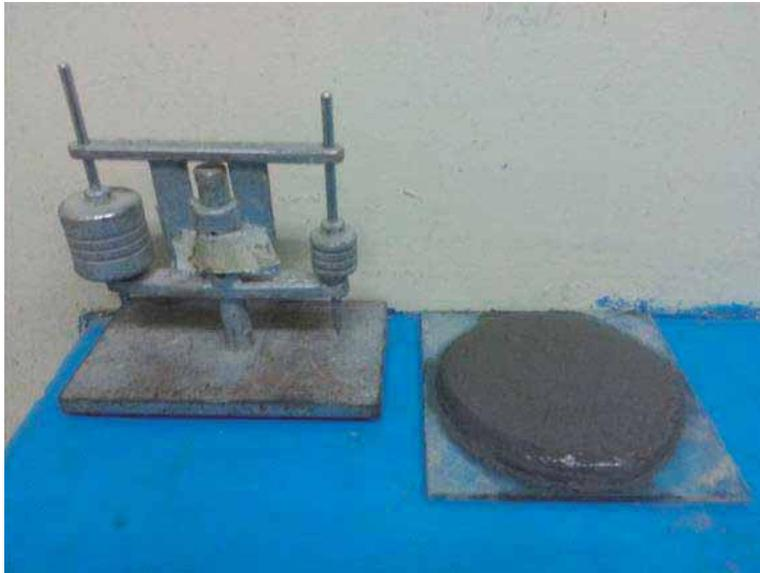
**ILUSTRACIÓN 34** APARATO DE GILLMORE Y PASTILLA DE MASA DE CEMENTO RESULTADO DEL ENSAYE DE CONSISTENCIA NORMAL, EN EL CUARTO HÚMEDO. (FOTOGRAFÍA: MAYRA A. GUIZA S.)
