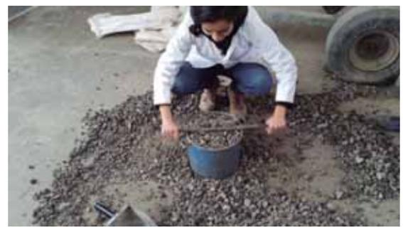
**ILUSTRACIÓN 24 PROCESO DE DETERMINACIÓN DE MASAS VOLUMÉTRICAS SECAS VARILLADAS. (FOTOGRAFÍA: MAYRA A. GUIZA S)**
