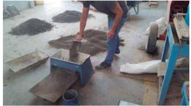
**ILUSTRACIÓN 15 REDUCCIÓN DE LA MUESTRA DE ARENA POR MEDIO DE CUARTEADOR MECÁNICO (FOTOGRAFÍA: MAYRA A. GUIZA S.)**
