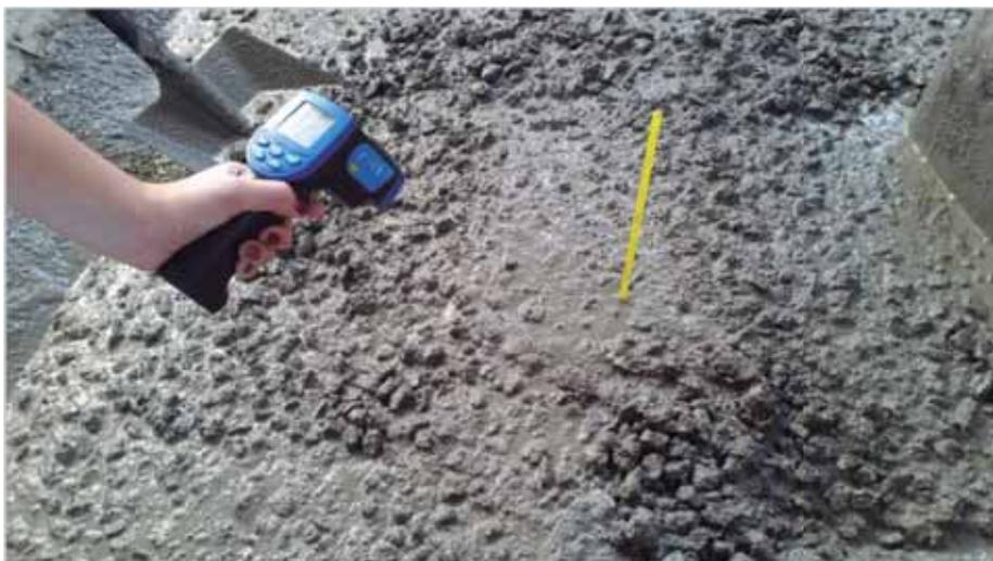
**ILUSTRACIÓN 39. DETERMINACIÓN DE LA TEMPERATURA DE LA MEZCLA, POR MEDIO DE TERMÓMETRO ELECTRÓNICO Y DE MERCURIO. (FOTOGRAFÍA: MAYRA A. GUIZA S.)**
