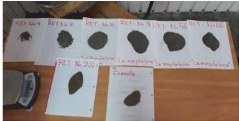
ILUSTRACIÓN 25 PROCESO DE CRIBADO MEDIANTE EL APARATO MECÁNICO RAP-TAP (FOTOGRAFÍA: MAYRA A. GUIZA S.)
