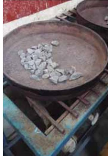
ILUSTRACIÓN 19 EN LA IMAGEN DE LA IZQUIERDA SE OBSERVA LA GRAVA SATURADA DURANTE 24 HORAS, EN LA IMAGEN DE LA DERECHA SE OBSERVA EL MATERIAL SECADO EN LA PARRILLA. (FOTOGRAFÍA: MAYRA A. GUIZA S.)
