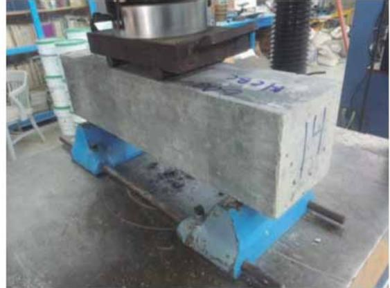
ILUSTRACIÓN 43 PROCESO DE DETERMINACIÓN DE LA RESISTENCIA A LA FLEXIÓN (FOTOGRAFÍA: E. GONZÁLEZ CASTRO)
