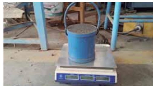
**ILUSTRACIÓN 22 DETERMINACIÓN DE LAS MASAS VOLUMÉTRICAS DE LA ARENA. (FOTOGRAFÍA: MAYRA A. GUIZA S.)**
