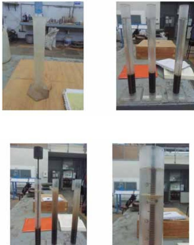
ILUSTRACIÓN 29 PROCESO DE DETERMINACIÓN DE EQUIVALENTE DE ARENA (FOTOGRAFÍA: MAYRA A. GUIZA S.)
