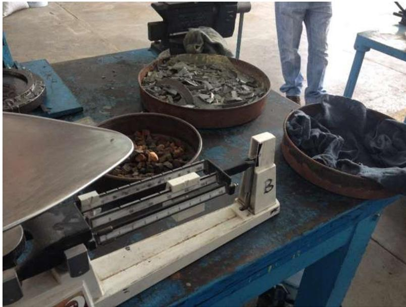
*Imagen 9. Secado de grava para ensaye de absorción.*
