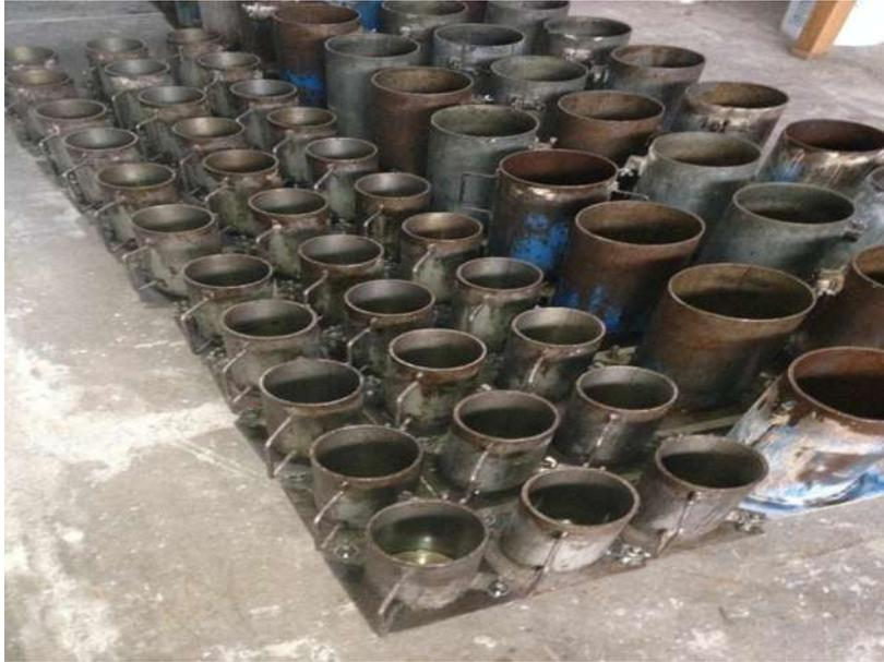
Imagen 13. Moldes cilíndricos de 10 y 15 cm de diámetro.
