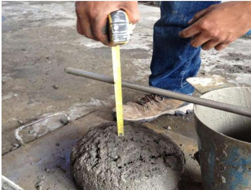
Imagen 12. Medición del revenimiento en concreto fresco.
