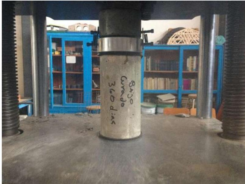
Imagen 15. Espécimen cilíndrico de concreto sometido al ensaye de compresión.
