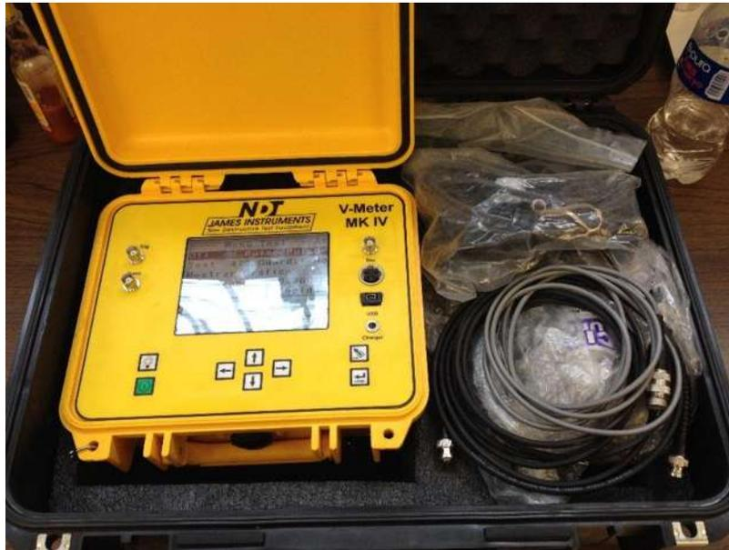
Imagen 17. Equipo para la medición de velocidad de pulso ultrasónico.
