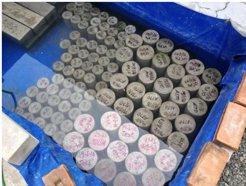
Imagen 14. Curado de especímenes cilíndricos.
