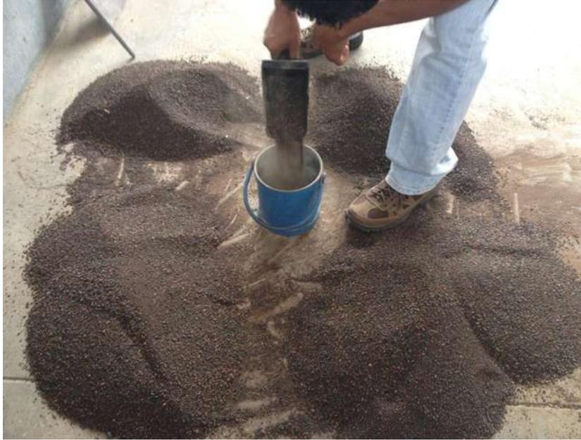
*Imagen 3. Masa volumétrica seca suelta en arenas.*
