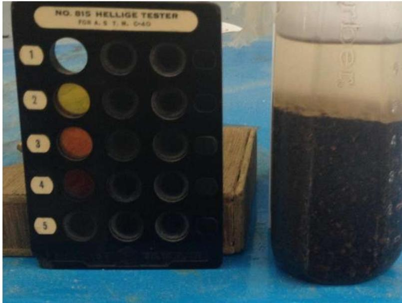
Imagen 19. Comparativa del material con la tabla colorimétrica.
