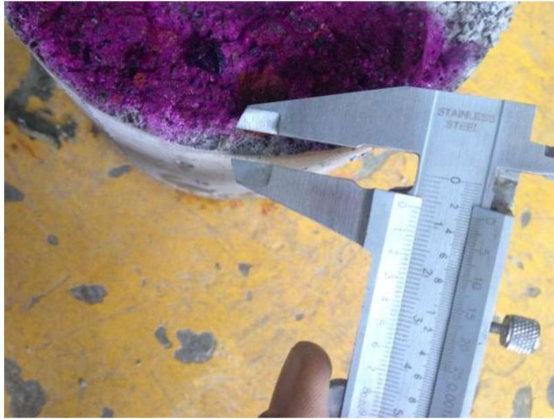
*Imagen 18. Espécimen de concreto con efectos de carbonatación.*
