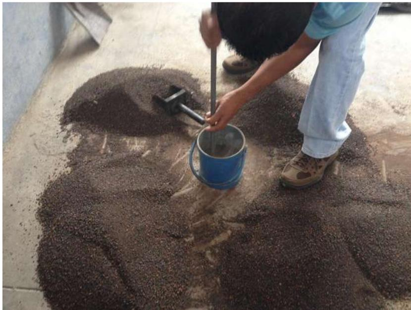
*Imagen 4. Masa volumétrica seca varillada en arenas.*
