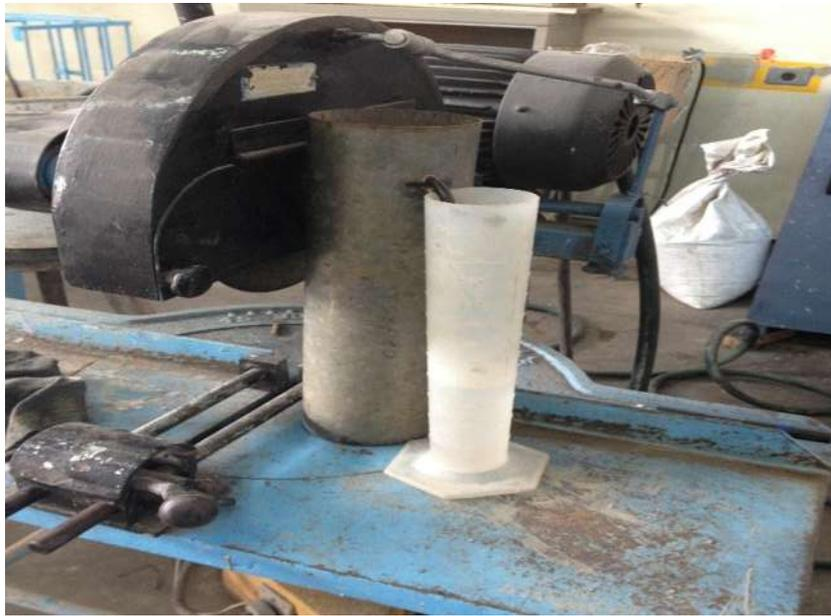
Imagen 5. Probeta y picnómetro para medir diferencia de volumen.
