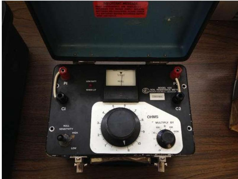
Imagen 16. Resistómetro utilizado para medir la resistencia eléctrica.
