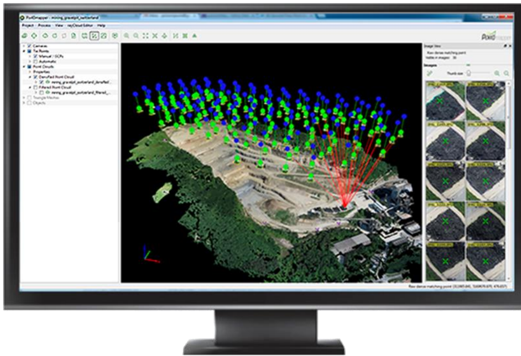
FIGURA 22. Imágenes de explotación a cielo abierto tomadas con UAV y procesadas con Pix4DMapper
