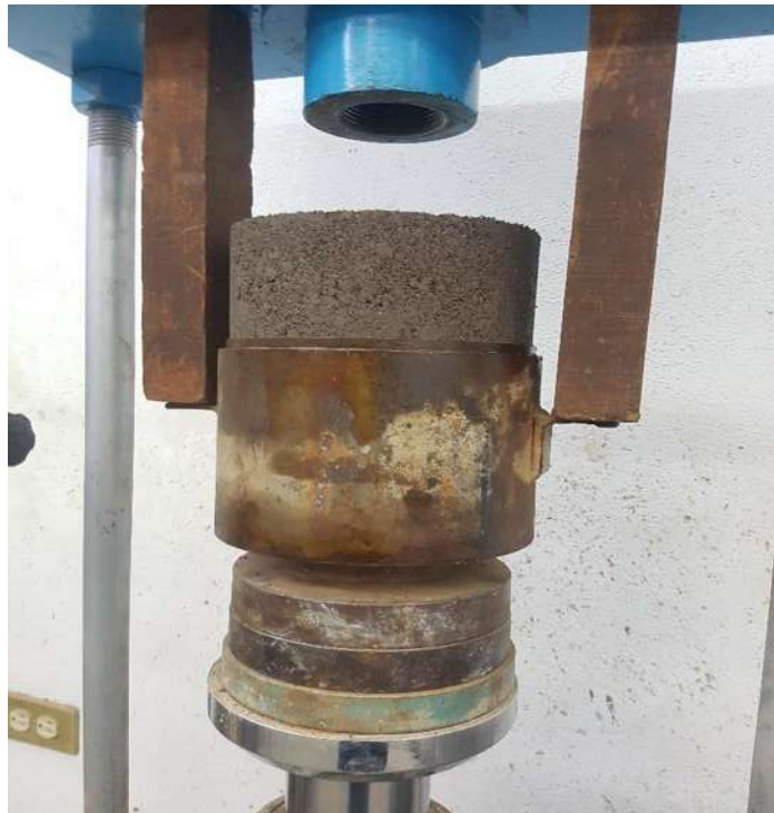
Fig. 26 Preparación de remoldeada
