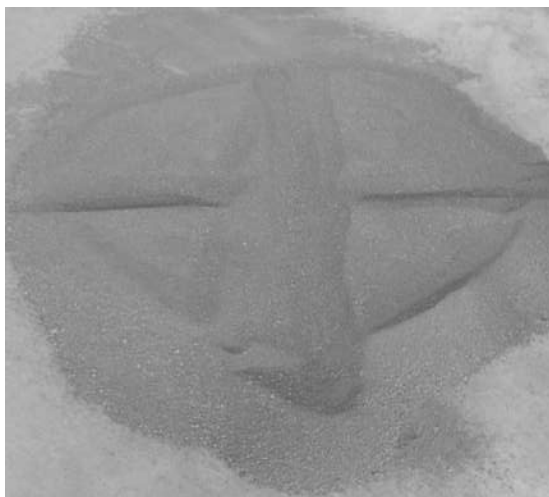
Ilustración 5. División del material.
