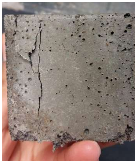
Ilustración 46. Falla del cubo sometido a compresión. (J.Acha, 2017)
