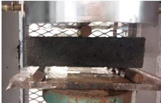
Ilustración 49. Aplicación de la carga de flexión constante a la muestra. (J.Acha, 2017).
