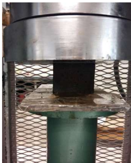
Ilustración 45. Cubo colocado en el centro de la placa y sometido a una carga de compresión. (J.Acha, 2017).
