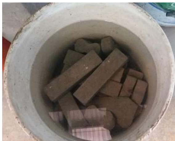
Ilustración 39. Curado de los cubos. (J.Acha, 2017)
