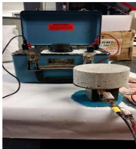
Ilustración 52. Equipo utilizado en la medición de resistividad eléctrica. (J.Acha, 2017)
