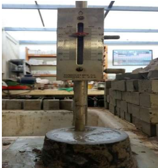
Ilustración 3. Penetración de la aguja. (J.Acha, 2017)
