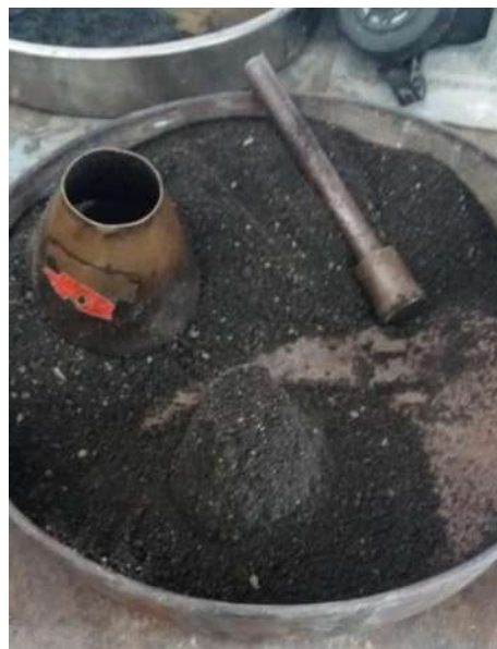
Ilustración 27. Secado superficial de la muestra. (J.Acha, 2017).
