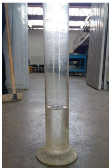
Ilustración 28. Colocando el volumen inicial en la probeta. (J.Acha, 2017)
