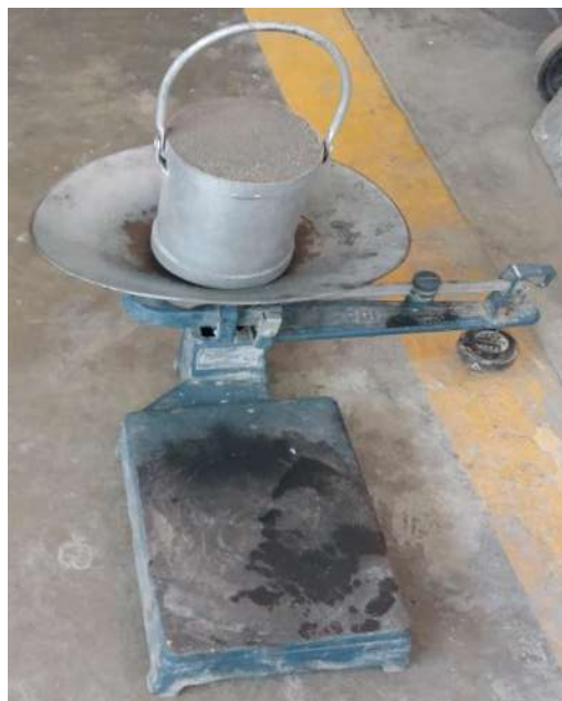
Ilustración 12. Peso el recipiente lleno con el material. (J.Acha, 2017)
