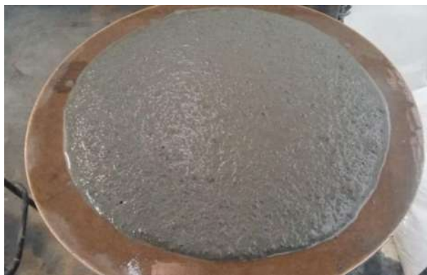
Ilustración 33. Extendido de la mezcla. (J.Acha, 2017)
