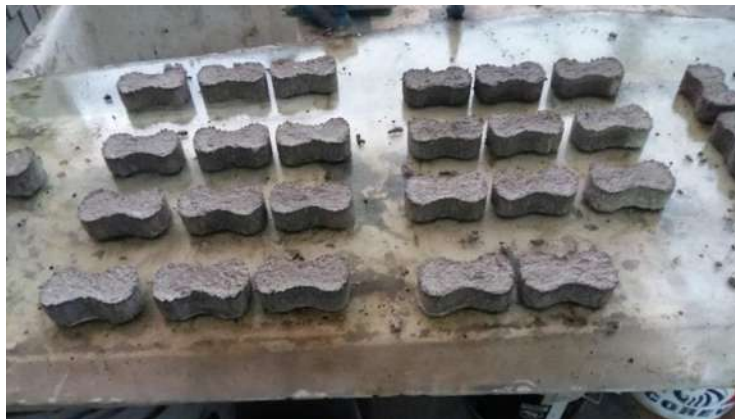
Ilustración 44. Fraguado de las briquetas. (J.Acha, 2017)
