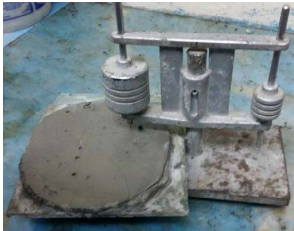
Ilustración 4. Penetración de la aguja final. (J.Acha, 2017)
