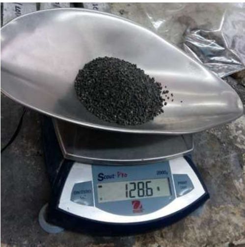
Ilustración 18. Pesado del material al décimo de gramo. (J.Acha, 2017).
