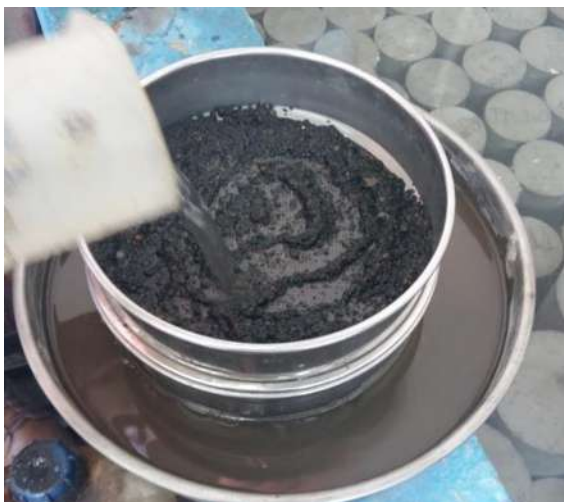
Ilustración 24. Lavado del material. (J.Acha, 2017).
