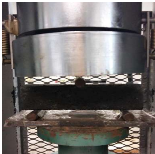
Ilustración 48. Muestra colocada en los apoyos para la muestra de flexión.
