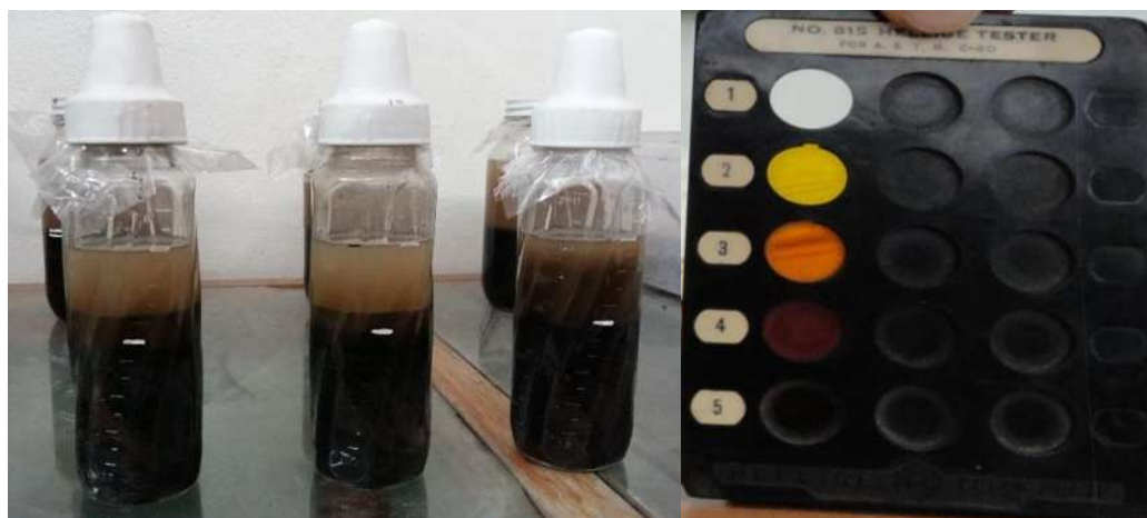
Ilustración 21. Comparación del agua con la tabla de colores. (J.Acha, 2017).
