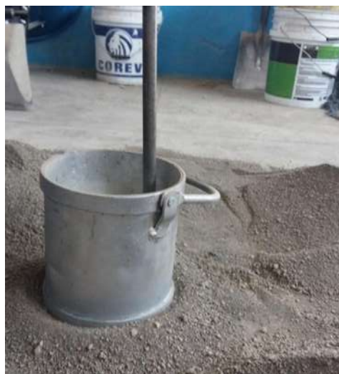
Ilustración 13. Varillado de la primera capa. (J.Acha, 2017)
