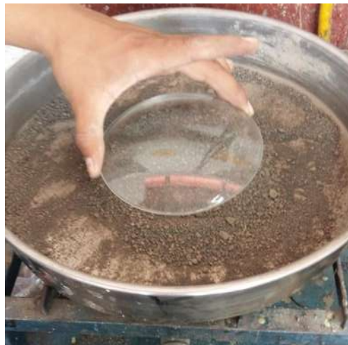
Ilustración 10. Secado de la muestra hasta peso constante. (J.Acha, 2017).
