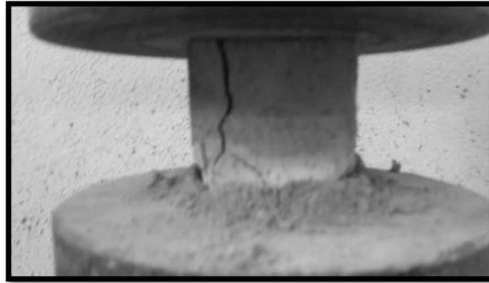
Figura 74. Falla de cubo (compresión simple)
