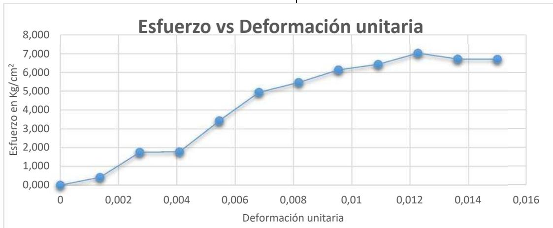
**Grafica 23. Presión 0.6 Factor 8.31 comparación esfuerzo vs deformación (triaxial rápida inalterada) tomando en cuenta anexo 51 y 52**
