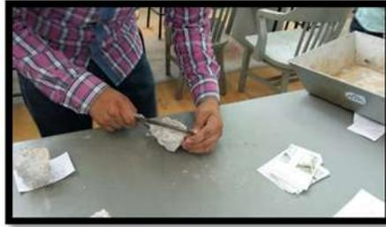
**Figura 55. Largo y ancho (carga puntual)**
