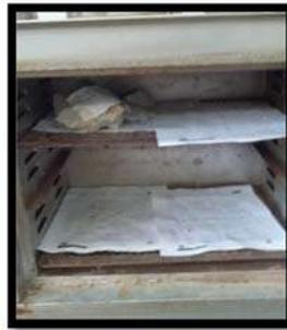
**Figura 36. Secado de la muestra (densidad y absorción)**
