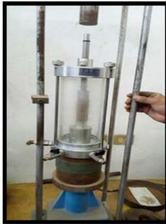
**Figura 7. Cámara triaxial laboratorio de materiales “Luis Silva”**
