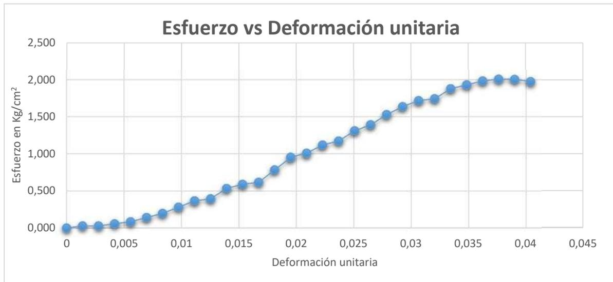
**Grafica 16. Prueba 3, presión 0.3, factor 0.63 comparación esfuerzo vs deformación (triaxial rápida) tomando en cuenta anexo 37 y 38**
