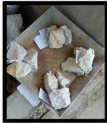
**Figura 59. Identificación de muestra (carga puntual)**
