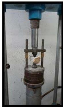
Figura 54. Carga puntual en roca
