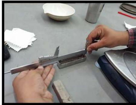
**Figura 29. Preparación molde (contracción lineal)**
