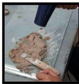
**Figura 27. Material no plástico (limite plástico)**
