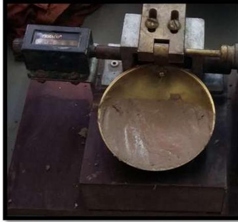
**Figura 28. Preparación para contracción lineal**
