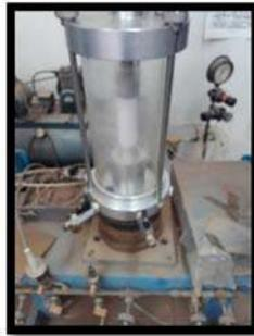
**Figura 52. Muestra tallada en prensa (compresión simple)**
