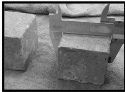
**Figura 69. Identificación de muestra tallada (compresión simple)**
