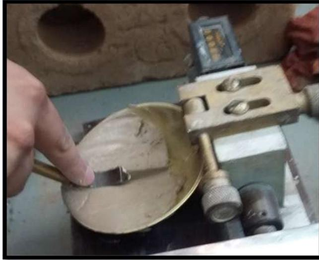
Figura 24. Ranura en la parte central (copa Casagrande)
