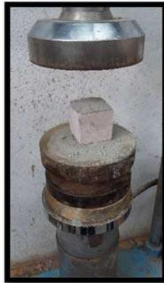
**Figura 72. Centrado de cubo (Compresión simple)**
