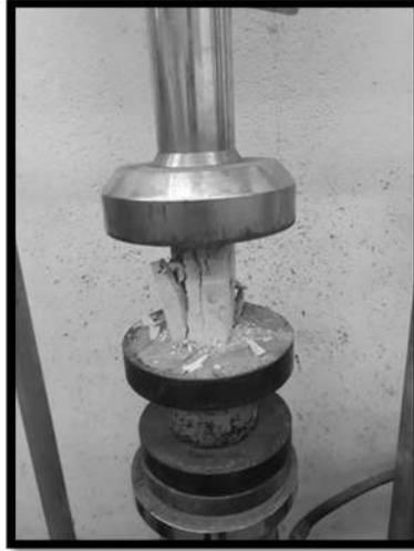
Figura 78. Falla de muestra cilíndrica (compresión simple).
