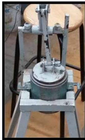
**Figura 45. Retiro de material del molde (compactación proctor estándar)**
