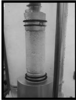
**Figura 89. Muestra lista para la carga (Triaxial Rápida)**
