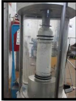
**Figura 88. Preparación de muestra cilíndrica (Triaxial Rápida)**
