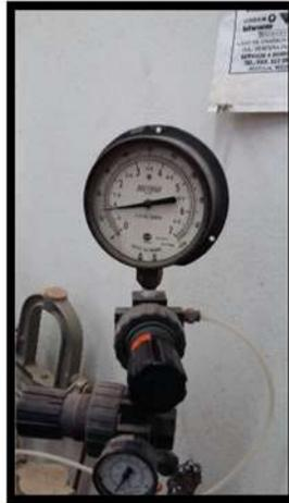
Figura 87. Presión de confinamiento 0.3, 0.6, 0.9 (Triaxial Rápida)
