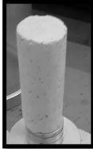
**Figura 51. Cilindro labrado (compresión simple)**
