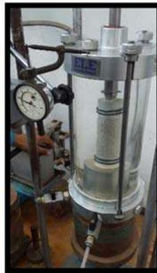
**Figura 83. Colocación de muestra en cámara triaxial (Triaxial Rápida)**
