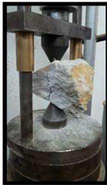
**Figura 64. Falla del testigo (carga puntual)**
