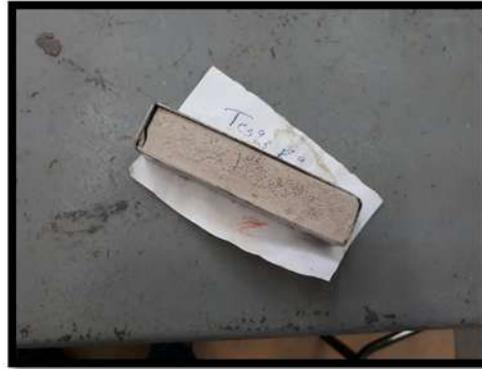
Figura 30. Secado muestra temperatura ambiente (contracción lineal)
