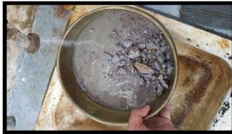
**Figura 17. Lavado mediante la malla no. 200**
