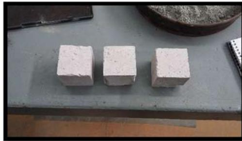
**Figura 66. Cubos sin grietas (compresión simple)**
