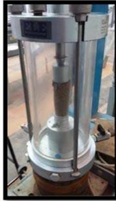
**Figura 50. Falla de la muestra (compresión simple)**
