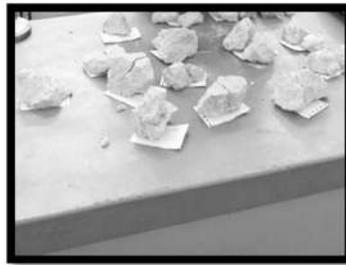
**Figura 57. Identificación de muestra valida (carga puntual)**
