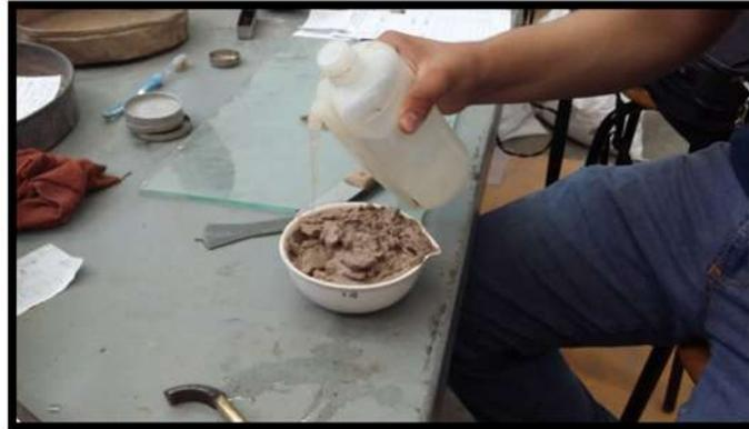
**Figura 22. Homogenizar el material**
