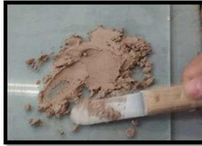
**Figura 26. Muestra limite plástico**
