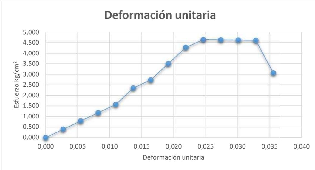
**Grafica 12. Prueba 1, presión 0.9, factor 8.44 comparación esfuerzo vs deformación (triaxial rápida) tomando en cuenta anexo 29 y 30**
