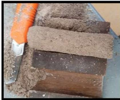
**Figura 80. Muestra labrada (Triaxial Rápida)**
