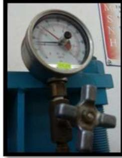
**Figura 62. Medidor de presión (carga puntual)**
