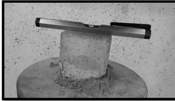
**Figura 71. Nivelación de muestra (Compresión simple)**
