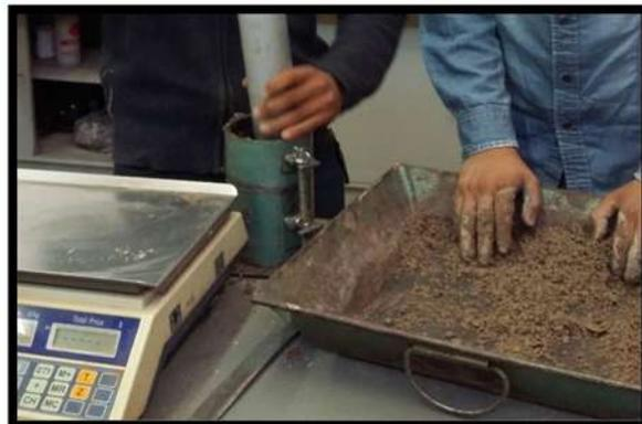
**Figura 47. Homogenización del material (compactación proctor estándar)**
