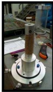
**Figura 86. Especimen sin presión (Triaxial Rápida)**
