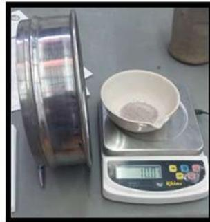
Figura 21. Peso del material que retiene la malla
