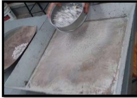
**Figura 38. Cribado de muestra (compactación proctor estándar)**
