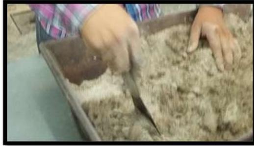
**Figura 41. Homogenización de muestra (compactación proctor estándar)**
