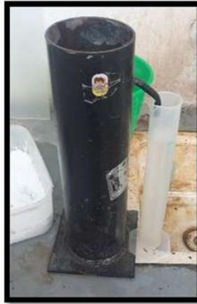
**Figura 33. Preparación picnómetro (densidad y absorción)**
