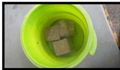
**Figura 67. Saturación de cubos (compresión simple)**
