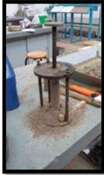
**Figura 48. Muestra inalterada labrada (compresión simple)**
