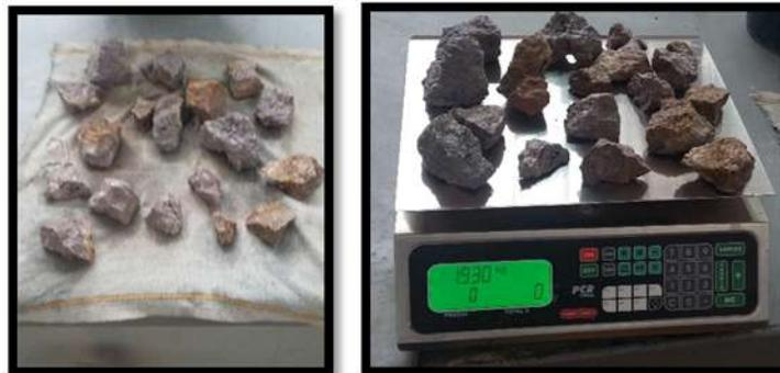
**Figura 34. Masa la muestra (densidad y absorción)**
