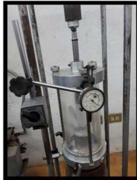
**Figura 91. Toma de tiempo (Triaxial Rápida).**
