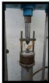
**Figura 61. Acomodo de espécimen (carga puntual)**
