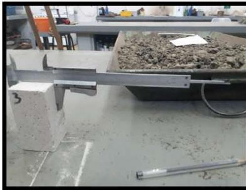
**Figura 76. Dimensiones de cilindro (Compresión simple).**
