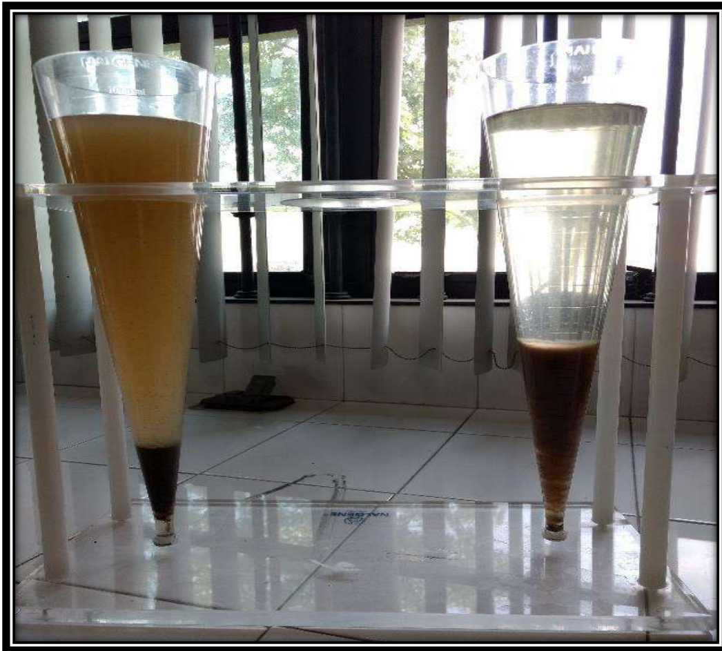
Ilustración 54. Prueba de sólidos sedimentables por medio de cono IMHOFF de la primera muestra (EAST)
