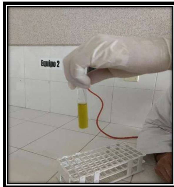
Ilustración 56. Mezcla de ácido sulfúrico y la muestra obtenida de la PTAR
