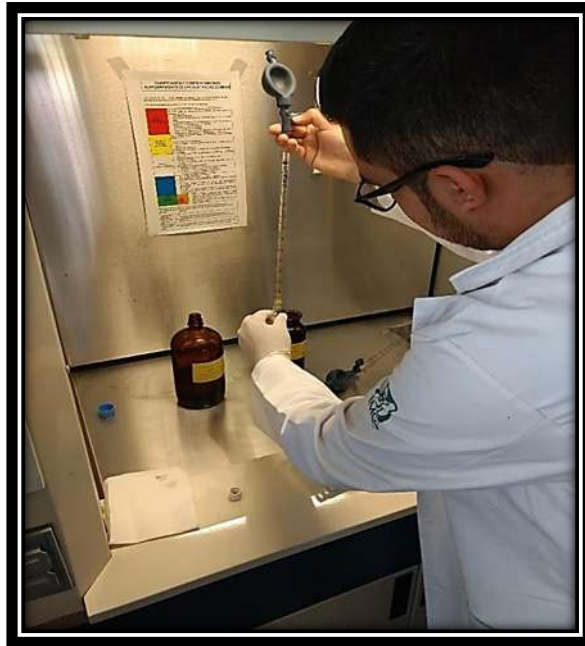
Ilustración 55. Vertido del ácido sulfúrico para la prueba de DQO (EAST)
