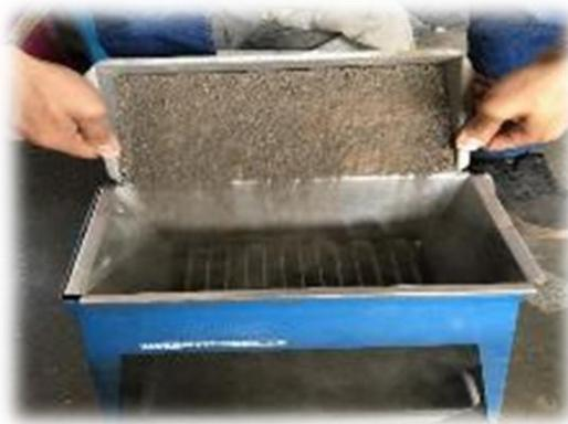
*Ilustración 14 Cuarteo por cuarteador mecánico. (VACA ARCIGA, 2017)*
