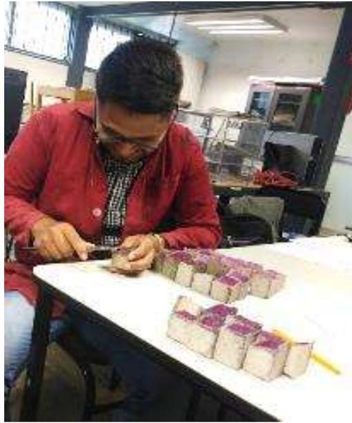
*Ilustración 61 Medición de la profundidad de carbonatación. (Báez Ángel, 2017)*
