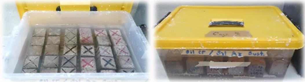
*Ilustración 64 Especímenes inmersos en solución de sulfato de sodio. (Báez Ángel, 2017)*
