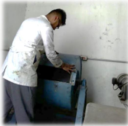
*Ilustración 10 Trituración de Sílice en la Máquina de desgaste de Los Ángeles. (Báez Ángel, 2017)*
