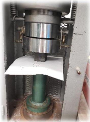
*Ilustración 66 Ensayo a compresión después de que el espécimen fue expuesto a solución de sulfato de sodio. (Báez Ángel, 2017)*
