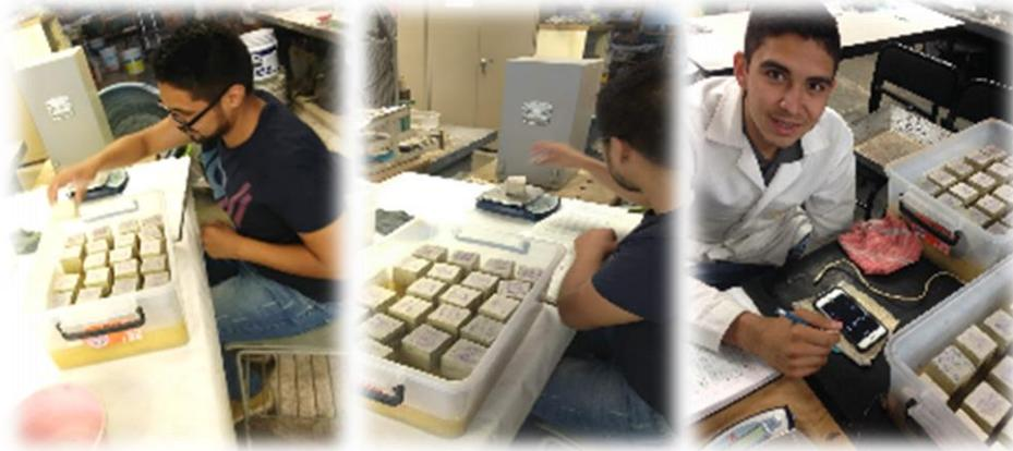
*Ilustración 58 Registro de masa durante la prueba de absorción capilar. (Báez Ángel, 2017)*
