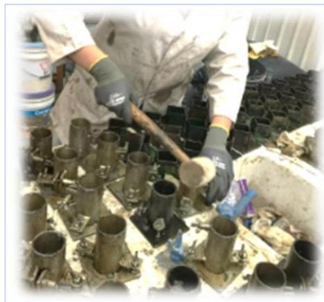
*Ilustración 41 Elaboración de cilindros. (Santillán Barragán, 2017)*
