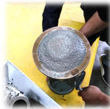
Ilustración 32 Expansión de la mezcla de forma manual haciendo girar la leva. (VACA ARCIGA, 2017)
