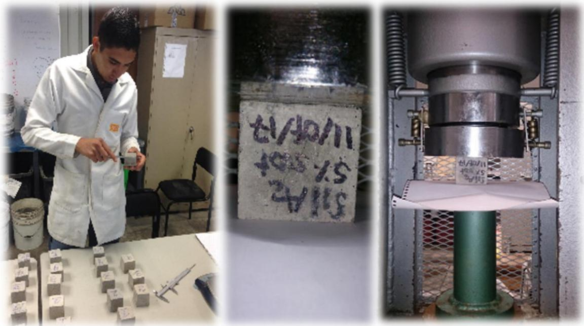
*Ilustración 48 Prueba de compresión simple en cubos. (Báez Ángel, 2017)*
