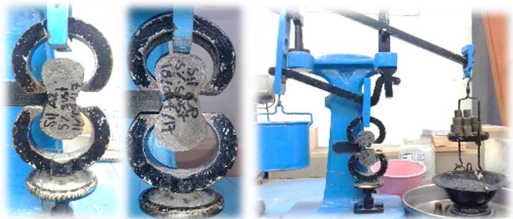
*Ilustración 52 Prueba de tensión directa en briquetas. (Báez Ángel, 2017)*
