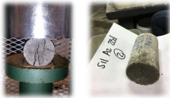
Ilustración 51 Prueba de tensión indirecta en cilindros. (Báez Ángel, 2017)
