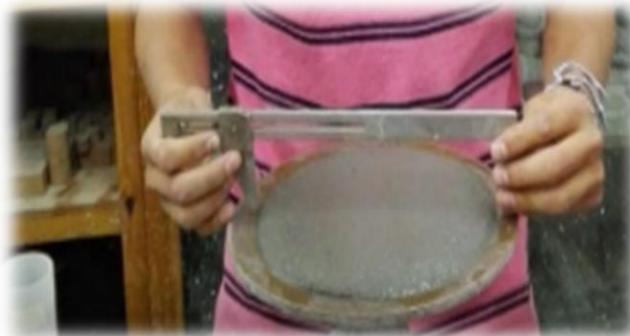
Ilustración 33 Toma de mediciones para determinar la fluidez (Báez Ángel, 2017)
