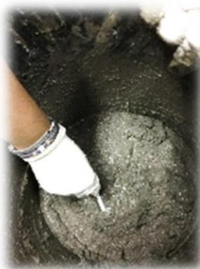
Ilustración 34 Papel indicador puesto en contacto con el mortero (VACA ARCIGA, 2017)
