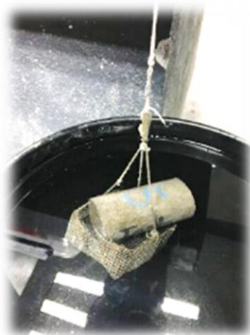
*Ilustración 45 Prueba de Gravedad Específica. (Báez Ángel, 2017)*
