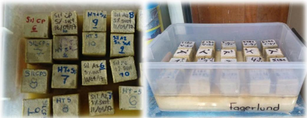
*Ilustración 57 Colocación de los especímenes sobre la esponja húmeda. (Báez Ángel, 2017)*
