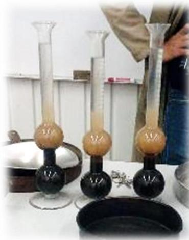
*Ilustración 26 Determinación de la densidad de la arena por medio del frasco de Chapman (Báez Ángel, 2017)*
