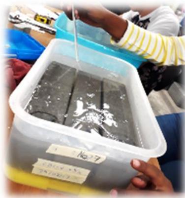
*Ilustración 54 Toma de temperatura de los especímenes tras ser sometidos a ciclos de congelamiento y deshielo (Báez Ángel, 2017).*
