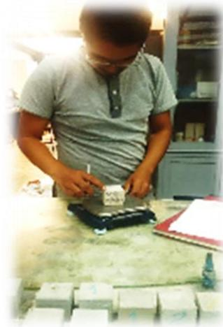
*Ilustración 65 Obtención de masa seca después de ser expuestos a solución de sulfato de sodio. (Báez Ángel, 2017)*
