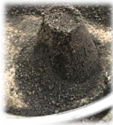
*Ilustración 17 Secado superficial de la muestra mediante el molde troncocónico.
