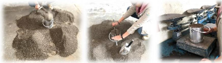
*Ilustración 18 Realización de la prueba de MVSS (VACA ARCIGA, 2017)*
