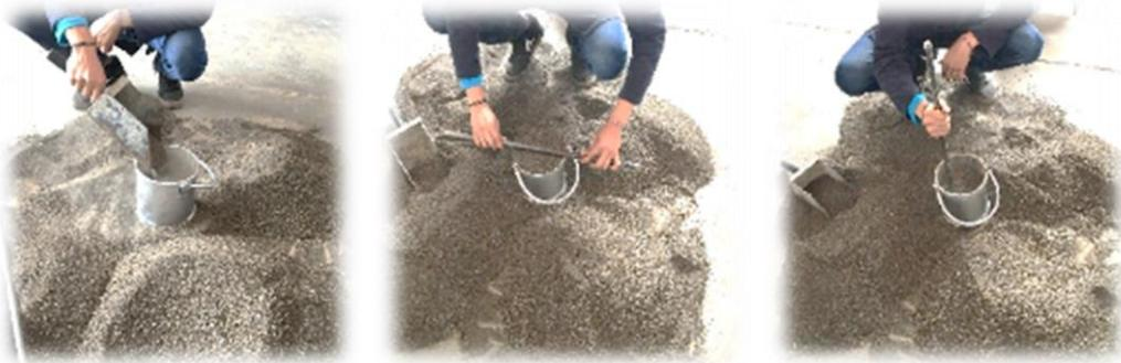
*Ilustración 19 Realización de la prueba de MVSV (VACA ARCIGA, 2017)*
