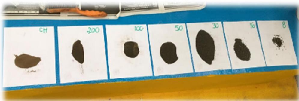
*Ilustración 21 Material retenido de las diferentes mallas una vez pesadas. (Báez Ángel, 2017)*
