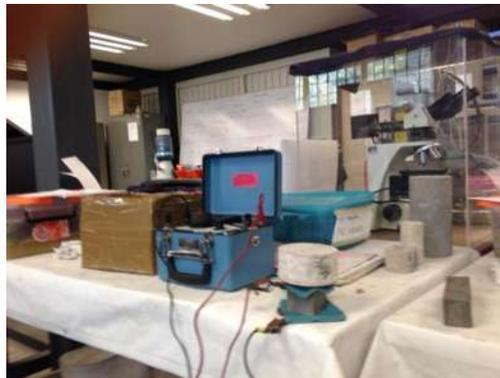
Figura 53. Obtención de la resistencia eléctrica en una muestra de morteros. Por Luis Alberto González
