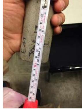
Figura 55. Obtención de las dimensiones del espesor en muestras. Por Luis Alberto González
