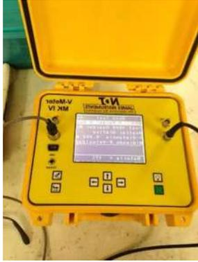
Figura 54. Aparato usado para la determinación de la velocidad de pulso ultrasónico. Por Luis Alberto González
