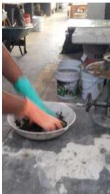
Figura 39. Mezclado del mortero por determinación de la fluidez. Por Luis Alberto González
