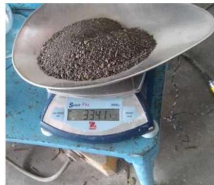
Figura 21. Determinación del peso seco del agregado. Por Luis Alberto González
