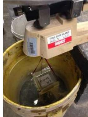
Figura 47. Determinación de la masa sumergida de los especímenes. Por Luis Alberto González
