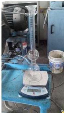
*Figura 23. Obtención de la masa del vaso de Chapman.
