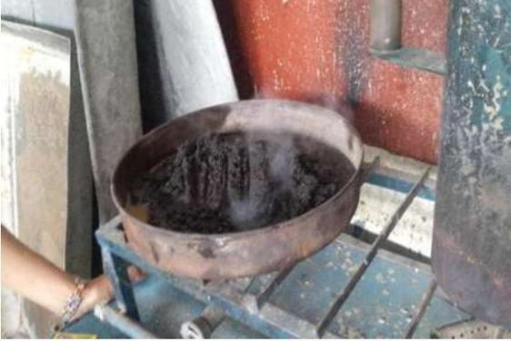
Figura 18. Una muestra de agregado fino que se puso en calor para que perdiera humedad. Por Luis Alberto González
