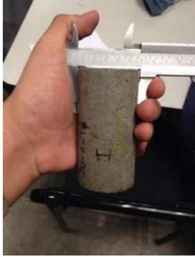
Figura 59. Determinación del diámetro de la sección circular del espécimen cilíndrico. Por Luis Alberto González
