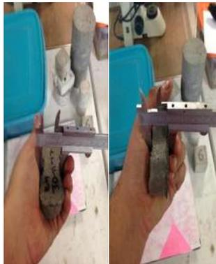
*Figura 62. Determinación de las dimensiones de la sección más desfavorable en las briquetas. Por Luis Alberto González*
