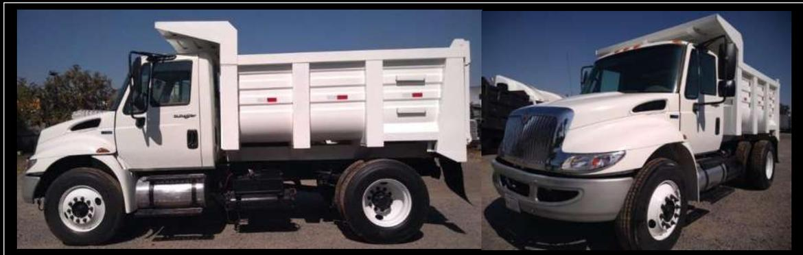
Figura 49. Camión Volteo De 7 m<sup>3</sup> International 4300 Mod 2013.
