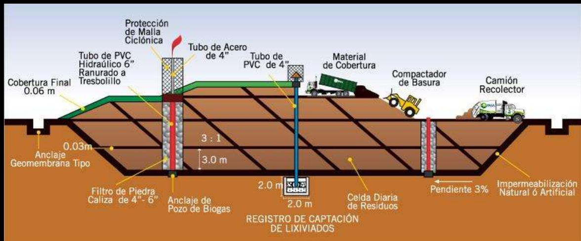
Figura 44. Relleno Sanitario Según el Método Combinado.
