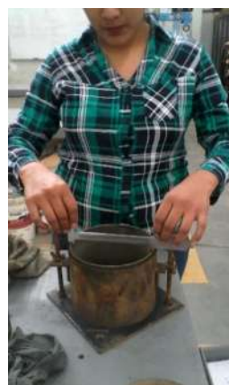
Imagen 42.- Forma de medir el molde.
