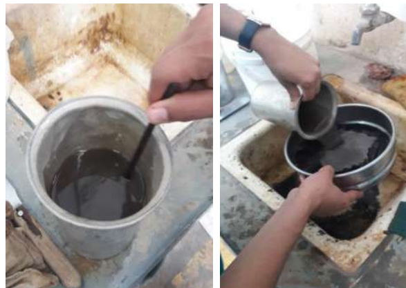
Imagen 9.- Forma de decantar la suspensión a través de la malla N°200.
