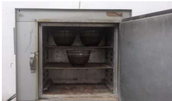
Imagen 21.- Secado al horno de las muestras realizadas en la prueba.
