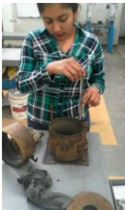
Imagen 42.- Forma de medir el molde.
