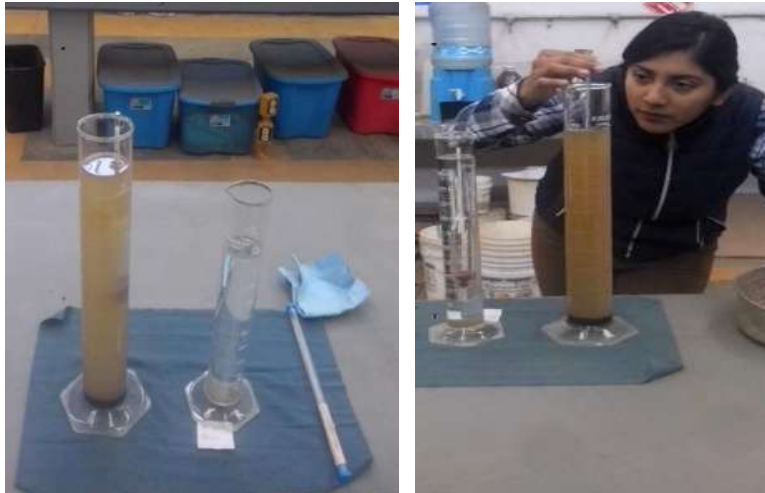
Imagen 27.- Colocación del hidrómetro y termómetro.
