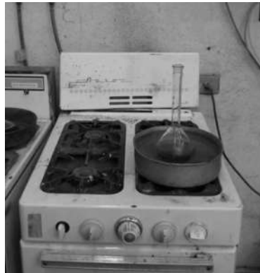
Imagen 19.- Expulsión del aire atrapado mediante la ebullición.
