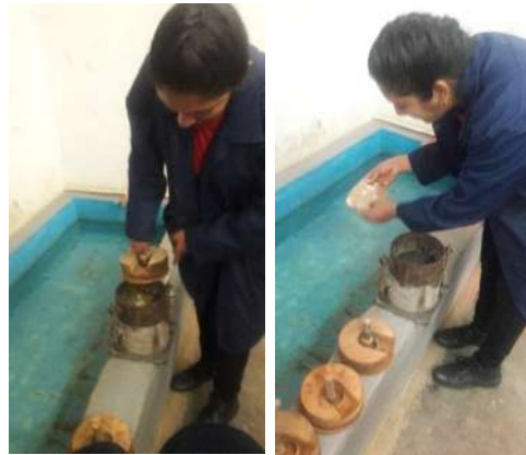
Imagen 38.- Retiro del molde de la pila de saturación.
