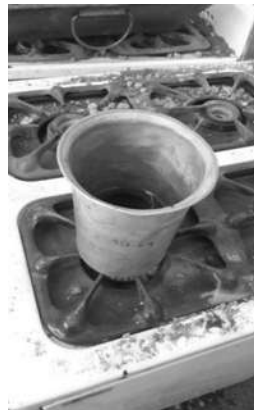
Imagen 7.- Secado en la estufa de la ceniza volcánica.
