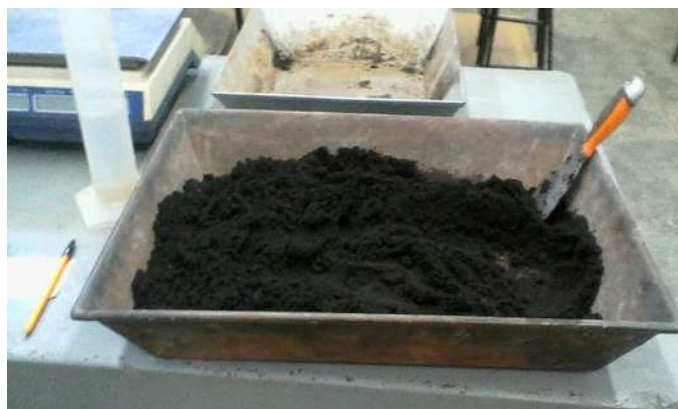
Imagen 31.- Homogenización del material con el agua.
