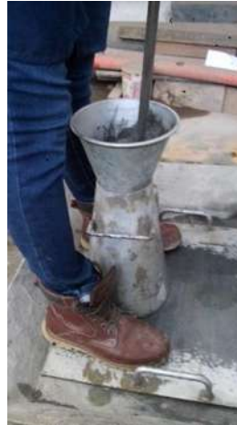
Imagen 53.- Varillado para la prueba de revenimiento.
