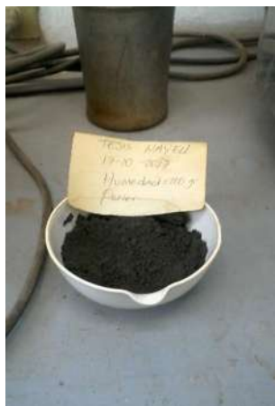
Imagen 35.- Obtención del contenido óptimo de humedad.
