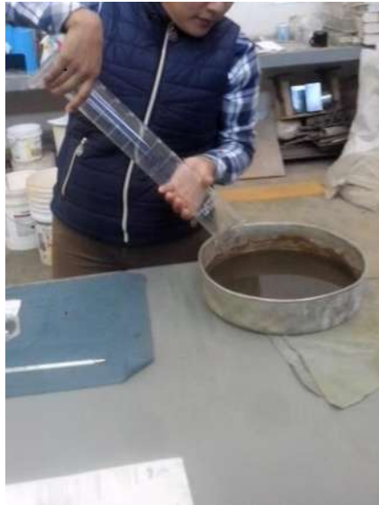
Imagen 28.- Colocación de la suspensión en una charola para su posterior secado en el horno.
