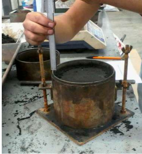
Imagen 34.- Forma de medir el borde superior del molde con el vernier.
