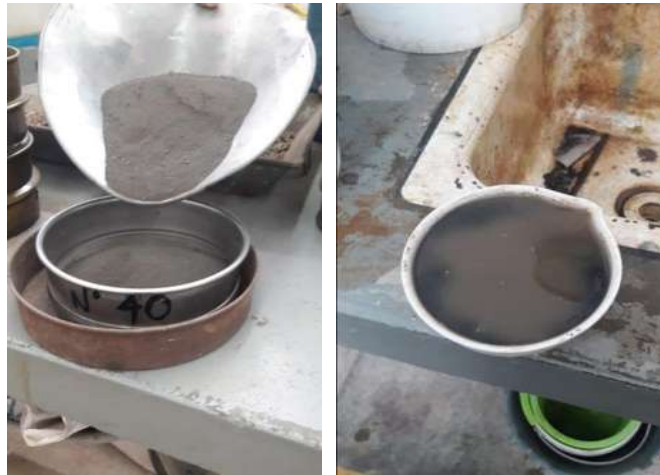
Imagen 13.- Cribado y saturación del material.
