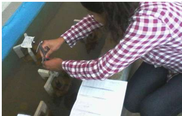
Imagen 37.- Muestra la forma de medir las lecturas con ayuda del vernier.
