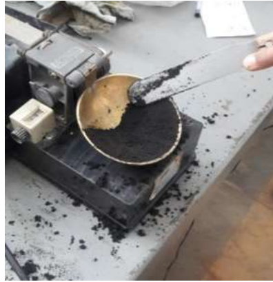
Imagen 14.- Colocación del material en la copa de casa grande
