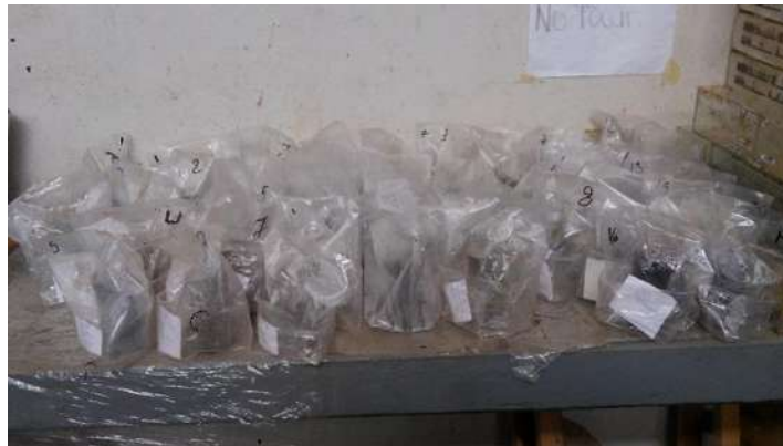
Imagen 52.- Especímenes cubiertas con bolsas muy húmedas.
