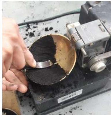
Imagen 15.- Forma de ranurar el material.
