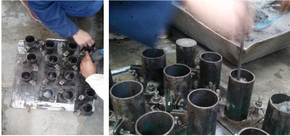
Imagen 49.- Llenado y varillado de los cilindros.
