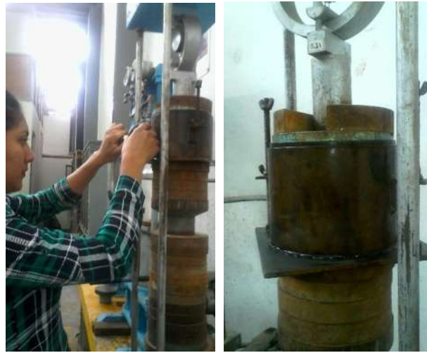
Imagen 39.- Forma de colocar el molde en la máquina.
