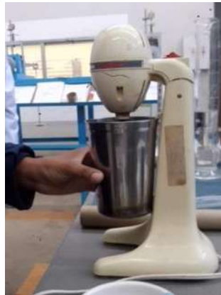
Imagen 26.- Colocación de la suspensión en el mezclador mecánico.
