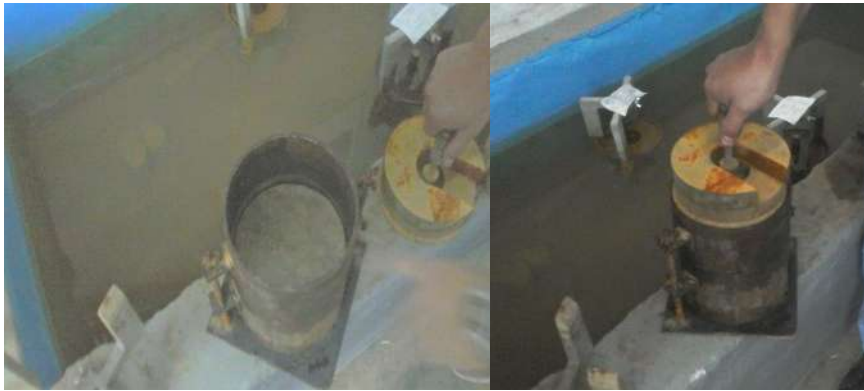
Imagen 36.- Colocación de la placa perforada para su posterior saturación en la pila.
