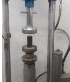
Imagen 55.- Espécimen colocado en el centro de la placa de la prensa.
