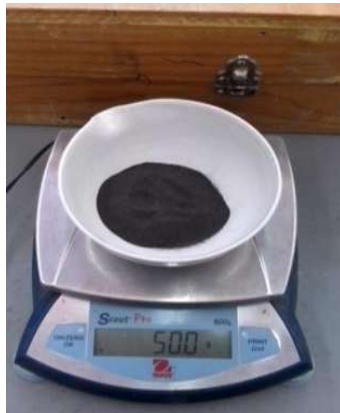
Imagen 23.- Material cribado por la malla N°200.
