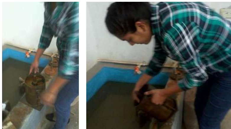
Imagen 57.- Retiro del molde de la pila de saturación.
