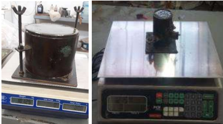
Imagen 50.- Registro del peso de los especímenes frescos.
