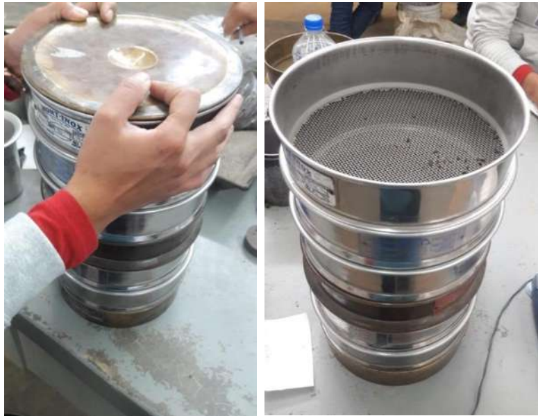
Imagen 10.- Colocación de las mallas para efectuar el cribado del material.
