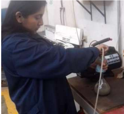
Imagen 20.- Succión del aire atrapado con ayuda de la bomba.
