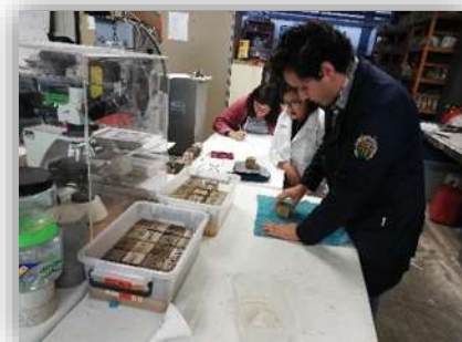
Figura 3.34. Se registra el cambio de masa de cada espécimen en diferentes intervalos de tiempo, Fotografía: J.C. García Perdomo, 2018.
