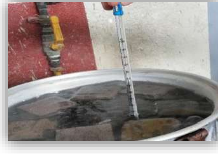
Figura 3.38. Saturar los especímenes en un recipiente durante 5 horas hasta llegar su punto ebullición a una temperatura de 100\text{ }^{\circ}\text{C} a 110\text{ }^{\circ}\text{C} , Fotografía: J.C. García Perdomo, 2018.
