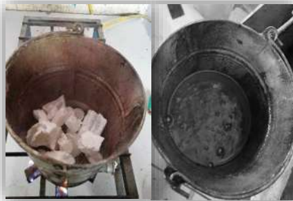
Figura 3.31. Se introduce en un recipiente parafina hasta convertirse en líquido, Fotografía: J.C. García Perdomo, 2018.
