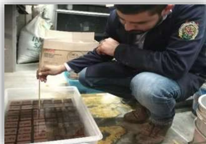
Figura 3.56. Se colocan las muestras completas restantes en la solución de sulfato de sodio en un transcurso de 5 ciclos, Fotografía: J.C. García Perdomo, 2018.
