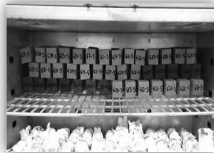
Figura 3.55. Las muestras se dejan secar en el horno a una temperatura no menor a 60^\circ\text{C} hasta obtener masa seca constante, Fotografía: J.C. García Perdomo, 2018.
