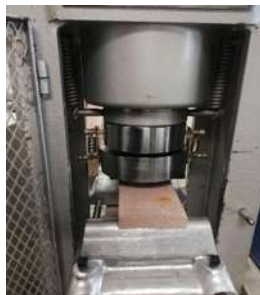
Figura 3.20. Colocar el espécimen en la prensa hidráulica, ajustar y nivelar, Fotografía: J.C. García Perdomo, 2018.
