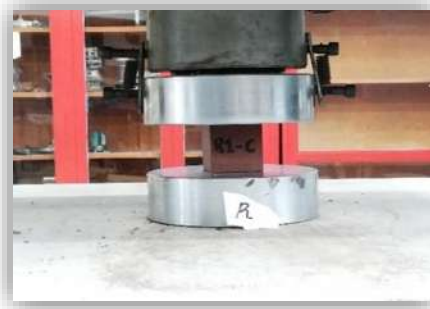
Figura 3.13. Se coloca la muestra cubica en la maquina Universal para ser analizada en prueba de compresión simple, Fotografía: J.C. García Perdomo, 2018.
