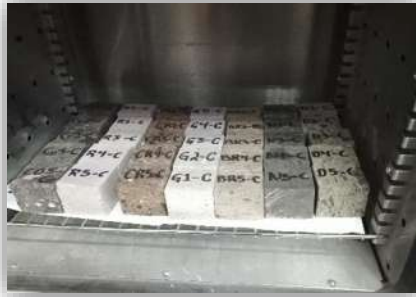
Figura 3.4. Muestras en el horno a temperatura 110^{\circ}\text{C} \pm 5^{\circ}\text{C} , hasta tener masa constante, Fotografía: J.C. García Perdomo, 2018.
