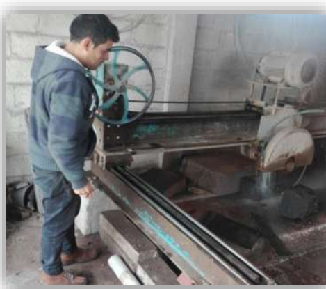
Figura 2.15. Corte de material con disco de diamante, Fotografía: J.C. García Perdomo, 2018.
