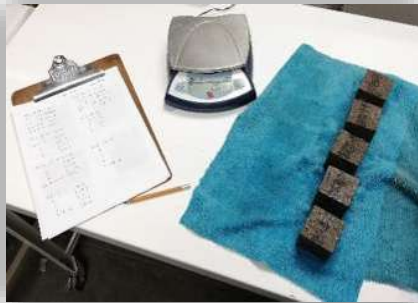
Figura 3.37. Secar superficialmente las muestras con franela y registrar la masa superficialmente seca, Fotografía: J.C. García Perdomo, 2018.
