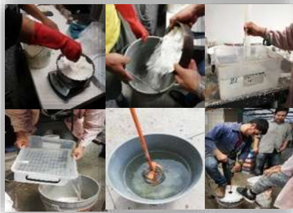
Figura 3.52. Preparación de solución de sulfato de sodio ( \text{Na}_2\text{SO}_4 ), Fotografía: J.C. García Perdomo, 2018.
