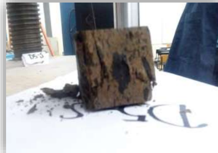
Figura 3.15. Punto de falla del material, mostrando su agrietamiento, así posteriormente se analizaron cinco muestras de los siete colores de prueba, Fotografía: J.C. García Perdomo, 2018.
