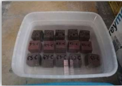
Figura 3.8. Muestras de cantera completamente saturadas con agua, en un periodo de tiempo de 24 horas, Fotografía: J.C. García Perdomo, 2018.
