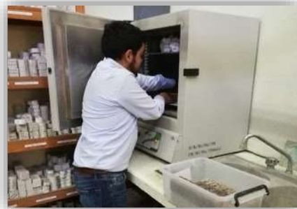
Figura 3.30. Se colocan las muestras en el horno a una temperatura 110\text{ }^{\circ}\text{C} \pm 5\text{ }^{\circ}\text{C} , hasta tener masa seca constante teniendo una diferencia de 0.5% de masa, Fotografía: J.C. García Perdomo, 2018.
