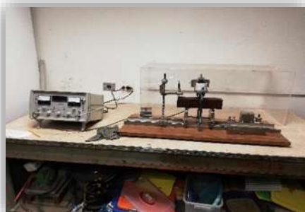
Figura 3.45. Se realiza prueba de Frecuencia de Resonancia, ciclo 0, Fotografía: J.C. García Perdomo, 2018.
