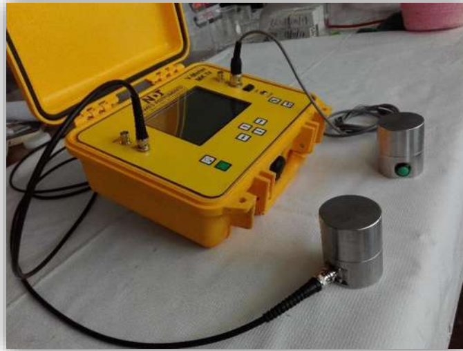
Figura 3.22. Aparato V-Meter Mk IV, marca James Instruments, para Velocidad de Pulso Ultrasónico, Fotografía: J.C. García Perdomo, 2018.
