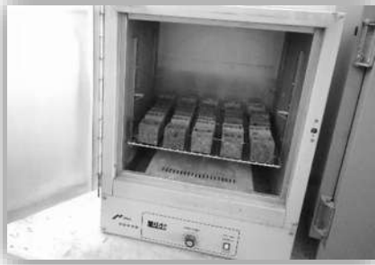
Figura 3.35. Se colocan 5 muestras de cada color en el horno a 110\text{ }^{\circ}\text{C} \pm 5^{\circ}\text{C} hasta tener masa seca constante, Fotografía: J.C. García Perdomo, 2018.
