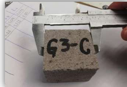
Figura 3.26. Se toman las dimensiones reales con un vernier, Fotografía: J.C. García Perdomo, 2018.
