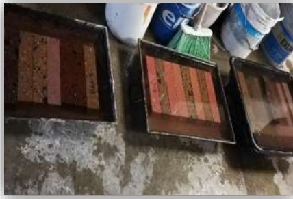
Figura 3.41. Las muestras en forma de prisma fueron sometidas en proceso de saturación por 48 horas hasta obtener masa constante, ciclo 0, Fotografía: J.C. García Perdomo, 2018.
