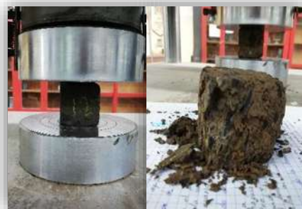
Figura 3.57. Se determina los parámetros mecánicos ensayando 5 muestras en cada ciclo, Fotografía: J.C. García Perdomo, 2018.
