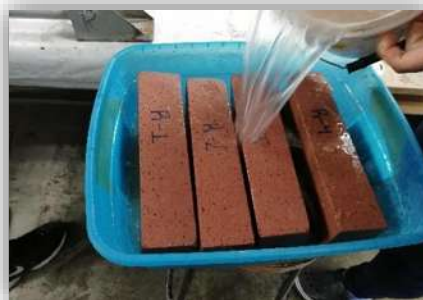
Figura 3.46. Se colocan 4 especímenes en cada recipiente, con un nivel de 3 mm sobre la superficie de la muestra, ciclo 0, Fotografía: J.C. García Perdomo, 2018.
