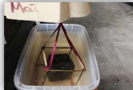
Figura 3.40. Se obtiene la masa específica por medio de una canastilla sumergida bajo el agua con el espécimen, Fotografía: J.C. García Perdomo, 2018.
