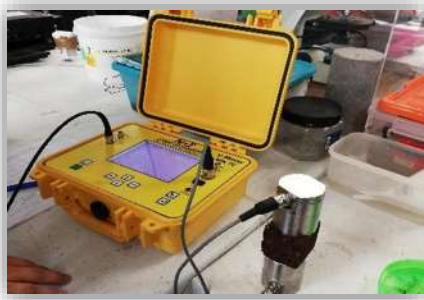
Figura 3.23. Transmisión directa con los traductores en las caras opuestas de la roca, Fotografía: J.C. García Perdomo, 2018.
