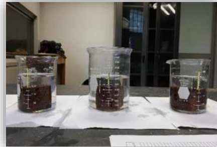
Figura 3.9. Vaso precipitado utilizado para medir el volumen de cada uno de los especímenes, misma función del picnómetro midiendo el agua que desaloja, Fotografía: J.C. García Perdomo, 2018.
