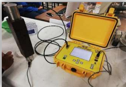
Figura 3.43. Se realiza la prueba de Velocidad de Pulso Ultrasónico, ciclo 0, Fotografía: J.C. García Perdomo, 2018.
