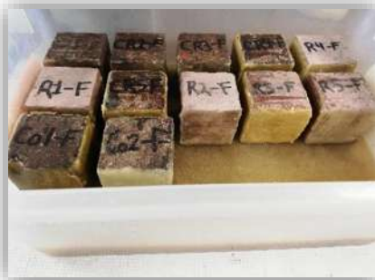
Figura 3.33. Se colocan las muestras en un recipiente con una esponja húmeda en el interior al fondo con un nivel de agua de 3 mm, Fotografía: J.C. García Perdomo, 2018.
