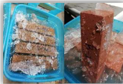
Figura 3.50. Conforme en cada ciclo de pruebas las muestras se congelan más por la penetración del hielo en los poros de la roca, Fotografía: J.C. García Perdomo, 2018.
