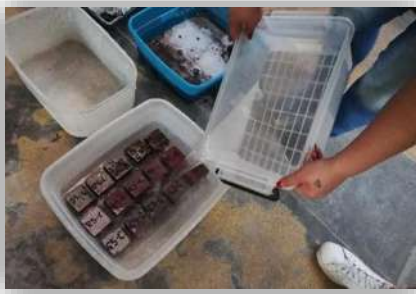
Figura 3.6. En un recipiente se colocan las muestras hasta quedar completamente saturadas de agua, Fotografía: J.C. García Perdomo, 2018.
