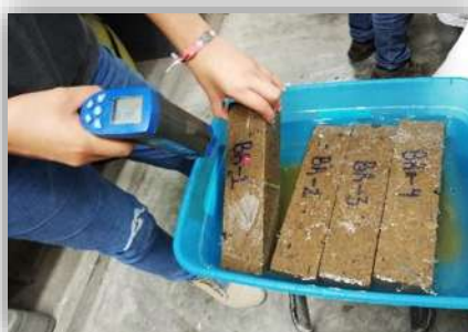
Figura 3.48. Se toma la temperatura cuando sale el recipiente de aparato enfriador con las muestras, Fotografía: J.C. García Perdomo, 2018.
