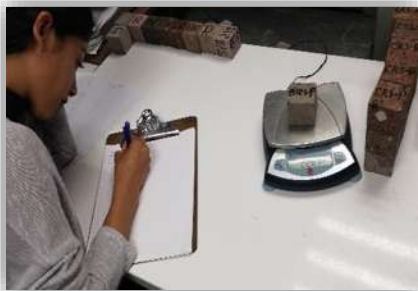
Figura 3.39. Se registra su masa saturada por ebullición superficialmente seca, Fotografía: J.C. García Perdomo, 2018.
