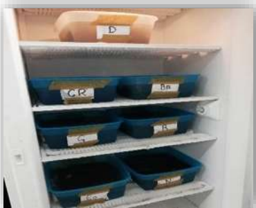
Figura 3.47. Se colocan todos los recipientes dentro del aparato enfriador cumpliendo un periodo de tiempo de 3 horas en el transcurso de cada ciclo, Fotografía: J.C. García Perdomo, 2018.
