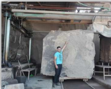
Figura 2.11. Maquinaria especial para corte en laminado de cantera, Fotografía: J.C. García Perdomo, 2018.
