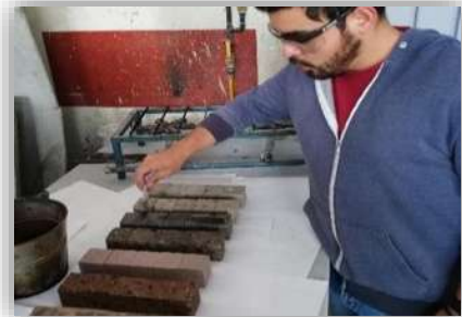
Figura 3.32. Se cubren 4 lados laterales de cada cubo con parafina y resina líquida, Fotografía: J.C. García Perdomo, 2018.
