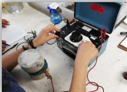
Figura 3.27. Se calibra el aparato resistómetro garantizando la conexión del amperímetro y voltímetro, Fotografía: J.C. García Perdomo, 2018.
