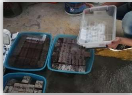
Figura 3.53. Se cubren las muestras con sulfato hasta quedar completamente saturadas y procurar un tirante de solución no menor de 13 mm por encima de la superficie del espécimen, Fotografía: J.C. García Perdomo, 2018.
