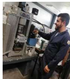
Figura 3.21. Aplicación de carga en el espécimen, Fotografía: J.C. García Perdomo, 2018.
