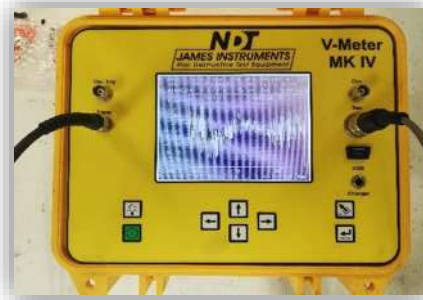
Figura 3.24. Registrando el valor más estable de la distancia en línea recta medida de centro a centro de la cara de los traductores, Fotografía: J.C. García Perdomo, 2018.
