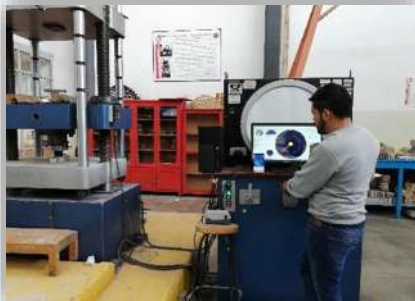
Figura 3.14. Se ajusta y nivela la maquina Universal, para aplicar carga y obtener su carga máxima, Fotografía: J.C. García Perdomo, 2018.
