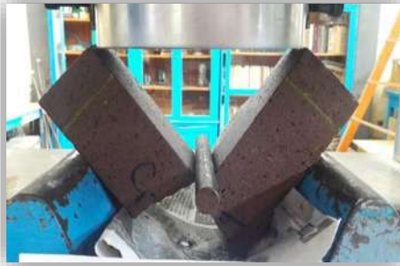
Figura 3.51. Se realiza prueba de Flexión Estática al final de todos los ciclos que fue sometido el espécimen, Fotografía: J.C. García Perdomo, 2018.
