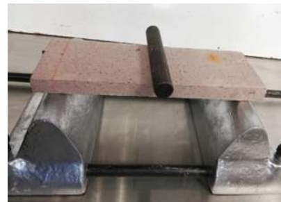
Figura 3.19. Marcar el punto centro donde se aplica la carga, Fotografía: J.C. García Perdomo, 2018.
