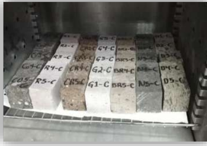
Figura 3.1. Determinación de masa seca constante en gramos a temperatura 110 \pm 5 °C, Fotografía: J.C. García Perdomo, 2018.
