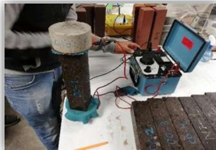
Figura 3.44. Se realiza la prueba de Resistividad Eléctrica, ciclo 0, Fotografía: J.C. García Perdomo, 2018.
