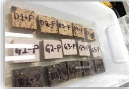
Figura 3.36. Se sumergen los cubos en agua hasta obtener una saturación total, Fotografía: J.C. García Perdomo, 2018.
