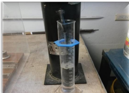
Ilustración 79. Medición del volumen de un espécimen.
