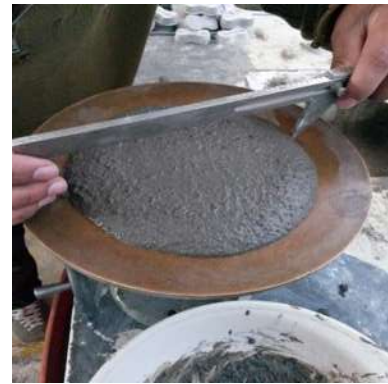
Ilustración 63. Medida del mortero extendido.
