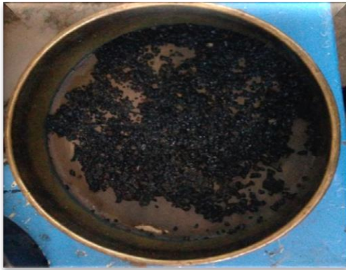
Ilustración 53. Material lavado y retenido en la malla #30.
