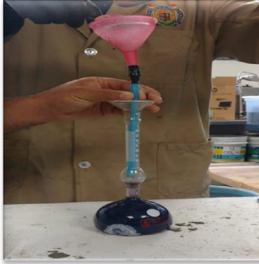
Ilustración 15. Se agrega cemento al vaso Le chatelier.
