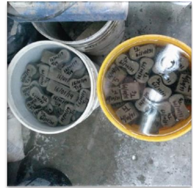
Ilustración 67. Curado de los especímenes.
