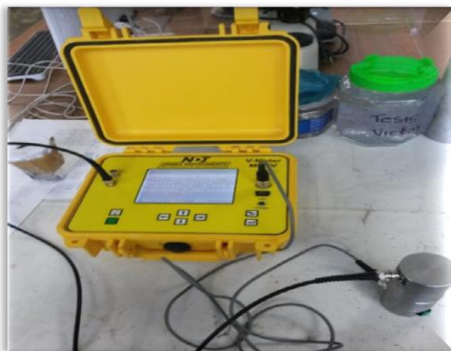
Ilustración 73. Aparato para la determinación de la VPU.
