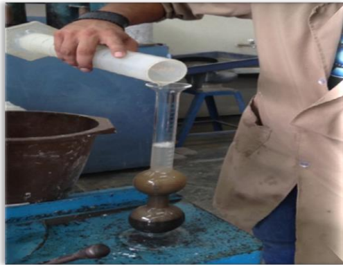
Ilustración 40. Agregando un volumen final (Vf).
