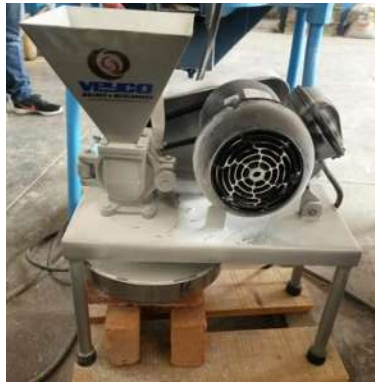
Ilustración 10. Aparato utilizado para el molido del arroz.
