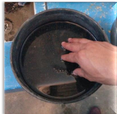
Ilustración 52. Eliminación de terrones de arcillas existentes.
