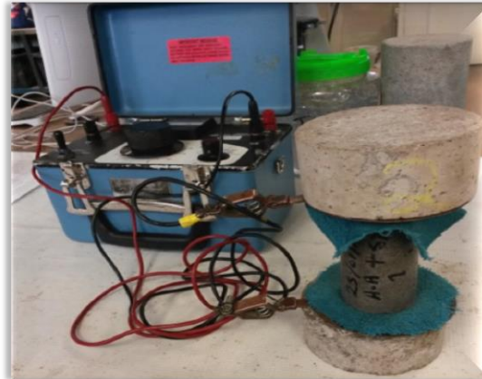
Ilustración 76. Determinación de la resistencia eléctrica en un cilindro.
