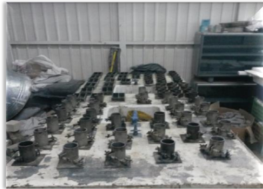
Ilustración 64. Moldes para la elaboración de los especímenes.
