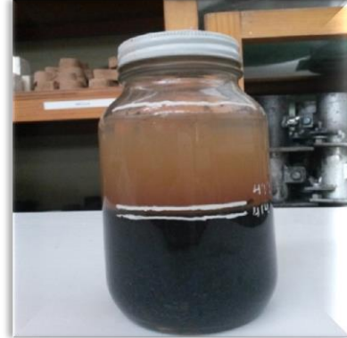
Ilustración 49. Sedimentación de la arena.
