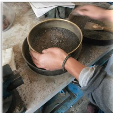
Ilustración 50. Material retenido en la malla #16.
