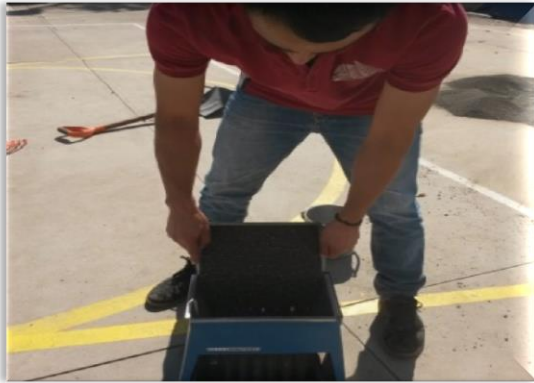
Ilustración 21. Vaciado de la muestra en el divisor de muestras (Cuarteador de Johnson).
