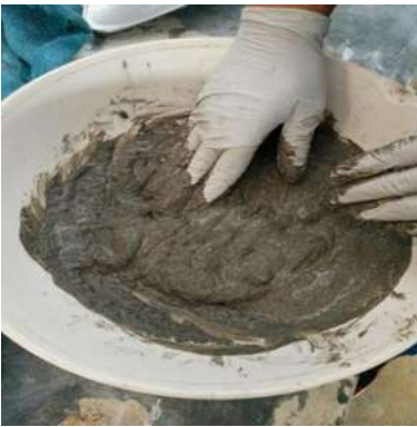
Ilustración 61. Mezcla para la determinación de la fluidez.
