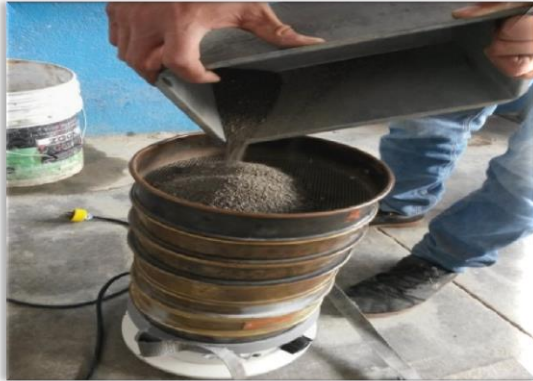
Ilustración 27. Vaciado de la muestra en el Raf-tap.
