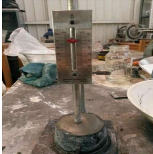
Ilustración 17. Consistencia normal del cemento.
