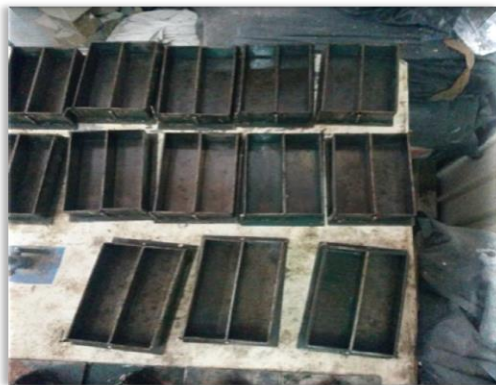
Ilustración 68. Moldes para la elaboración de prismas.
