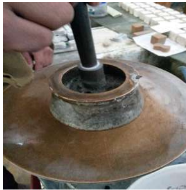
Ilustración 62. Compactación con el pizón en cada capa.
