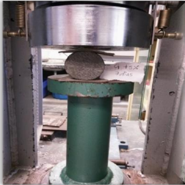
Ilustración 84. Colocación del espécimen en la prensa hidráulica.
