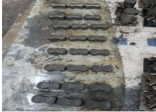
Ilustración 71. Briquetas realizadas en una mezcla.
