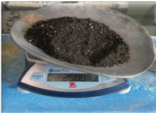
Ilustración 35. Peso de masa saturada superficialmente seca.
