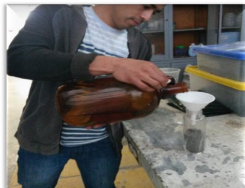
Ilustración 43. Adición de sosa cáustica.
