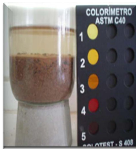
Ilustración 46. Colorímetro (ASTM C40, 2019).
