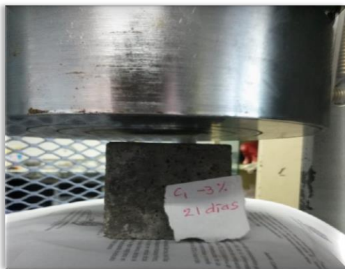
Ilustración 80. Colocación del espécimen en la prensa hidráulica.
