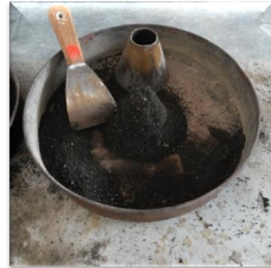
Ilustración 34. Masa saturada superficialmente seca.
