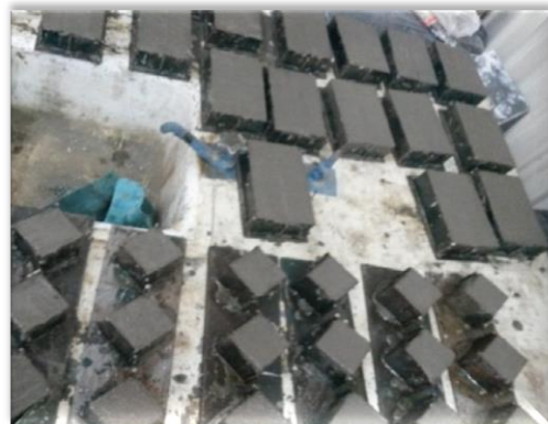
Ilustración 69. Prismas realizados en una mezcla.
