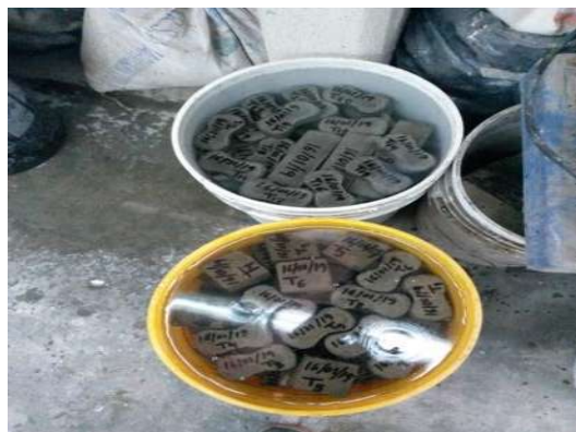
Ilustración 72. Curado de los especímenes de una mezcla.
