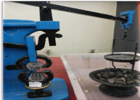
Ilustración 87. Falla de la briqueta.
