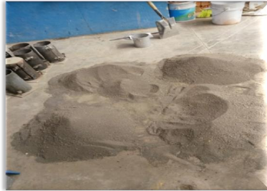
Ilustración 20. Material dividido en 4 partes iguales (Cuarteo).
