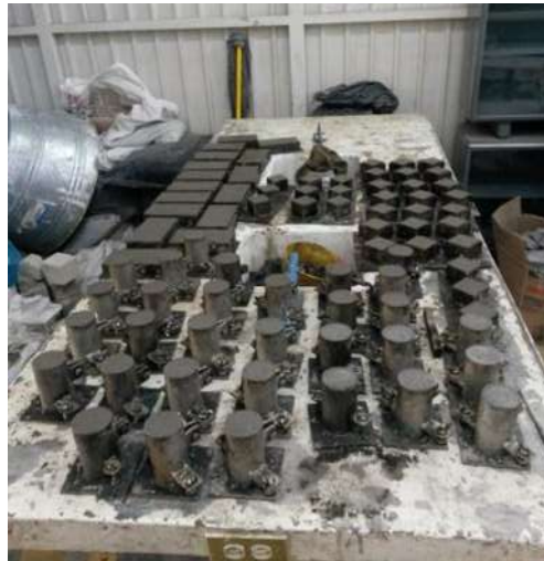
Ilustración 70. Cilindros realizados en una mezcla.
