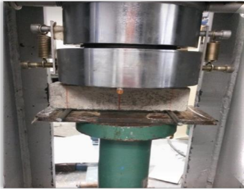
Ilustración 82. Espécimen colocado en la prensa hidráulica.
