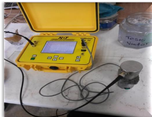
Ilustración 74. Determinación de la VPU en un espécimen de cubo.
