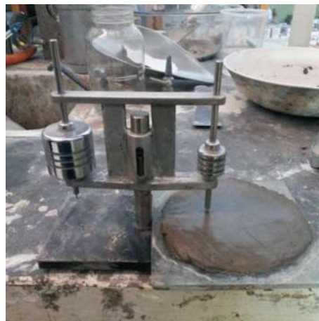
Ilustración 18. Determinación del fraguado inicial.
