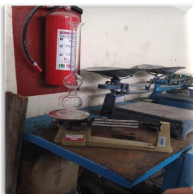
Ilustración 38. Peso de la probeta con un vol. inicial (F).
