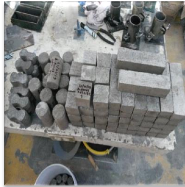
Ilustración 66. Terminación desmolde de especímenes.
