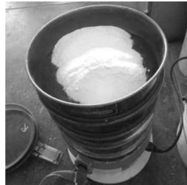
Ilustración 11. Análisis granulométrico por medio del aparato Raf-Tap.
