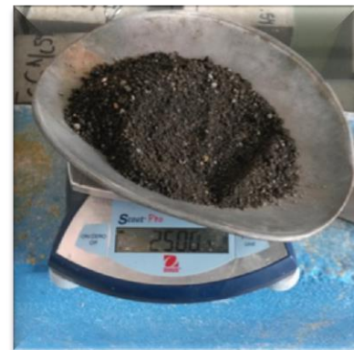
Ilustración 39. Peso de la muestra superficialmente seca (As).
