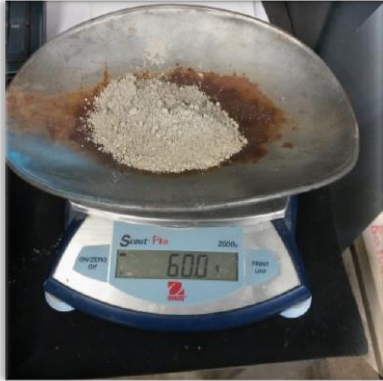
Ilustración 14. Peso del cemento.
