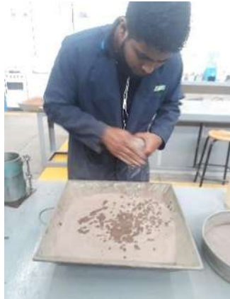
Figura 5.23 Incorporación del agua.
