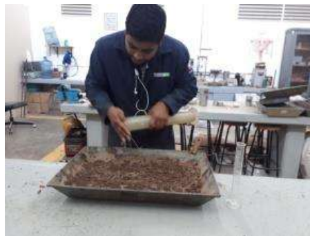
Figura 5.35 Incorporación del agua.
