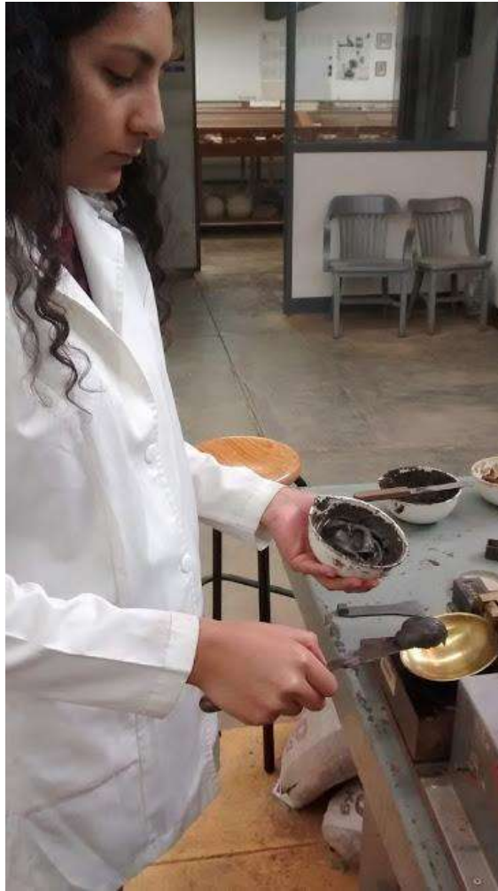
Imagen 58. Muestra colocada en copa de Casagrande
