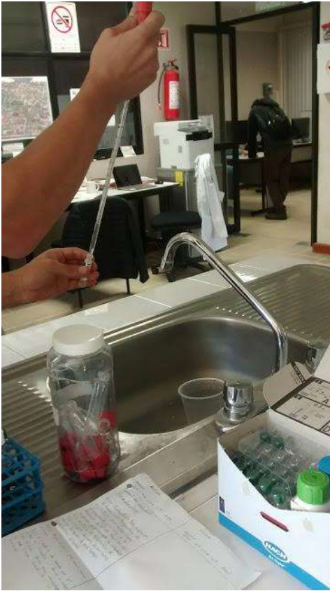
Imagen 50. Adición de reactivos para determinación de N
