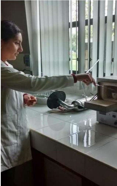
Imagen 52. Calcinación de la composta
