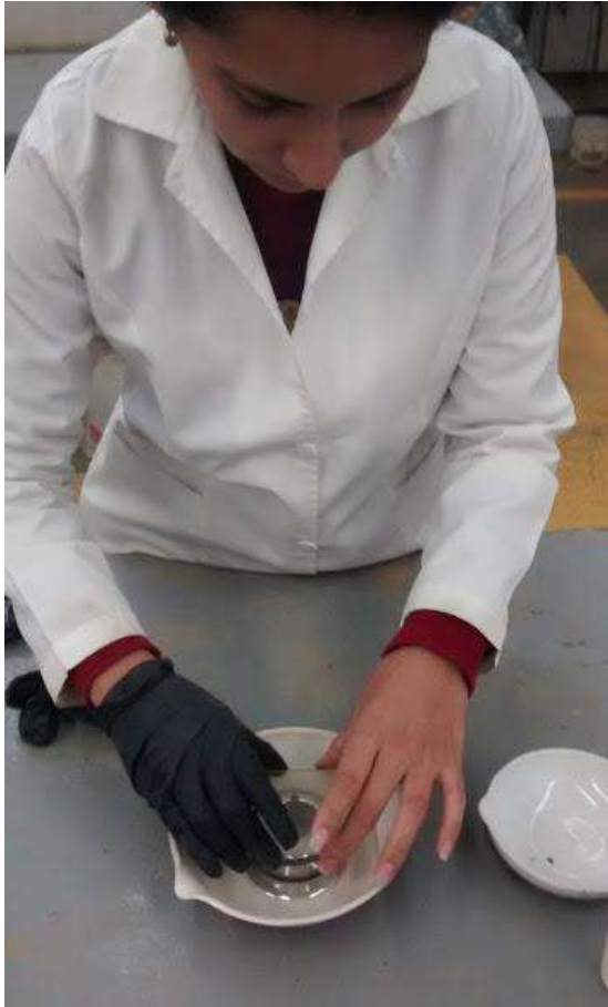
Imagen 64. Desborde de exceso de mercurio
