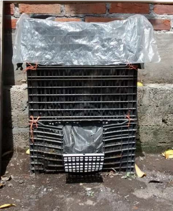
Imagen 15. Reactor compostero bajo el sol
