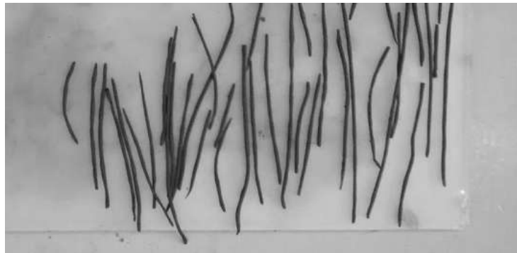
Imagen 60. Cilindros para medir límite plástico
