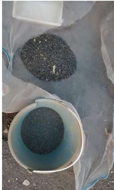
Imagen 22. Cribado de material granular (arenas)
