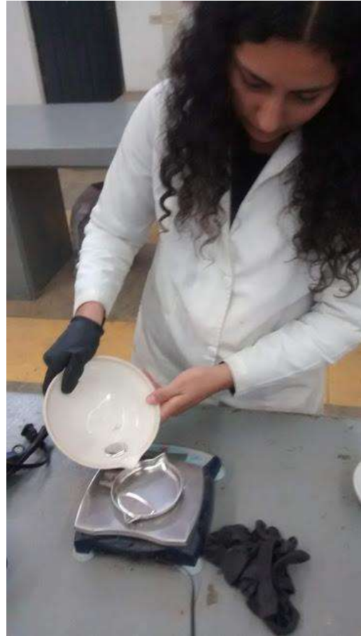
Imagen 65. Volumen desplazado de mercurio
