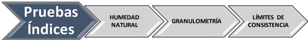
Por las condiciones que presentan los materiales, no fue posible realizar muestras inalteradas por lo que se decidió realizar muestras RE MOLDEADAS, a las cuales se les realizaron los siguientes ensayos:
