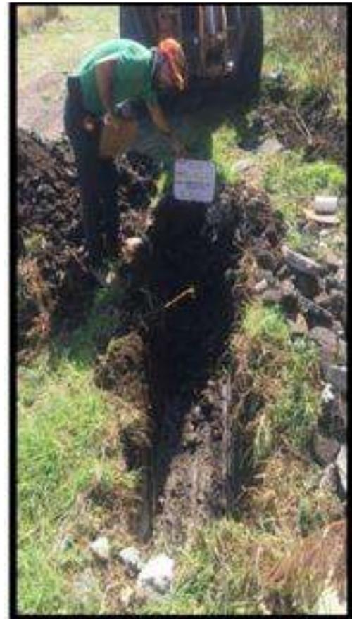
*Ilustración 52, Foto 12, Vista al sitio para la realización del P.CA.5, Mostrándose el material a una profundidad de 1.50 mts.*
