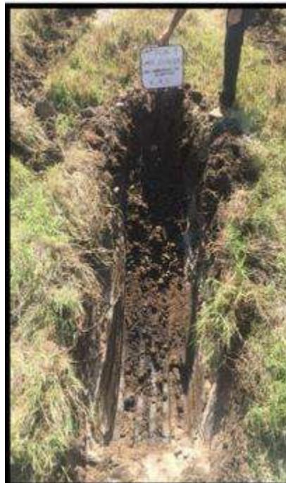
*Ilustración 50, Foto 10, Vista al sitio para la realización del P.CA.4, Mostrándose el material a una profundidad de 2.20 mts.*
