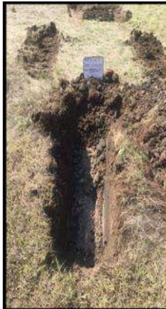
**Ilustración 48**, Foto 8, Vista al sitio para la realización del P.C.A.3, Mostrándose el material a una profundidad de 1.90 mts.
