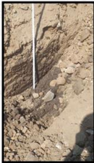
Foto 6.- Toma de estratigrafía en el pozo a cielo abierto.
