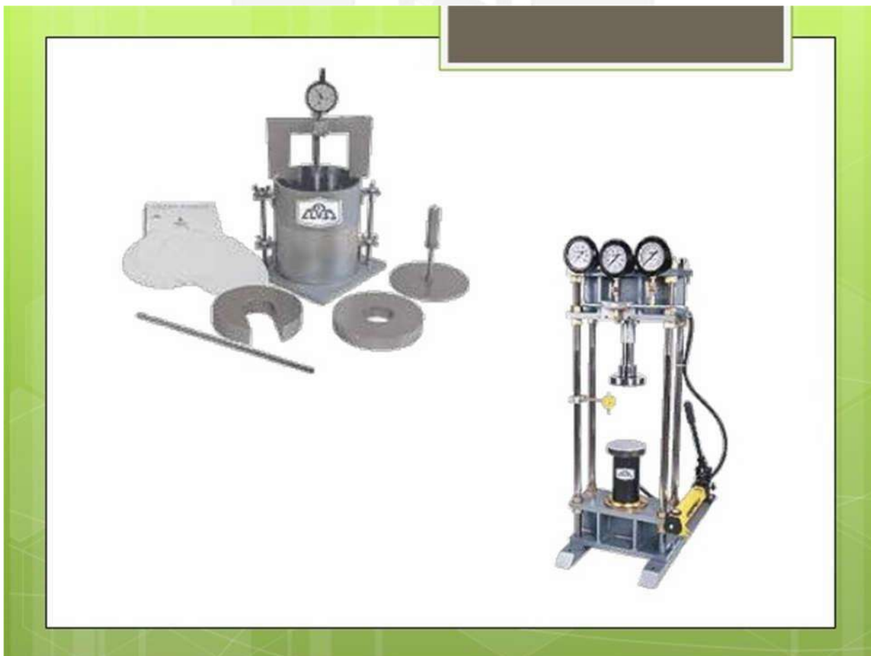
Ilustración 22, Equipo para realizar la prueba del Valor Relativo de Soporte (VRS)
