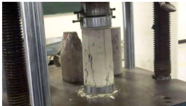
Ilustración 2.11.1-3 Cilindro fracturado por carga axial en sus extremos.
