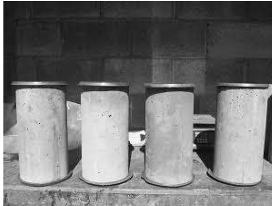
Ilustración 2.11.1-2 Cilindros de concretos cabeceados listos para probar a compresión.
