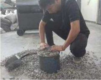
Ilustración 3.7-4. Enrasado manual del material grueso
