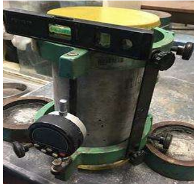
Ilustración 3.16.2-2. Anillos para deformación colocados y nivelados
