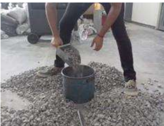
Ilustración 3.7-3. Vertiendo el material en el recipiente de lamina
