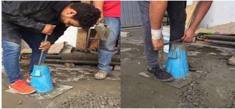
Ilustración 3.15.1-2. Llenando la última capa del cono de revenimiento para posteriormente aplanar la superficie.
