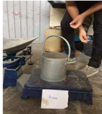
Ilustración 3.4-4. Pesado de agregado fino
