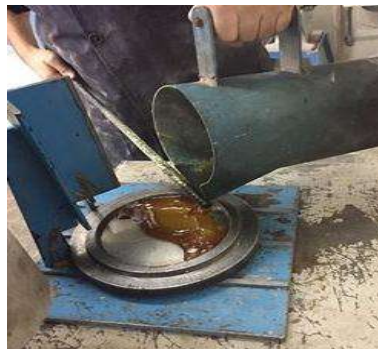
Ilustración 3.16.1-2. Azufre liquido vertiéndose en el molde de cabeceo
