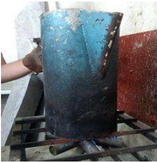
Ilustración 3.16.1-1. Azufre calentándose en la parrilla para cabeceo de cilindros
