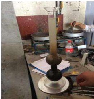
Ilustración 3.6-4. Probeta con agua y muestra del material cribado
