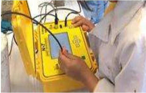
Ilustración 3.17.2-1. Calibrando el equipo de velocidad de pulso
