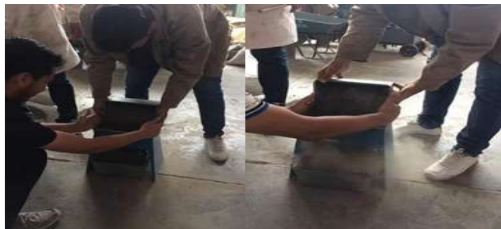
Ilustración 3.2-1. Cuarteo de material granular fino, con divisor de muestras.
