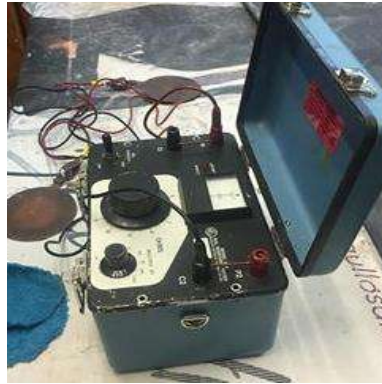
Ilustración 3.17.1-1. Tablero preparado de la pila de la máquina de resistividad eléctrica
