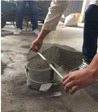
Ilustración 3.4-3. Enrasado de agregado fino
