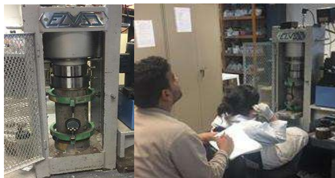
Ilustración 3.16.2-3. Compresora aplicando carga a cilindro para obtener módulos de deformación
