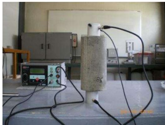
Ilustración 2.12.2.1-4. Aparato para medir la velocidad de pulso del cilindro de concreto.
