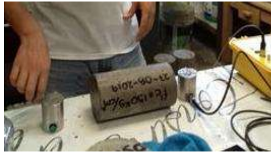
Ilustración 3.17.2-2. Colocando gel en los transductores
