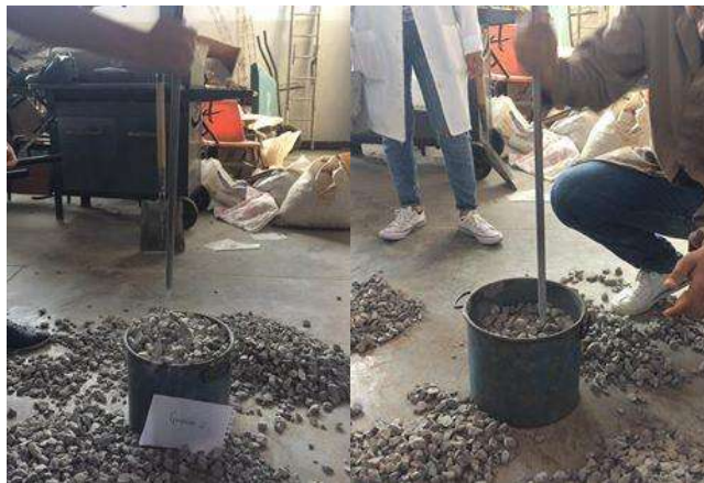
Ilustración 3.13-1. Capas de grava siendo varilladas
