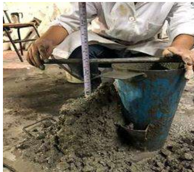
Ilustración 3.15.1-3. Midiendo el revenimiento con cinta métrica.
