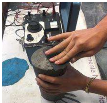
Ilustración 3.17.1-2. Cara del cilindro siendo lijada
