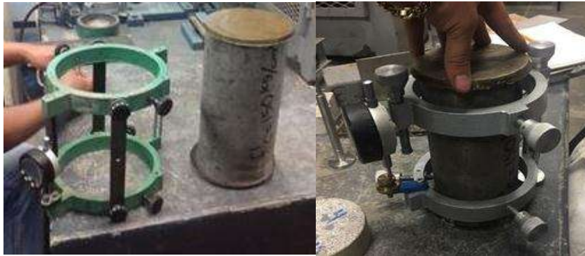
Ilustración 3.16.2-1. Colocación de los anillos perimetrales de medición para la deformación
