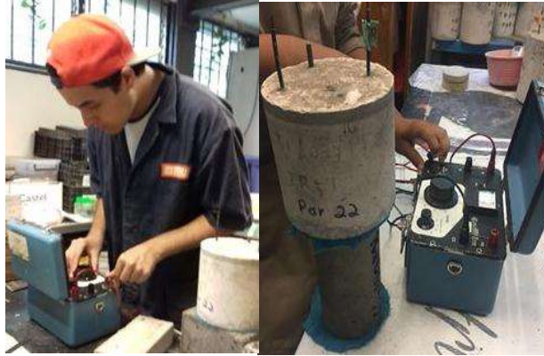
Ilustración 3.17.1-3. Realizando prueba de resistividad eléctrica
