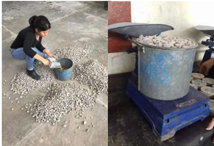
Ilustración 3.12-1. Pesado de un volumen de grava seca y suelta
