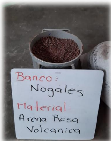
Figura 82.- Dosificación de los materiales por volumen en botes de 5 litros. (Contreras, 2019)
