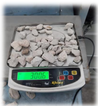
Figura 57.- Masa húmeda de la muestra. (Contreras, 2019)
