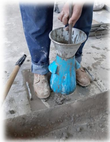
Figura 85.- Compactación de cada capa 25 veces con la varilla. (Contreras, 2019)
