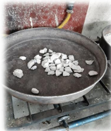
Figura 58.- Material en la parrilla para eliminar la humedad. (Contreras, 2019)
