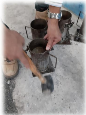
Figura 89.- Vibrado suave con mazo de goma para eliminar las oquedades. (Contreras, 2019)
