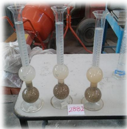
Figura 41.- Frasco con arena y agua, hasta la marca de 450 ml. (Contreras, 2019)
