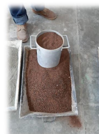
Figura 80.- Dosificación de la arena en botes de 5 litros. (Contreras, 2019)
