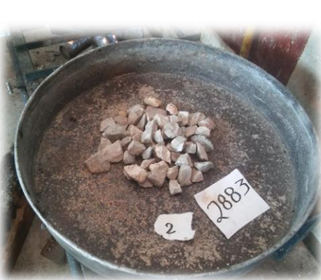
Figura 62.- Secado del material en la parrilla eléctrica. (Contreras, 2019)
