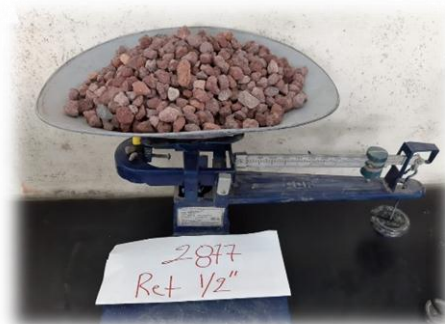
Figura 68.- Obtención del peso del material retenido en las mallas. (Contreras, 2019)
