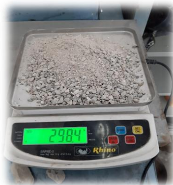
Figura 35.- Masa de la muestra completamente seca. (Contreras, 2019)
