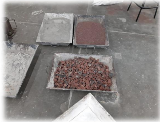
Figura 81.- Cantidades de materiales necesarios para la mezcla de concreto. (Contreras, 2019)
