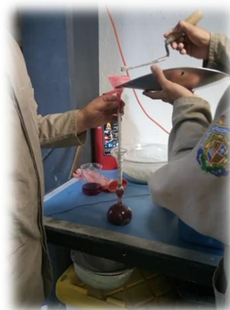
Figura 75.- Se introduce el cemento en el frasco para determinar su volumen. (Contreras, 2019)
