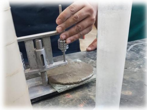
Figura 71.- Determinación del fraguado inicial con la aguja más ligera del aparato de Gillmore. (Contreras, 2019)
