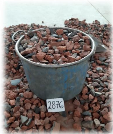
Figura 53.- Recipiente lleno y enrasado con la mano. (Contreras, 2019)
