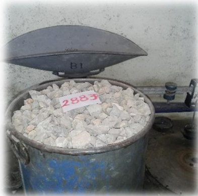
Figura 67.- Masa de la muestra para la granulometría. (Contreras, 2019)
