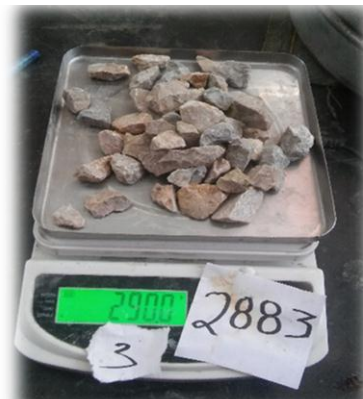
Figura 63.- Masa del material completamente seco. (Contreras, 2019)
