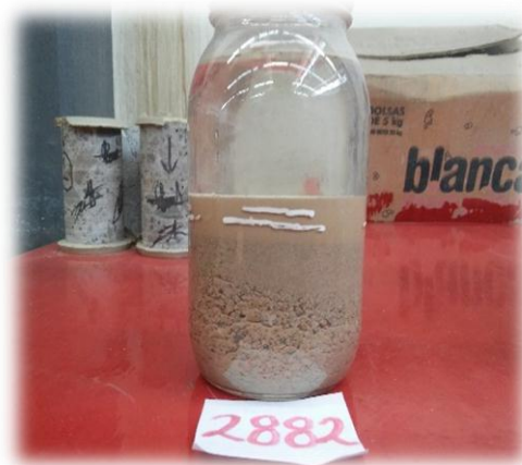
Figura 49.- Después de 24 horas se observa que el material fino rebasa la marca de 444 ml. (Contreras, 2019)
