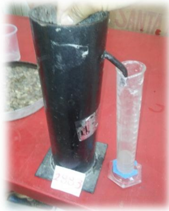
Figura 65.- Introduciendo el material dentro del picnómetro. (Contreras, 2019)
