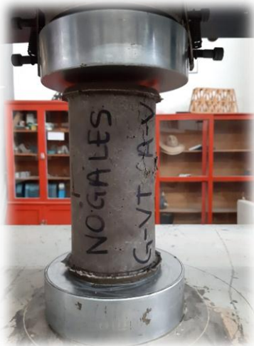
Figura 100.- Espécimen de concreto fallado después de aplicar la carga de compresión. (Contreras, 2019)
