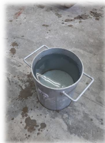
Figura 79.- Dosificación del agua en botes de 5 litros. (Contreras, 2019)
