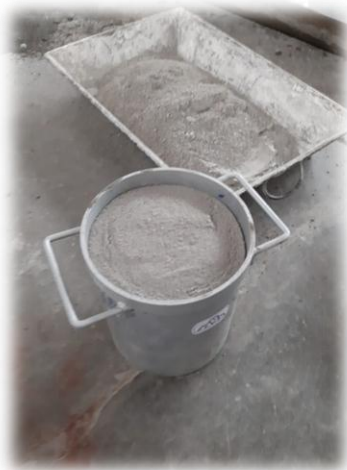
Figura 78.- Dosificación del cemento en botes de 5 litros. (Contreras, 2019)
