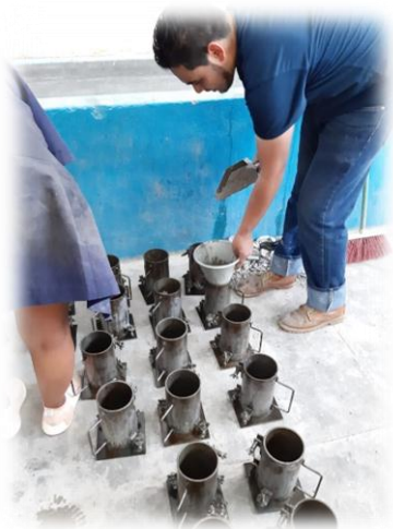
Figura 87.- Vaciado de la mezcla de concreto en los especímenes cilíndricos de 10x20cm. (Contreras, 2019)
