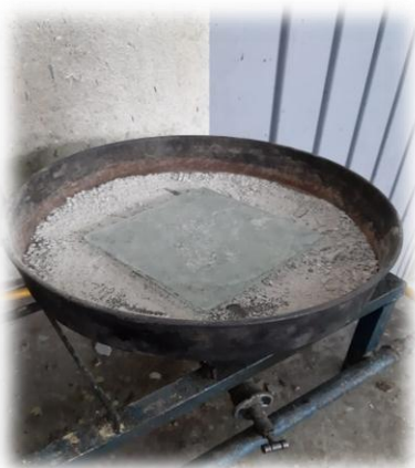
Figura 36.- Cristal sobre el material para verificar que está seco. (Contreras, 2019)
