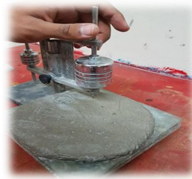
Figura 72.- Determinación del fraguado final con la aguja más pesada del aparato de Gillmore. (Contreras, 2019)
