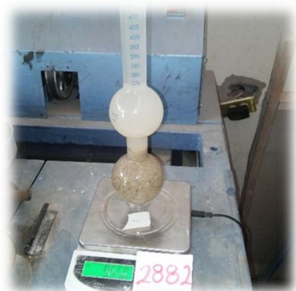
Figura 42.- Peso del frasco junto con la arena y el agua. (Contreras, 2019)
