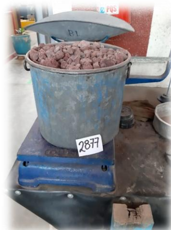
Figura 55.- Masa del recipiente más el peso del material compactado (Contreras, 2019)
