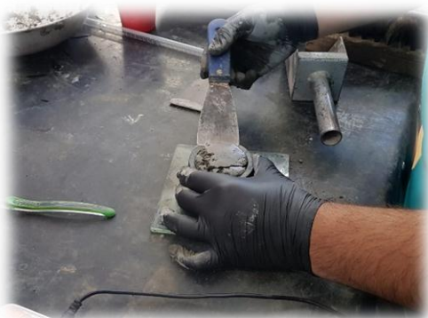
Figura 69.- Se enrasa la boca superior del anillo con ayuda de la espátula. (Contreras, 2019)
