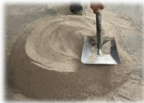
Figura 24.- Aplanado de la parte superior del montículo de arena, por medio de la pala. (Contreras, 2019)
