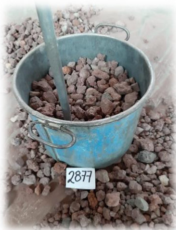
Figura 56.- Compactado del material con la varilla punta de bala. (Contreras, 2019)
