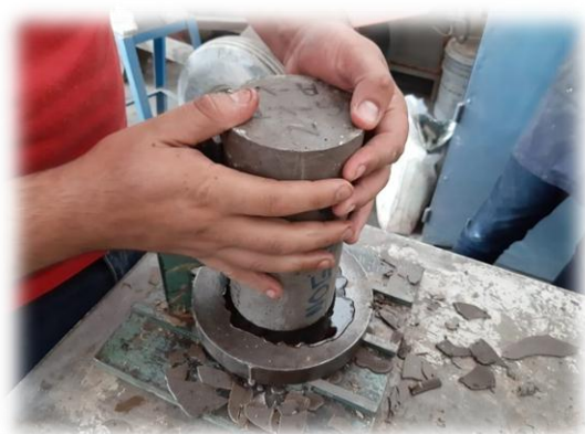
Figura 96.- Cilindro de concreto ajustado a las guías y centrado en el molde con azufre. (Contreras, 2019)
