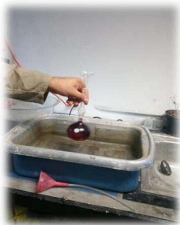
Figura 76.- Recipiente con agua, para mantener la temperatura constante durante la prueba. (Contreras, 2019)
