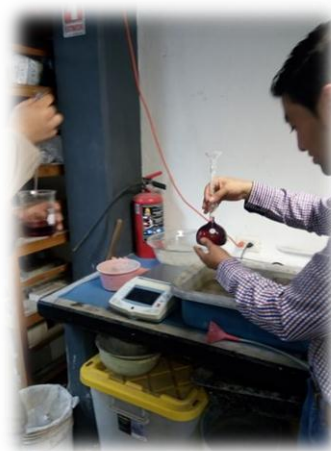
Figura 73.- Líquido que no reaccione con el cemento en el frasco (Contreras, 2019)
