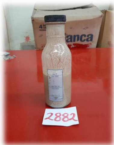
Figura 48.- Frasco con la arena y la solución de sosa caustica. (Contreras, 2019)
