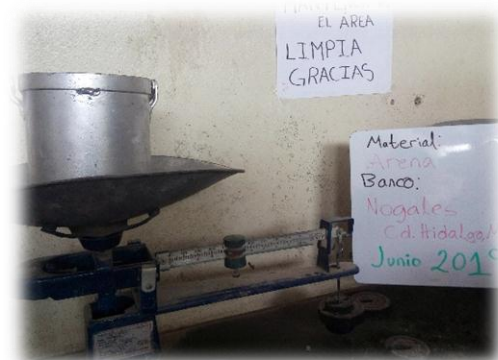
Figura 30.- Masa de la arena con el recipiente. (Contreras, 2019)
