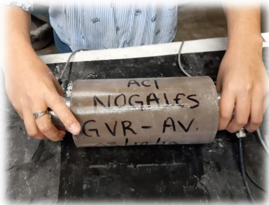
Figura 93.- Transductores y caras del espécimen en contacto, con gel para garantizar el buen funcionamiento. (Contreras, 2019)
