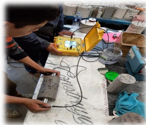
Figura 94.- Obtención de la velocidad de pulso ultrasónico a través de concreto, en m/s. (Contreras, 2019)
