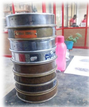
Figura 44.- Mallas acopladas en orden decreciente. (Contreras, 2019)
