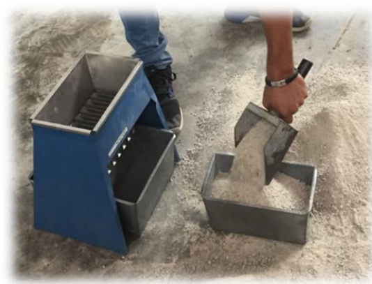
Figura 22.- Cuarteado después de aplanar con el montículo. (Contreras, 2019)
