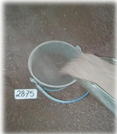
Figura 27.- Vaciado de la arena en el recipiente con volumen y masa conocida. (Contreras, 2019)
