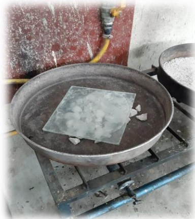
Figura 59.- Cristal sobre el material para verificar su secado. (Contreras, 2019)
