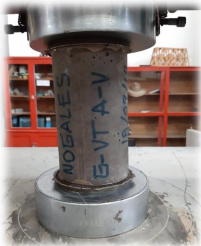
Figura 98.- Platina ajustada al espécimen para proceder a aplicar carga. (Contreras, 2019)
