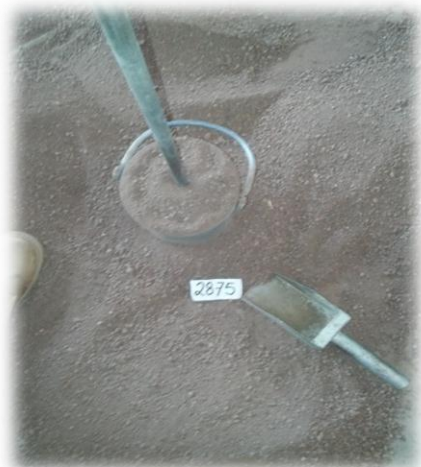
Figura 31.- Compactación de la arena con ayuda de la varilla punta de bala. (Contreras, 2019)
