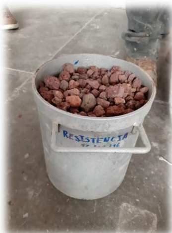
Figura 77.- Dosificación de la grava en botes de 5 litros. (Contreras, 2019)
