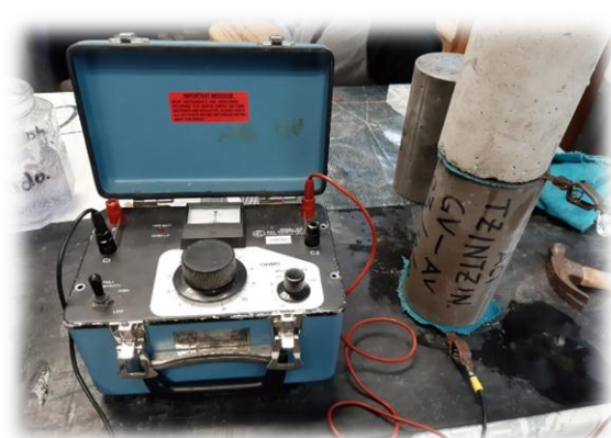
Figura 92.- Resistómetro conectado y preparado para la obtención de la resistividad, en ohm (Contreras, 2019)
