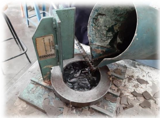
Figura 95.- Azufre líquido en los moldes, para proceder a cabecear la cara del cilindro de concreto. (Contreras, 2019)
