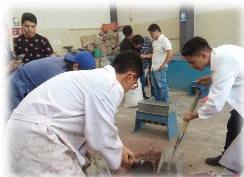
Figura 52.- Cuarteo por el divisor de muestras. (Contreras, 2019)
