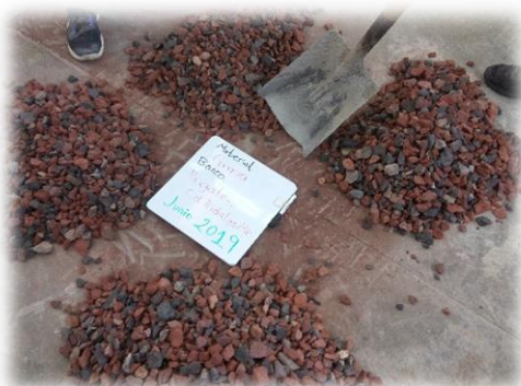
Figura 51.- Cuarteo manual o por paleado. (Contreras, 2019)
