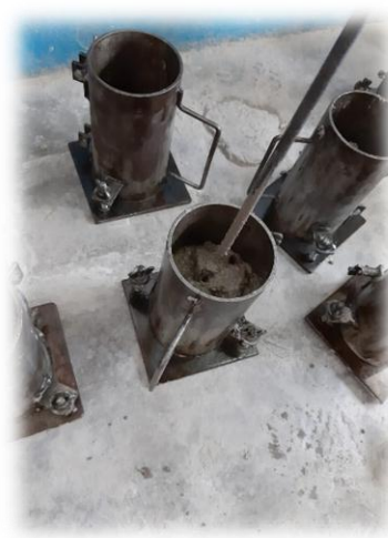
Figura 88.- Varillado de los especímenes con la varilla de 3/8". (Contreras, 2019)
