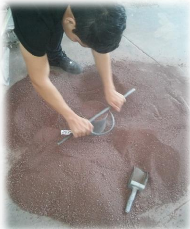
Figura 29.- Enrasado del recipiente con ayuda de la varilla. (Contreras, 2019)
