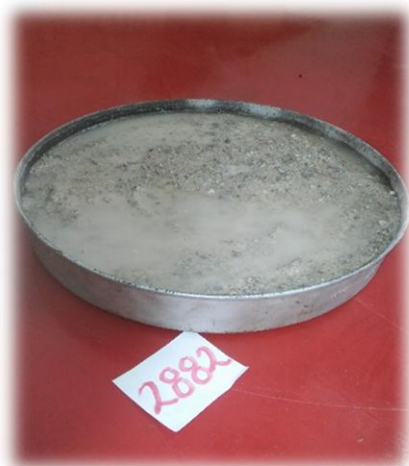
Figura 38.- Arena saturada con agua. (Contreras, 2019)
