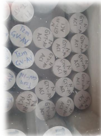
Figura 90.- Curado de los especímenes en la pila de curado para evitar la pérdida de humedad. (Contreras, 2019)
