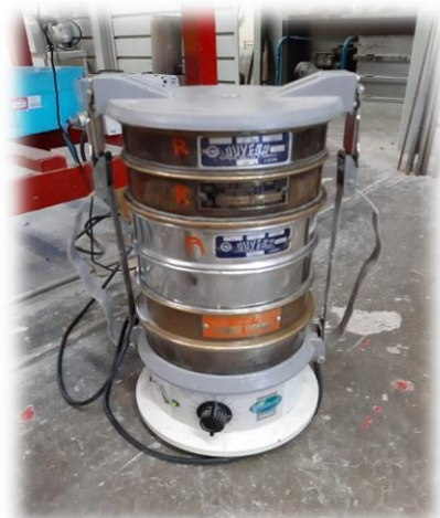
Figura 45.- Agitado de las mallas por medio de dispositivo mecánico (Raf-tap). (Contreras, 2019)
