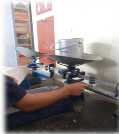
Figura 32.- Obtención de la masa de la arena con el recipiente. (Contreras, 2019)
