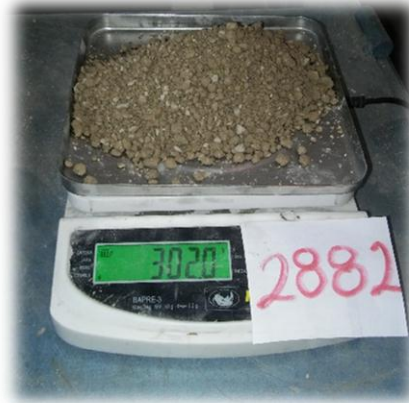
Figura 39.- Masa de la arena saturada y superficialmente seca. (Contreras, 2019)
