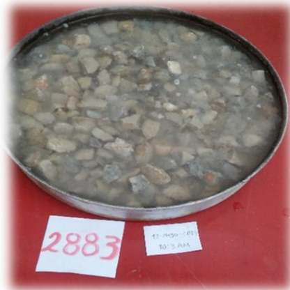
Figura 61.- Muestra de grava saturada en agua durante 24 horas. (Contreras, 2019)
