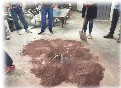
Figura 28.- Llenado del recipiente, sobrepasando el borde. (Contreras, 2019)
