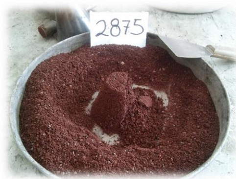
Figura 37.- Arena saturada y superficialmente seca. (Contreras, 2019)
