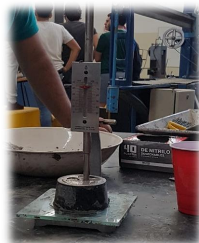
Figura 70.- Lectura de penetración del aparato de Vicat. (Contreras, 2019)
