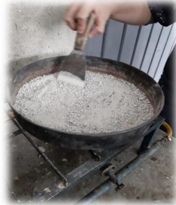
Figura 34.- Secado de la arena con la parrilla eléctrica. (Contreras, 2019)
