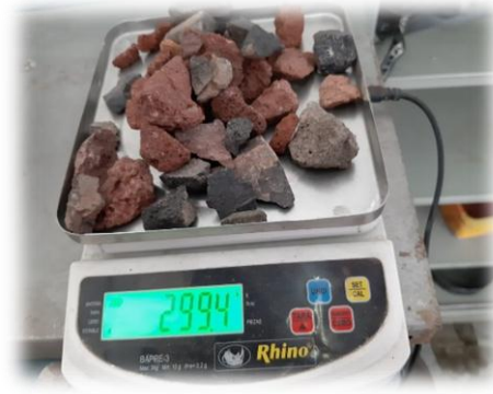
Figura 60.- Masa del material completamente seco. (Contreras, 2019)
