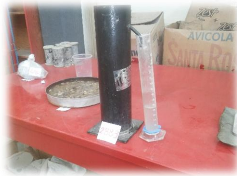
Figura 66.- Agua desalojada por el picnómetro, la cual corresponde al volumen de la grava. (Contreras, 2019)
