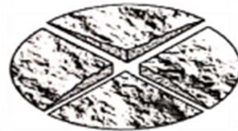
Figura 25.- Muestra de arena dividida en cuartos. (NMX-C-170-ONNCCE, 1997)
