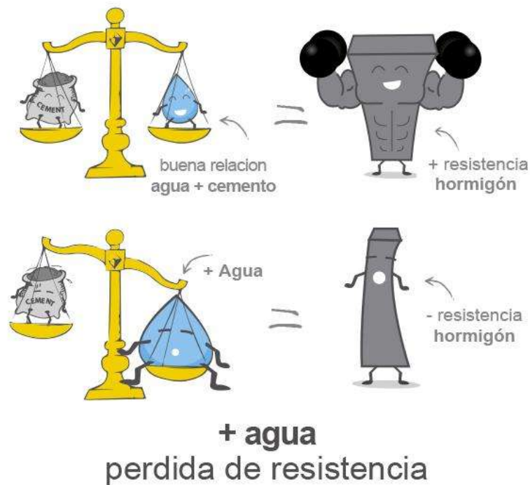
Figura 3.- Efecto de la cantidad de agua en la resistencia del concreto. (Putzmeister, 2019)
