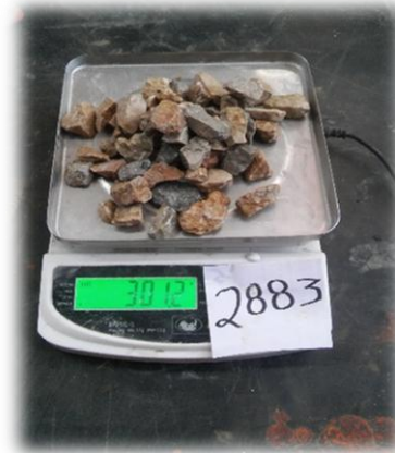
Figura 64.- Masa del material saturado y superficialmente seco. (Contreras, 2019)
