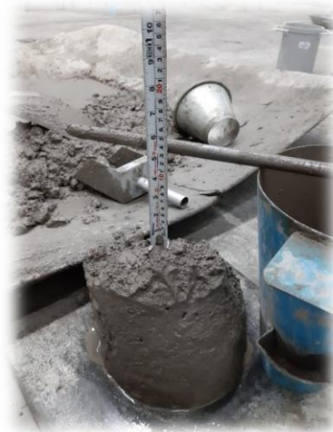
Figura 86.- Obtención del revenimiento de la mezcla de concreto fresco. (Contreras, 2019)
