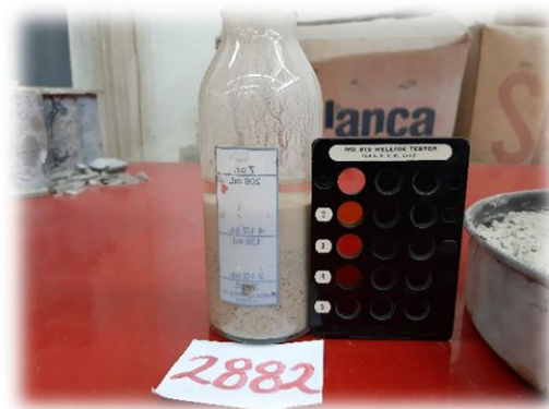
Figura 47.- Comparación del color del líquido de la botella con la tabla colorimétrica. (Contreras, 2019)
