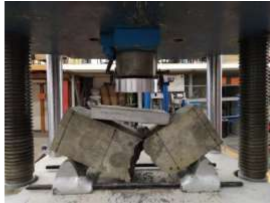
Ilustración 45. Falla frágil en las mezclas que no contienen adición de fibras de acero. (Fuente Antonio M)
