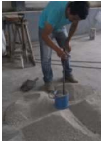
Ilustración 15. Llenado y varillado de MVSV (Fotografía Florentino M)
