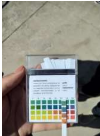
Ilustración 42. Lectura de pH en cada una de las mezclas (Fotografía Antonio M)
