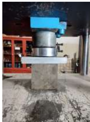
Ilustración 34. Aplicación de carga para prueba de compresión en especímenes prismáticos.
