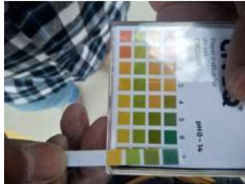
Ilustración 38. Lectura de pH a una solución de agua y sílice (Fuente Antonio M)
