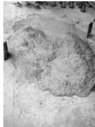
Ilustración 39a y 33b. Consistencia de las mezclas de concreto con revenimiento mayor a 20 cm (Fotografía Antonio M)
