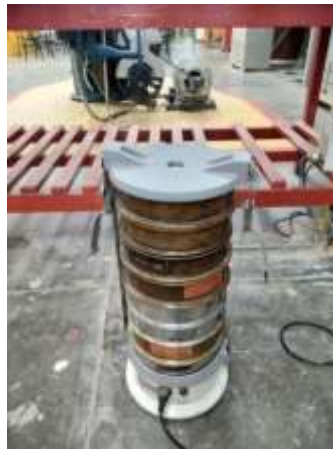
Ilustración 18. Agitado mecánico (Raf-tap) (Fotografía Antonio M).
