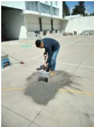
Ilustración 10. Homogenización del material (Fotografía Antonio M)
