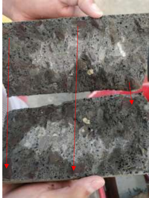
Ilustración 44. La falla que rige en los especímenes a edades de 45 y 60 días es la fractura del agregado. (Fuente Antonio M)
