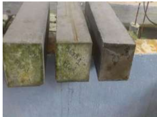
Ilustración 35. Especímenes prismáticos para ensayar en prueba a flexión. (Fuente Antonio M)
