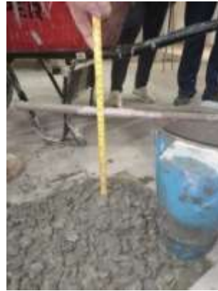
Ilustración 40. Prueba de revenimiento, resultado 19.5cm (Fotografía Antonio M)
