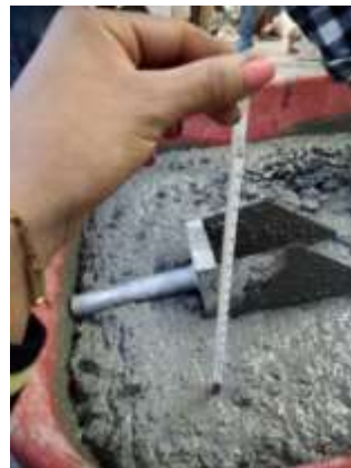
Ilustración 41. Lectura de temperatura en cada una de las mezclas (Fotografía Antonio M)
