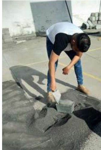
Ilustración 12. División de la muestra en 4 partes iguales (Fotografía J. Méndez).
