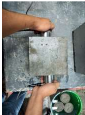
Ilustración 32. Medición de velocidad de pulso ultrasónico a espécimen prismático para corroborar homogeneidad en la mezcla (Fuente Antonio M)
