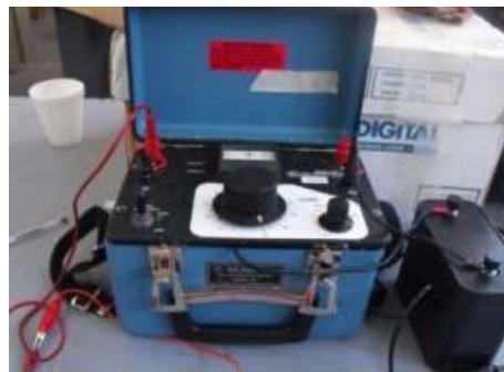
Ilustración 29. Equipo para medir la resistividad "Resistometro". (Fuente Antonio M)
