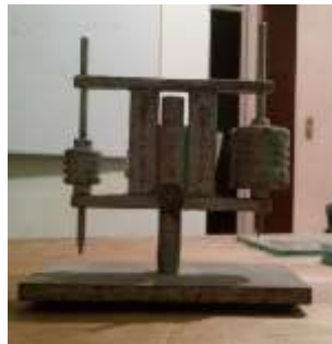
Ilustración 6 Aparato de Guillmore (Fotografía Antonio M.)
