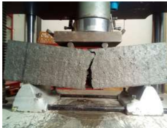
Ilustración 46. Falla dúctil en las mezclas adicionadas con fibras de acero, soportando incluso una carga permanente de 2500 kg. (Fuente Antonio M)
