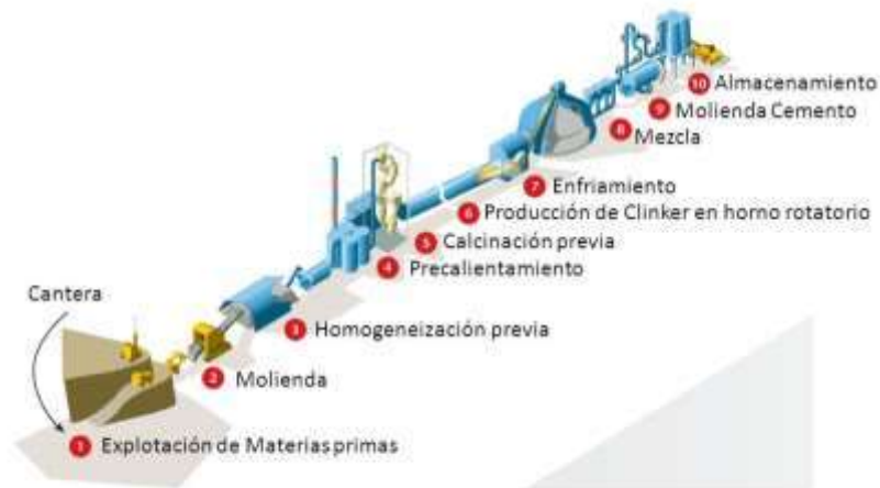
Ilustración 3. Esquema del proceso de producción del cemento. (IMCYC 2014)
