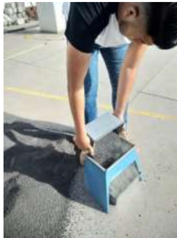
Ilustración 8. Agregando el material al divisor de muestras mecánico (Fotografía Antonio M).
