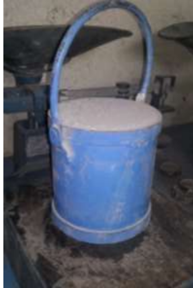
Ilustración 14. Llenado y pesado de la muestra en M.V.S.S (Fotografía Antonio M).
