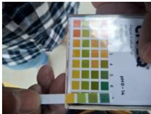
Ilustración 28. Lectura del pH a una mezcla de sílice disuelta (Fotografía Antonio M).
