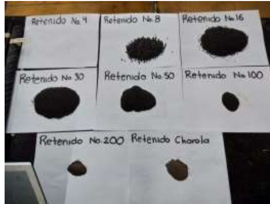
Ilustración 19. Separación de los retenidos en cada malla (Fotografía Antonio M).
