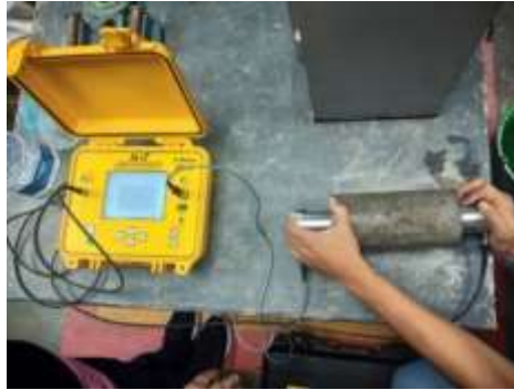
Ilustración 31. Lectura de la velocidad de pulso ultrasónico a espécimen cilíndrico (Fuente Antonio M)
