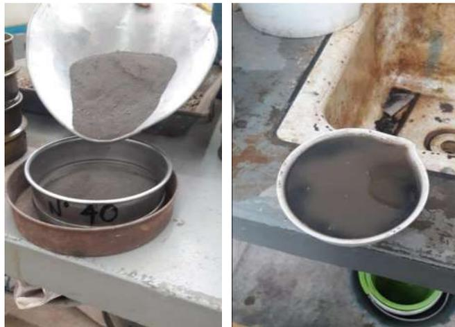
*Imagen 10.- Cribado y saturación del material.*
