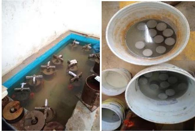
**Imagen 36.-** *Especímenes en la pila de saturación.*
