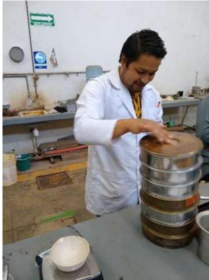
**Imagen 7.-** Colocación de las mallas para efectuar el cribado del material.
