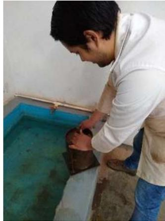
*Imagen 42.- Retiro del molde de la pila de saturación.*
