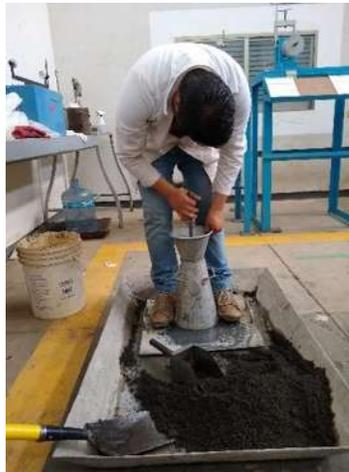
**Imagen 38.-** Varillado para la prueba de revenimiento.
