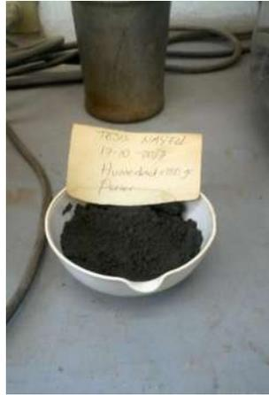
**Imagen 21.-** Obtención del contenido óptimo de humedad.
