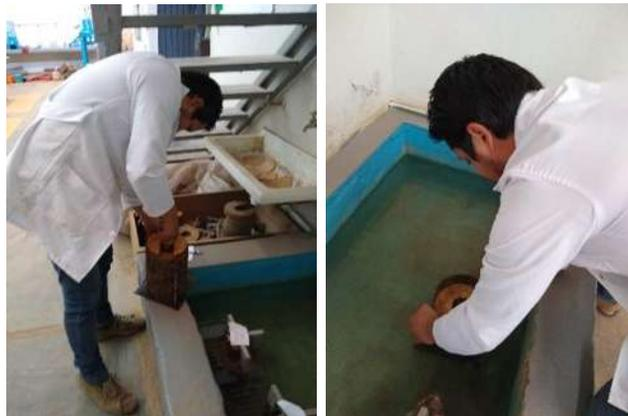
**Imagen 22.-** Colocación de la placa perforada para su posterior saturación en la pila.
