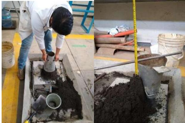
*Imagen 39.- Colocación del flexómetro durante la prueba.*
