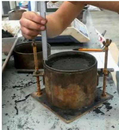
*Imagen 20.- Forma de medir el borde superior del molde con el vernier.*
