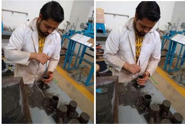
**Imagen 34.-** Llenado y varillado de los cilindros.
