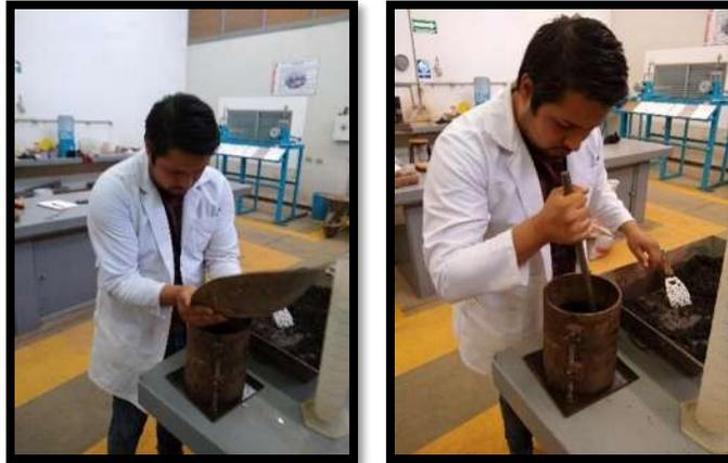
*Imagen 18.- Colocación y varillado del material.*
