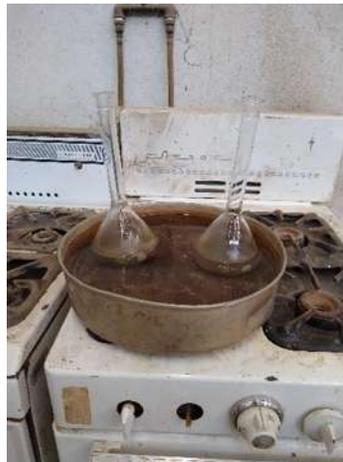
**Imagen 15.-** Expulsión del aire atrapado mediante la ebullición.
