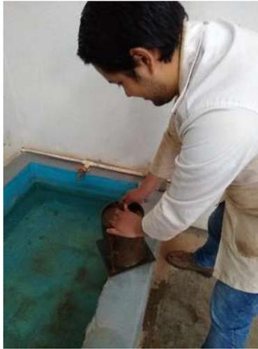
*Imagen 24.- Retiro del molde de la pila de saturación.*
