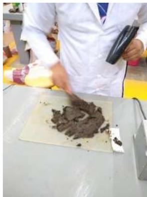
2. Posteriormente se coloca en la copa de Casagrande, previamente calibrada, una cantidad suficiente de material para que una vez extendido con la espátula se tenga un espesor de 8 a 10 milímetros en la parte central de la muestra colocada. Para extender el material se procede del centro hacia los lados, sin aplicar una presión excesiva y con un número mínimo de pasadas de la espátula.
