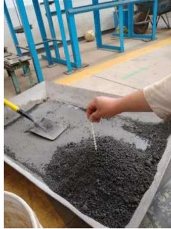
**Imagen 33.-** Colocación del termómetro.
