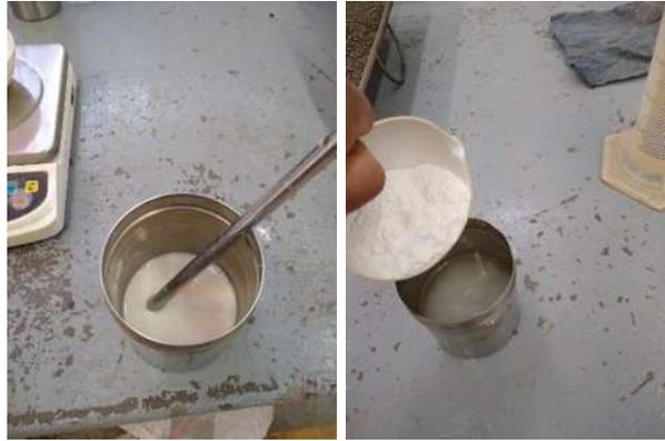
**Imagen 31.-** Homogenización del aditivo MAXE-h en agua.
