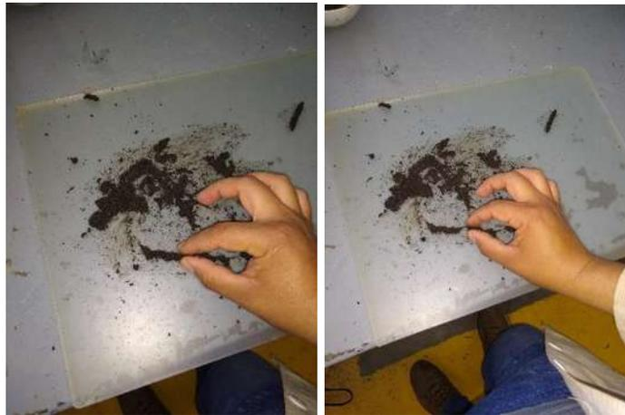
*Imagen 13.- Manipulación del material para formar rollitos.*
