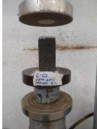
*Imagen 40.- Espécimen colocado en el centro de la placa de la prensa.*
