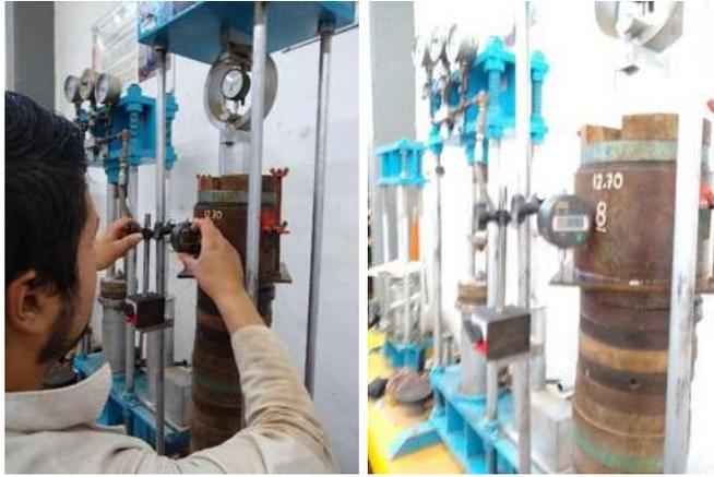
**Imagen 25.-** Forma de colocar el molde en la máquina.
