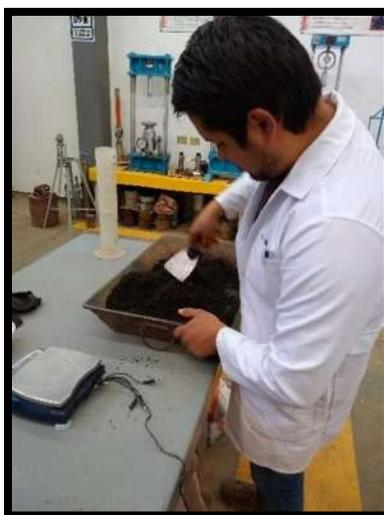
**Imagen 17.-** Homogenización del material con el agua.
