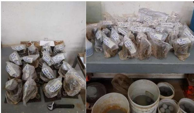
**Imagen 37.-** *Especímenes cubiertas con bolsas muy húmedas.*
