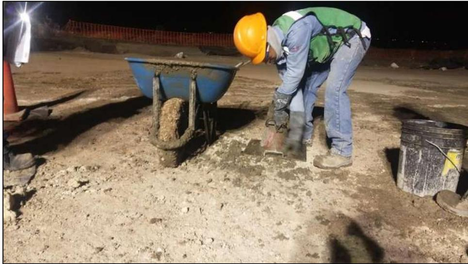
*Figura 14. Prueba de revenimiento del concreto de cada olla revolvedora que llega al sitio*
