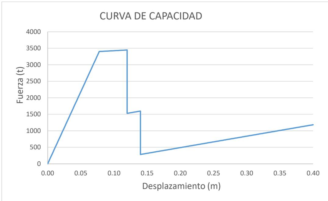
Figura 3-17 Curva de capacidad (Push-over), mecanismo de colapso a cortante en pilas tipo muro.
