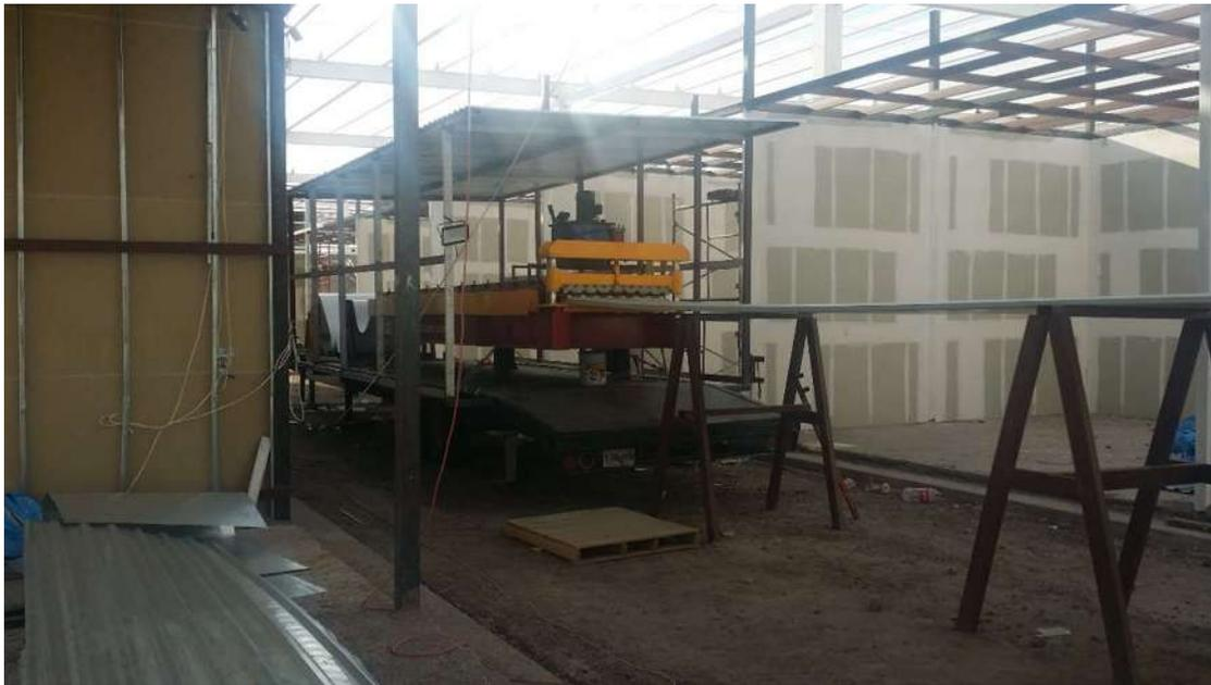
*Fig. 38 Fabricación de lámina R101 con acanaladora en campo*
