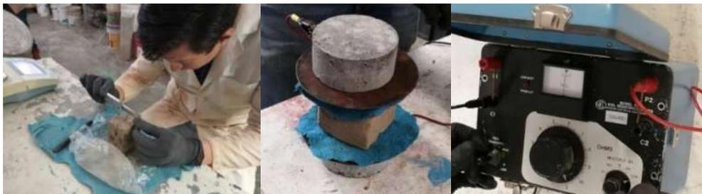
Figura 44. Medición de la muestra; preparación de la muestra; resistómetro.
