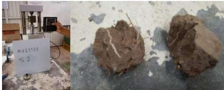
Figura 54. Aplicación de carga puntual en la muestra 5.2; muestra fragmentada.
