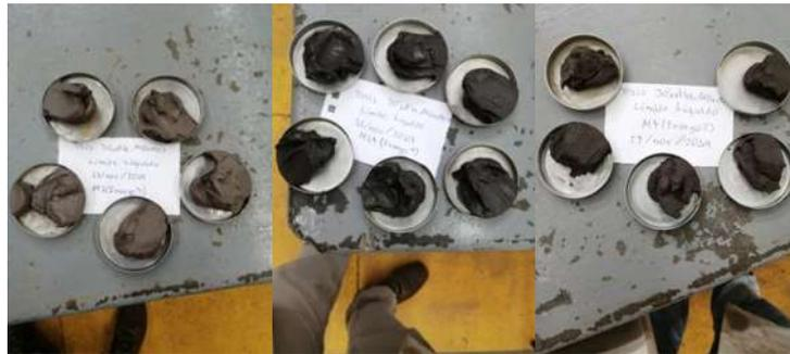
Figura 72. Obtención del límite líquido.
