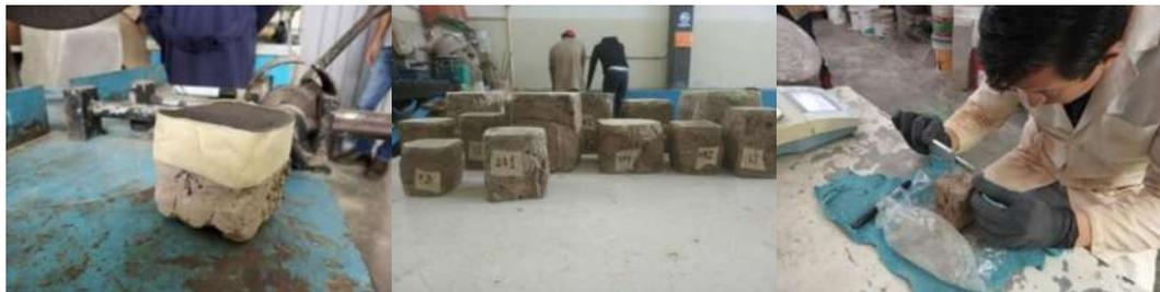
Figura 49. Enfriamiento del azufre; medición de las dimensiones a cada muestra.
