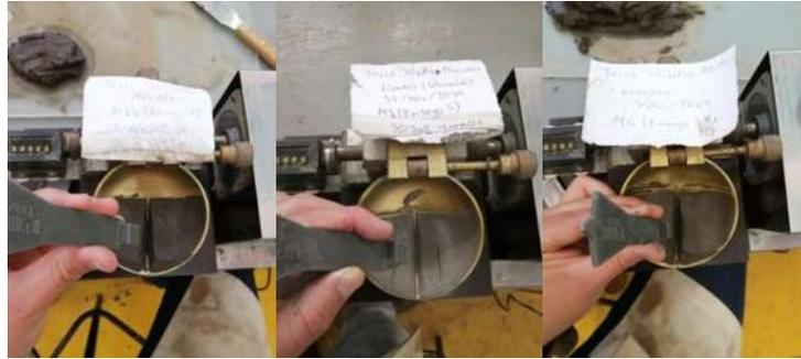
Figura 71. Medición del cierre de ranura en la Copa de Casagrande.
