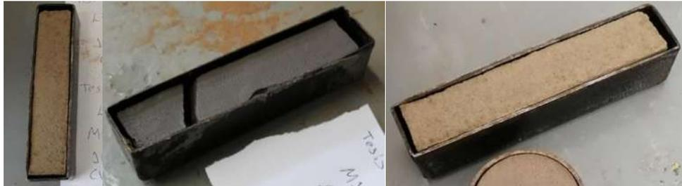
Figura 80. Barras de contracción lineal secadas en el horno.
