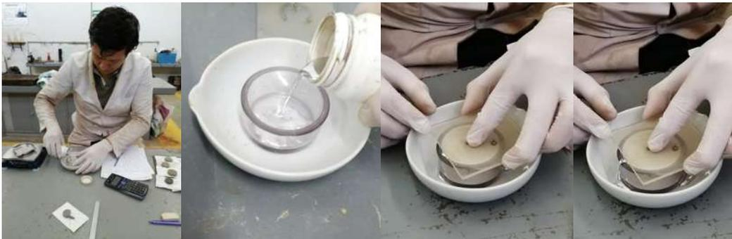
Figura 84. Colocación del mercurio y enrasado de la cápsula con la placa de cristal.
