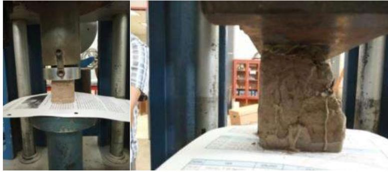
Figura 50. Colocación de las muestras en la máquina universal Tinius Olsen.
