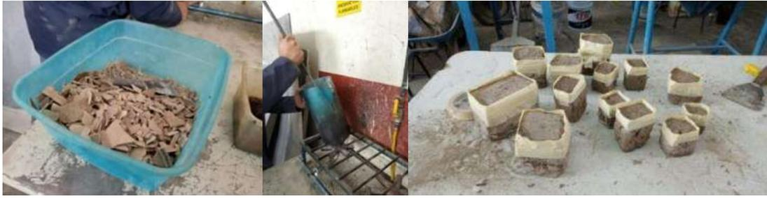
Figura 47. Derretimiento del azufre; preparación de los cubos de adobe con cinta adhesiva.
