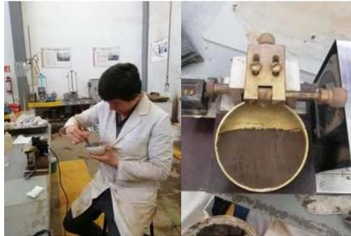
Figura 69. Homogenización del material en cápsula de porcelana; distribución del material sobre la Copa de Casagrande.
