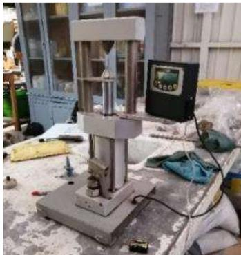
Figura 52. Probador de carga punto básico.
