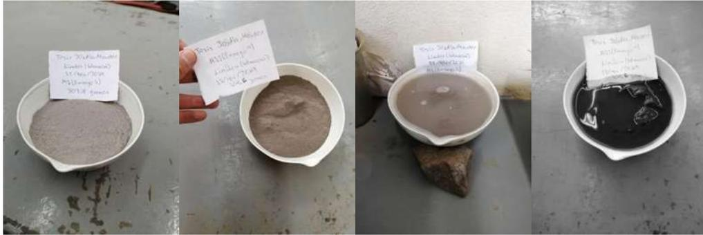
Figura 68. Material cribado por el tamiz N°40 y saturación en agua destilada durante 24 horas.
