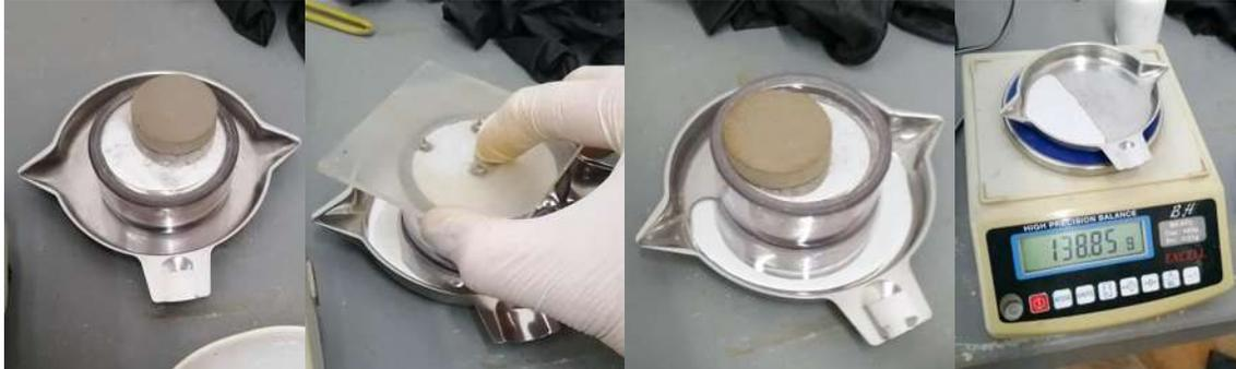
Figura 85. Peso del mercurio desplazado por la pastilla de contracción volumétrica.
