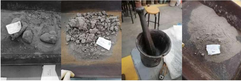
Figura 60. Trituración del material con un mortero.
