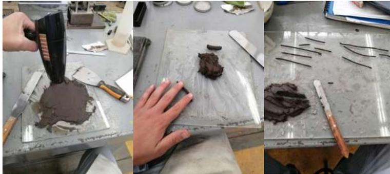
Figura 75. Secado de material sobre una placa de cristal; giro del rollo de material sobre la placa de cristal; secado de los rollos de material.
