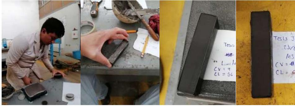
Figura 79. Compactación del material y secado de la cápsula de contracción lineal fuera del horno.
