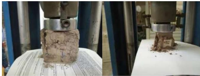
Figura 51. Aplicación de carga en los cubos de adobe.
