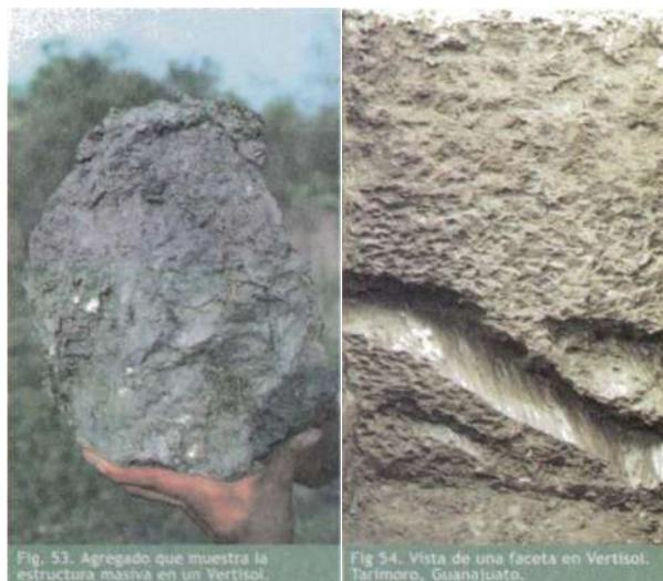
Figura 22. Muestra de suelo tipo vertisol (INEGI, 2004).
