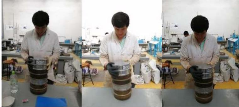
Figura 62. Cribado de la muestra.
