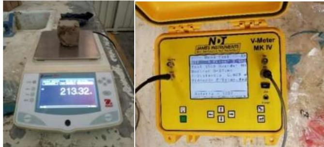
Figura 46. Determinación de la masa del cubo de adobe; medición de la velocidad de pulso.
