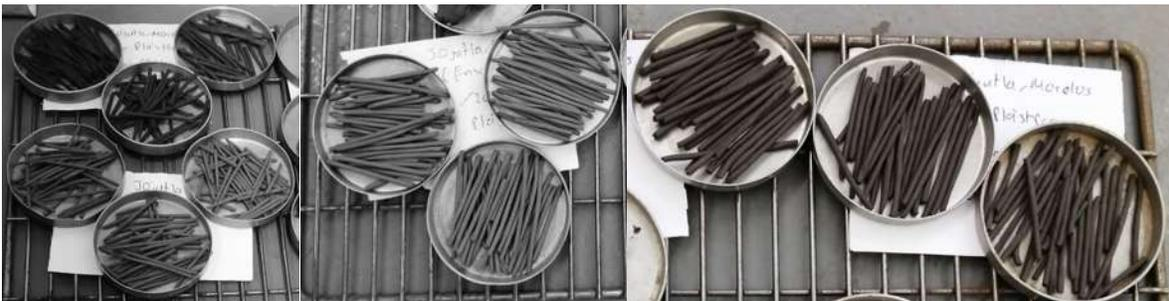
Figura 78. Cápsulas con material del límite plástico.
