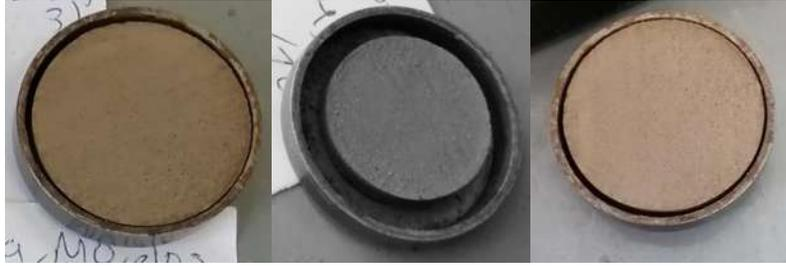
Figura 83. Cápsulas de contracción volumétrica secas.
