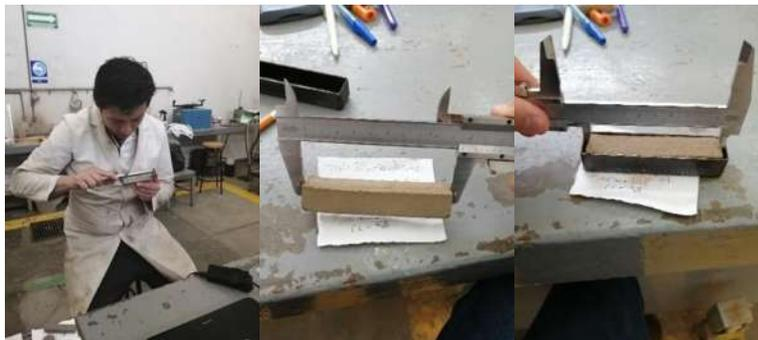
Figura 81. Medición de la barra de contracción lineal.
