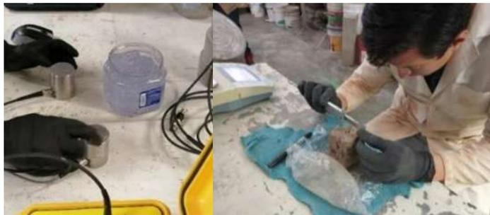
Figura 45. Calibración del generador de impulsos; medición de la longitud del cubo de adobe.
