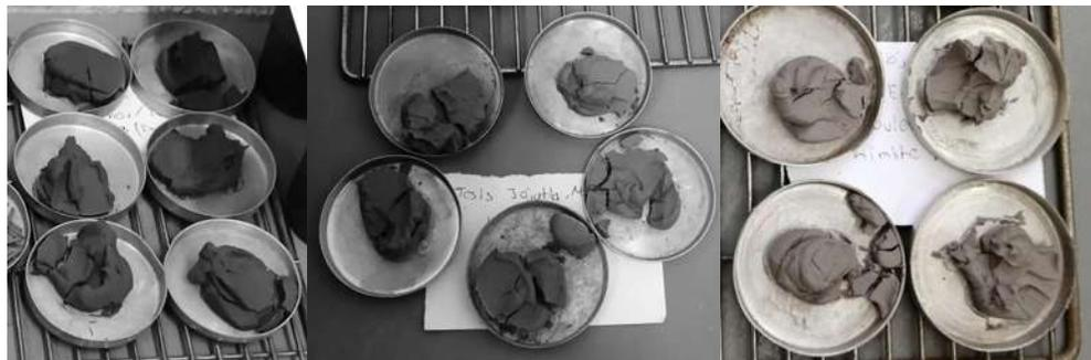
Figura 73. Cápsulas con material del límite líquido secado en el horno.
