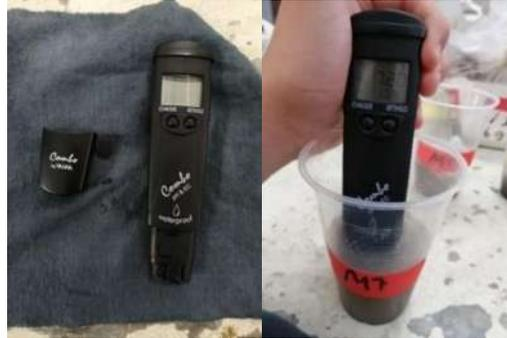
Figura 58. Medidor de pH Hanna Waterproof tester; resultados de pH.
