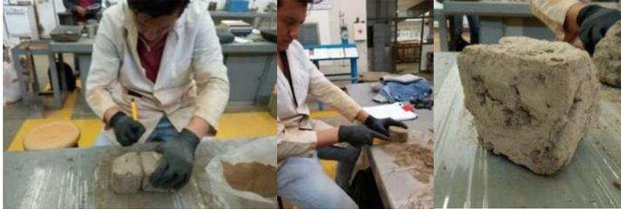
Figura 39. Labrado de bloque de adobe, bloque de adobe recién labrado.
