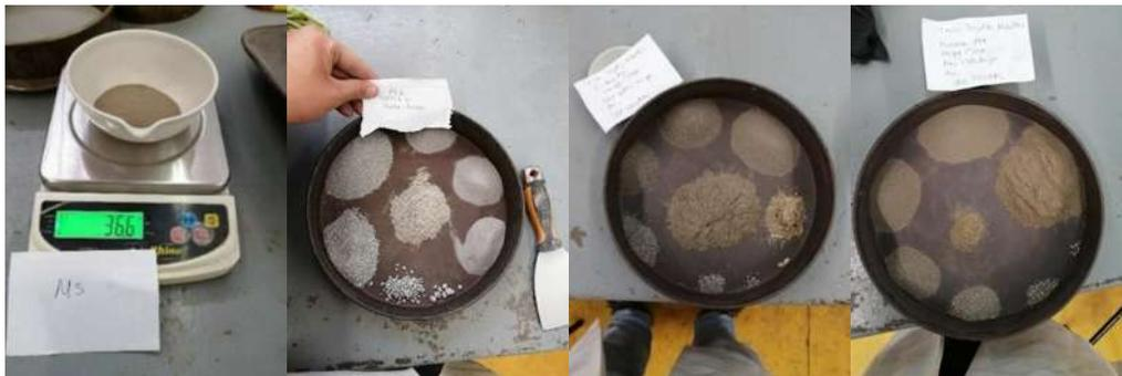
Figura 63. Determinación del peso retenido de las mallas.
