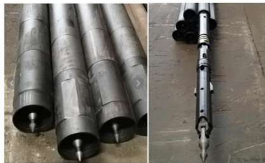
IMAGEN 12. BARRIL MUESTREADOR CON BROCA DE RIMA Y DIAMANTE, FUENTE: [12].
