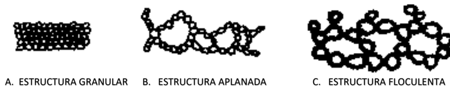
IMAGEN 8. ESTRUCTURA DE LOS SUELOS, (a) ESTRUCTURA GRANULAR; (b) ESTRUCTURA APLANADA; (c) ESTRUCTURA FLOCULENTE. FUENTE: [1].
