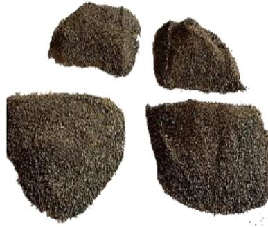
*Ilustración 22 Cuarteo del agregado fino "Arena" material (Fotografía Víctor Ramírez).*
