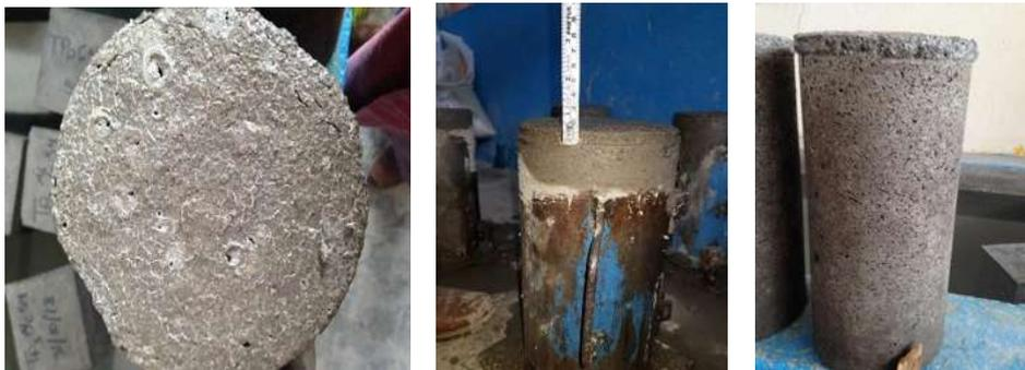
*Ilustración 98 Reacción del concreto con la adición de escoria de aluminio.*
