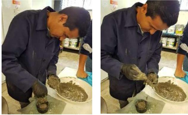
*Ilustración 16 Se hace el llenado del cono troncocónico con la pasta de cemento (Fotografía Víctor Ramírez).*
