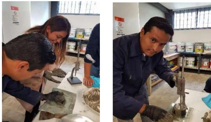
*Ilustración 17 Colocación del cono lleno de pasta de cemento al aparato e Vicat (Fotografía Víctor Ramírez).*
