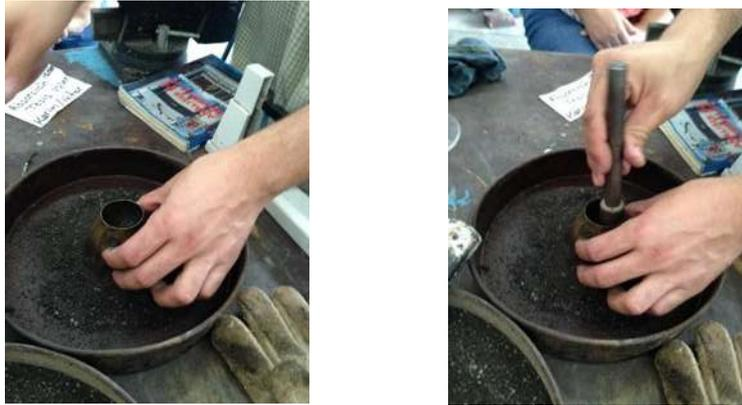
*Ilustración 26 Llenado del cono tronco cónico para corroborar el secado superficial de la arena (Fotografía Víctor Ramírez).*
