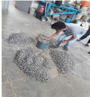
Ilustración 55 Enrazado de la cubeta metálica (Fotografía Víctor Ramírez).
