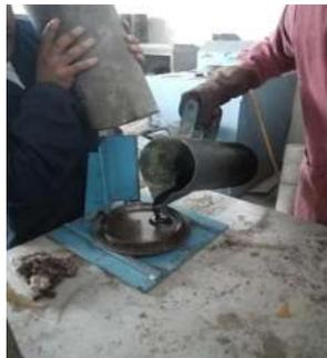
*Ilustración 87 Colocación del azufre en el molde metálico de cabeceo (Fotografía de Víctor Ramírez).*
