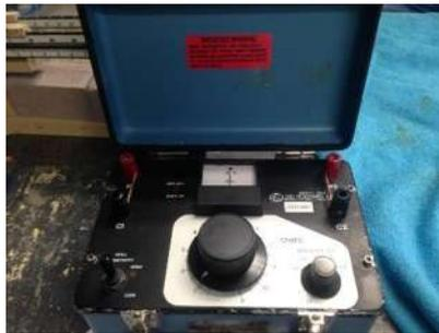
*Ilustración 77 Resistómetro de marca "Nilson electrical" (Fotografía de Víctor Ramírez).*
