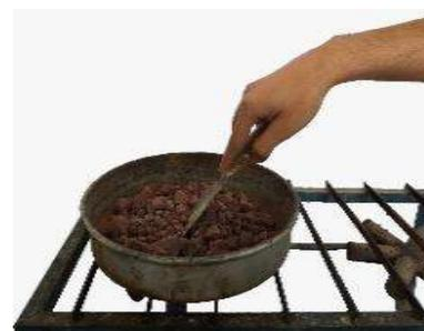
Ilustración 49 Eliminación del agua retenida en la grava por medio de una parrilla de gas (Fotografía Víctor Ramírez).
