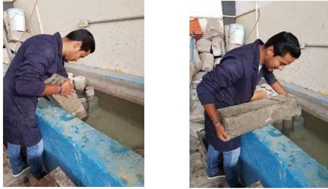
*Ilustración 90 Extracción de las vigas de concreto de la pila de curado (Fotografía de Víctor Ramírez).*
