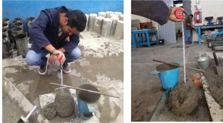
Ilustración 67 Medición del revenimiento de la mezcla de concreto Varillado del concreto en ensaye de revenimiento (Fotografía Víctor Ramírez).
