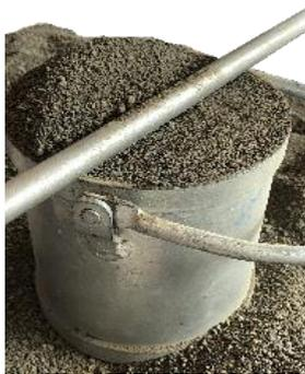
*Ilustración 37 Extracción del exceso de material de arena “enrasado” (Fotografía Víctor Ramírez).*
