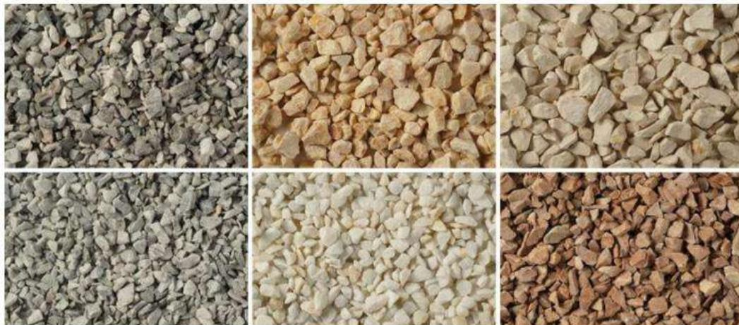
*Ilustración 2 Agregados pétreos con diferentes características de color y textura*
