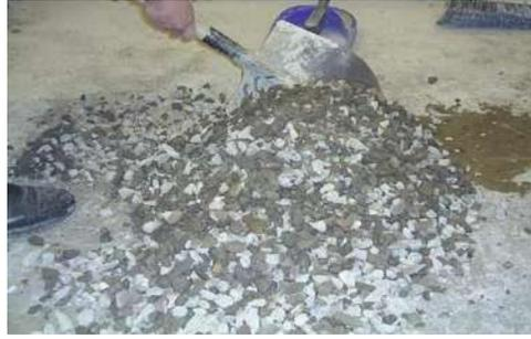
*Ilustración 43 Homogenización del agregado grueso "grava" (Fotografía Víctor Ramírez).*
