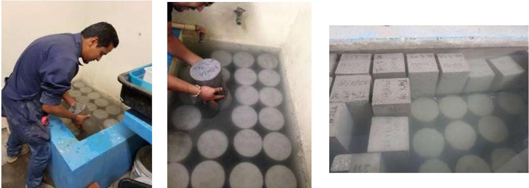
*Ilustración 76 curado por inmersión de las muestras de concreto (Fotografía de Víctor Ramírez).*
