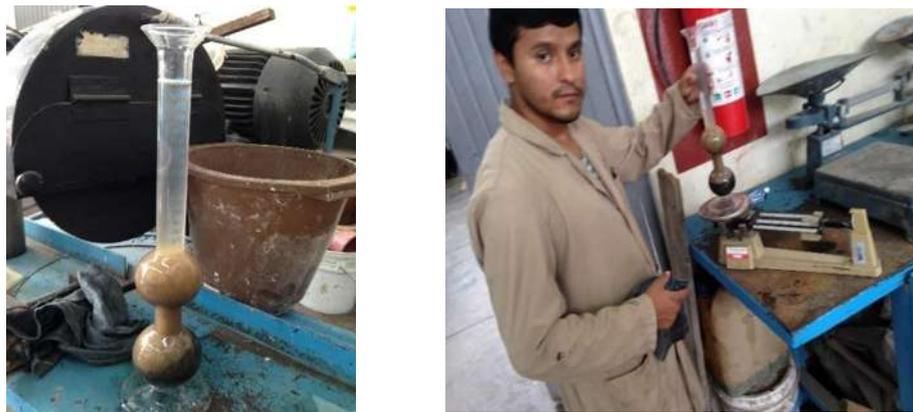
*Ilustración 35 Demostración del matraz de chadman lleno hasta el aforo con la muestra de arena (Fotografía Víctor Ramírez).*
