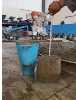
*Ilustración 97 Comprobación del revenimiento de la mezcla de concreto con adición de escoria e acero (hierro), (Fotografía de Víctor Ramírez).*
