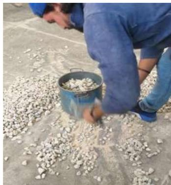
*Ilustración 57 Llenado del bote metálico para la determinación de la mvsc (Fotografía Víctor Ramírez).*
