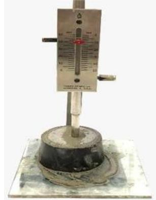
*Ilustración 18 Lectura final, medición de la penetración de la aguja del aparato Vicat (Fotografía Víctor Ramírez).*
