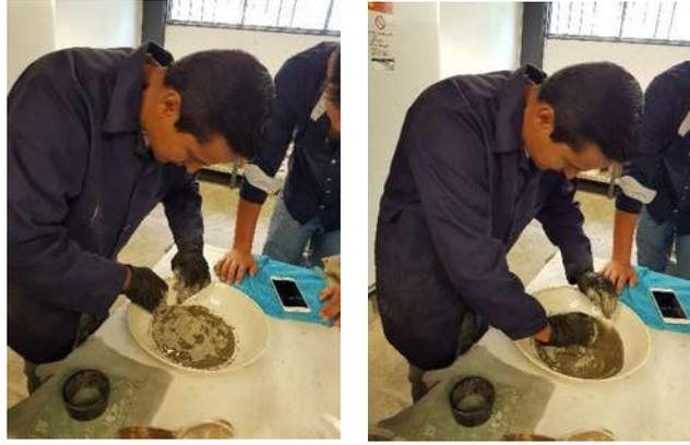
*Ilustración 14 Amasado del cemento con el agua hasta su homogenización (Fotografía Víctor Ramírez).*
