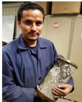
*Ilustración 89 Falla del espécimen cilíndrico (Fotografía de Víctor Ramírez).*
