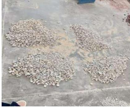
*Ilustración 45 Cuarteo del agregado grueso "Grava" material (Fotografía Víctor Ramírez).*
