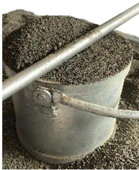
*Ilustración 39 Extracción del exceso de material de arena "Enrasado" (Fotografía Víctor Ramírez).*
