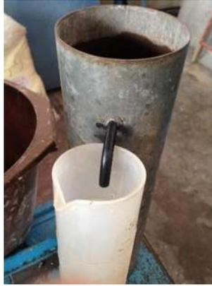
Ilustración 52 Aforo del picnómetro tipo sifón (Fotografía Víctor Ramírez).
