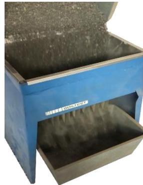
*Ilustración 23 División de la muestra de arena por medios del cuarteador mecánico (Fotografía Víctor Ramírez).*
