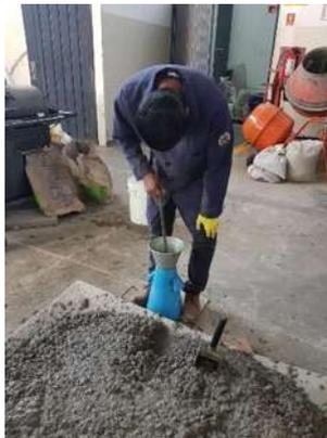
*Ilustración 65 Varillado del concreto en ensaye de revenimiento (Fotografía Víctor Ramírez).*
