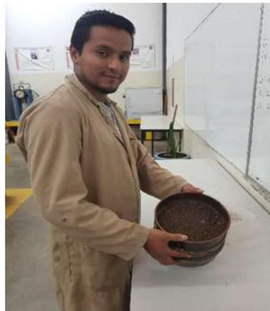
*Ilustración 62 Procedimiento de criba de la fibra de acero. (Fotografía Víctor Ramírez).*
