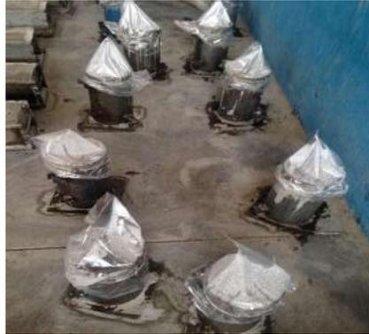
*Ilustración 70 Colocación de bolsa de plástico para que el concreto no pierda humedad excesiva (Fotografía Víctor Ramírez).*
