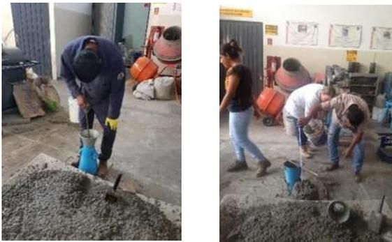
*Ilustración 95 Comprobación del revenimiento en la mezcla de concreto convencional (Fotografía de Víctor Ramírez).*
