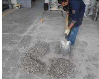
*Ilustración 56 Cuarteo de gravas por el método de palas (Fotografía Víctor Ramírez).*
