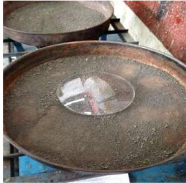
*Ilustración 32 Comprobación de que la muestra de arena ya no contiene humedad (Fotografía Víctor Ramírez).*
