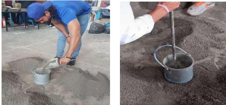
*Ilustración 38 Llenado y varillado de la muestra de arena para la determinación de la masa volumétrica seca y compactada (Fotografía Víctor Ramírez).*
