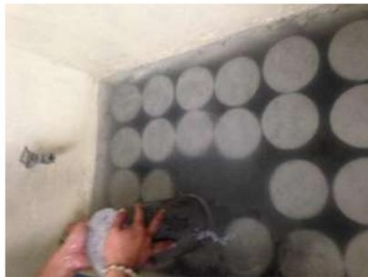
*Ilustración 85 Extracción de los especímenes cilíndricos de la pila de curado (Fotografía de Víctor Ramírez).*
