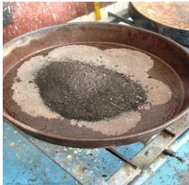
*Ilustración 31 Secado de la muestra de arena (Fotografía Víctor Ramírez).*
