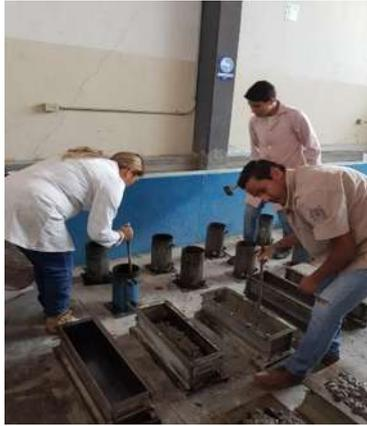
*Ilustración 72 Varillado de las capas de concreto en vigas (Fotografía Víctor Ramírez).*
