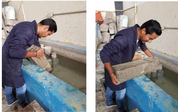
*Ilustración 82 Extracción de los especímenes de la pila de curado (Fotografía de Víctor Ramírez).*
