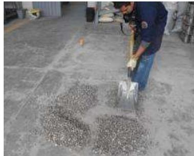
*Ilustración 53 Cuarteo de grava por el método de palas (Fotografía Víctor Ramírez).*
