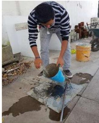
*Ilustración 63 Los materiales de la prueba se humedecen (Fotografía Víctor Ramírez).*
