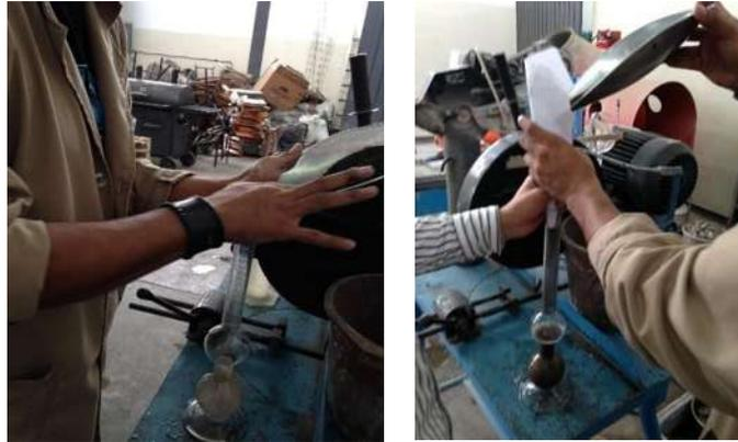
*Ilustración 34 Se introduce la arena dentro del matraz de chadman (Fotografía Víctor Ramírez).*
