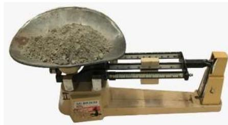
*Ilustración 12 Determinamos el peso de muestra representativa del cemento (Fotografía Víctor Ramírez).*
