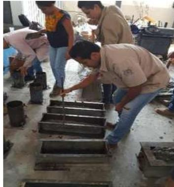
*Ilustración 71 Llenado de las capas de concreto en vigas (Fotografía Víctor Ramírez).*
