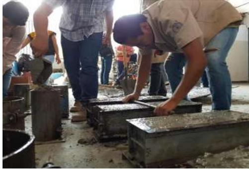
Ilustración 74 Enrasado, acabado final de la viga de concreto (Fotografía Víctor Ramírez).
