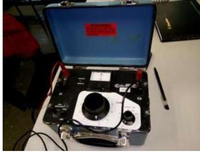
*Ilustración 78 Resistómetro conectado (Fotografía de Víctor Ramírez).*
