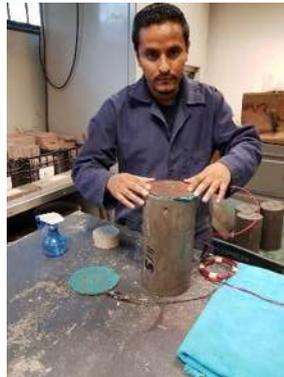
*Ilustración 79 Preparación de la muestra de concreto para hacer la lectura de resistividad (Fotografía de Víctor Ramírez).*
