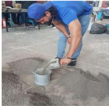
*Ilustración 36 Llenado del bote metálico para la determinación de la masa volumétrica seca y suelta (Fotografía Víctor Ramírez).*
