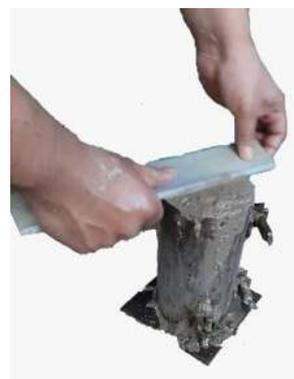
*Ilustración 68 Llenado y enrasado del cilindro de concreto (Fotografía Víctor Ramírez).*
