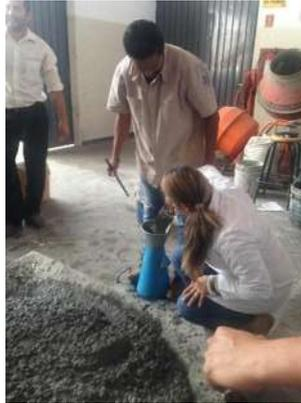
*Ilustración 64 Llenado del molde troco cónico de concreto para el ensaye de revenimiento (Fotografía Víctor Ramírez).*
