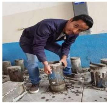
*Ilustración 75 Preparación de las muestras de concreto para su curado (Fotografía de Víctor Ramírez).*
