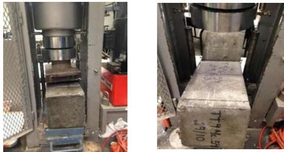
*Ilustración 94 Aplicación de la carga y falla de la viga a flexión (Fotografía de Víctor Ramírez).*
