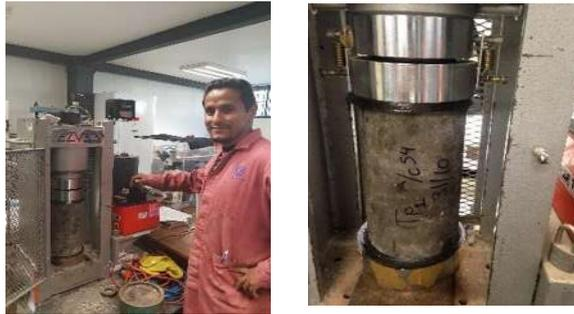
*Ilustración 88 Aplicación de la carga a compresión en el espécimen cilíndrico (Fotografía de Víctor Ramírez).*
