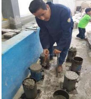
*Ilustración 69 Vibración con el mazo de goma (Fotografía Víctor Ramírez).*
