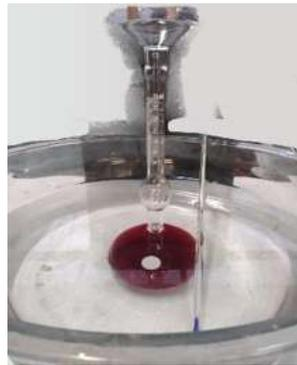
*Ilustración 8 Estabilización del Keroseno (Fotografía Víctor Ramírez).*
