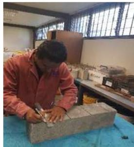
*Ilustración 92 Marcación de los tercios medios en las vigas de concreto para determinar la flexión (Fotografía de Víctor Ramírez).*
