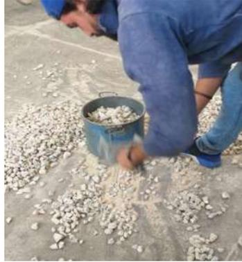
Ilustración 54 Llenado de la cubeta metálica por la grava para determinar mvss (Fotografía Víctor Ramírez).
