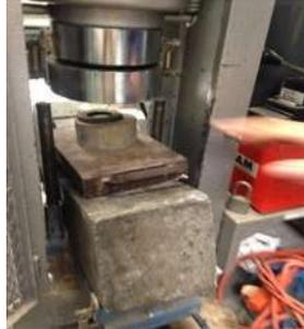
*Ilustración 93 Colocación de los apoyos y aditamentos para la prueba de flexión (Fotografía de Víctor Ramírez).*
