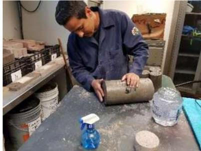
*Ilustración 83 Aplicación del agente de acoplamiento para medir la velocidad de pulso ultra sónico (Fotografía de Víctor Ramírez).*
