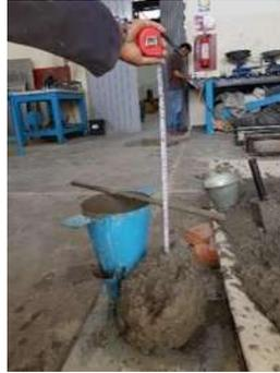
*Ilustración 96 Comprobación del revenimiento del concreto con adición de escoria de aluminio (Fotografía de Víctor Ramírez).*
