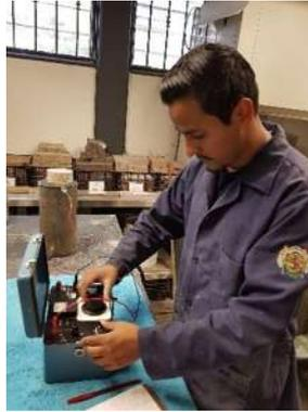
Ilustración 80 Toma de la lectura de resistividad con el resistómetro (Fotografía de Víctor Ramírez).
