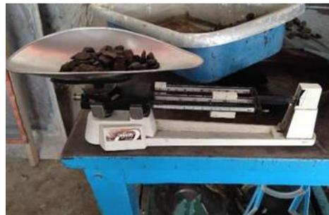
*Ilustración 51 Secado superficial y toma de los 300 gr de la muestra de grava (Fotografía Víctor Ramírez).*
