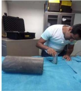
*Ilustración 81 Calibración del aparato de velocidad de pulso ultra sónico (Fotografía de Víctor Ramírez).*
