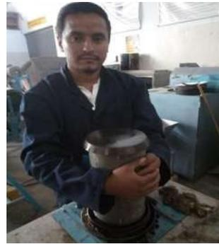
*Ilustración 86 Cabeceo del espécimen cilíndrico de concreto (Fotografía de Víctor Ramírez).*
