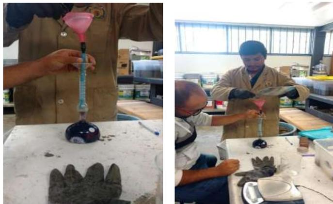
*Ilustración 10 Se agrega el cemento al matraz de chatelier para la toma de la lectura final (Fotografía Víctor Ramírez).*
