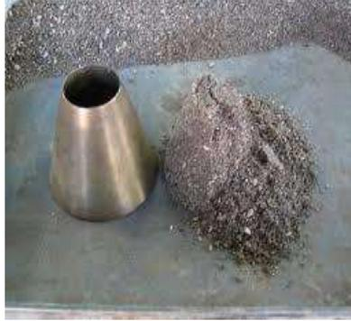
Ilustración 28 Revisión final del secado superficial de la arena, si la muestra se disgrega esta seca superficial (Fotografía Víctor Ramírez).
