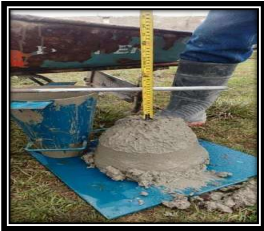
Figuras V.41 Prueba de revenimiento del concreto y llenado de cilindros. Fuente: propia
