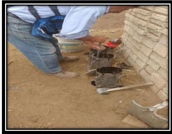
Figuras V.41 Prueba de revenimiento del concreto y llenado de cilindros. Fuente: propia
