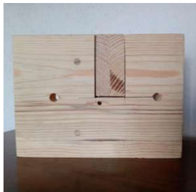
Imagen 79. Detalle ensamble pegado al muro.
