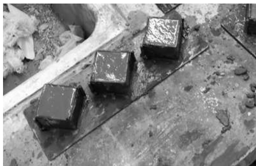
Ilustración 43. Terminación de llenado y enrasado de cubos. (Fuente: Elaboración Propia.)
