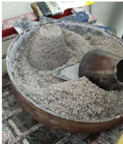
Ilustración 18. Secado superficial y uso del molde troncocónico. (Fuente: Elaboración Propia.)
