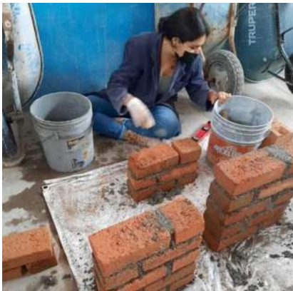
Ilustración 47. Realización de muretes. (Fuente: Elaboración Propia.)
