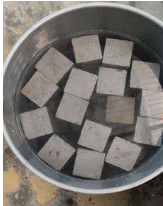
Ilustración 44. Curado de los especímenes. (Fuente: Elaboración Propia.)
