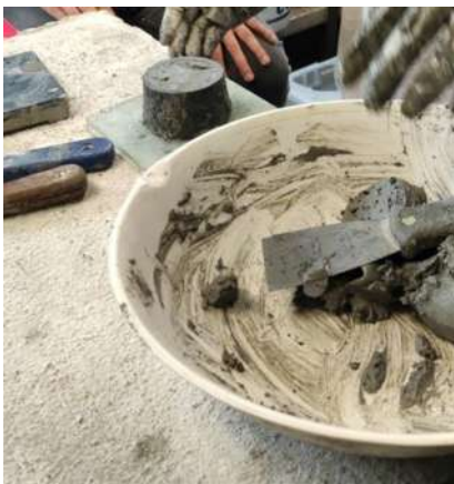
Ilustración 31. Colocación de la masa en el anillo del aparato de Vicat. (Fuente: Elaboración Propia.)
