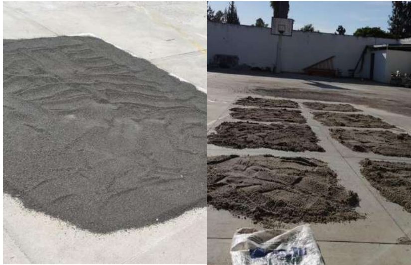
Ilustración 7. Secado de la arena, haciendo uso del patio del Laboratorio de la Facultad. (Fuente: Elaboración Propia.)
