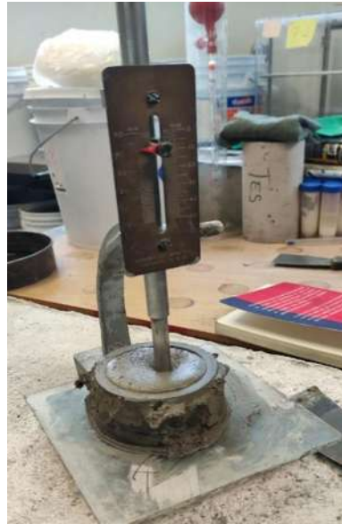
Ilustración 32. Medición de la penetración a la masa del cemento. (Fuente: Elaboración Propia.)
