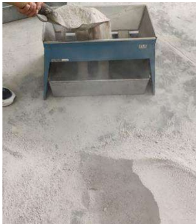
Ilustración 12. Agregado del material al cuarteador mecánico. (Fuente: Elaboración Propia)
