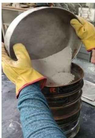
Ilustración 15. Colocación del material y ordenado de mallas. (Fuente: Elaboración Propia.)
