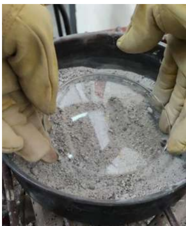
Ilustración 19. Colocación del cristal a la muestra completamente seca. (Fuente: Elaboración Propia.)
