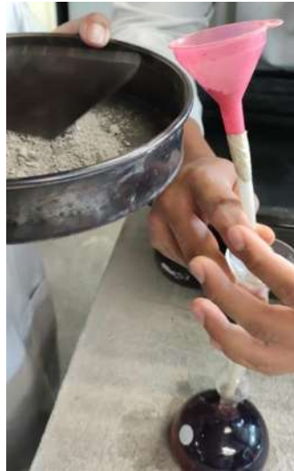
Ilustración 28. Colocación del cemento CPC 30R RS, dentro del frasco Le Chatelier. (Fuente: Elaboración Propia.)
