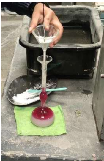
Ilustración 36. Vaciado de la cal en el frasco de Le Chatelier. (Fuente: Elaboración Propia.)
