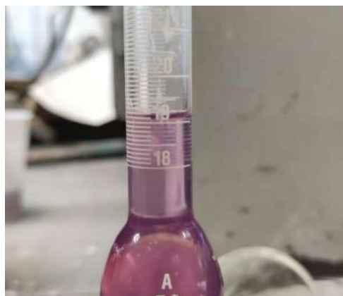
Ilustración 37. Toma de lectura final, para la Densidad de la cal. (Fuente: Elaboración Propia.)
