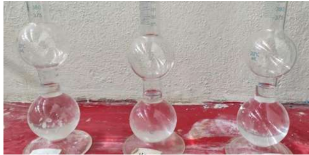
Ilustración 20. Colocación de un volumen de agua conocido. (Fuente: Elaboración Propia.)
