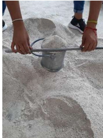
Ilustración 26. Enrasado y pesado del material MVSV. (Fuente: Elaboración Propia.)
