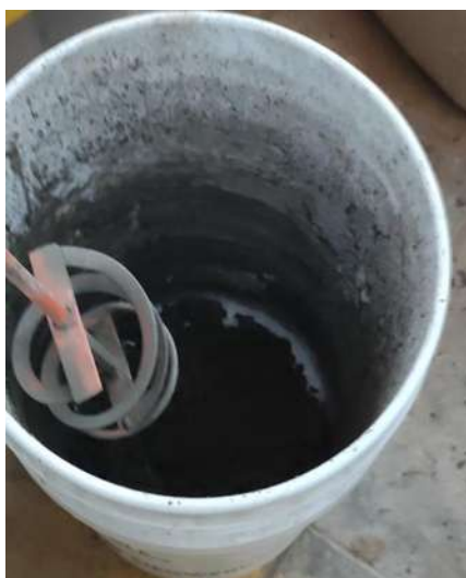
Ilustración 40. Método de mezclado por medio del uso del taladro. (Fuente: Elaboración Propia.)
