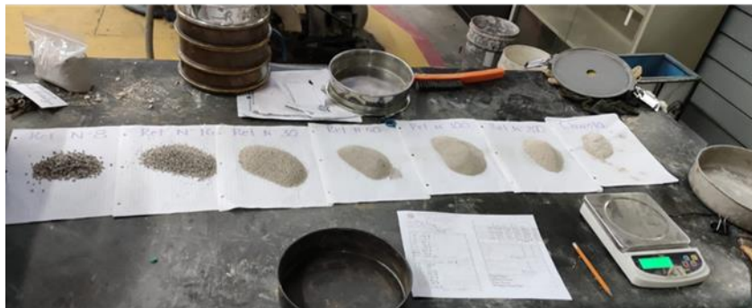
Ilustración 17. Retenido del material en cada número de malla. (Fuente: propia.)
