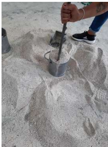
Ilustración 25. Golpes al material con la varilla punta de bala. (Fuente: Elaboración Propia.)
