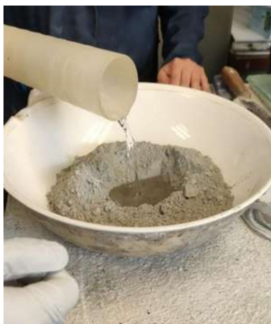
Ilustración 30. Realización de cráter para hacer el vertido del agua. (Fuente: Elaboración Propia.)
