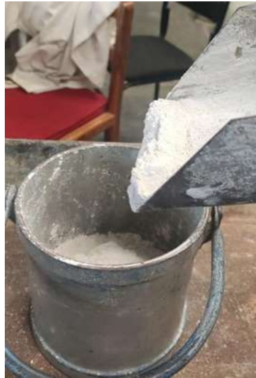
Ilustración 38. Llenado de recipiente de MVSS, con altura de 5 cm a partir de la arista superior. (Fuente: Elaboración Propia.)
