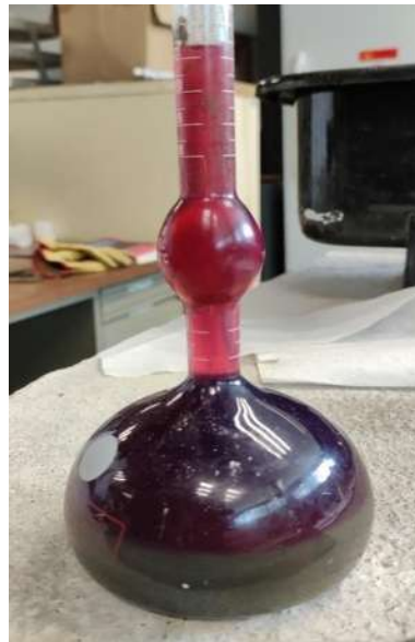
Ilustración 29. Lectura final de densidad del cemento. (Fuente: Elaboración Propia.)
