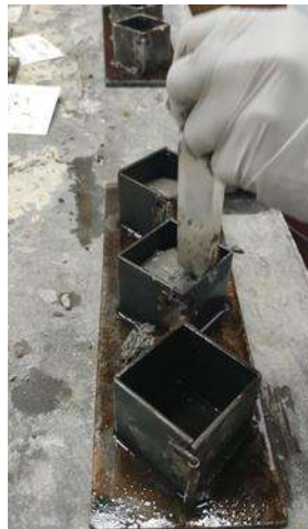
Ilustración 42. Engrasado y llenado del molde con la mezcla. (Fuente: Elaboración Propia.)
