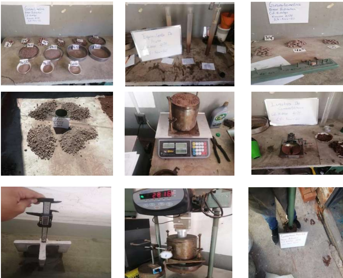
Fig. N° 23: Granulometrías, Cuarteos y Limites.
