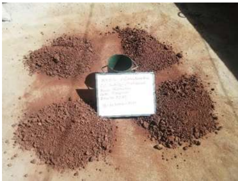
Fig. N° 28: Cuarteo y Granulometrías.
