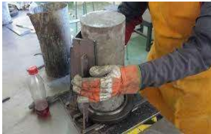
Fig. N° 20.- Cabeceo de los cilindros de concreto con azufre.
