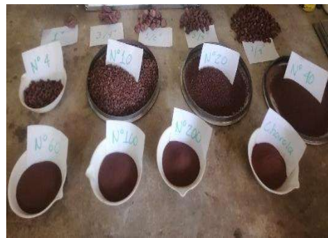
Fig. N° 28: Cuarteo y Granulometrías.
