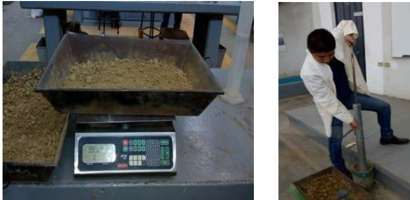
Fig. N°11.- Prueba de AASHTO en laboratorio.
