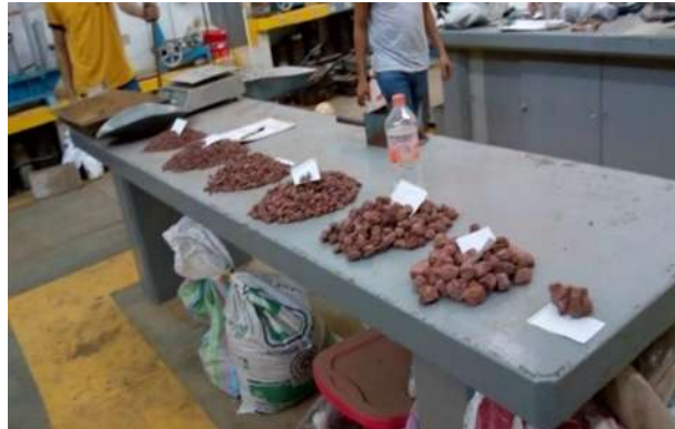
Fig. N°9.- Prueba de granulometría en laboratorio.
