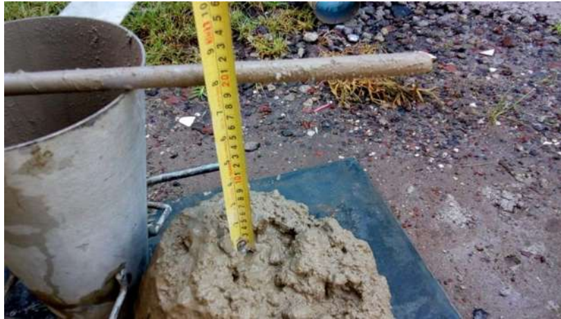
Fig. N° 17: Se realizo el revenimiento del concreto hidráulico.
