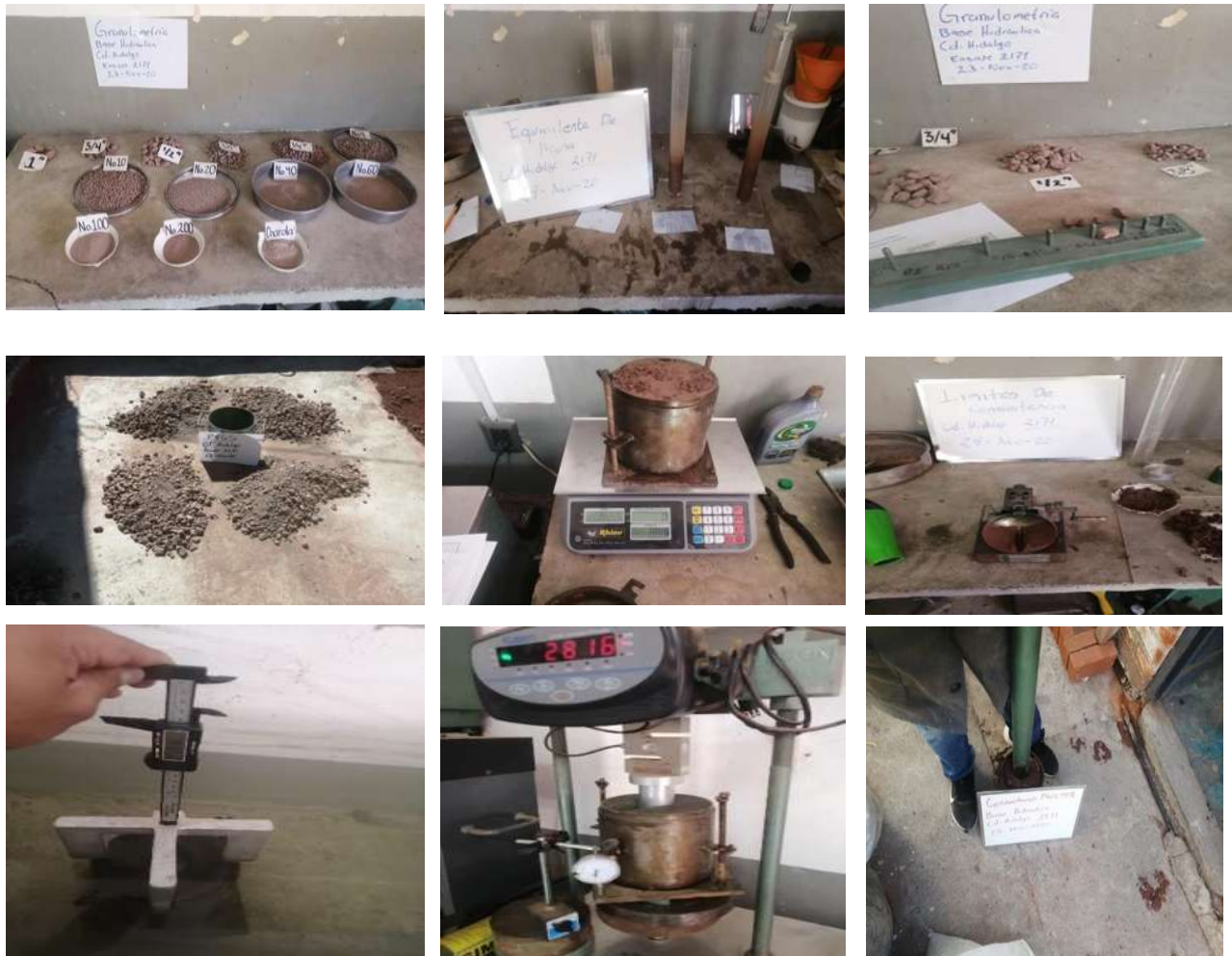
Fig. N° 24: Granulometrías, Equivalentes de Arena, Cuarteos y Limites.
