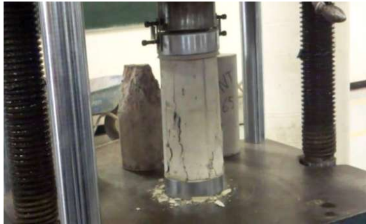
Fig. N° 21.- Prueba de resistencia a la compresión de los cilindros con la maquina universal.
