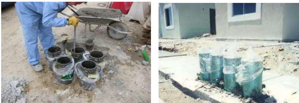
Fig. N° 18.- llenado de molde con la muestra de concreto, identificación y protección de las muestras.
