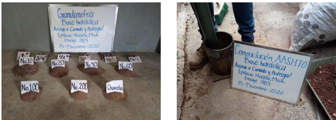
Fig. N° 25: Granulometrías y compactación AASHTO
