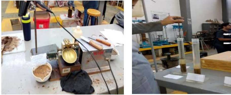
Fig. N°13.- Prueba de limites de consistencia equivalente de arena.
