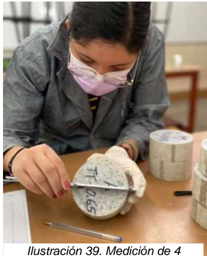
Ilustración 39. Medición de 4 diámetros con Vernier.
