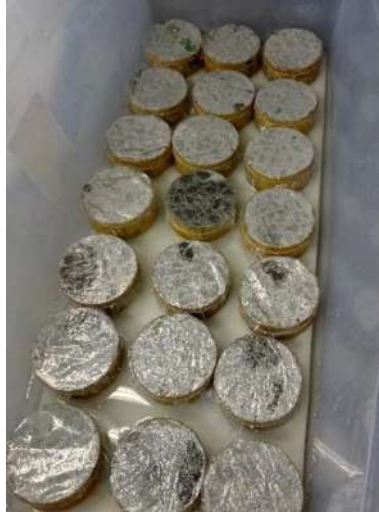
Ilustración 43. El recipiente plástico con esponja y agua que cubre 3mm de la muestra colocada con la superficie de ensayo del espécimen sobre la esponja
