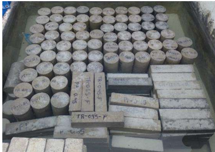
Ilustración 24. Especímenes cilíndricos y prismáticos en pila de curado. (García Romero, 2021)
