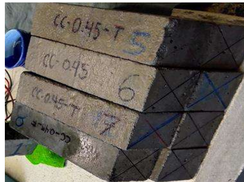
Ilustración 26. Especímenes prismáticos de 6x6x26cm de la mezcla con sustituto de Ceniza de Bagazo de Caña, con agregado triturado y la relación a/c=0.45 (García Romero, 2021)
