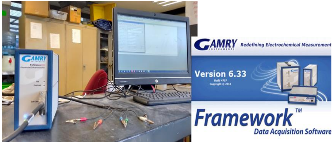
Ilustración 68. Potenciostato marca Gamry, modelo E600. Software de operación y de análisis versión 6.33.
