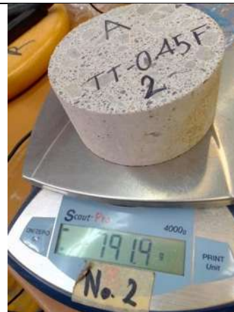
Ilustración 38. Masa seca después de reposo de 15 días de cilindro de mezcla Testigo con agregado triturado y una relación a/c=0.45
