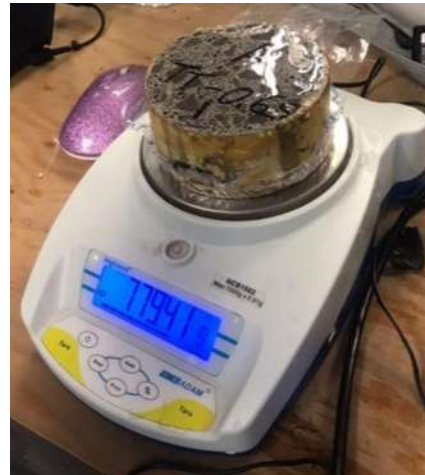
Ilustración 44. Masa de Testigo con agregado triturado y relación a/c=0.65 a los 60s de inmersión
