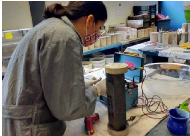
Ilustración 34. Realización del método directo de la prueba de durabilidad de resistividad eléctrica con el aparato de Nilsson (García Romero, 2021)
