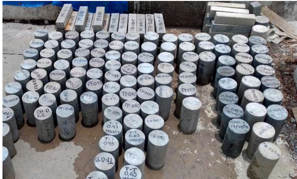
Ilustración 20. Especímenes prismáticos y cilíndricos que se someterán a pruebas de durabilidad (García Romero, 2021)
