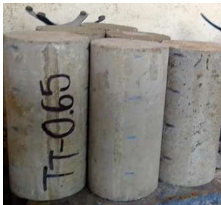
Ilustración 21. Especímenes cilíndricos de 10x20cm. (García Romero, 2021)
