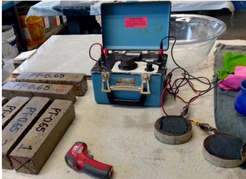
Ilustración 27. Equipo necesario para realizar prueba de resistividad eléctrica. (García Romero, Daniela)
