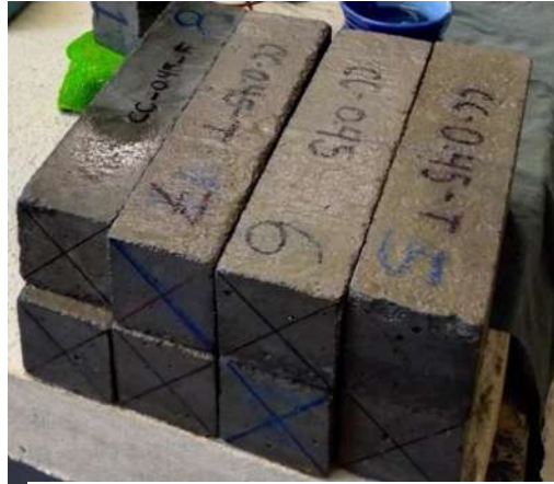
Ilustración 23. Especímenes prismáticos de 6x6x26cm. (García Romero, 2021)
