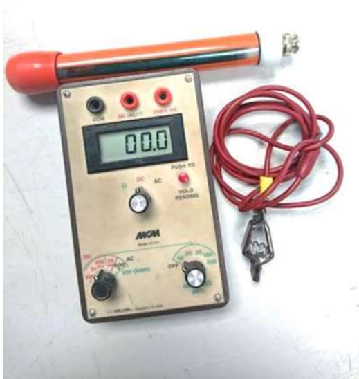
Ilustración 64. Equipo utilizado para prueba de potencial de corrosión (Bernabé Reyes)
