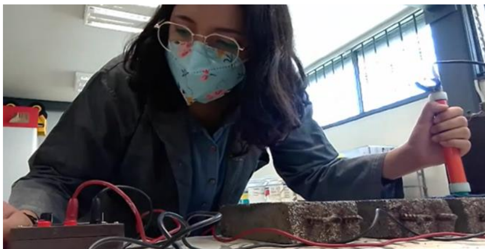
Ilustración 66. Medición de potencial de corrosión. (García Romero, 2021)
