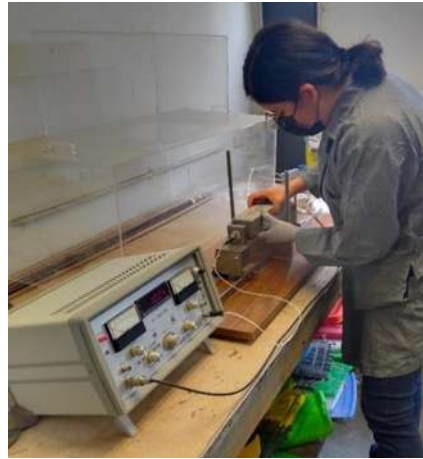
Ilustración 47 Colocación del espécimen prismático según lo indica el manual de uso del aparato E-METER. (García Romero, 2021)
