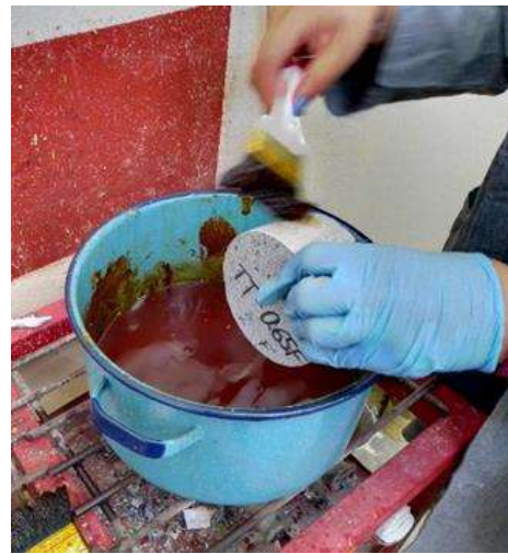
Ilustración 40. Sellado con parafina en la superficie lateral de cada espécimen
