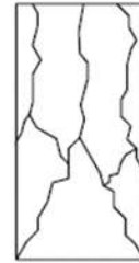
Ilustración 52, TIPO 3. Fracturas verticales de columnas de extremo a extremo conos no formados.
