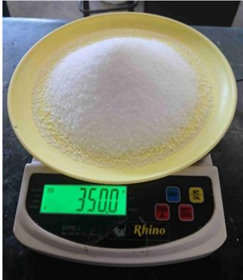
Ilustración 59. Cloruro de sodio (NaCl) al 3.5% de la solución en masa respecto al agua. (Bernabé Reyes)
