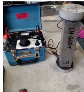
Ilustración 33. Colocación del espécimen con sustitución de Ceniza de Horno, agregado triturado y relación a/c=0.65. (García Romero, 2021)
