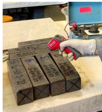
Ilustración 32. Toma de temperatura hasta que sea constante de espécimen prismático (García Romero, 2021)
