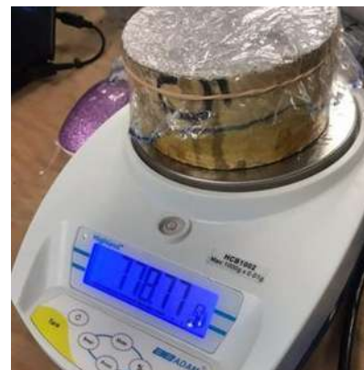
Ilustración 42. Toma de masa de rodajas de concreto con sellado de parafina, plástico y liga elástica.
