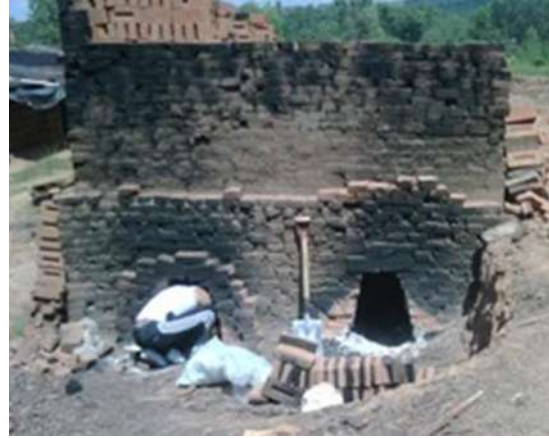
Ilustración 16. Extracción de la ceniza del horno de cocción del ladrillo, utilizando palas. (Bernabé Reyes, 2012)
