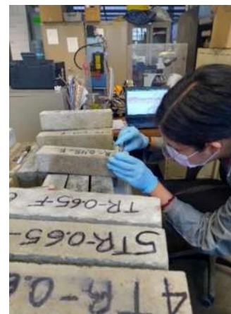
Ilustración 31. Medición de espesor de las probetas prismáticas que se someterán a resistividad eléctrica. (García Romero, 2021)
