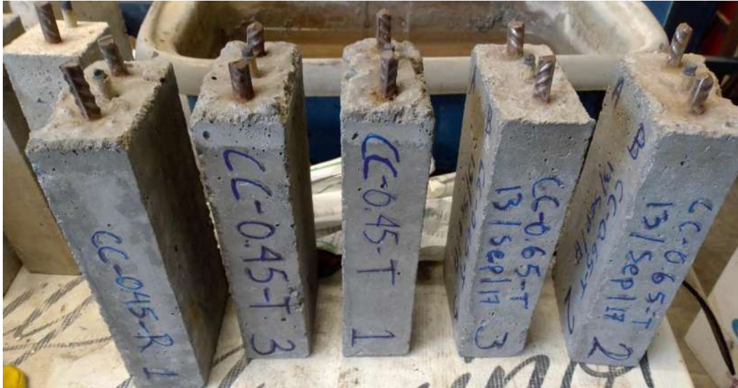
Ilustración 62. Especímenes “paleta” de la mezcla SCBA con agregado CCA y una relación a/c=0.45 , conformados de acero embebido en concreto, los cuales se utilizaron para medir el potencial de corrosión. (García Romero, 2021)
