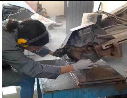
Ilustración 36. Cortado de cilindros para prueba de absorción con cortadora de disco con enfriador de agua (García Romero, 2021)
