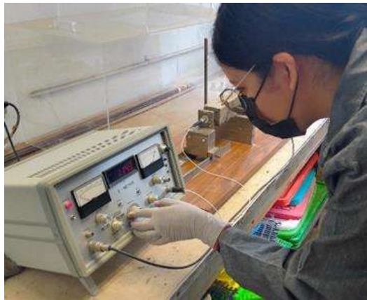
Ilustración 48. Vibración de prismas a varias frecuencias. (García Romero, 2021)
