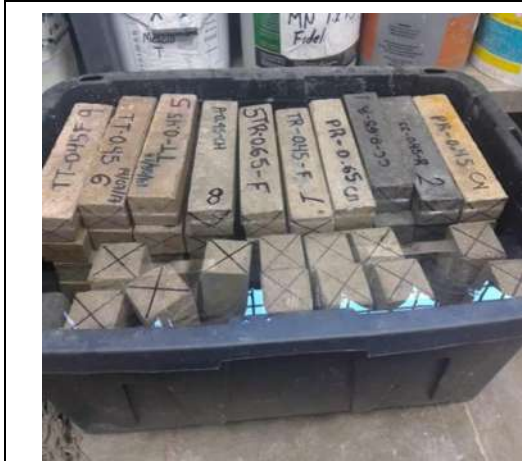
Ilustración 46 Especímenes prismáticos de 6x6x26cm utilizados para la prueba de frecuencia de resonancia longitudinal. (García Romero, 2021)
