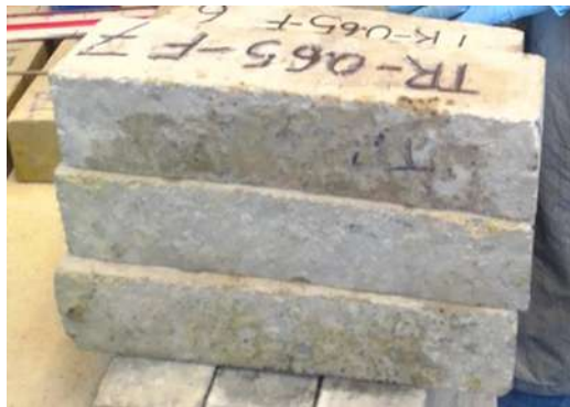
Ilustración 25. Especímenes prismáticos de 6x6x26cm de la mezcla Testigo con agregado reciclado con una relación a/c=0.65 (García Romero, 2021)
