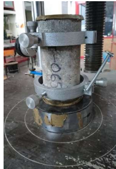
Ilustración 57. el espécimen con el deformímetro sobre la platina de la prensa, centrándolo antes de aplicar la carga. (Bernabé Reyes)
