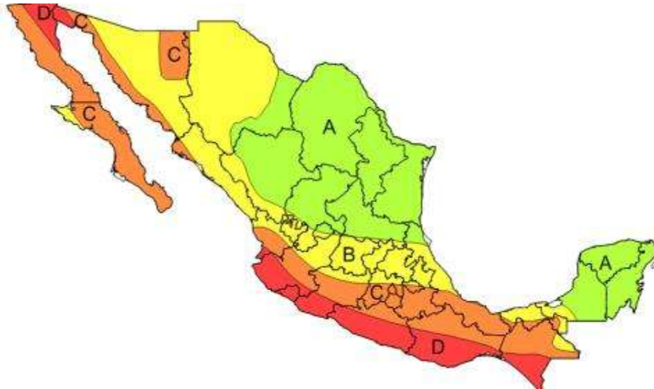
Figura 6 Regionalización sísmica de México (Manual de diseño de obras civiles de la CFE).
